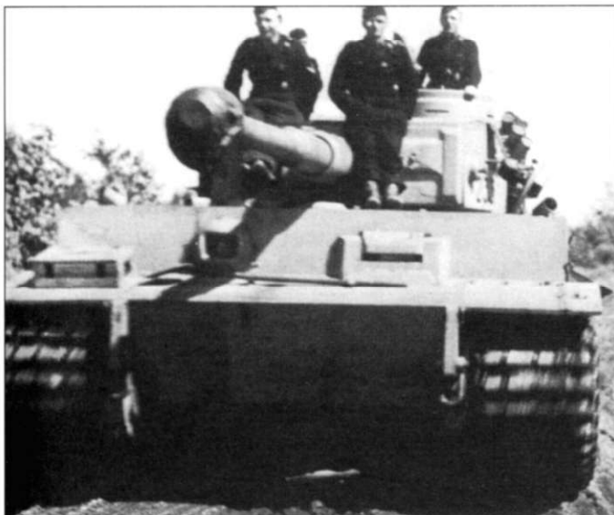
«Тигр» с бортовым номером «233». Мамонт нарисован в самом углу лобового бронелиста. На правом крыле укреплен ящик с инструментом. Скорее всего снимок сделан где-то в тылу, на передовой экипаж вряд ли стал бы оставлять ящик в этом месте.
