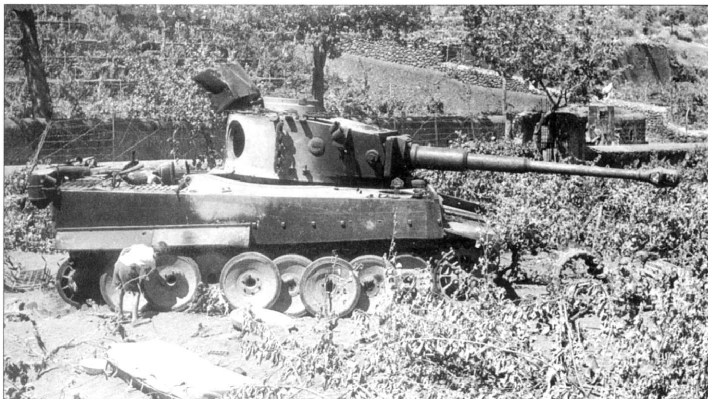
Один из трех танков «Тигр», уничтоженных союзникам в районе Пизано, Сицилия, снимок сделан 16 августа 1943 г. Шесть последних танков «Тигр» подразделение получило в июне 1943 г. На всех этих танках запасные гусеничные траки крепились на бортах башни, тактических номеров на башнях не было, лишь в верхней левой части нижнего лобового бронелиста имелась эмблема в виде ромба белого цвета с красной полоской, а также небольшая цифра порядкового номера танка в подразделении.
