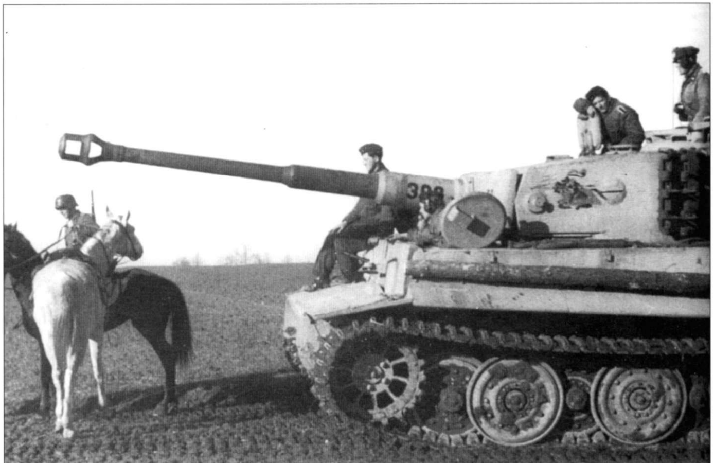
Танкисты из 505-го тяжелого танкового батальона сфотографированы у танка «Тигр» с бортовым номером «300». Танком командовал лейтенант Рёдер (стоит в командирском люке). На борту корпуса укреплены троса и бревно, на борту башни - гусеничные траки. С осени 1943 г. бортовые номера стали наносить на стволы орудий, сначала прямо на базовую окраску, затем, с весны 1944 г. для лучшей идентификации - на ярко-желтый фон. В передней части борта башни изображался конный рыцарь - эмблема s.Pz.-Abt. 505.
