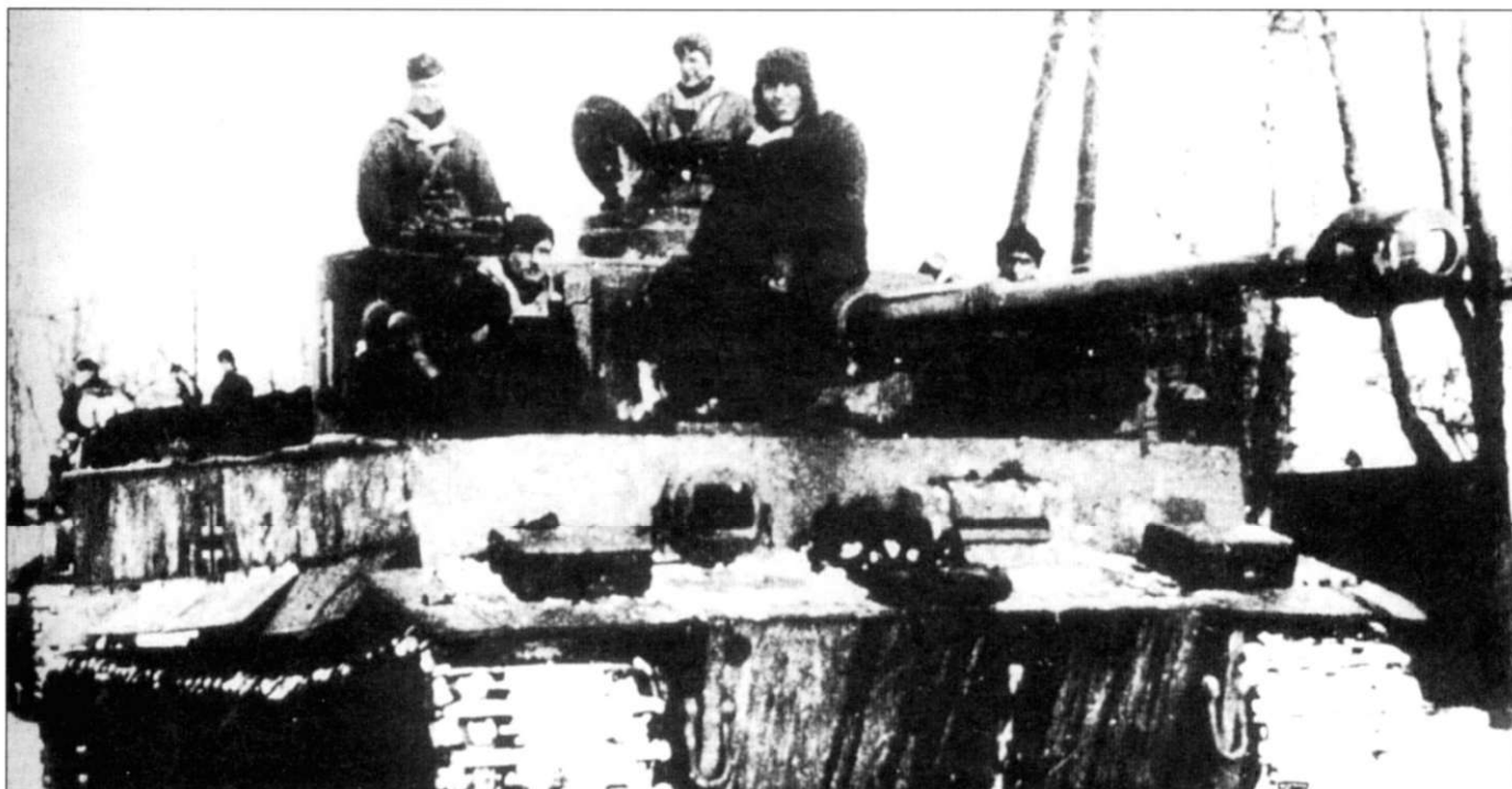
«Тигр I» с тактическим номером «111» из 503-го батальона, январь 1943 г. На наклонном лобовом бронелисте корпуса закреплены два ящика с инструментами.
