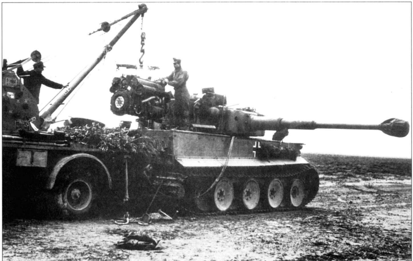
Еще один снимок того же танка. Хорошо видно снятый двигатель Майбах HL 320 P54.
