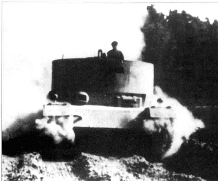
Прототип танка VK4501 (P) Tiger на испытаниях. На корпусе машины установлен бетонный весовой имитатор башни.
