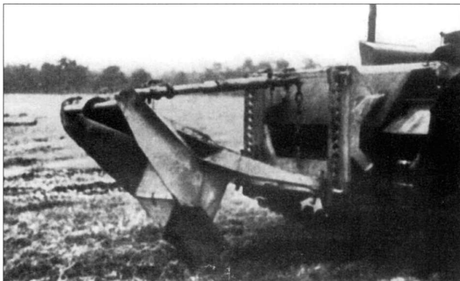
Плуг опущен в рабочее положение. На снимке можно разобрать элементы навесной арматуры плуга.
