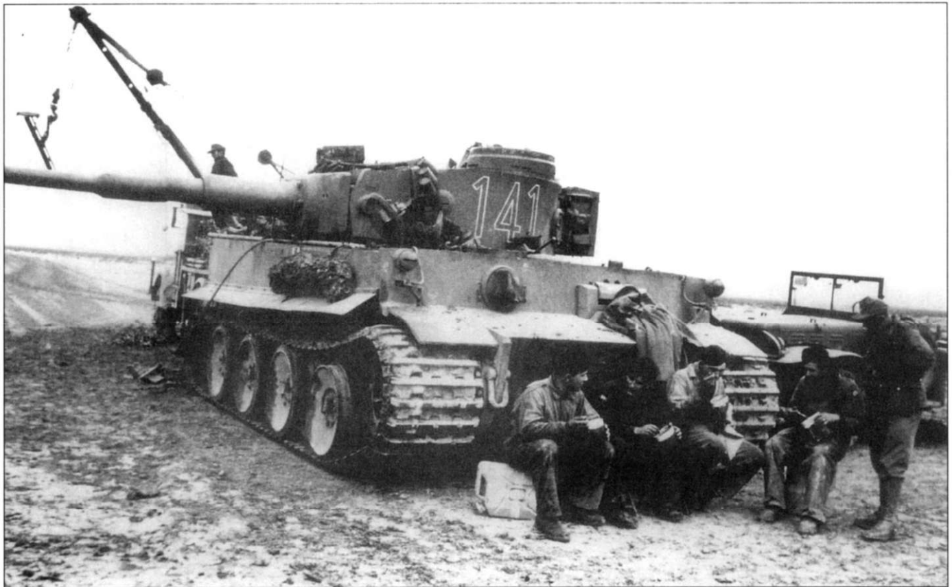
Ремонт двигателя в полевых условиях на танке «Тигр I» из schwere Panzer Abteilung 501 с тактическим номером «141», Тунис, весна 1943 г. Справа стоит трофейный автомобиль Додж WC-51, за танком - грузовик Бюссинг NAG-4500A из ремонтной роты. На грузовике смонтирован 3-тонный кран Blistein. На крюке крана зацеплена специальная рама для крепления силового блока танка. Маска пушки - раннего типа. Интересный момент - курсовая пулеметная установка в лобовом бронелисте надстройки закрыта брезентом.
