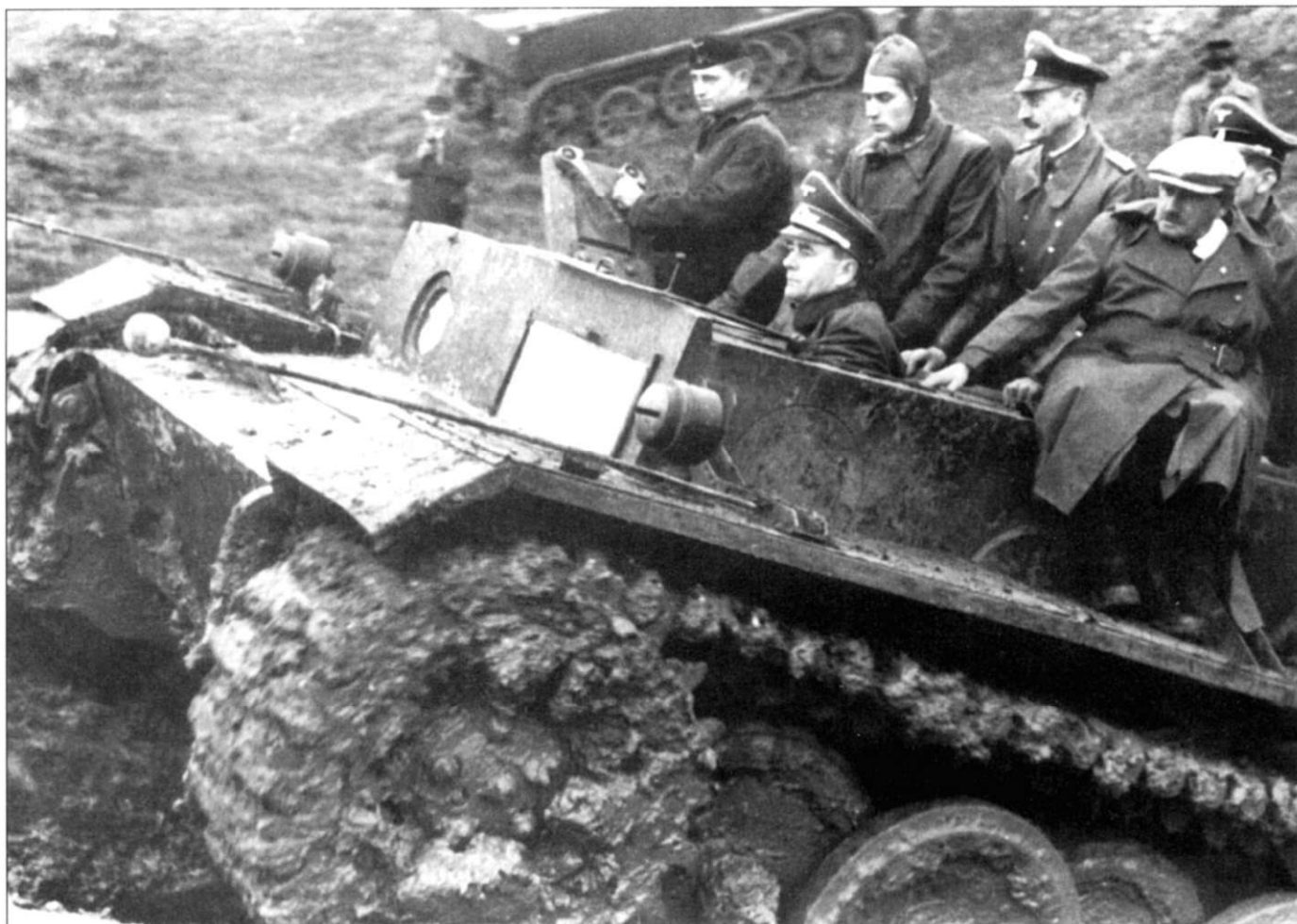
Прототип VK3601 (H), проверка на проходимость по размокнувшему грунту и пересеченной местности. Военный в фуражке - министр вооружений Альберт Шпеер. Обратите внимание на закрытые плексиглазом проемы в лобовом бронелисте корпуса, один - под люк механика-водителя, второй - под шаровую установку курсового пулемета.
