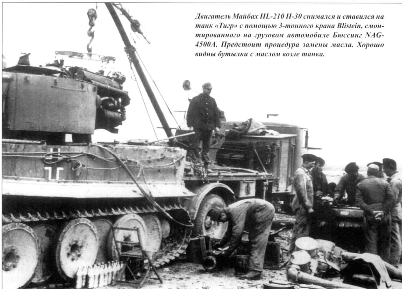
Техники сняли двигатель. Обратите внимание на Rommelkiste («рюкзак Роммеля») - закрепленный на корме башни контейнер для снаряжения. На крыше башни сложена демонтированная из моторного отделения арматура.
