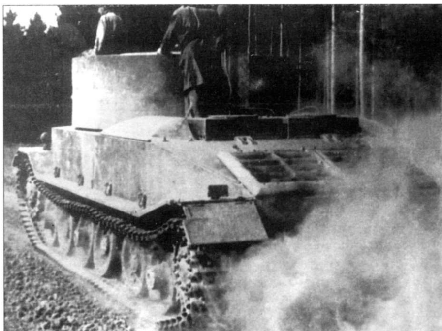
Второй прототип танка VK4501 (P) Tiger, вид сзади. На этой машине испытывался альтернативный вариант охлаждения двигателя.
