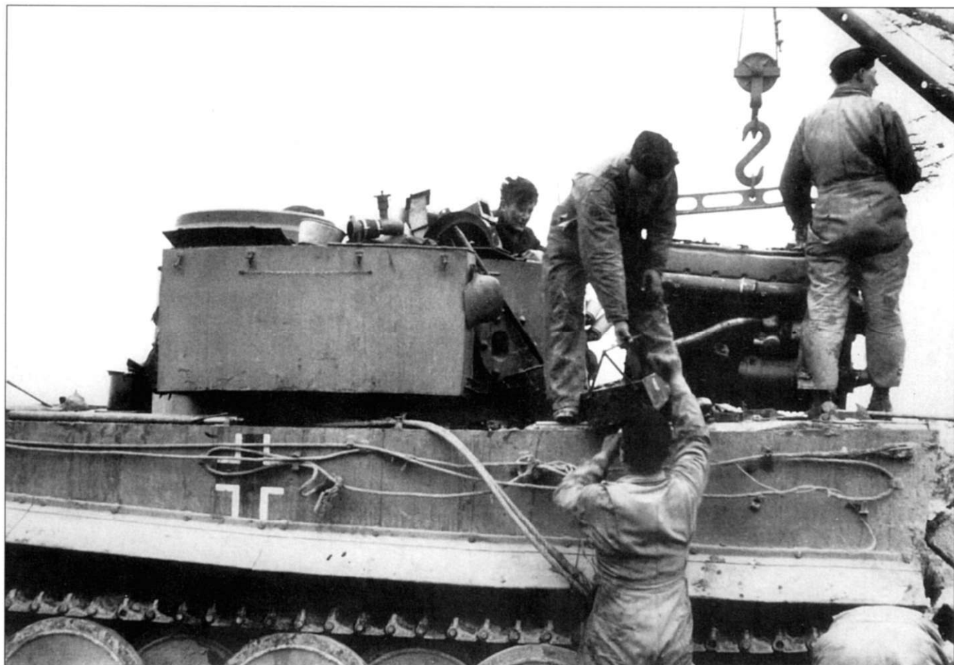
Техники сняли двигатель. Обратите внимание на Rommelkiste («рюкзак Роммеля») - закрепленный на корме башни контейнер для снаряжения. На крыше башни сложена демонтированная из моторного отделения арматура.
