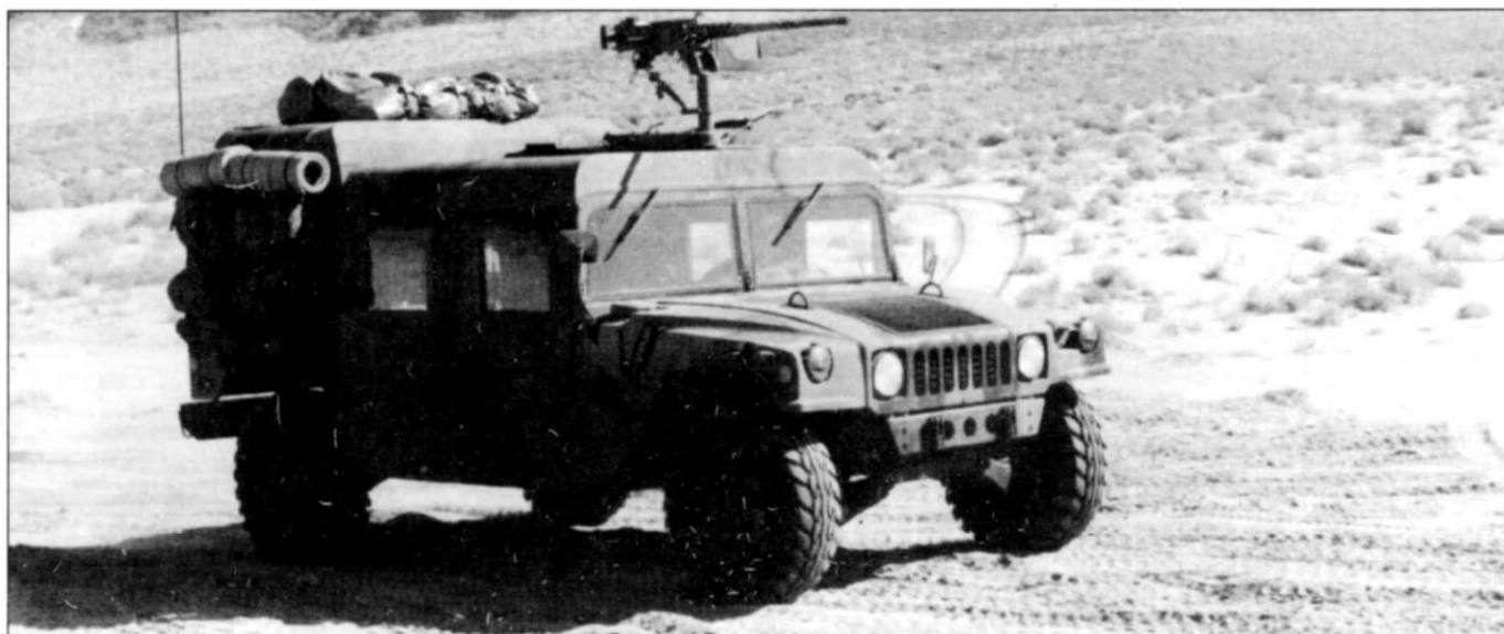
Командирский бронированный Hummer во время испытаний в National Training Center, Форт Ирвин, Калифорния. Автомобиль вооружен 12,7-мм пулеметом M2 Browning на кольцевом станке. Испытания машина проходит „по полной программе”: на крыше грузового отсека палатка, по бортам – складные постели и прочая амуниция.
