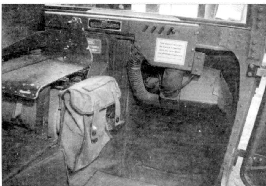
Интерьер М998. Два снимка слева представляют систему вентиляции и отопления М998. Снимки справа – фотографии привода дворника на верхней рамке ветрового стекла, сделанные изнутри салона. Справа в центре – крепление брезентового тента к переднему правому углу крыши салона.
