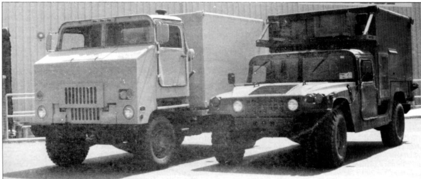
Армейский фургон M1037/M1042 Shelter Carrier («транспортёр пассажирского модуля») оснащён усиленной подвеской, обеспечивающей возможность монтажа нескольких вариантов специализированных фургонов. Прежде всего речь идет о фургонах с аппаратурой связи, передвижных вычислительных центрах и пр. На нижнем кадре слева сфотографирован грузовик Hummer, способный выполнять аналогичные функции. На снимке сверху показан интерьер силового фургона – электростанция, распределительный щит и компьютерная система управления.
