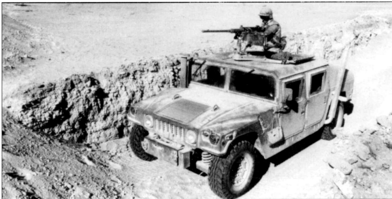
Hummer в больших количествах поступает в морскую пехоту США (U.S. Marine Corps). На снимке машина морских пехотинцев M1044 оснащена лебедкой и дополнительной броней, вооружена 12,7-мм пулеметом на кольцевом станке. Фотография сделана во время международных тактических учений BRIGHT STAR («яркая звезда») в составе многонациональных сил в египетской пустыне летом 1987 г.
