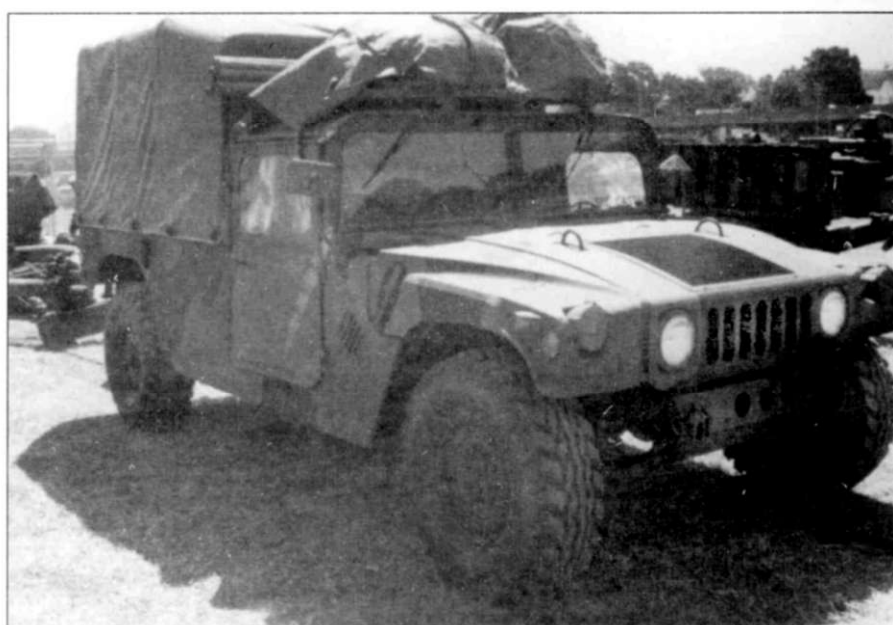
Фронтальной тягач M1069 разрабатывался для буксировки относительно легких артиллерийских систем, вплоть до 105-мм гаубиц. Машина отличалась от стандартного M988 усиленной рамой, кузовом с высокими тентовыми дугами, стеллажами для снарядных укладок.
