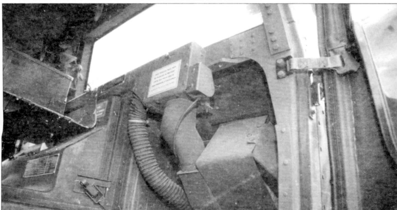
Интерьер М998. Два снимка слева представляют систему вентиляции и отопления М998. Снимки справа – фотографии привода дворника на верхней рамке ветрового стекла, сделанные изнутри салона. Справа в центре – крепление брезентового тента к переднему правому углу крыши салона.
