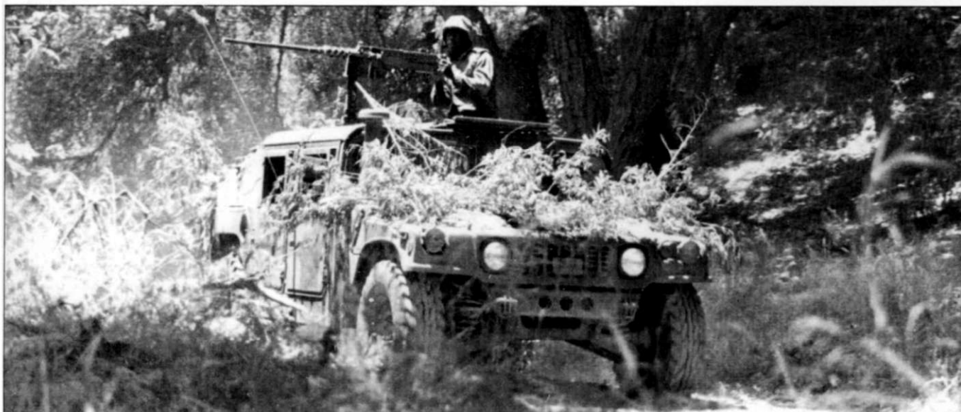
Машина HMMWV из корпуса морской пехоты участвует в учениях в Camp Pendleton в составе мобильного патруля. Отличительной особенностью машин морской пехоты являются удлиненные воздухозаборная и выхлопная трубы. Машина вооружена 12,7-мм пулеметом.
