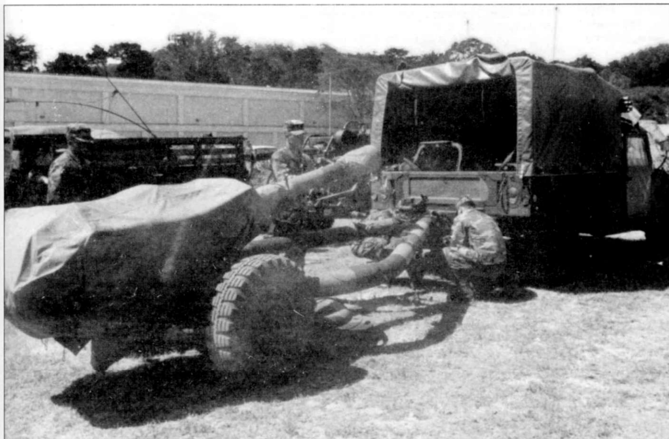
Фронтальной тягач M1069 разрабатывался для буксировки относительно легких артиллерийских систем, вплоть до 105-мм гаубиц. Машина отличалась от стандартного M988 усиленной рамой, кузовом с высокими тентовыми дугами, стеллажами для снарядных укладок.
