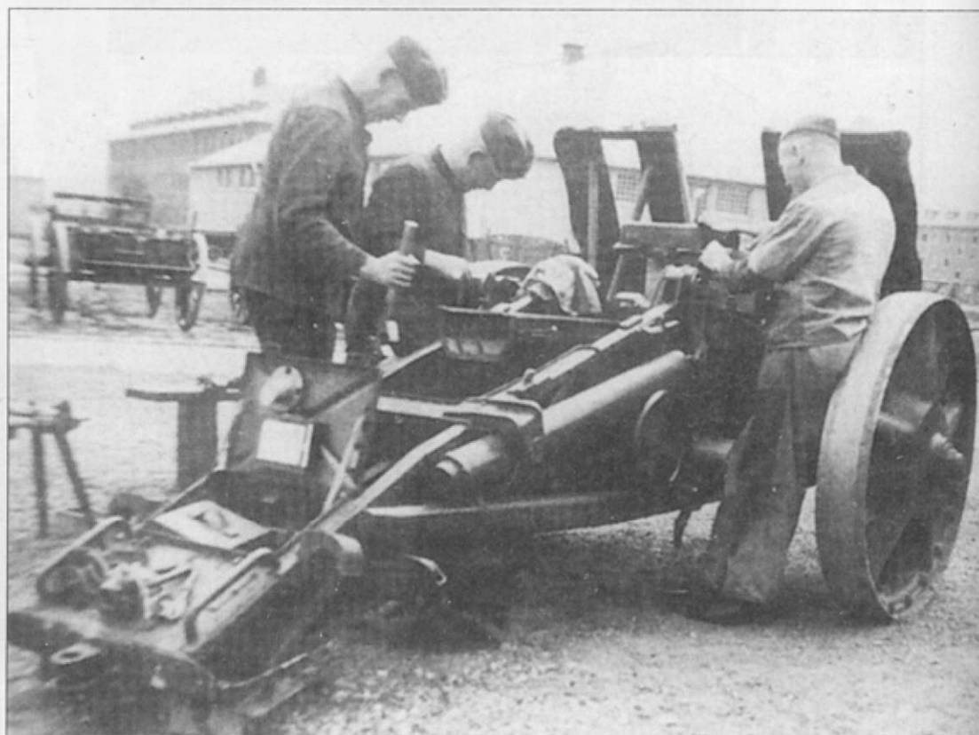
Техническое обслуживание гаубицы. На лафет установлен уровень.
