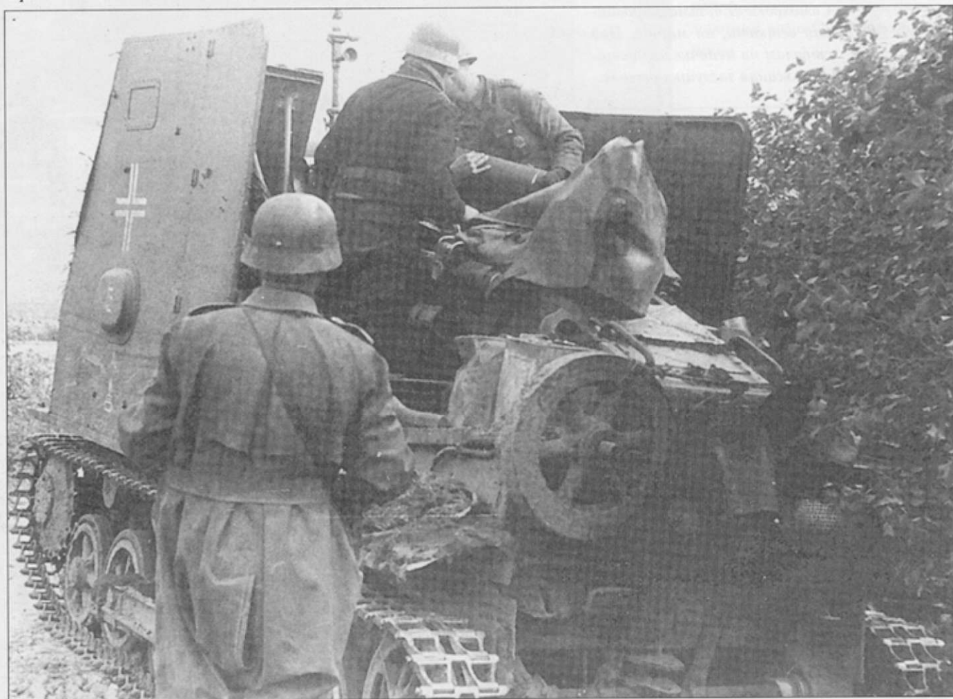
Прекрасный снимок боевого отделения самоходки «Е» из s.I.G.Кр. (mot.S.) 702, Восточный фронт. Хорошо виден запасной опорный каток.
