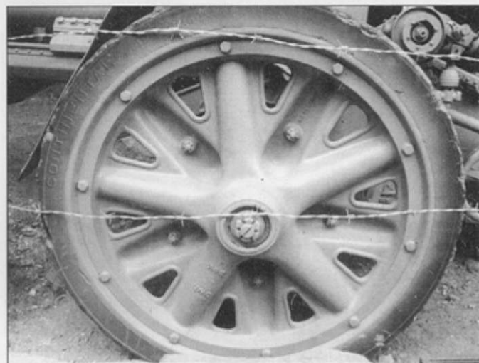
Колесо моторизованной гаубицы со штампованным металлическим диском. На резиновом бандаже сделана надпись «Continental 1100x160». На одной из спиц отштамповано «bwh 41 bev. II» и номер 58 21 106. Бронекорпак втулки отсутствует зато видна корончатая гайка, которой колесо крепится к оси.
