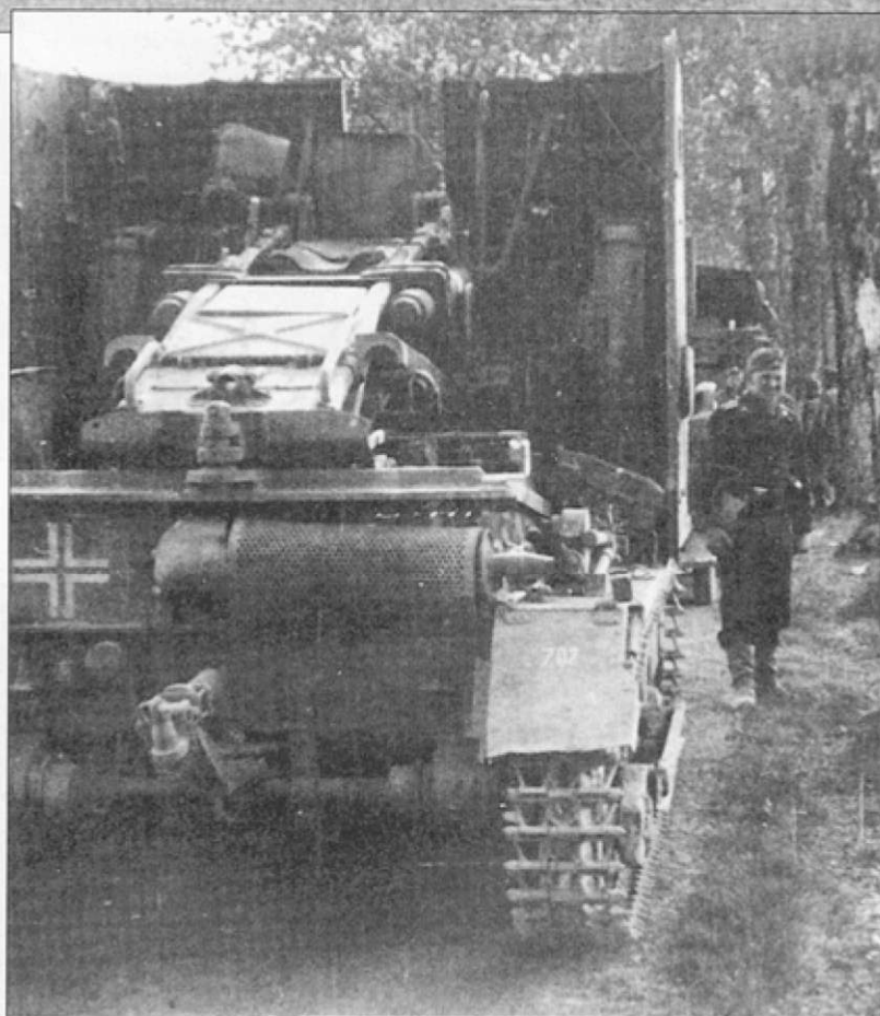
Техника s.I.G.Кр. (mot.S.) 702 перед боем. На корме машины изображен опознавательный знак в виде балканского креста, на правом заднем подкрылке самоходки – номер роты.
