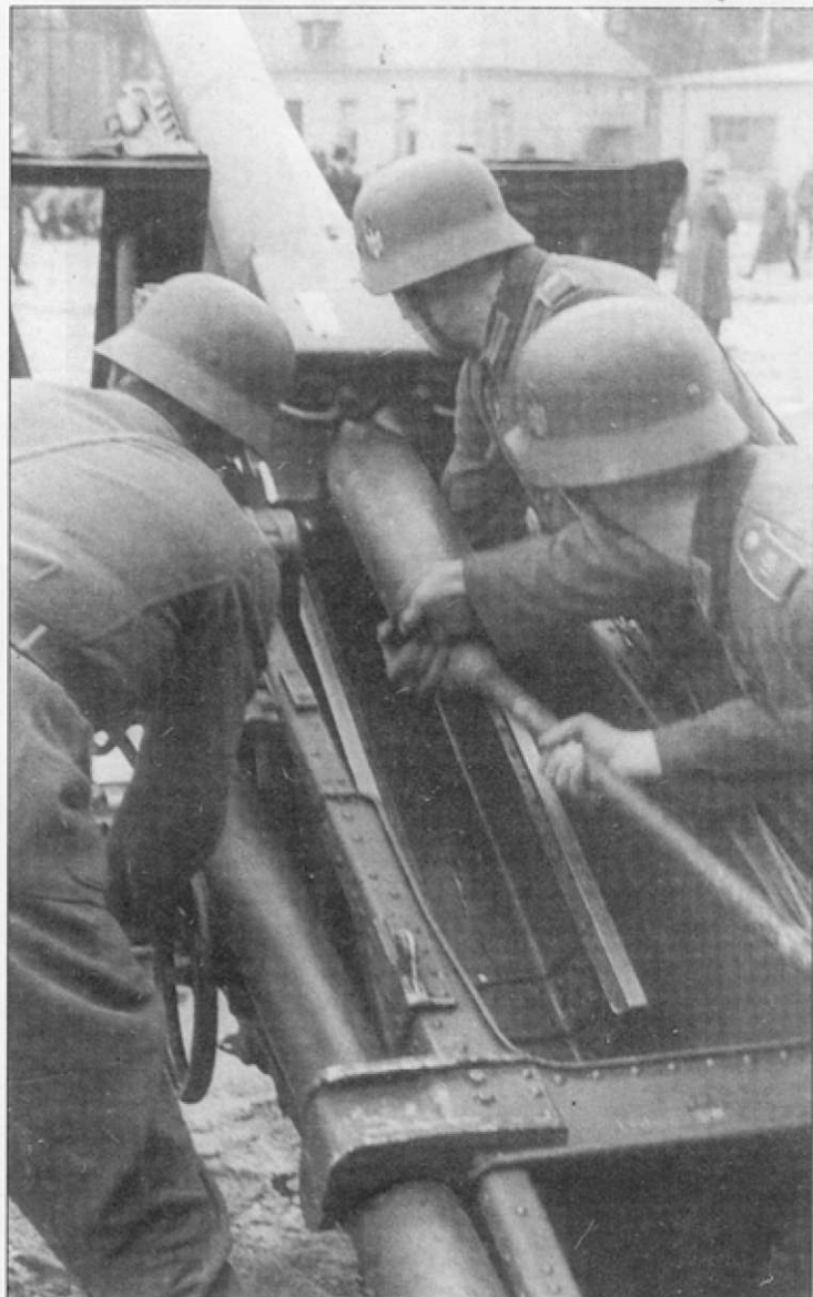
Забьют снаряд в ствол туго, а потом дернут за веревочку. Снаряд забивают заряжающие № 2 и № 5.
