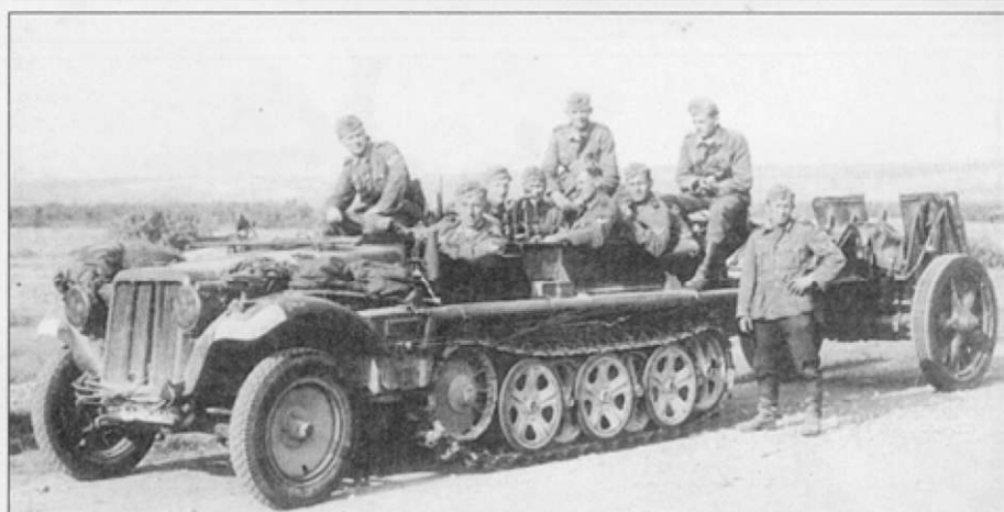
А это штатный тягач гаубицы 15 см s.I.G. 33 (mot.) – 1-тонный полугусеничный автомобиль Sd.Kfz. 10. Снимок дает представление о размерах расчета не самого мощного в мире орудия: семеро артиллеристов, водитель тягача, помощник водителя тягача.
