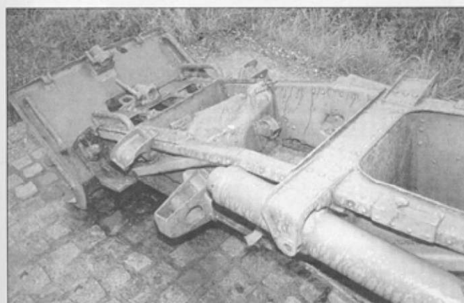
Снимок хвостовика гаубицы из Арденн. Упор переведен в боевое положение.
