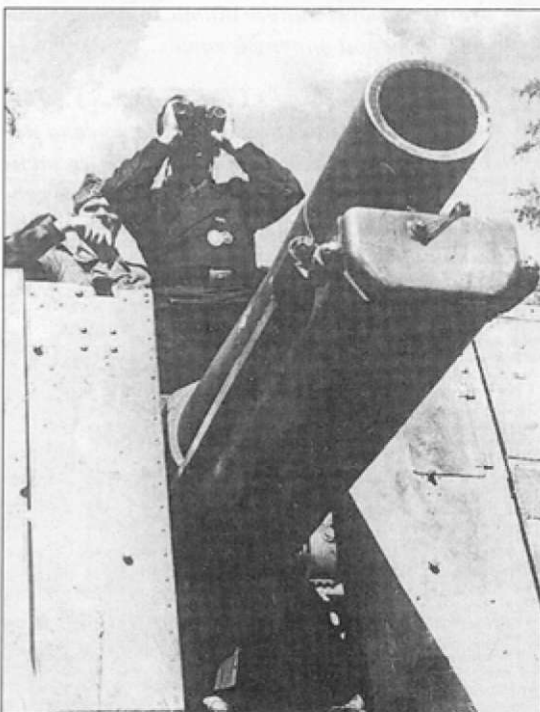
Пропагандистский кадр, сделанный в 1942 г. На снимке – самоходка из s.I.G.Кр. (mot.S.) 704. Обратите внимание на небольшую пластину, приваренную к лобовой части рубки правее орудия. Видимо – заделана пробоина.
