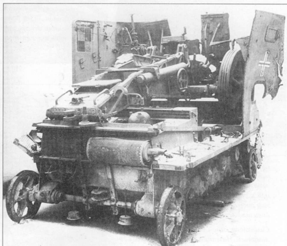
Разбитая русской артиллерией самоходка из s.I.G.Kr. (mot.S.) 704. На снимке хорошо видны элементы интерьера боевого отделения. Орудие – моторизованный вариант с резиновыми бандажками колес. Радиостанцией машина не оснащена. Лобовой лист рубки свалился на корпус шасси, закрыв смотровые приборы механика-водителя и стрелка. Люк трансмиссии снят. На щите гаубицы и на ее стволе написаны от руки мелом загадочные цифры «833667» и «14686». Второй номер является вероятно заводским номером шасси.
