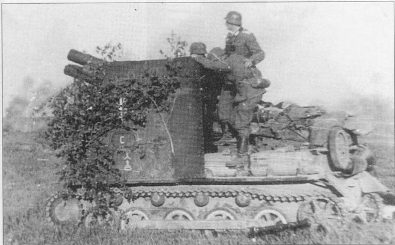
Самоходка «С» из s.I.G.Кр. (mot.S.) 702 в бою, Восточный фронт, лето 1941 г. Запасной опорный каток прикреплен к корме шасси.
