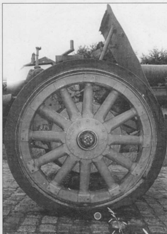
Колесо моторизованной гаубицы с деревянными спицами. На бандаже надпись «Continental 1070-160».
