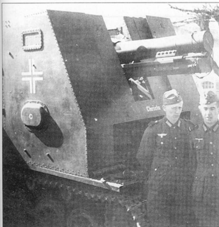
Самоходка «С», «Christa», из s.I.G.Kr. (mot.S.) 705 накануне операции «Барбаросса». На снимке хорошо просматриваются головки заклепок.
