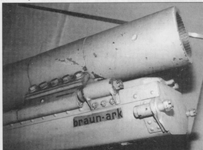
Ствол орудия и люлька, вид слева. Видны нарезы канала ствола. Лобовая часть люльки утрачена, взамен установлена металлическая пластина.
