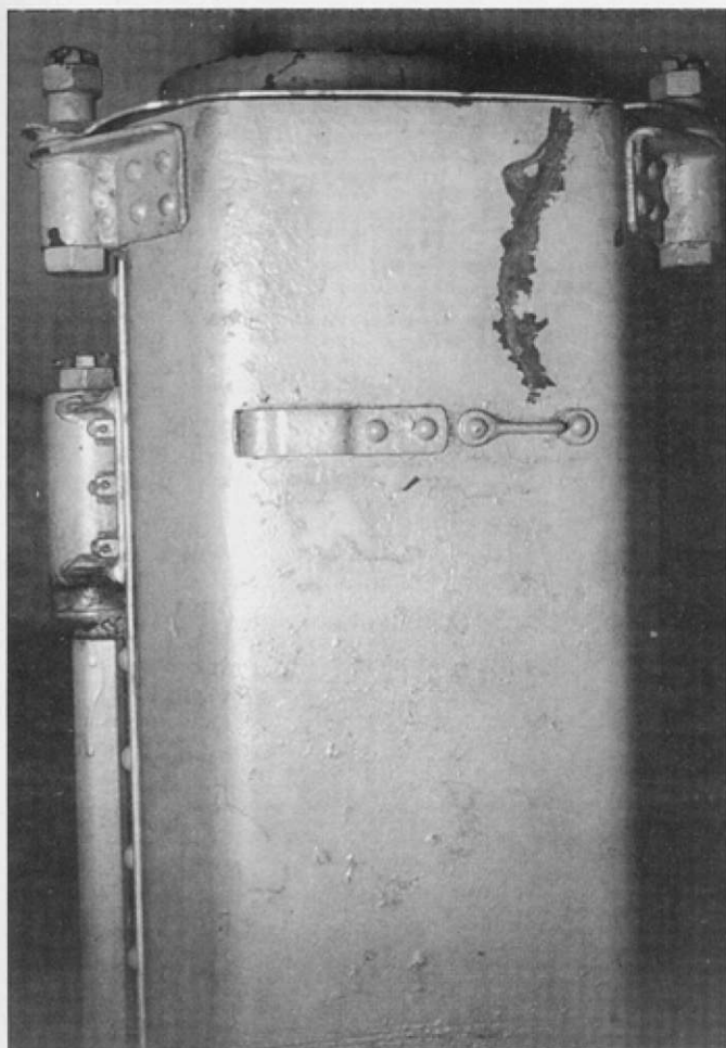
Ствол и люлька орудия, вид снизу. Справа – кожух пружины эквалибратора.
