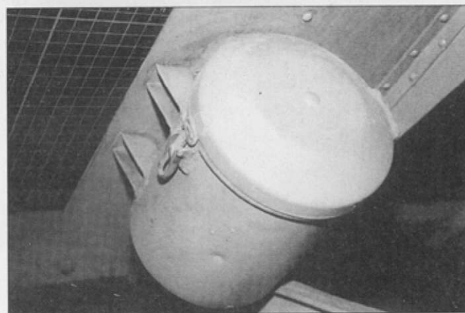
Контейнер для банника, закрепленный на левой части ору- дийного щита.
