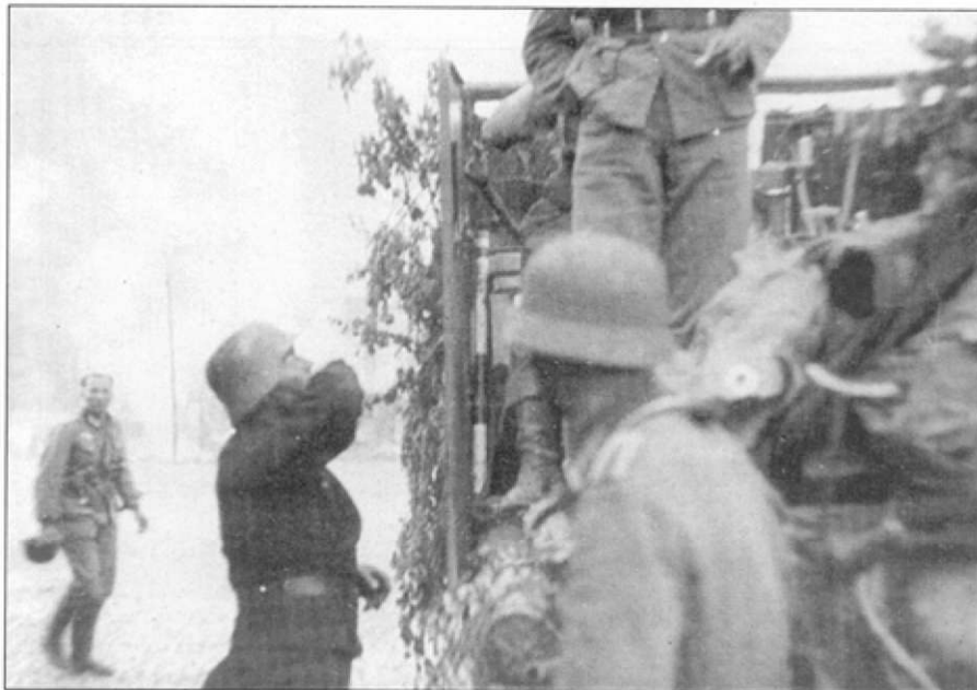
Уличный бой, в населенных пунктах самоходки использовались очень эффективно. На снимке видна полевая доработка – поперечина на рубке, усиливающая жесткость конструкции и упрощающая крепление тента. Самоходка из s.I.G.Кр. (mot.S.) 702, Восточный фронт, 1941 г.
