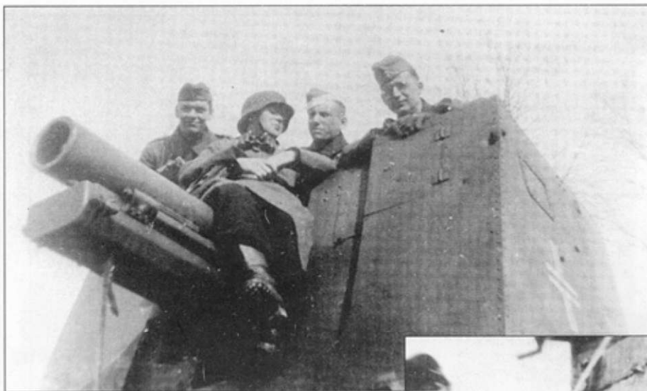
Самоходка «F» из s.I.G.Кр. (mot.S.) 702. Броня рубки повреждена осколками и пулями. Пробоины сквозные – броня защищает от солнца, но не от пуль!
