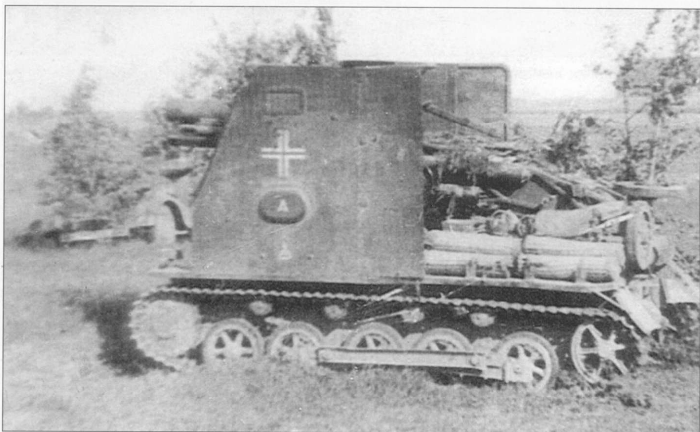
Самоходка «А» на открытом пространстве, машина замаскирована ветками. На машинах 702-й роты опорные катки крепились на корме шасси.
