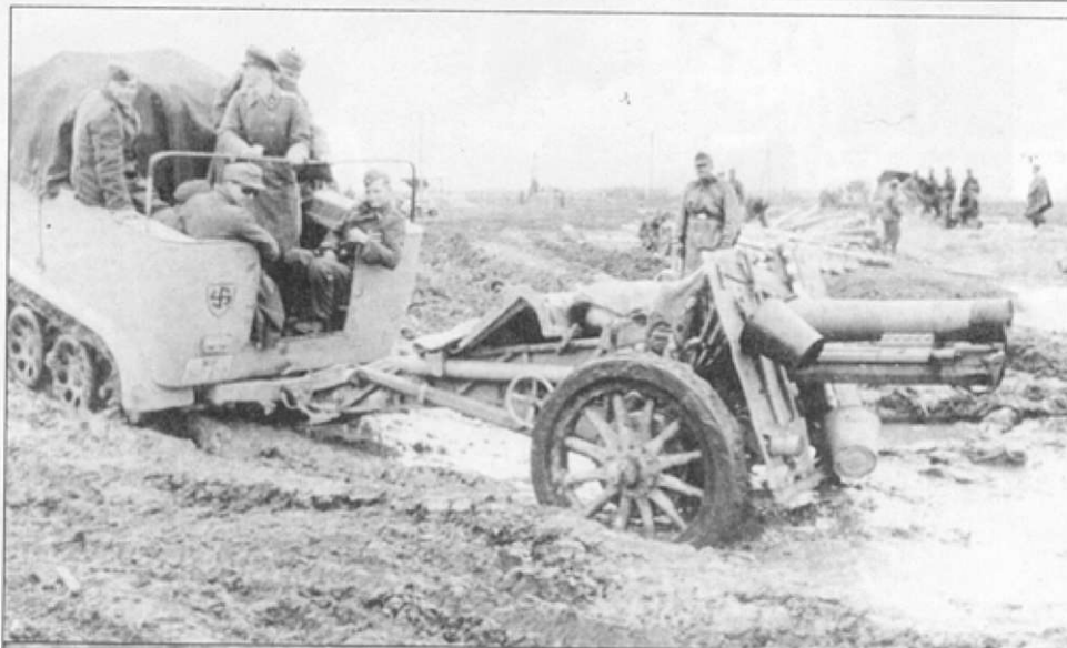
Для буксировки гаубицы по раскисшим дорогам большие, чем Sd.Kfz. 10, подходил 3-тонный полугусеничный тягач Sd.Kfz. 11. На снимке – техника из 5-й танковой дивизии СС «Викинг», весна 1944 г., район Ковеля. В то время в дивизии СС «Викинг» имелся автотранспорт, номерные знаки которого начинались с WH (вермахт). Гаубица оснащена колесами с деревянными спицами.
