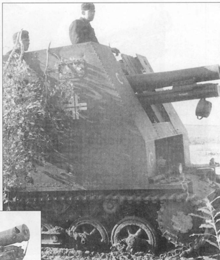
Самоходка «С» из s.I.G.Kr. (mot.S.) 706. На лобовой стенке рубки написана буква «G» - Heersgruppe G. Литера «С» также нанесена на лобовую часть рубки, позиция этой буквы по сравнению с кампанией на Западе изменилась. Исчезло название машины. Еще одна ненормальность: фара Нотек установлена не на левом предкрылке, а на бронекорпусе. Кодовых букв на бортах рубки нет.
