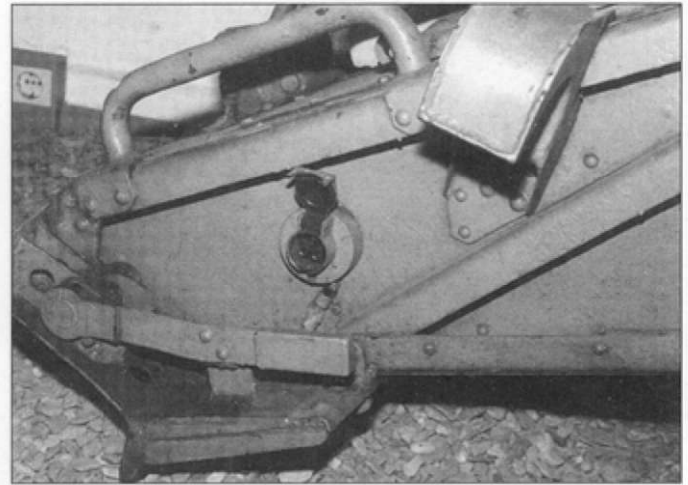
Крупный план упора в сложенном положении. В кадр попал электроразъем, необходимый при буксировке тягачом.
