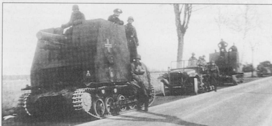
Самоходка «С» из s.I.G.Kp. (mot.S.) 702. На крыше моторного отделения, в задней части установлен запасной опорный каток. Машина промаркирована сразу двумя эмблемами 1-й танковой дивизии, использовавшимися весной 1941 г. – звезда Мерседес и крестик. Характерное расположение запасного опорного катка типично для машин 702-й роты. Фара Нотек пока еще не установлена.
