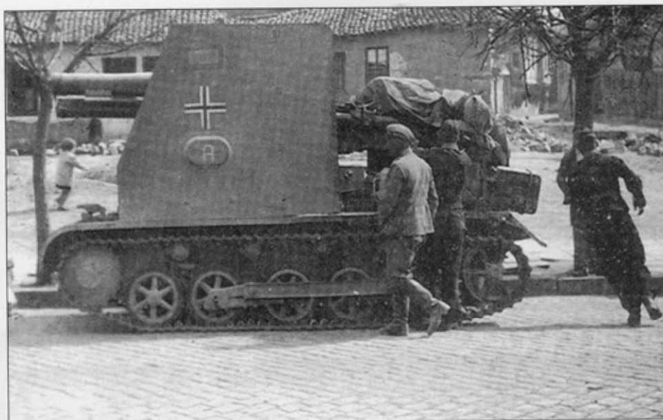
Снимок самоходки из s.I.G. Kr. (mot.S.) 701 сделан незадолго до начала кампании на Балканах в марте 1941 г. на территории Болгарии. Изменилась система маркировки самоходов роты, со времен кампании во Франции. Крест нанесен выше колпака и покрашен черной и белой красками. Литера «А» написан в «скругленном» стиле. В передней части корпуса шасси установлена фара Нотек.
