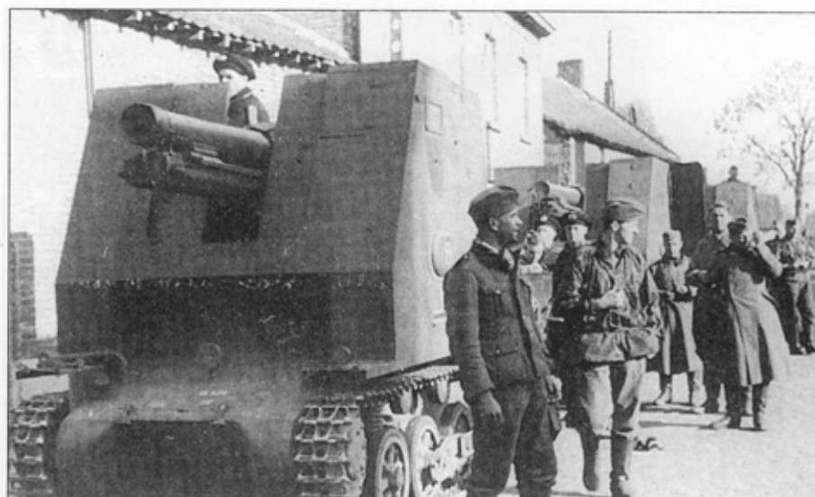
Колонна самоходок из s.I.G.Kr. (mot.S.) 701, первые дни кампании на Западе. На шасси самоходки «В» можно различить заводской номер шасси «13628» и номер орудия «22».
