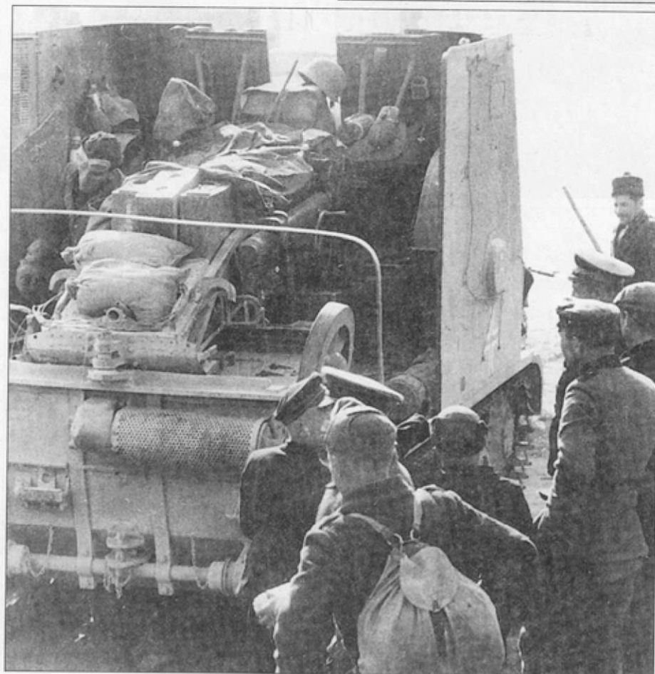
Снова «Alter Fritz», но в рубке установлено орудие «В», «Bismarck». Радиооборудования машина не имеет.
