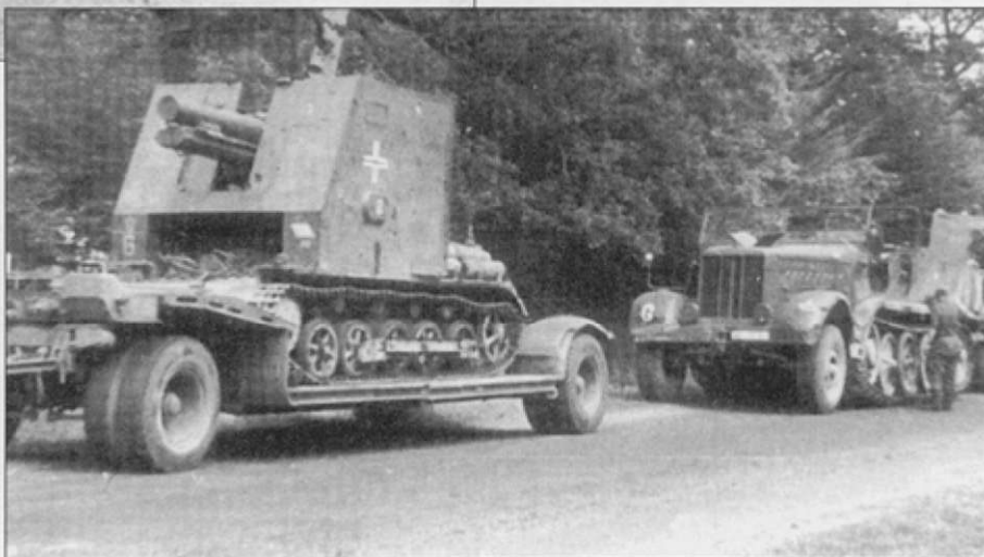
Перевозка самоходки из s.I.G.Кр. (mot.S.) 702 1-й танковой дивизии. На левый задний подкрылок установки нанесена литера «G» - Heeresgruppe "G" и дубовый лист – эмблема 1-й танковой дивизии. Типично для 702-й роты закреплен на корме запасной опорный каток. На снимке слева – колонна автомобилей Круп Protze из противотанкового батальона пехотной дивизии.
