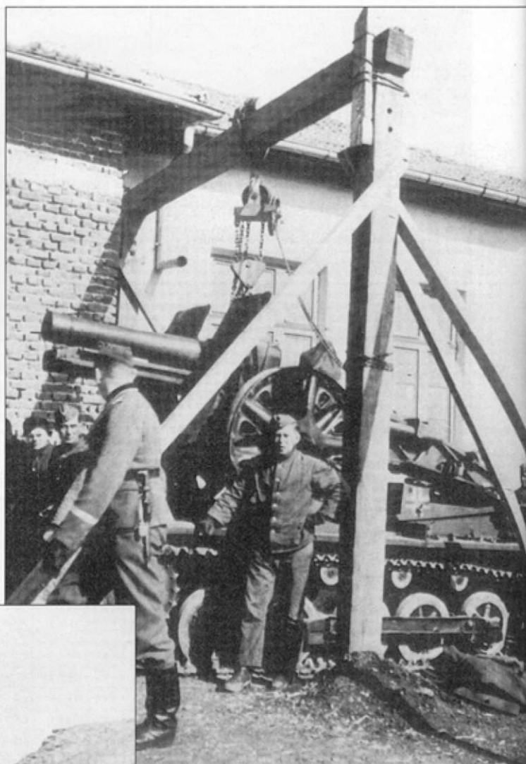
Демонтаж гаубицы с самоходки с помощью козлового крана, рубка уже снята. Для демонтажа орудия обязательно вначале снималась бронерубка. Крест нанесен в крайне необычном месте.
