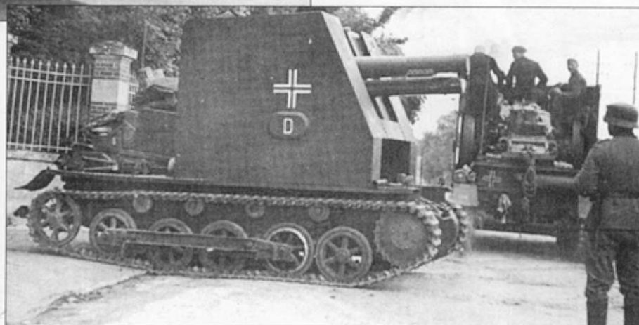
Самоходка «А» из s.I.G.Кр. (mot.S.) 704. Для усиления защищенности лобовой части использованы гусеничные траки.
