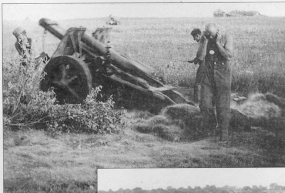
Гаубица 15 см s.I.G. 33 на огневой позиции в поле. Произведен выстрел, ствол откатывается назад. По соображениям безопасности в момент выстрела у орудия остались лишь командир и наводчик.
