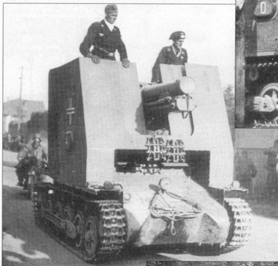
Самоходка «А» из s.I.G.Кр. (mot.S.) 704. Для усиления защищенности лобовой части использованы гусеничные траки.
