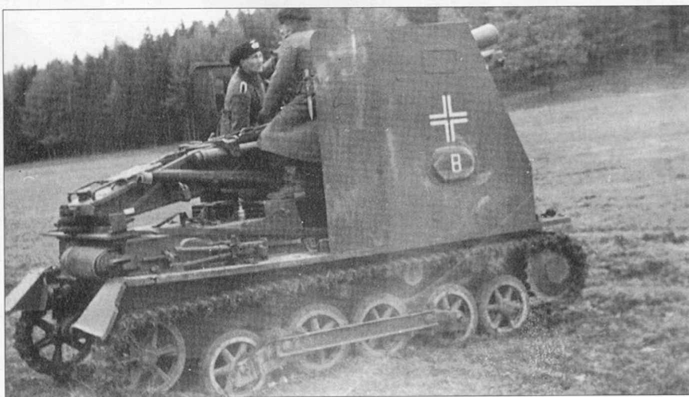
Самоходка «B» из s.I.G.Кр. (mot.S.) 704. Станины гаубицы закреплены для большей устойчивости на крыше моторного отделения.
