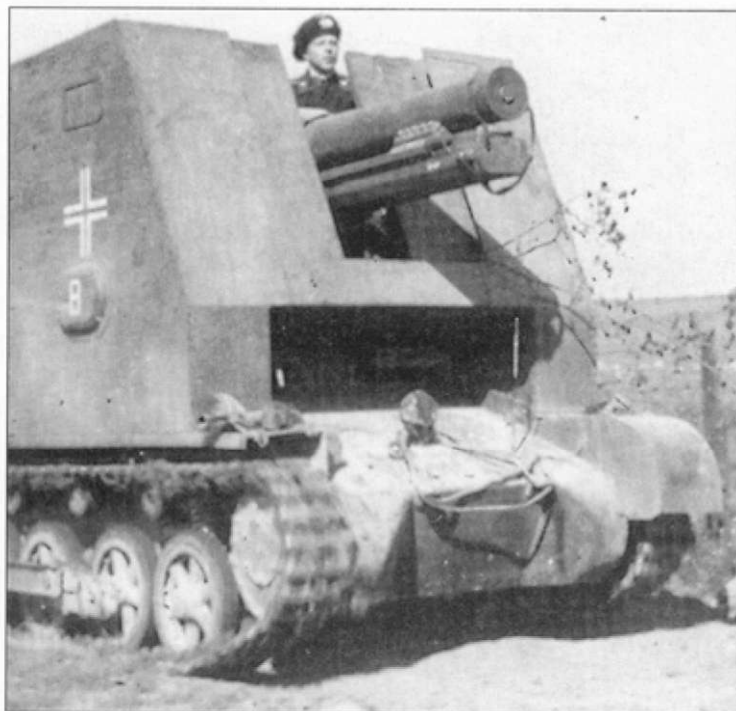
Самоходка «В» из s.I.G.Кр. (mot.S.) 704 во время кампании на Западе. Правый передний подкрылок снят, логика простая: правые подкрылки чаще повреждались от столкновений с придорожными объектами – деревьями, столбами и т.д.
