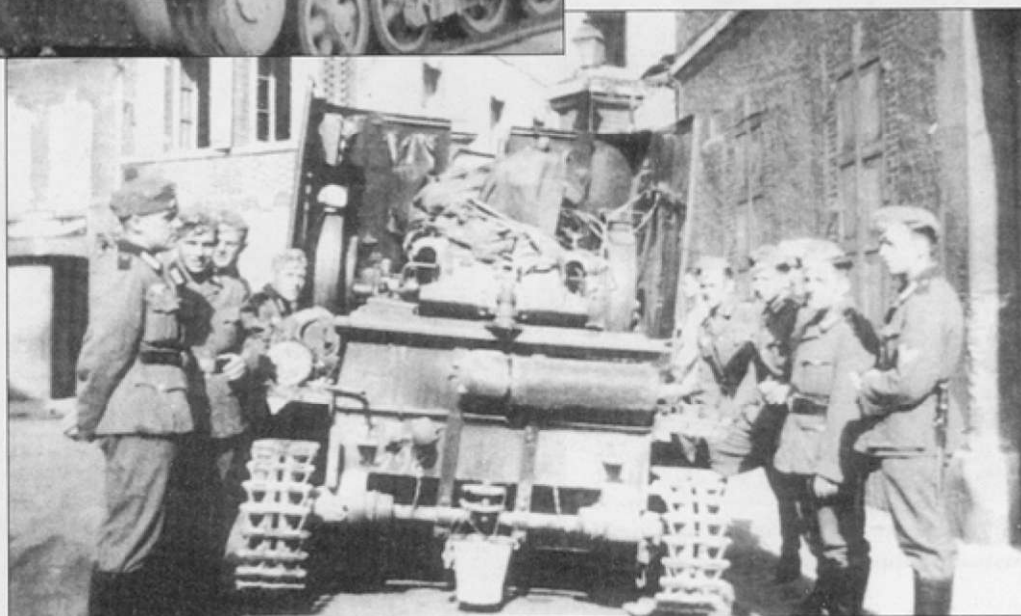
Фотография той же самоходке, но выполненная позже. Машина покрыта плотным слоем пыли. По непонятным причинам снят люк доступа к трансмиссии.
