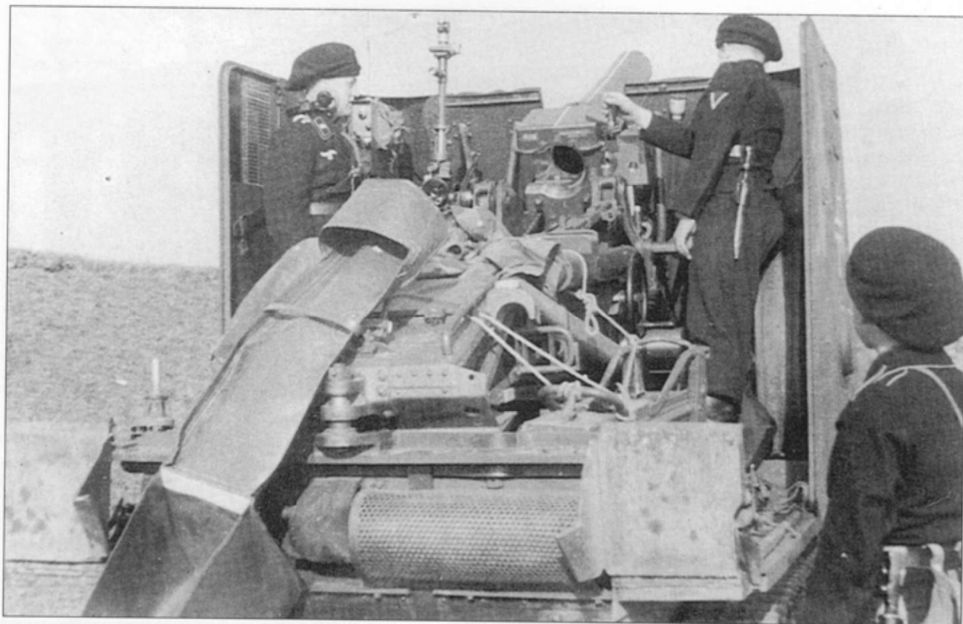
Тренировка экипажа самоходки из s.I.G.Kr. (mot.S.) 705 накануне вторжения во Францию. Тент, которым рубка закрывается сверху, свернут и уложен в задней части машины. Судя по ободам колес, в данном случае на танковое шасси водружен конный вариант гаубицы. На стенке рубки закреплена портативная радиостанция, но не стандартная – вероятно какой-то опытный образец.
