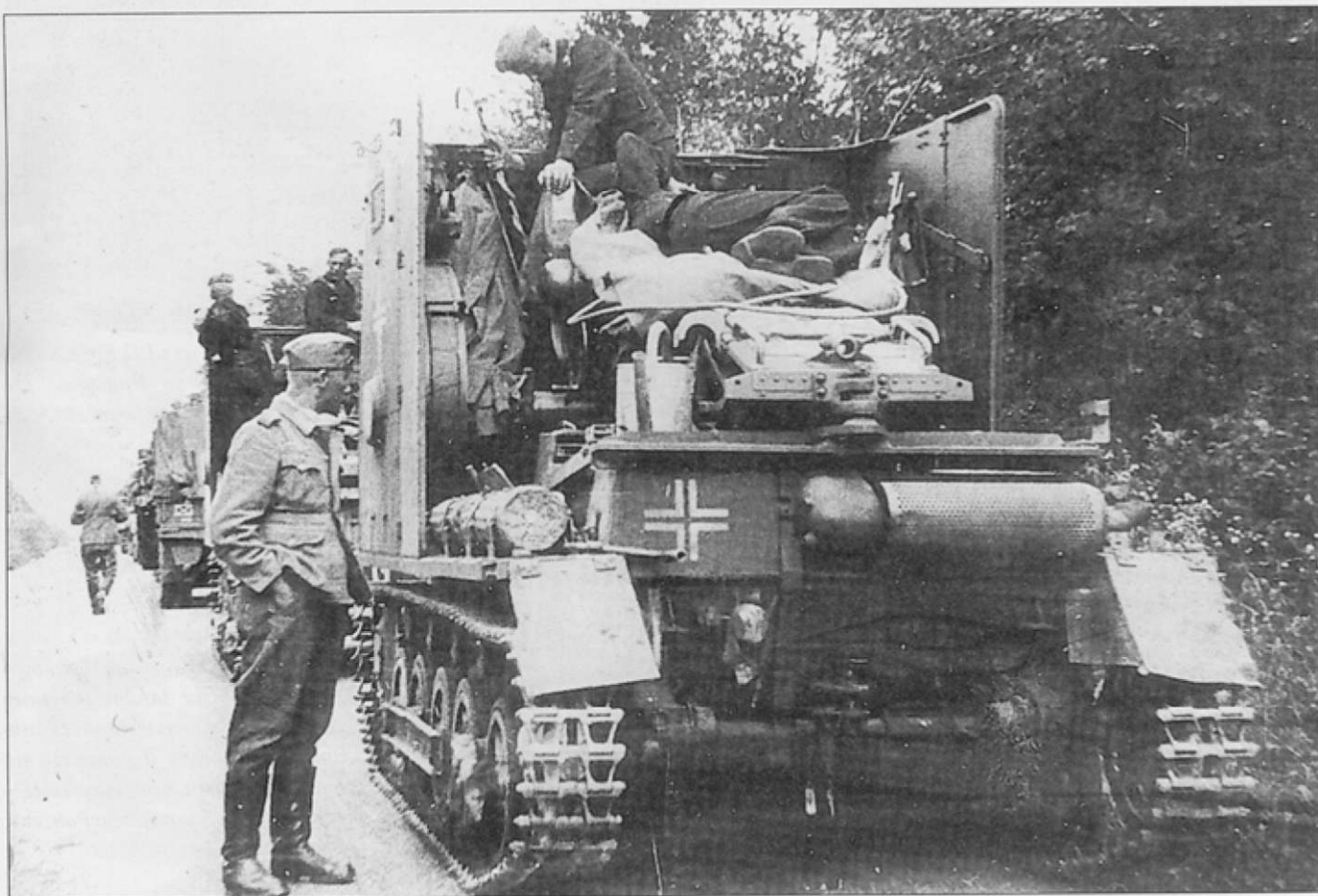
Самоходка «Edith». На орудийном щите нарисован крест и дата гибели, 29 мая 1940 г., одного из членов экипажа. Левое ведущее колесо снято. Демонтированы оба передних подкрылка. Под подкрылки набивалось много грязи.
