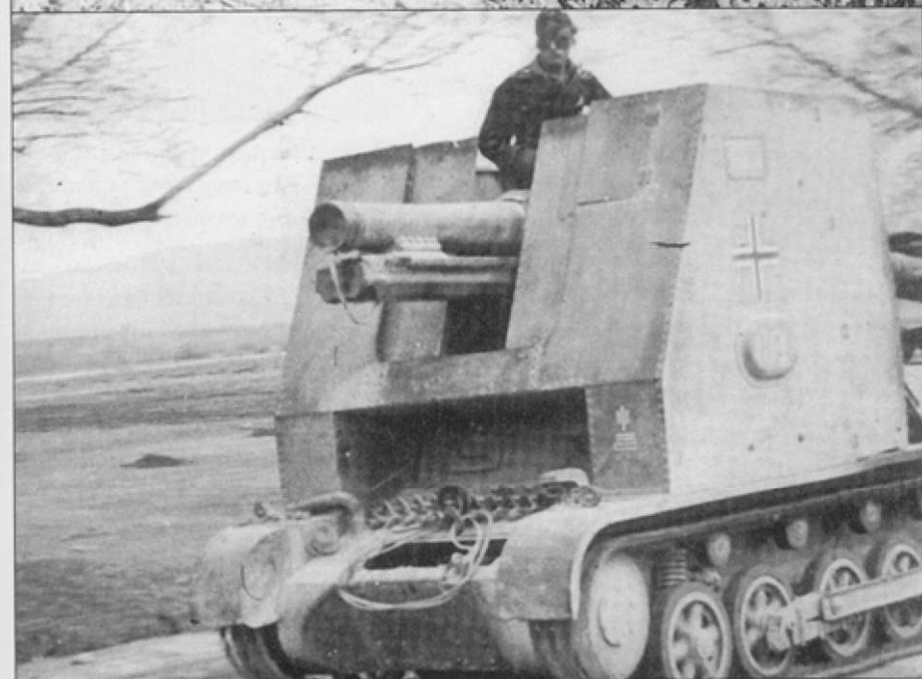
Фотография той же самоходке, но выполненная позже. Машина покрыта плотным слоем пыли. По непонятным причинам снят люк доступа к трансмиссии.
