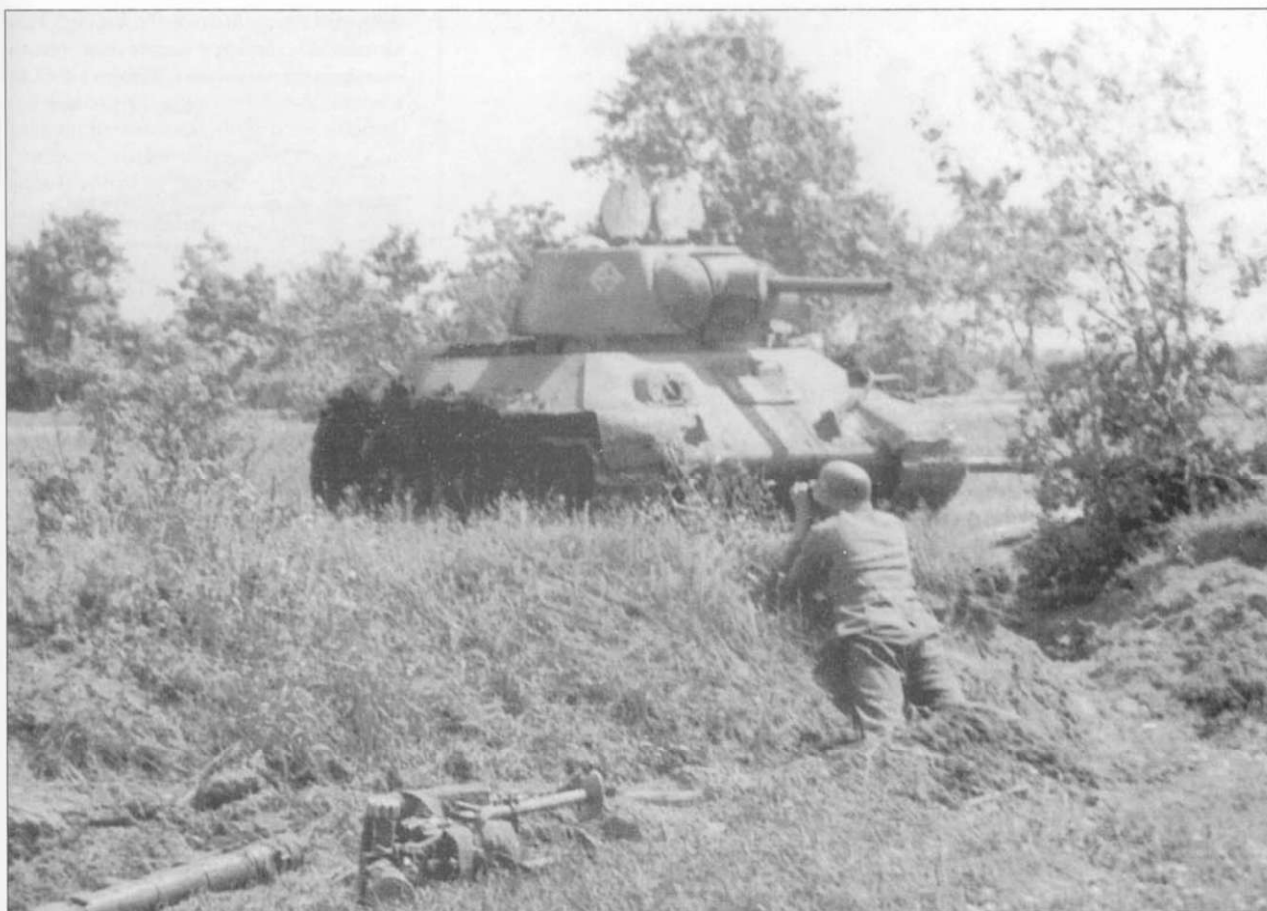
Немецкий минометчик наблюдает за передним краем советских войск. Слева лежит миномет калибра 81 мм. На заднем плане подбитый или брошенный Т-34 с «шестигранной башней». Обратите внимание, что на лобовом пулемете нет броневой маски. Традиционно, антенный ввод заглушен, так как радиостанции нет.
