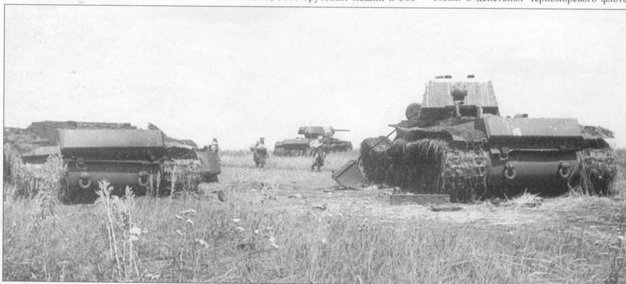
КВ-1 позднего выпуска с прямыми задними листами, сварными и литыми башнями. КВ-1 часто ругали за ненадежность трансмиссии. Не всегда эта критика была обоснованной. Использование тяжелых танков на слабом и влажном грунте, как на фото, конечно, приводило к выходу их из строя, но это вина командиров, а не конструкторов.
