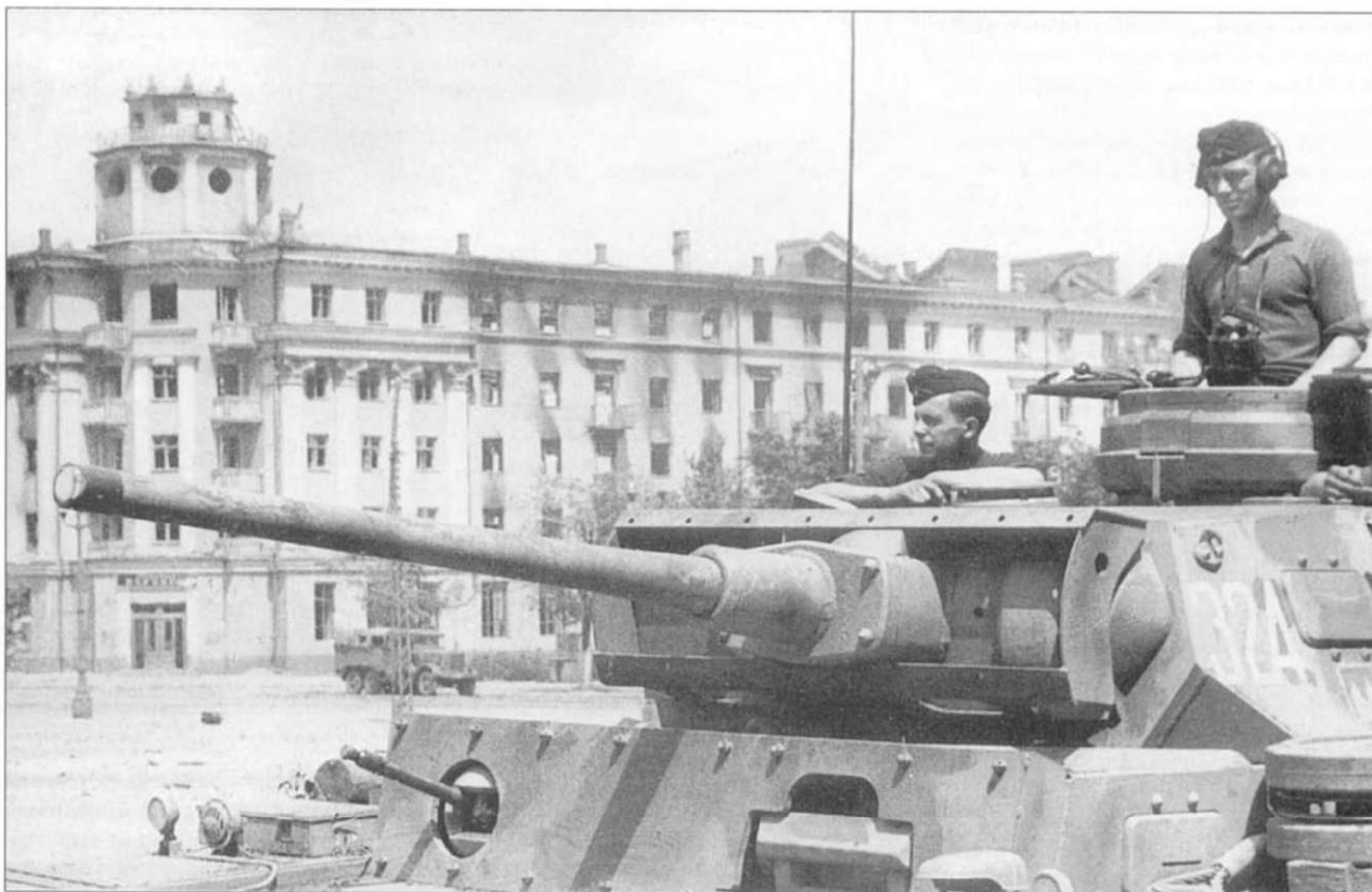
Танк Pz III L из состава 16-й танковой дивизии на улице Воронежа. Танк имеет экранированную броню в лобовой части корпуса, а на маске пушки она снята.
