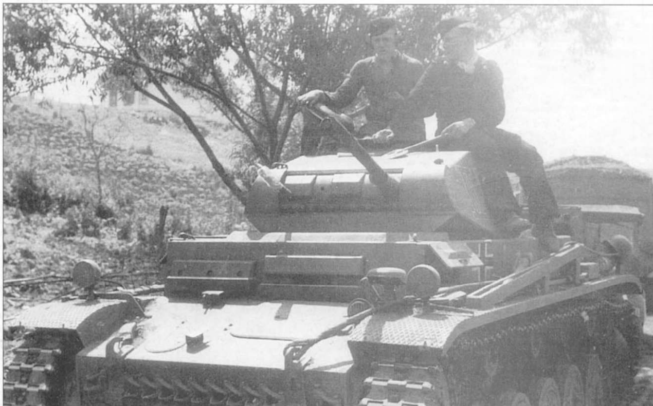
Командирский Pz II из состава 201 танкового полка 23-й танковой дивизии. Эта дивизия была сформирована в 1941 году в районе Парижа. Отсюда ее знак, нанесенный на бронетехнику — Эйфелева башня. На этом танке пушка отсутствует, а ее ствол заменен макетом для увеличения места в башне.
