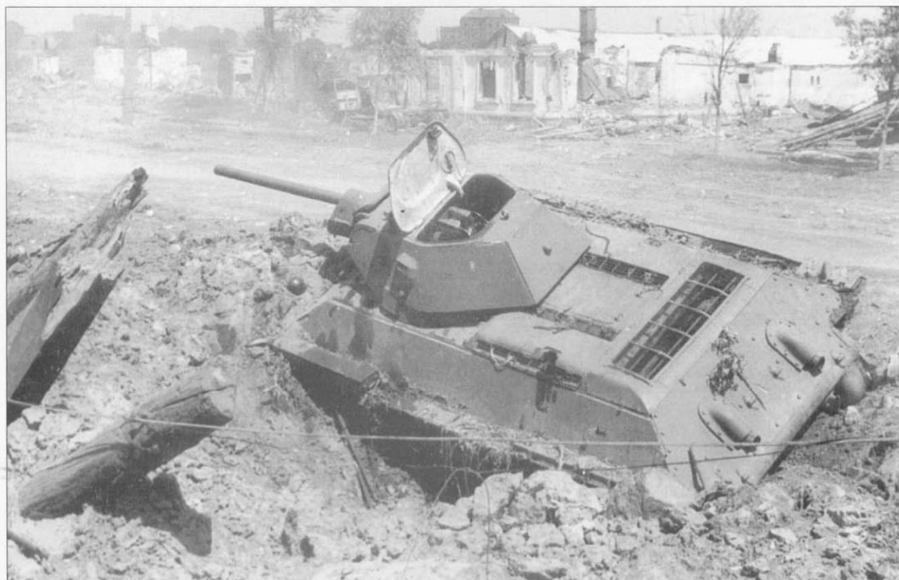
Подбитый Т-34 производства СТЗ. Хорошо виден корпус, собранный на шипах. Башня со скосами в лобовой части и приваренным, а не съемным кормовым листом. Крепления для прямоугольных наружных топливных баков уже отсутствуют.
