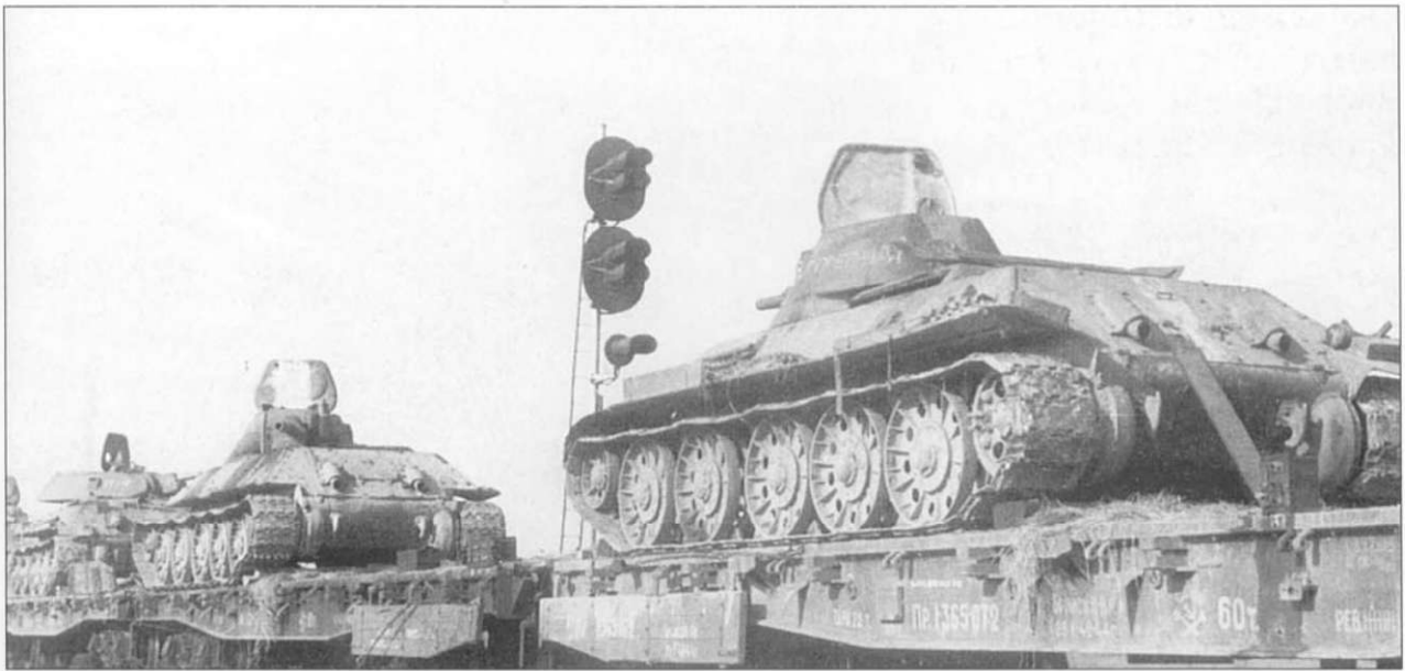
Захваченные немцами на платформах советские танки Т-34 производства СТЗ. Две передние машины имеют литую башню, задняя – сварную. Белая полоса на крышах башен служила для опознавания с воздуха. На переднем танке эта полоса нанесена и на задний лист корпуса.
