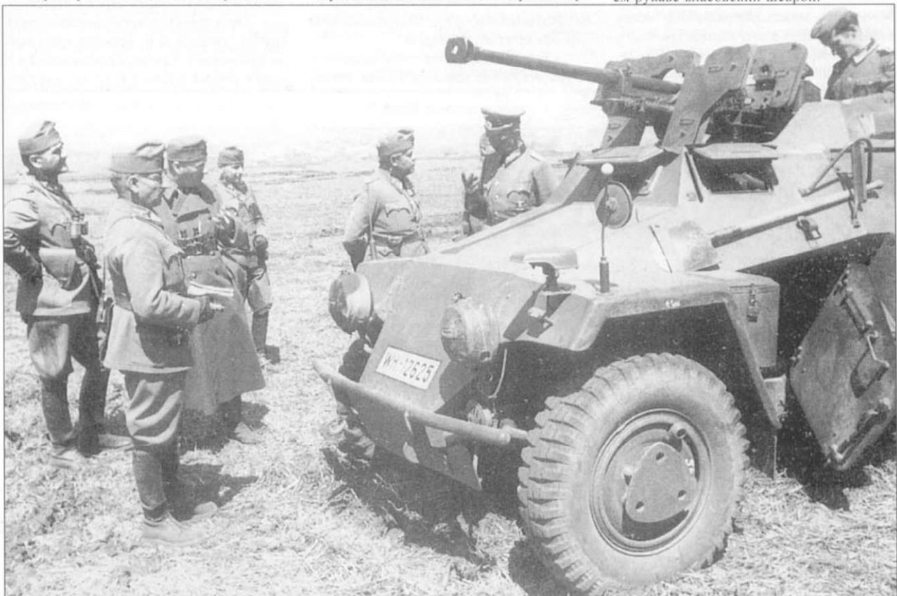
На южном фронте немцы используют войска всех своих сателлитов, за исключением финнов. На этом снимке румынские офицеры рассматривают немецкую разведывательную машину SdKfz 221. Эта машина оснащена противотанковой пушкой с коническим стволом 2,8 см, sPzB 41. Бронепробиваемость этой пушки, имевшей диаметр ствола у казенника 28 мм и у дульного среза 20 мм, достигала 50 мм на дальности 500 метров.
