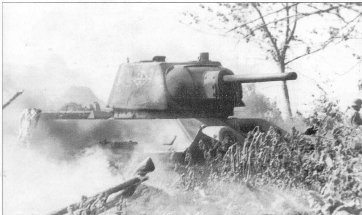
Подбитый или брошенный Т-34 с самой ранней «шестигранной» башней. Ранние башни этого типа не имели поручней по бортам и в них отсутствовали pistolетные бойницы под смотровыми щелями.
