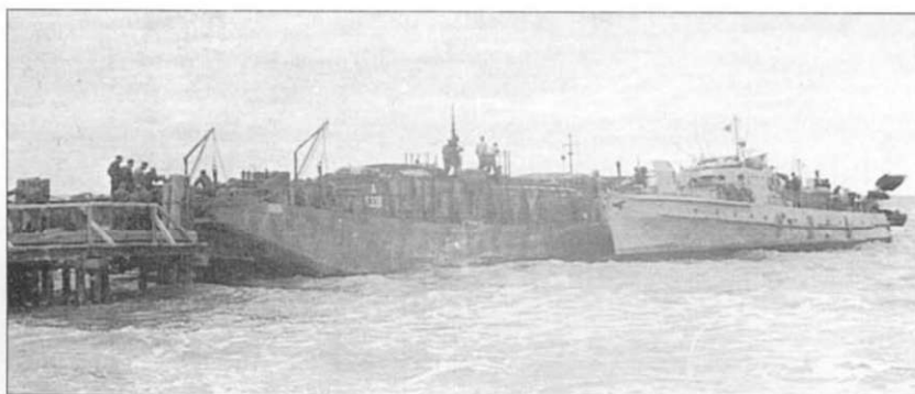
Немцы активно использовали баржи с пришвартованными к ним катерами. Баржа несла груз, а катер обеспечивал буксировку. Это было удобнее, чем тянуть баржу на буксире.
