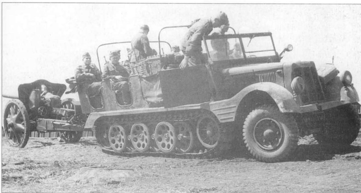
Механизированная немецкая артиллерия на марше: Тягач Zgkw 5-tonne Typ BN L 9, SdKfz 6/1, буксирует легкую 105 мм гаубицу leFH 18.
