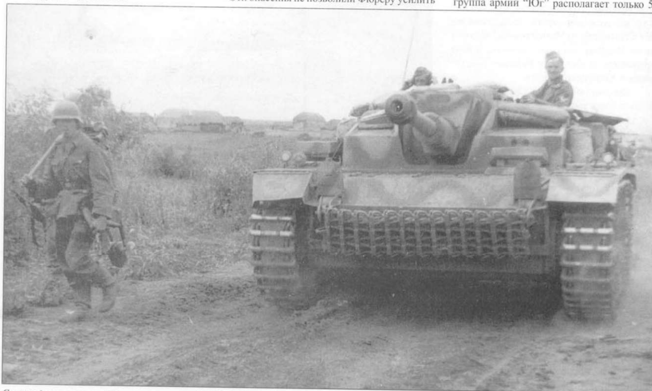
Самоходная пушка «Штурмгеццутц» 40 F (Sd.Kfz.142/1). Наконец у немецких танкистов появились машины, превосходящие по мощи вооружения советские танки.
