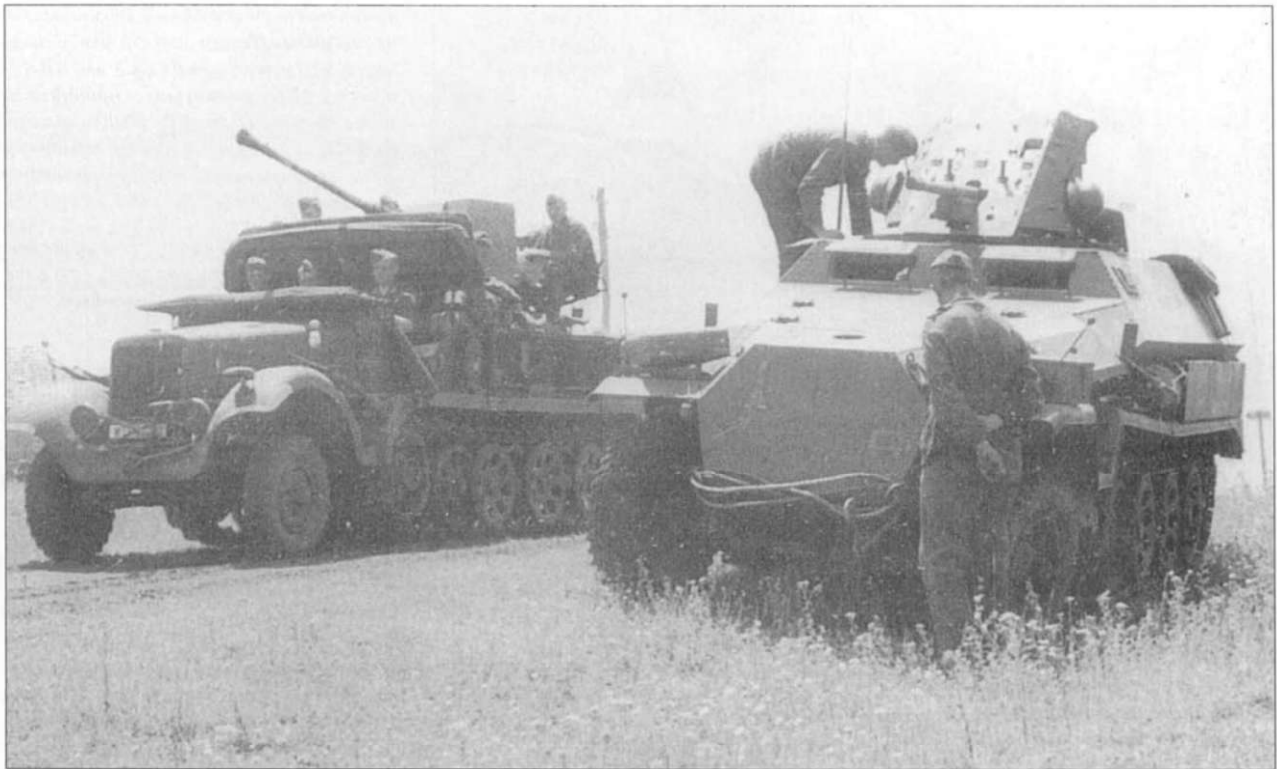
Немецкие полугусеничные машины, переоборудованные в самоходные пушки. Справа SdKfz 251/10, оснащенный 37 мм противотанковой пушкой. Слева полугусеничный тягач SdKfz 6 оснащенный 37 мм зенитной пушкой.
