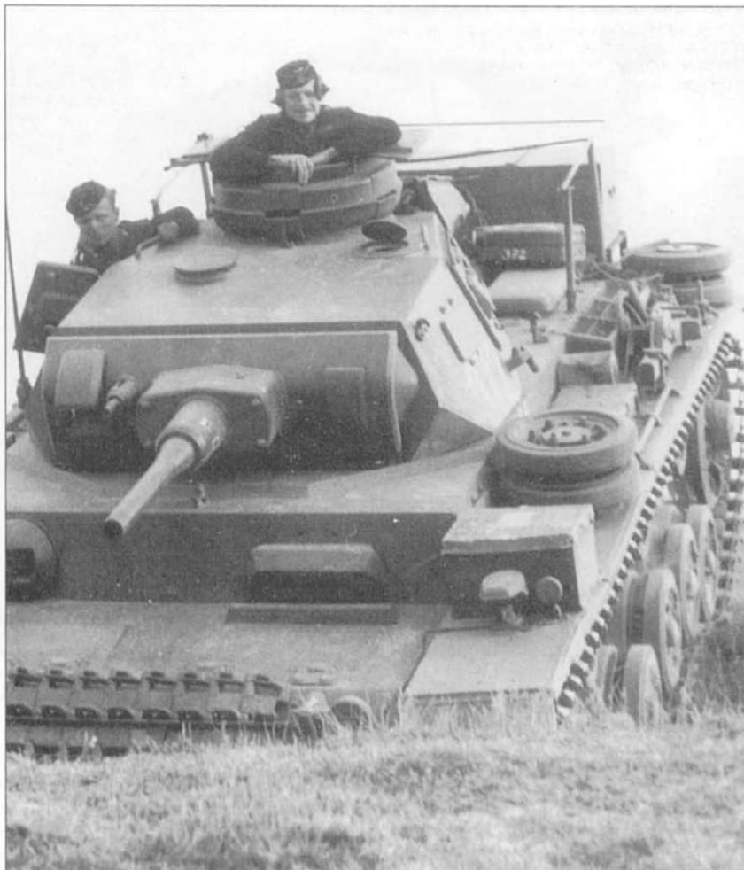
Командирский танк Pz.Bef.Wg III. Наличие рамочной антенны издавало эти машины. Поэтому летом 1942 года рамочные антенны с командирских танков сняли. На башне этого танка виден тактический номер 372.
