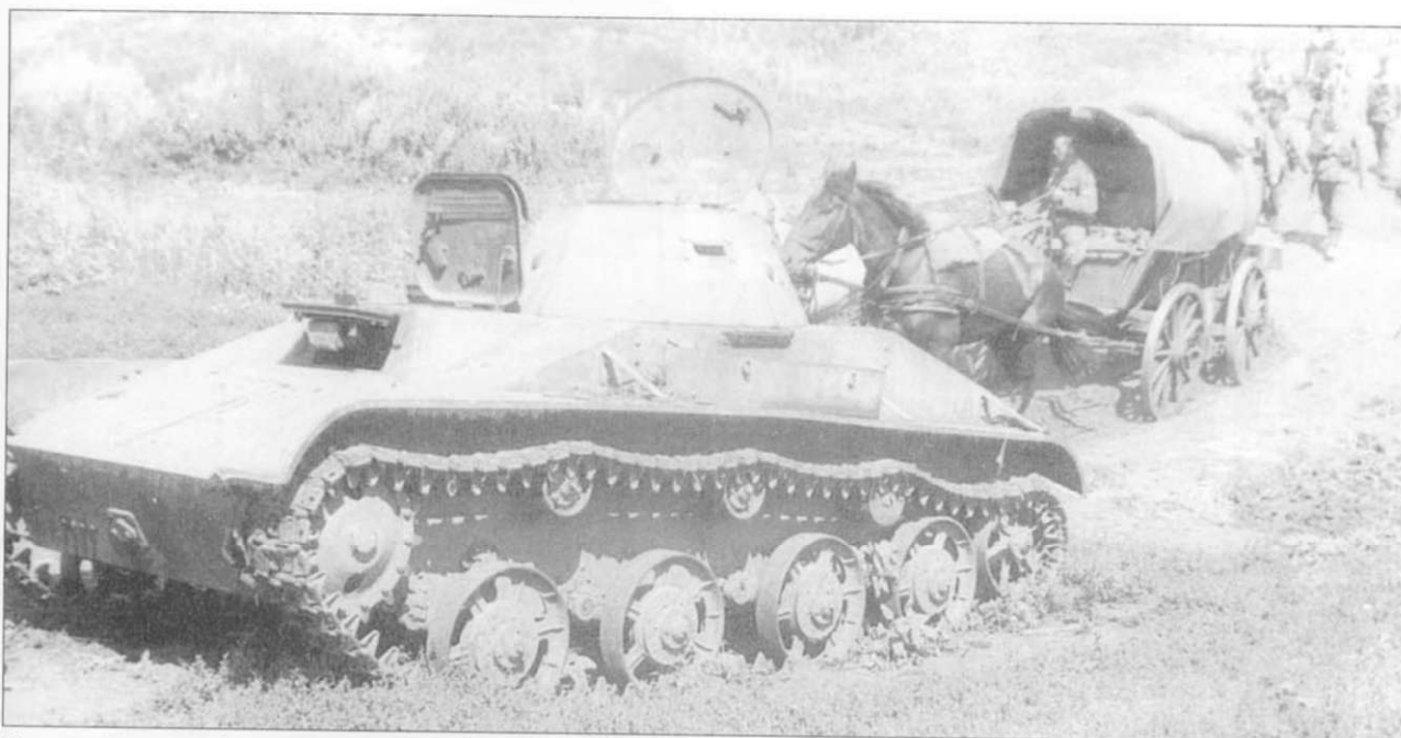
Брошенный советский танк Т-60. Такие танки с катками, имеющими внутреннюю амортизацию, выпускал завод №264 в Сталинграде.
