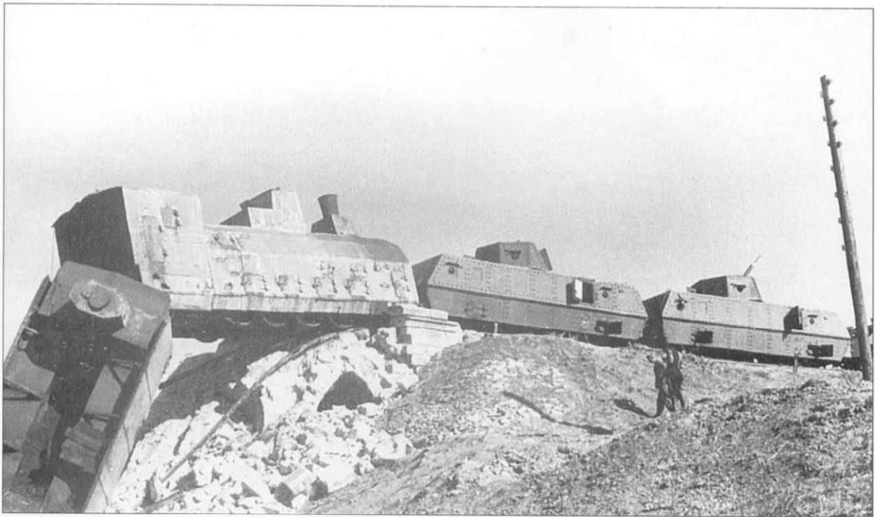
Захваченный немцами в 1942 году русский бронепоезд. Бронепоезда такого типа, использующие для бронеплощадок двухосные платформы, стали строить уже после начала войны.
