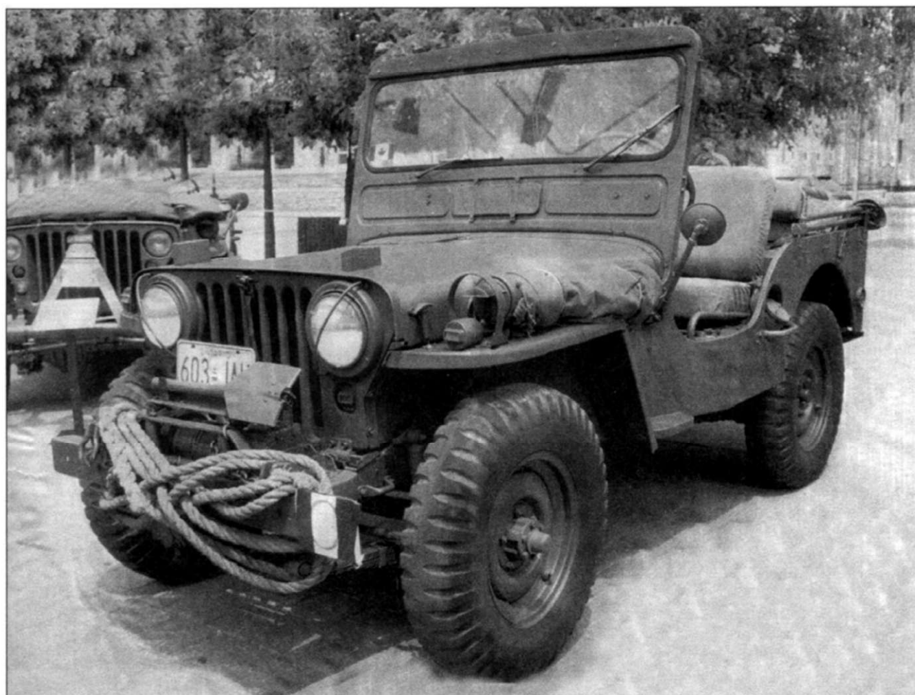
Канадский Willys M38 A1 на выставке-показе старых автомобилей. Обратите внимание на складную лопатку на кронштейне перед радиатором, два упора для ветрового стекла на капоте и защитные дуги на фарах. Джипы M38, представленные на остальных снимках в этом издании, этих деталей не имеют.
