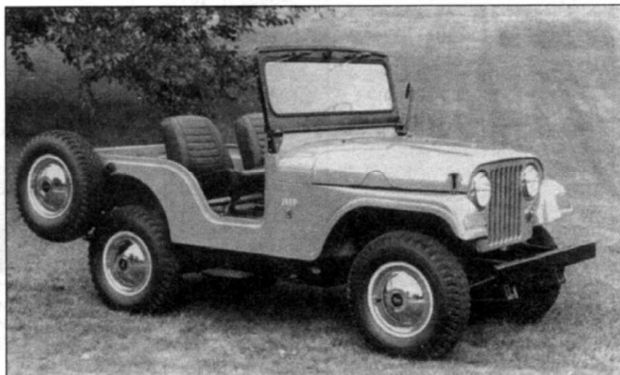
Один из основных конкурентов Ford M151 - Willys CJ-5 в гражданском исполнении 1966 г. Современные анатомические сиденья и хромированные колпаки на колесах, низкопрофильные дорожные шины. Его действительно можно принять за коммерческий автомобиль. Но если присмотреться, на капоте виден вырез для вывода воздухозаборной трубы... Т.е. это конверсионная армейская модель, выпущенная на рынок гражданских автомобилей.
