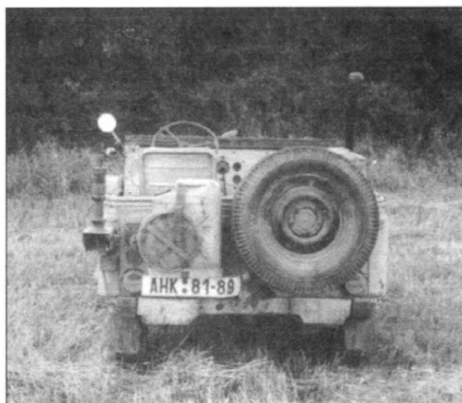
Снимки общего вида Jeep M606 A2, демобилизованного из кувейтской армии и хранящегося в чешской коллекции. Верхние и нижние кадры отличаются поднятым/опущенным ветровым стеклом. Это снижает силуэт машины при необходимости маскировки, хотя формально габарит по воздухозаборной трубе остается прежним.
