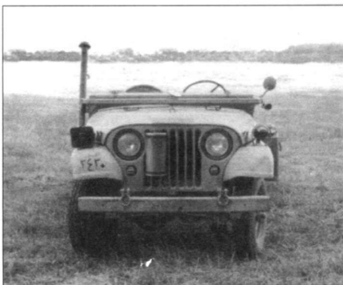
Снимки общего вида Jeep M606 A2, демобилизованного из кувейтской армии и хранящегося в чешской коллекции. Верхние и нижние кадры отличаются поднятым/опущенным ветровым стеклом. Это снижает силуэт машины при необходимости маскировки, хотя формально габарит по воздухозаборной трубе остается прежним.
