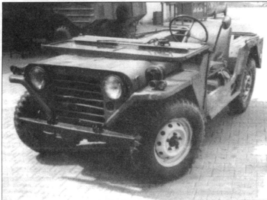
Ford M151A1. Обратите внимание на колесные диски. Машина ранних выпусков (A1) должна была иметь диски из легких сплавов с овальными отверстиями, как на фото ниже или на следующей странице, но у представленного на снимке образца облегчающие отверстия круглые - это колесные диски Ford MUTT M151 A2..
