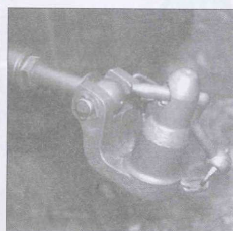
Буксировочный узел BMW R75. Машина создавалась, в частности, для буксировки легких орудий в десантных войсках. А поскольку разработчики пушек ориентировались на буксировку их систем автомобилями, то и на мотоцикле буксирный крюк располагался достаточно высоко. На снимке справа хорошо видна конструкция «крюка» с предохранительной чекой. Страница справа представляет двигатель, цилиндры, карбюратор, свечи и выхлопную трубу BMW R75.
