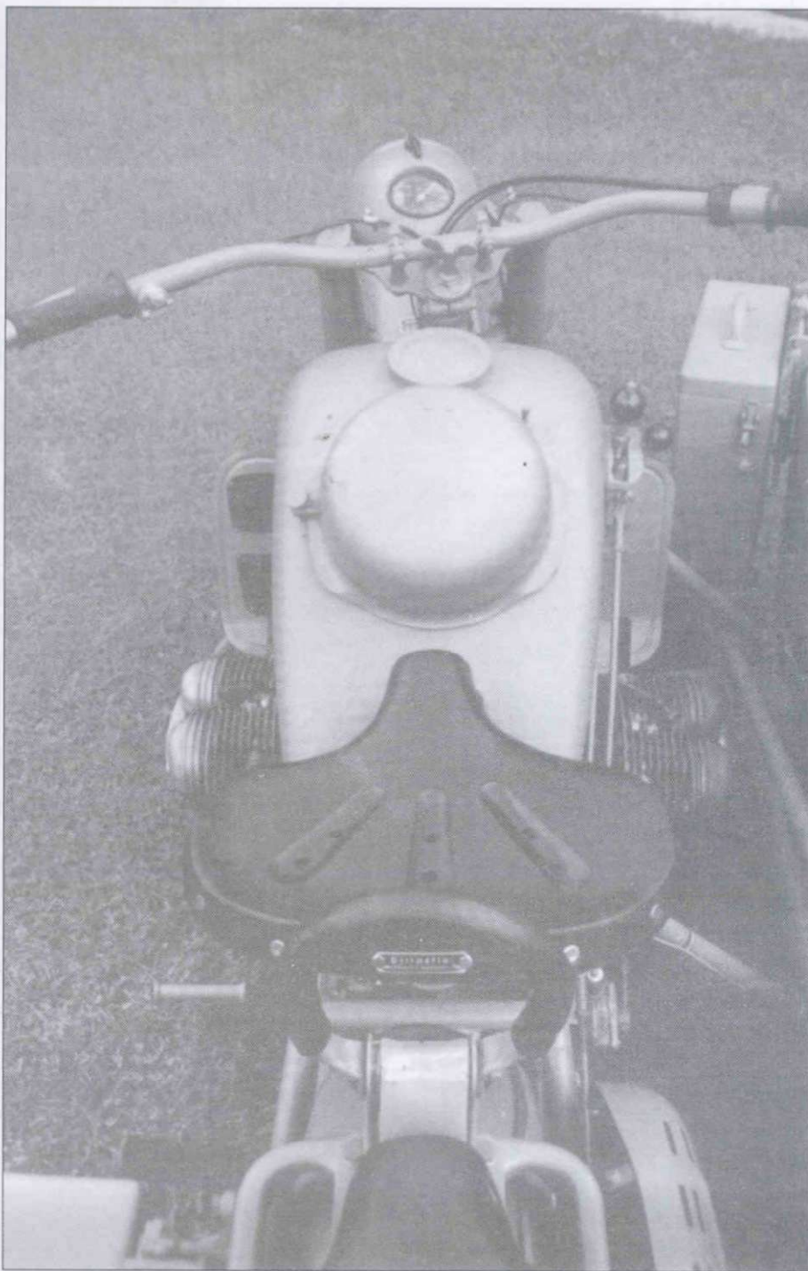
Воздушный фильтр, бензобак, сиденье и переключатель скорости на боковине бензобака BMW R75 позднего выпуска. Современная фотография машины из чешской коллекции.
