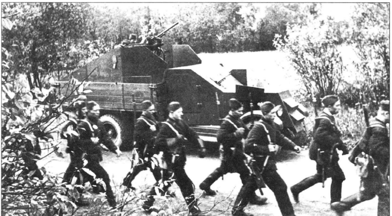
Забронированный в ленинградских мастерских ЗиС-5 с установкой пулемета ДТ в кабине и 45-мм морской пушки 21-К в кузове. 5.10.1941 (фото Михайлова).
