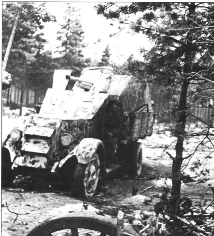
Бронегрузовик ЗиС-5 с установкой в кузове противотанковой «сорокопятки». Машина в зимнем камуфляже. Ленинградский фронт. 22.11.1941.
