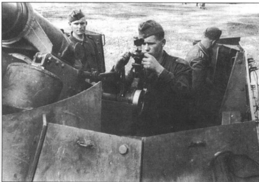
Наводчик работает с оптическим прицелом Rblf 36.
