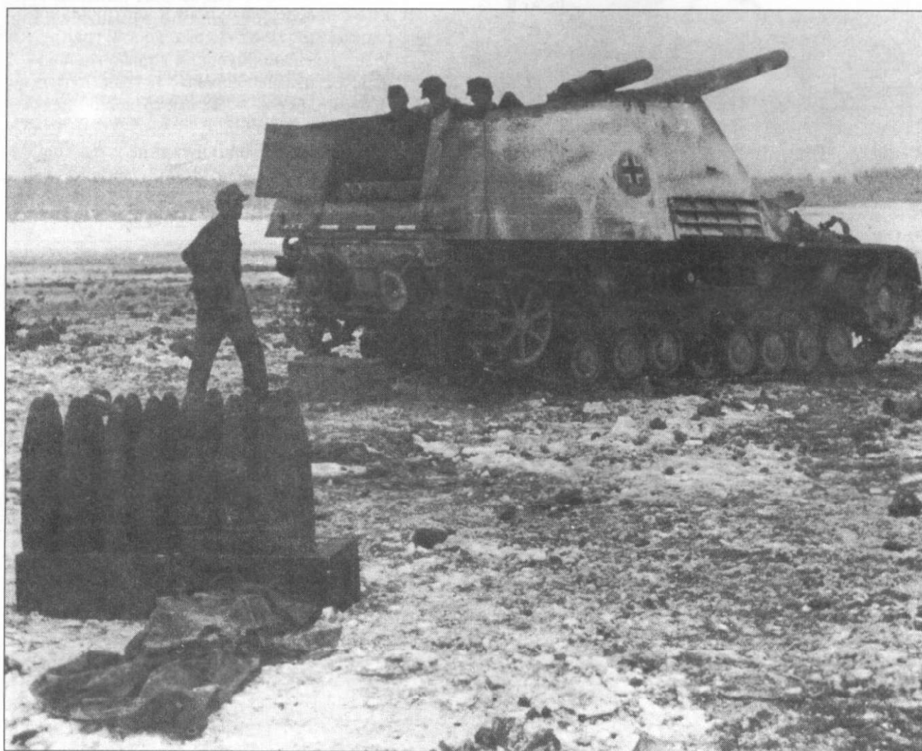
«Хуммель» на огневой позиции где-то на Восточном фронте. Несмотря на ряд достоинств САУ, офицеры-артиллеристы отмечали следующие недостатки: большая высота машины, слабая броня, малый возимый боезапас, малый угол поворота орудия.
