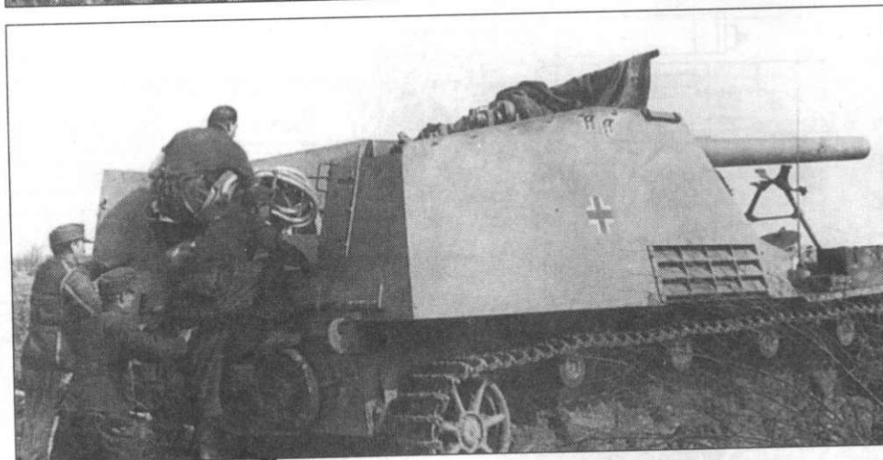
Экипаж перед боем занимает свои места в самоходке, на внутренней стенке рубки виден шланг, предназначенный для заливки рабочей жидкости в рекуператор и противоткатное устройство пушки.
