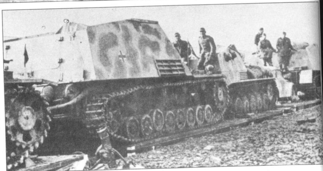
В центре фотографии - транспортер боеприпасов на базе «Хуммеля». Машина ранних серий - это видно по цилиндрическому глушителю.
