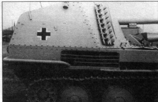
Кормовая часть самоходки из музея в Абердине, правый борт. Решетки воздухозаборника установлены перпендикулярно борту корпуса.
