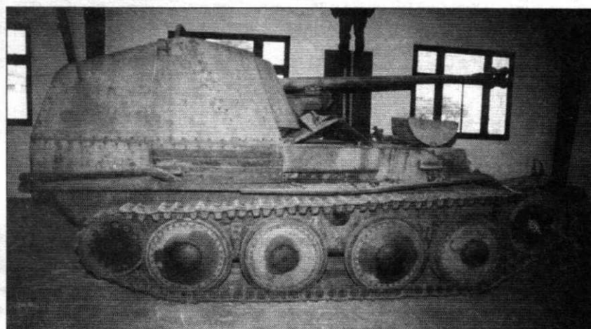
Правый борт истребителя танков из коллекции музея в Самюре. В отличие от истребителей танков Sd.Kfz. 139, обе версии самоходки Sd.Kfz. 138 (Ausf. H и Ausf. M) имели по одному поддерживающему гусеницу ролик на борт.
