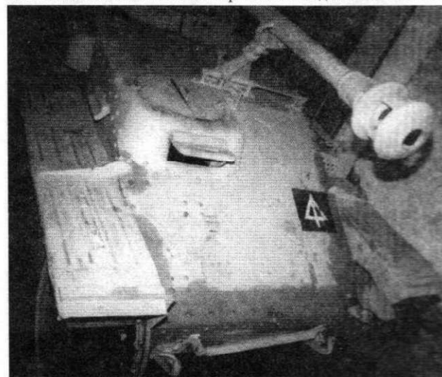
Передняя часть корпуса, вид сверху. Люк механика-водителя закрыт, Триест.
