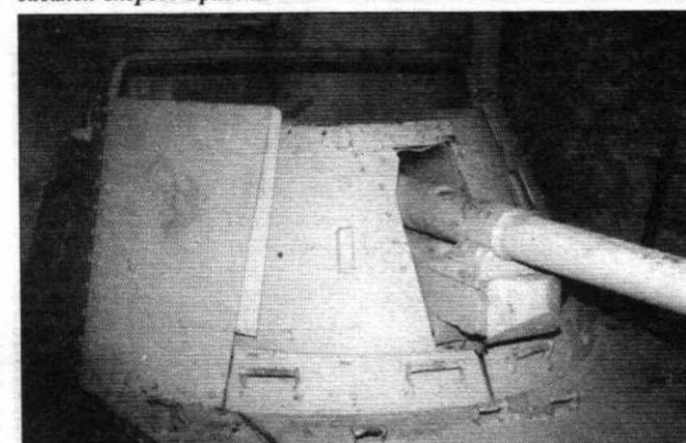
Крупный план передней части боевой рубки и орудийного щита. Щит жестко связан с орудием. Триест.
