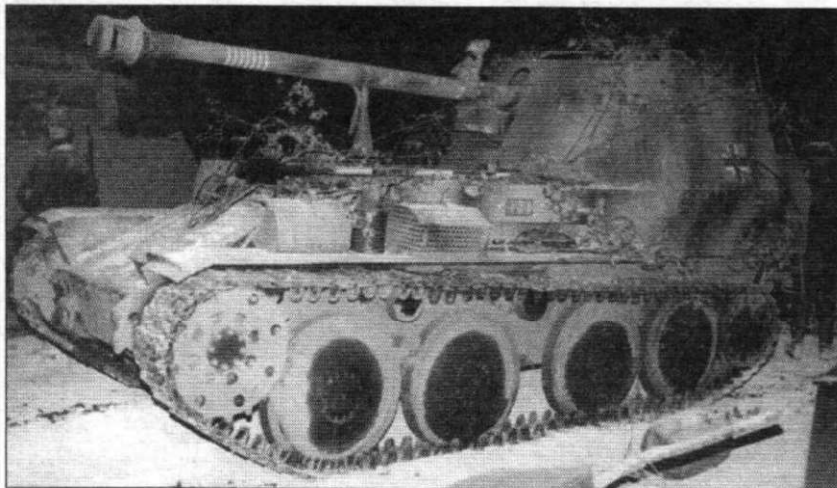
Та же самая машина, вид справа спереди. Обратите внимание на два поддерживающих гусеницу ролика. На крыле установлен ящик из перфорированных металлических листов. Перед ящиком лежит канистра для масла. Канистра, в отличие от ящика, не является штатным элементом снаряжения истребителя танков.
