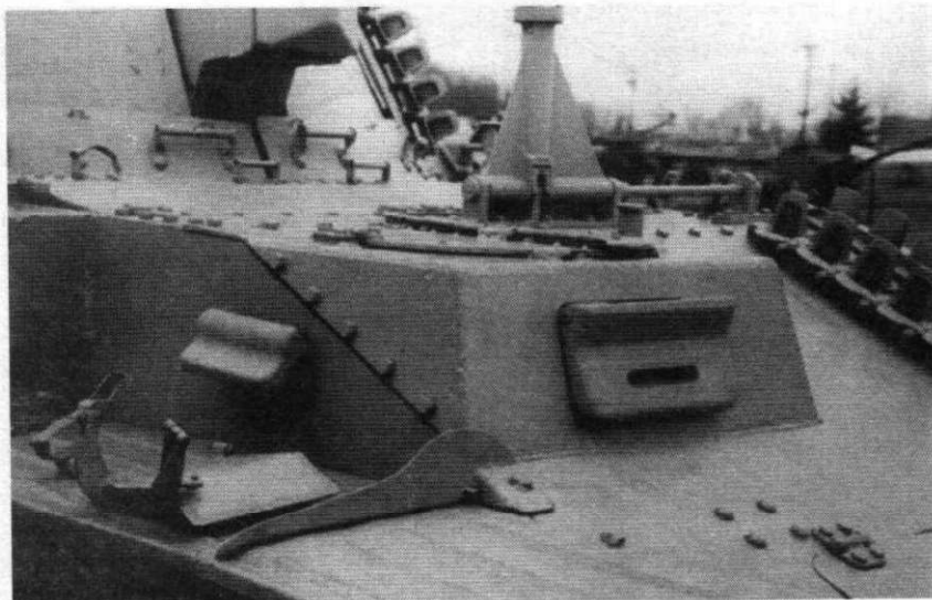
Крупный план рубки механика-водителя, правый борт. Обратите внимание на сварные швы по граням рубки. Хорошо виден люк-пробка. На переднем плане кронштейн крепления подкрылка. Абердин.
