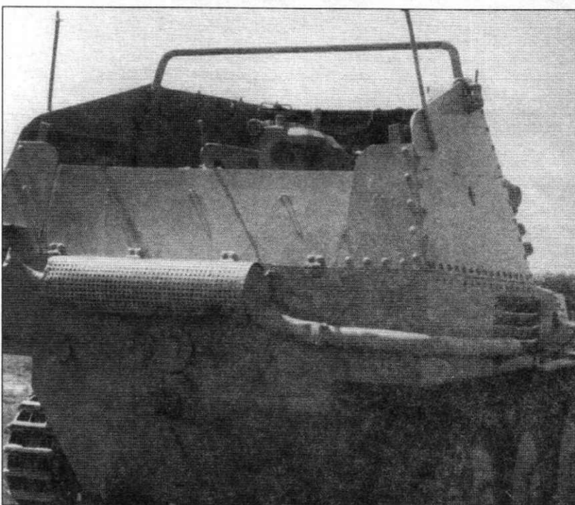
Корма самоходки из Абердина. Хорошо видны буксирные крючья на корпусе и кожух глушителя.
