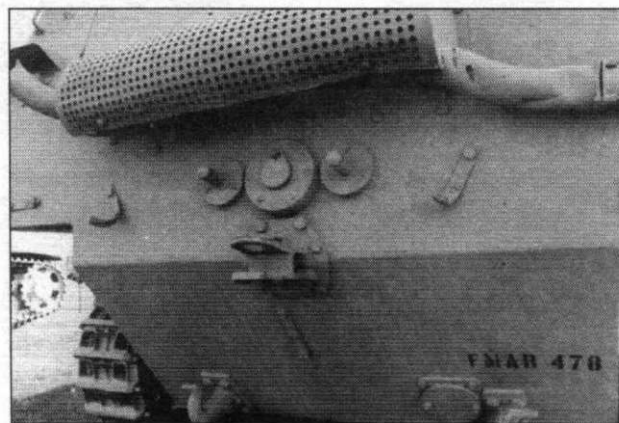
Вид снизу на корму самоходки с глушителем и кожухом. Абердин.
