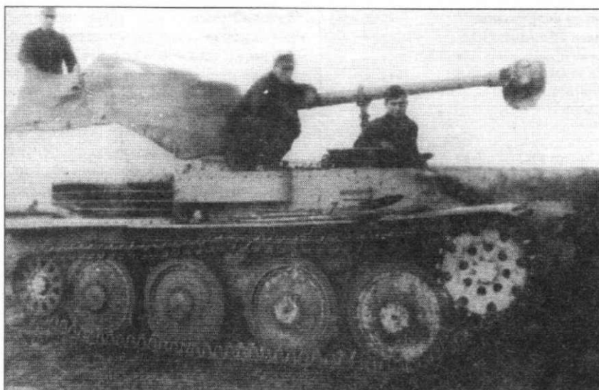
Истребитель танков «Мардер III» Ausf. M средней производственной серии. На ведущем колесе восемь сквозных отверстий расположены во внешнем диске. Обратите внимание на блеск траков, несмотря на грязные опорные катки.
