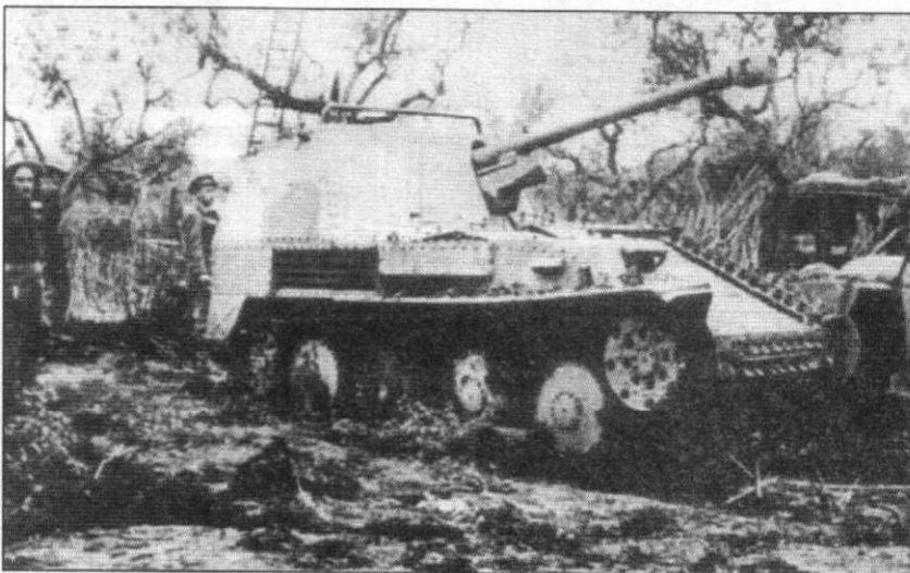
Трофей британских войск под Моцца-Грогна - истребитель танков «Мардер III» Ausf. М, декабрь 1943 г. Обратите внимание на задний подкрылок - редчайший снимок машины с таким подкрылком, сделанный на фронте.
