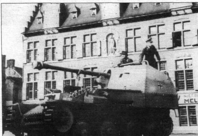
Еще один снимок истребителя танков из той же колонны. Обратите внимание на разницу в оттенке верхней и нижней части машины. Верх - чистый, светлый, низ - темный, запыленный. Открыт люк доступа к двигателю.
