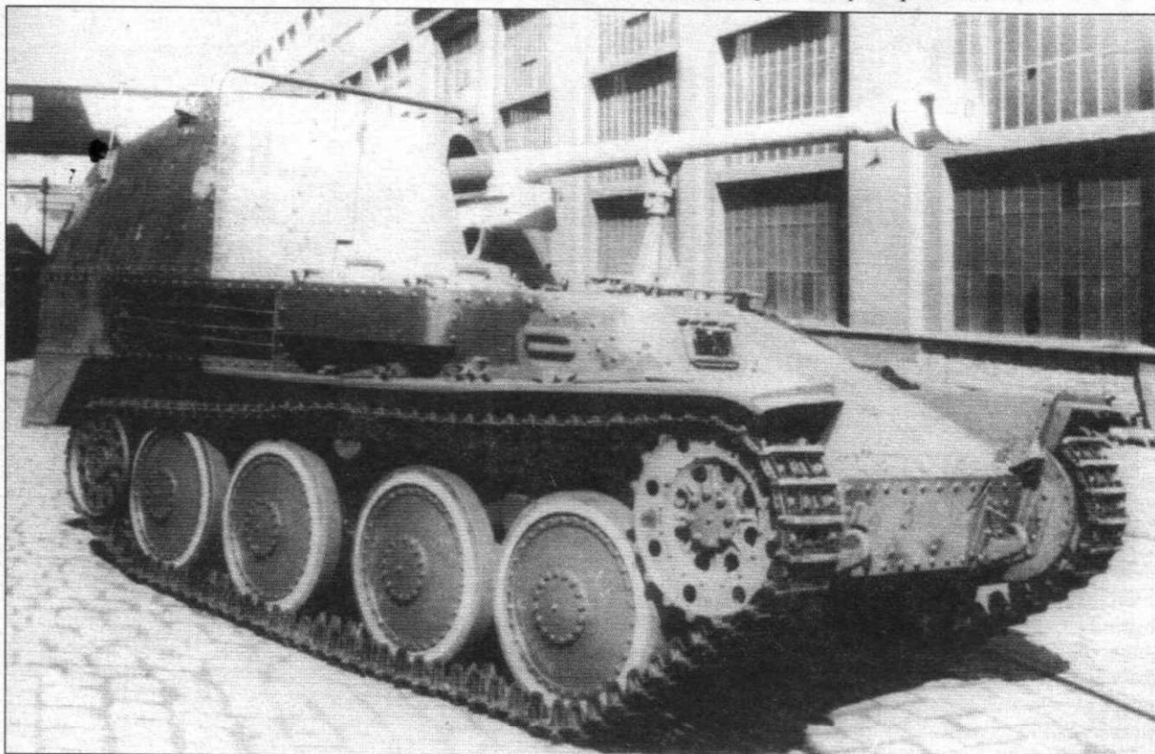
Снимок другого истребителя танков «Мардер III» Ausf. M, также сделанный под ракурсом 3/4 спереди справа. Обратите внимание на задний металлический подкрылок, очень редко устанавливавшийся на эти самоходки.
