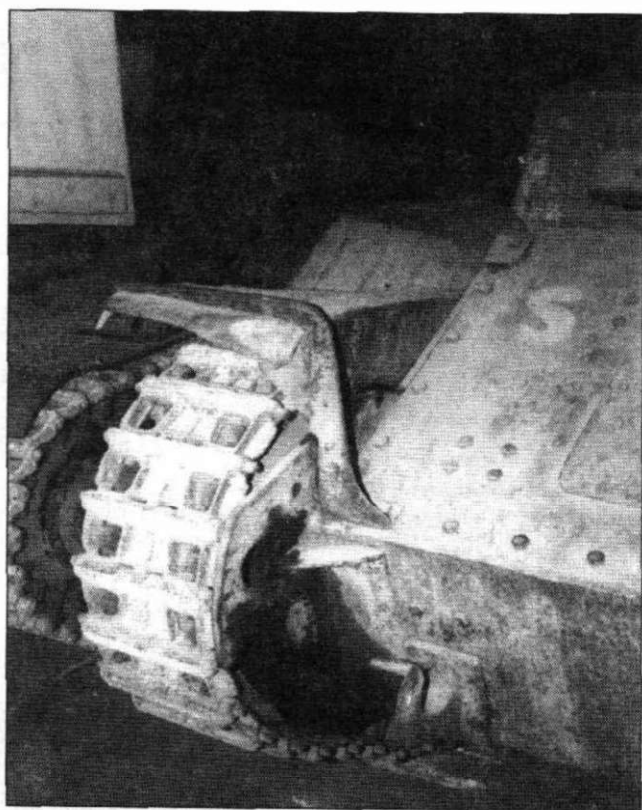
Детализовка лобовой части корпуса, Самюр. Обратите внимание на форму буксировочного крюка.
