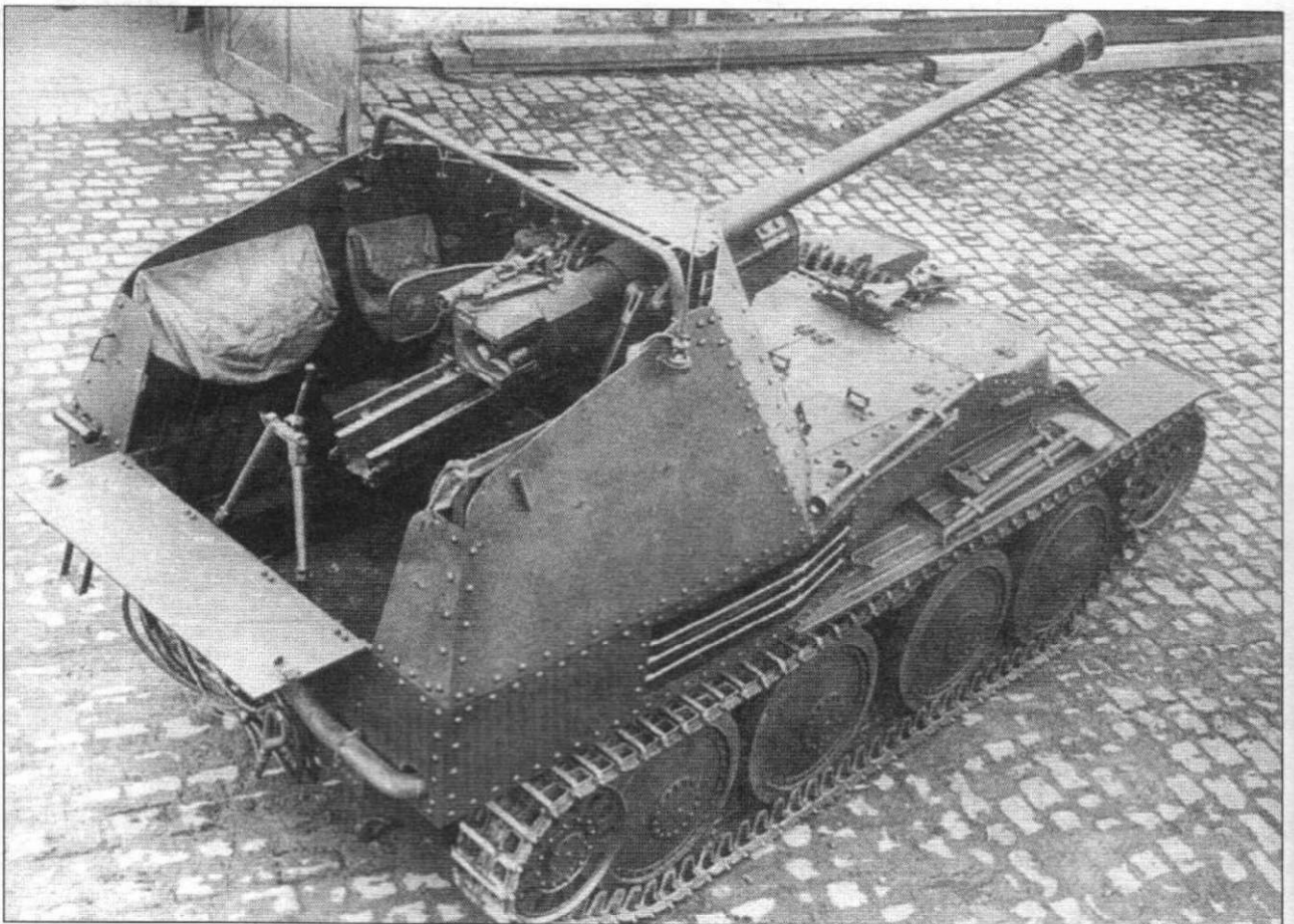
Вид сверху сзади на боевое отделение истребителя танков. Орудие не зафиксировано стопорами. Задняя стенка боевого отделения откинута.
