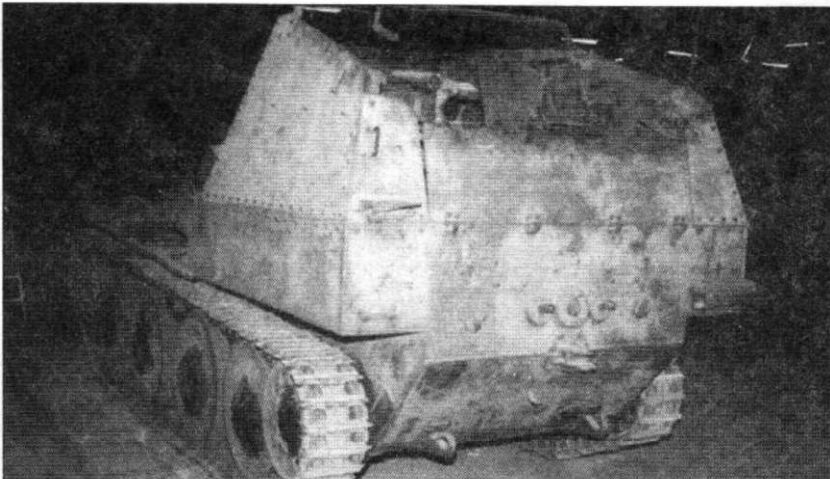
Глушитель на самоходке из Самюра отсутствует. Количество заклепок на самоходках поздних выпусков уменьшилось, так как шире использовались сварные соединения.
