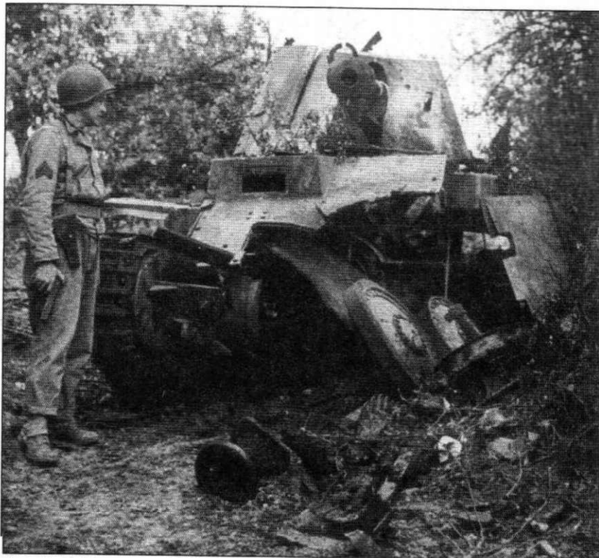
Еще одна сделанная в Италии фотография, впрочем нельзя исключить, что снимок сделан в Нормандии. «Мардер III» Ausf. M получил прямое попадание снарядом крупного калибра, возможно даже выпущенным из корабельного орудия.
