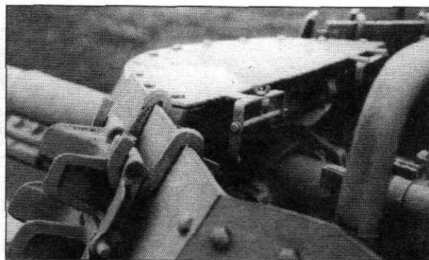
Вид на орудийный щит изнутри сверху слева. Обратите внимание на пустой крепеж под перископический наблюдательный прибор. На переднем плане - крючья навески запасных гусеничных траков и сами траки. Абердин.
