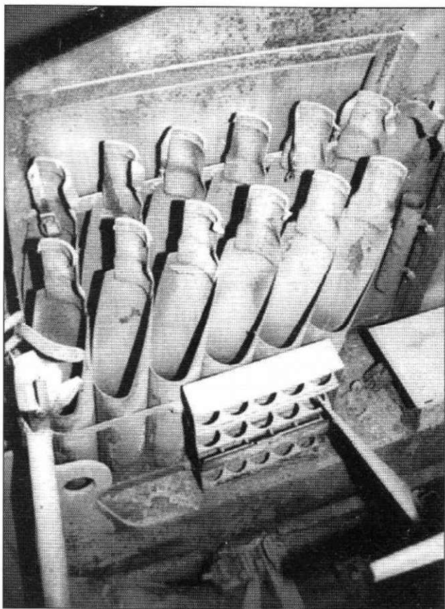
Боеукладка для снарядов, назначение контейнера перед боеукладкой установить не удалось, возможно это хранилище запасных магазинов к пистолетам-пулеметам МР-40. Триест.
