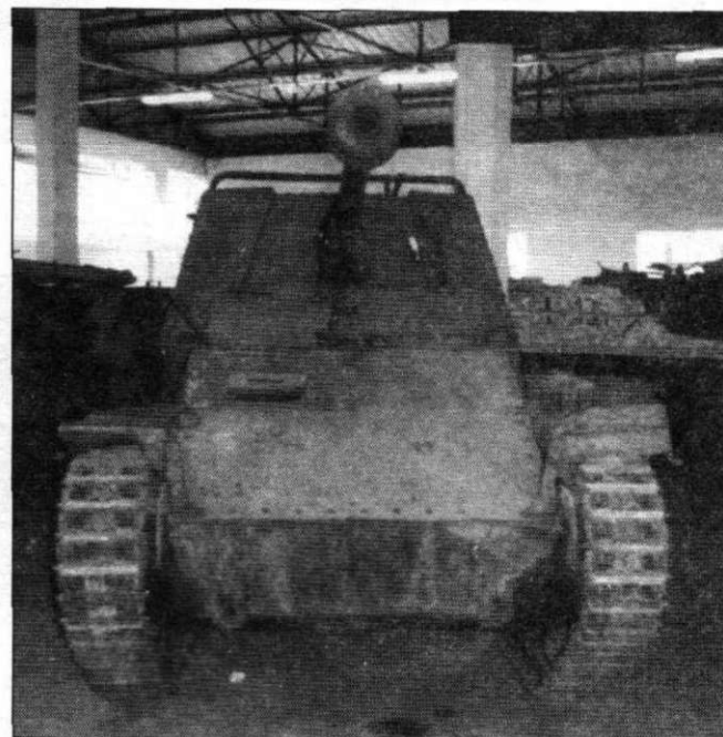
Это самоходка позднего выпуска - сварная рубка механика-водителя имеет граненую форму. Снимок сделан во французском танковом музее в Самюре.
