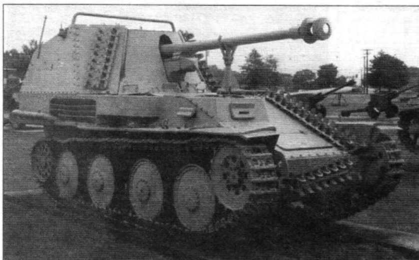
Общий вид истребителя танков «Мардер III» Ausf. M из Абердинского музея, США. По сварной рубке механика-водителя легко определить, что это самоходка позднего выпуска.
