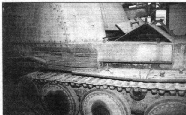
Решетки воздухозаборника установлены под углом с целью улучшения защищенности. Самюр.
