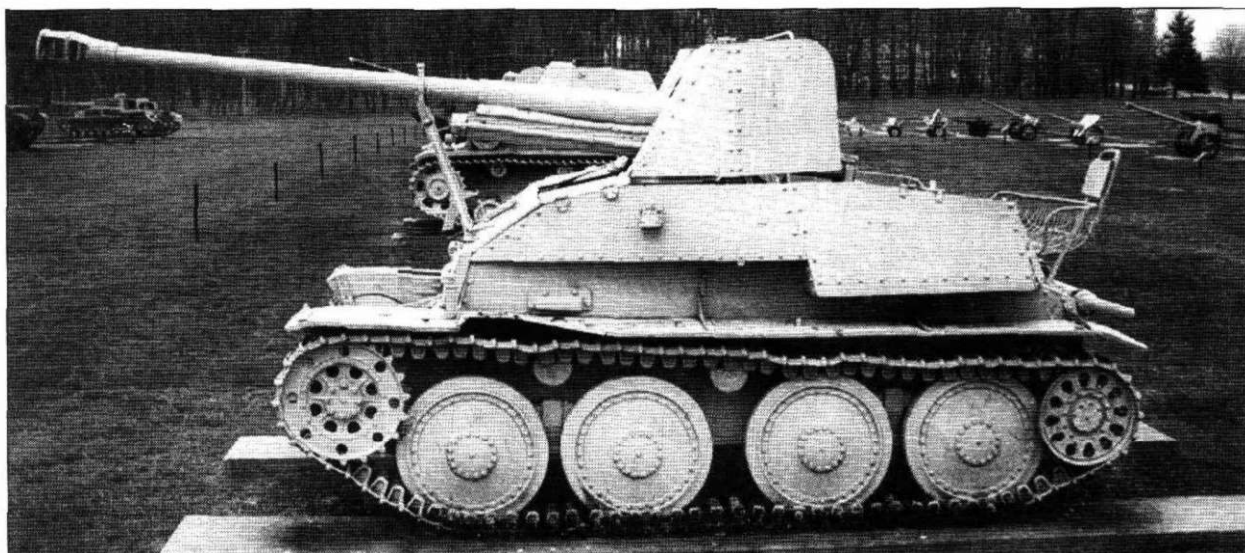
Вид слева. Истребитель танков Sd.Kfz. 139 «Мардер III» из музея в Абердине. Снимок дает представление о ненормальных пропорциях самоходки - слишком большой высоте. Окраска музейного экспонат - от большого американского фонаря. Вся машина, включая резиновые бандажки опорных катков, выкрашена в светло-серый цвет.
