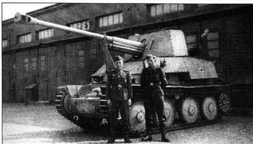
Истребитель танков «Мардер III» из Pz.Jg.Ers.Abt. 4. Машина целиком окрашена в темно-желтый цвет. Обратите внимание на отсутствие запасных гусеничных траков на лобовой детали корпуса.
