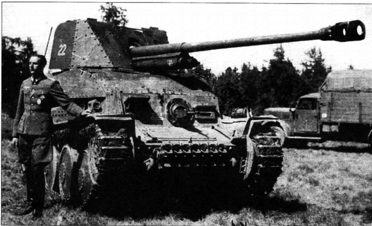
Герой! Позер! Фон - истребитель танков «Мардер III» с бортовым номером «22» из 12-й танковой дивизии. На заднем плане - грузовой автомобиль Опель «Блиц 3т». Обратите внимание - на самоходке нет фиксатора ствола орудия. Траки гусениц забиты грязью.
