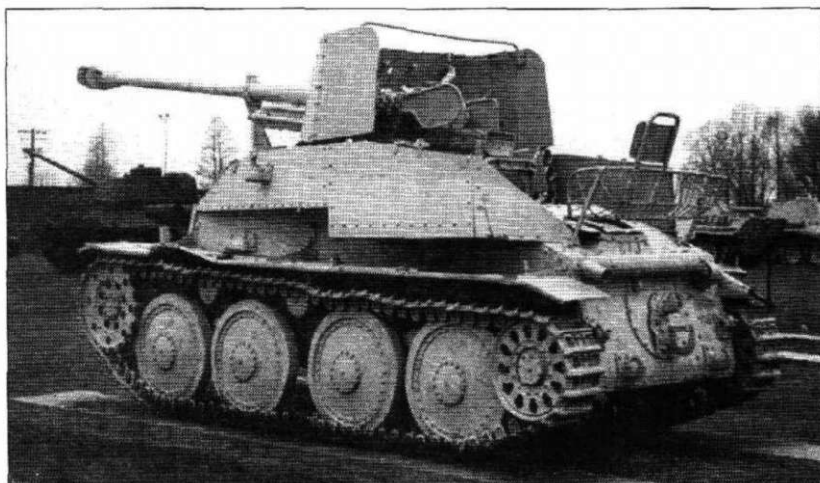
Вид слева. Истребитель танков Sd.Kfz. 139 «Мардер III» из музея в Абердине. Снимок дает представление о ненормальных пропорциях самоходки - слишком большой высоте. Окраска музейного экспонат - от большого американского фонаря. Вся машина, включая резиновые бандажки опорных катков, выкрашена в светло-серый цвет.
