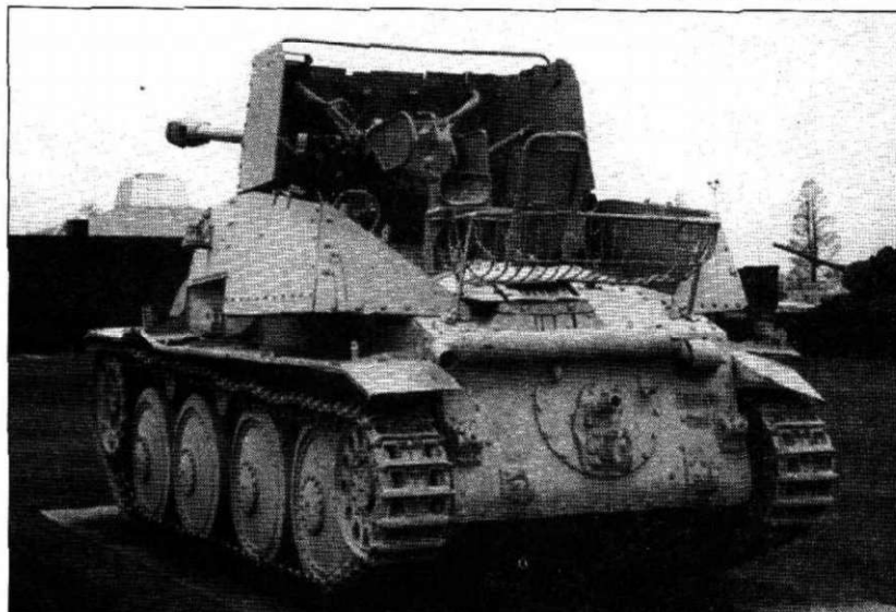
Вид сзади слева на истребитель танков Sd.Kfz. 139 из Абердина. Выхлопной патрубок развернут вниз, хотя на самом деле он был отклонен вверх. Обратите внимание на покатую крышу моторного отделения - не самый удобный пол для расчета пушки.
