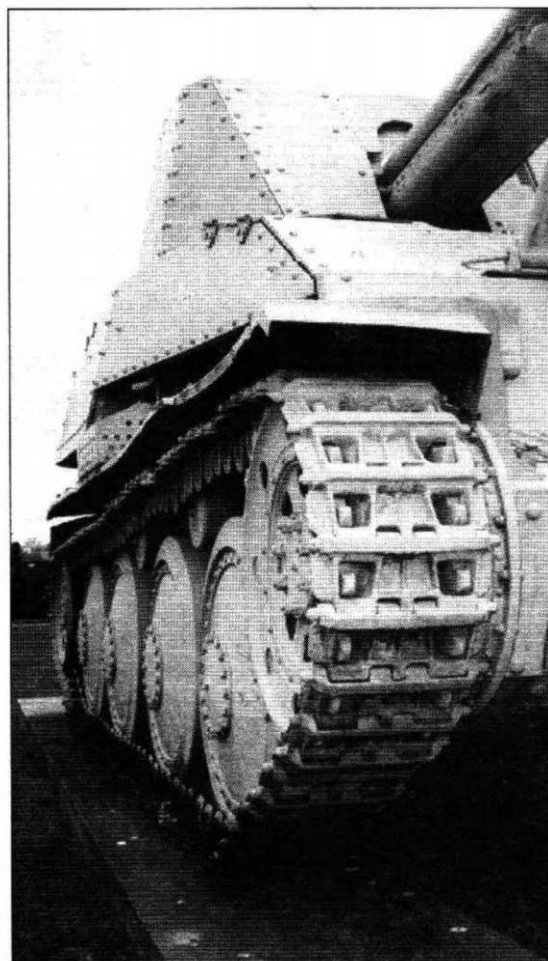
Гусеница крупным планом. Гусеница набиралась из 93 траков, ширина трака 293 мм.
