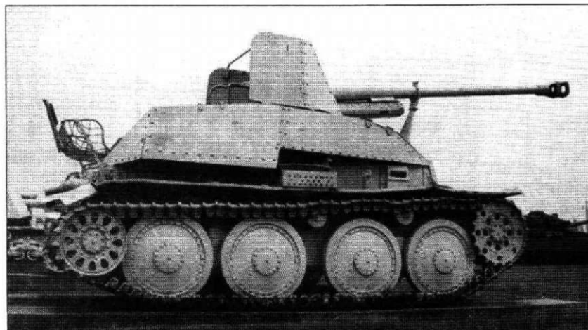
Истребитель танков Sd.Kfz. 139 «Мардер III» из музея в Абердине. Обратите внимание на смотровой прибор механика-водителя. Механик-водитель на танке Pz.Kpfw. 38(t) и истребителе танков Sd.Kfz. 139 располагался справа от продольной оси машины.
