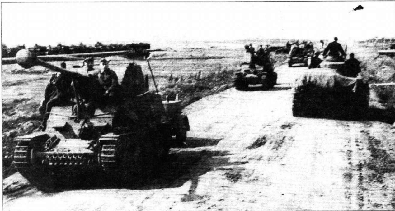
Колонна «Мардеров» на марше. Дульные тормозы орудий зачехлены, чтобы в стволы не попала пыль. На прицепах у самоходок - трейлеры для боеприпасов.
