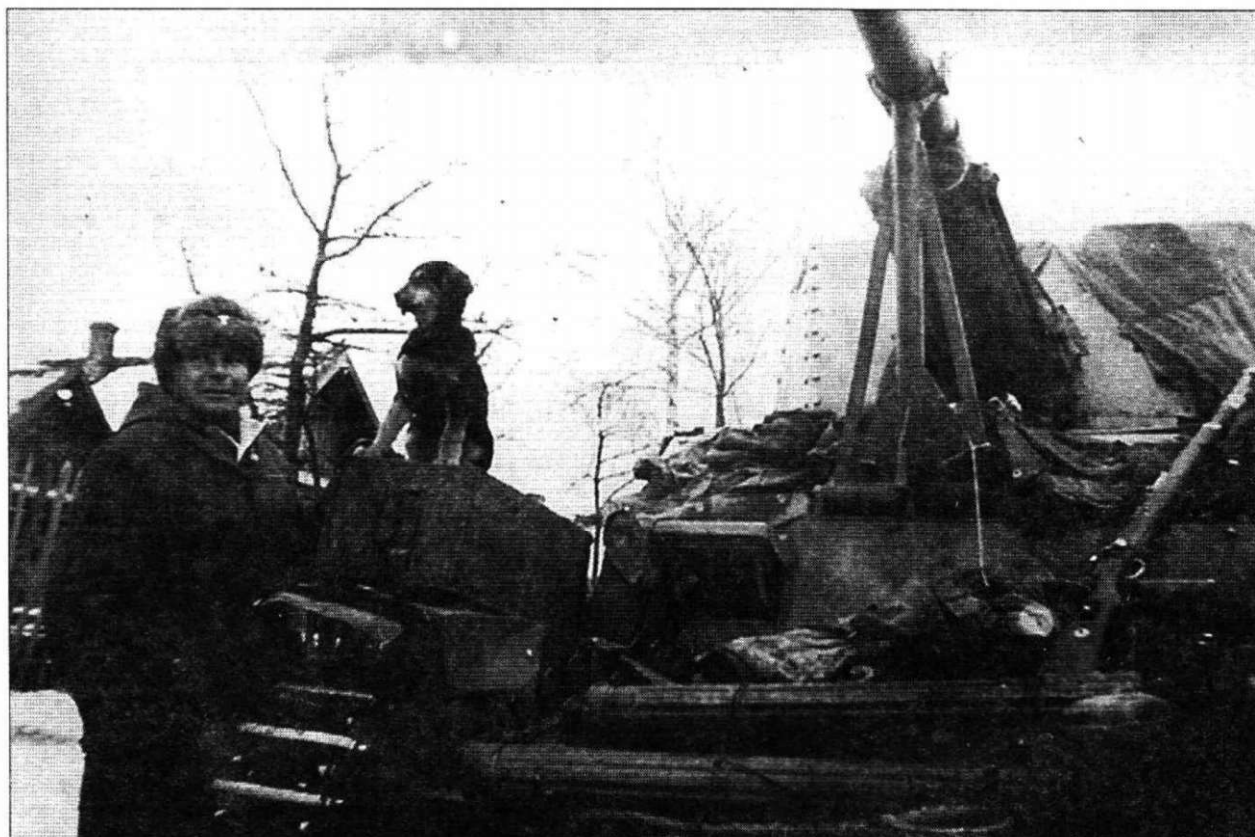
Крупный план «промежуточного» фиксатора ствола орудия - труба с двумя подкосами.
