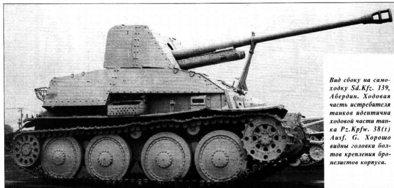
Истребитель танков Sd.Kfz. 139 «Мардер III» из музея в Абердине. Обратите внимание на смотровой прибор механика-водителя. Механик-водитель на танке Pz.Kpfw. 38(t) и истребителе танков Sd.Kfz. 139 располагался справа от продольной оси машины.
