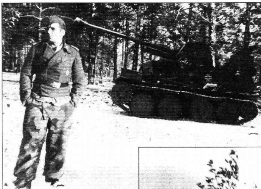
«Мардер III», на корме корпуса и в передней части на левом крыле закреплены дополнительные ящики.
