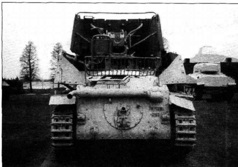
Кормовая часть истребителя танков Sd.Kfz. 139 «Мардер III», Абердин. Обратите внимание на выхлопную трубу и болтовое крепление плат с буксирными крбками к корпусу.
