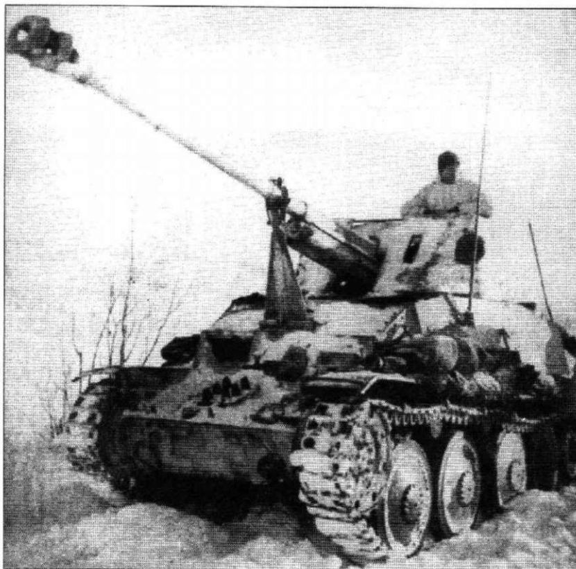
И еще один «Мардер» из Pz.Jg.Abt.2 12-й танковой дивизии. Впечатляет длина ствола орудия в сравнении с длиной самоходки. Белая краска в первую очередь стиралась на гранях корпуса и орудийного щита.
