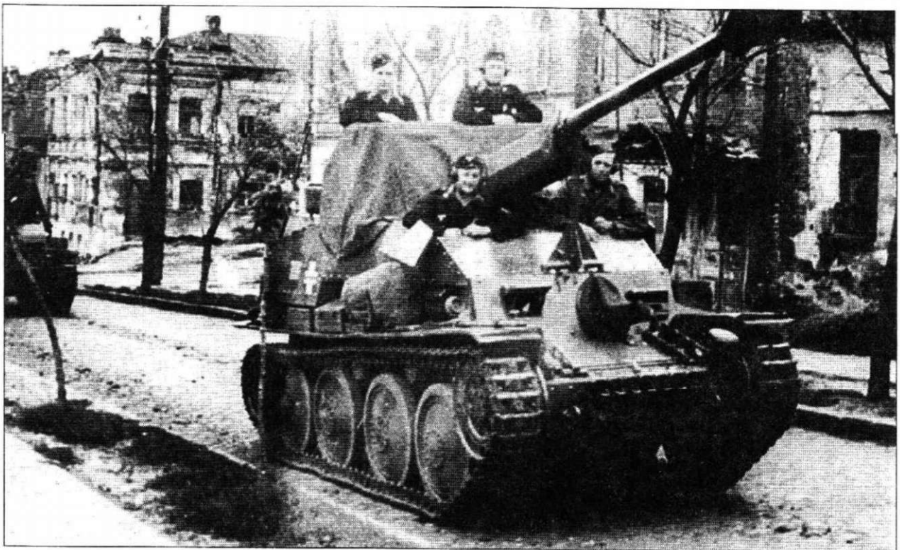
Колонна истребителей танков «Мардер III» на улице русского города. Боевое отделение головной машины закрыто тентом, на дульный тормоз надет чехол, ствол орудия зафиксирован.
