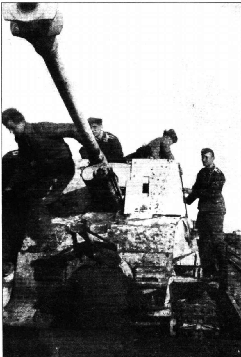
«Мардер III» с довольно редко встречающимся «промежуточным» типом фиксатора ствола орудия - труба с двумя подкосами.
