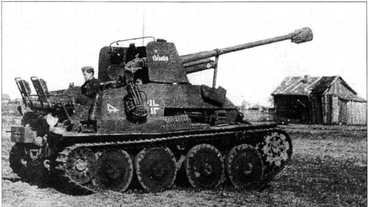
Вид сбоку на самоходку с собственным именем «Gisela», имя написано белой краской на орудийном щите. На внешней поверхности борта - откинутое сиденье заряжающего.
