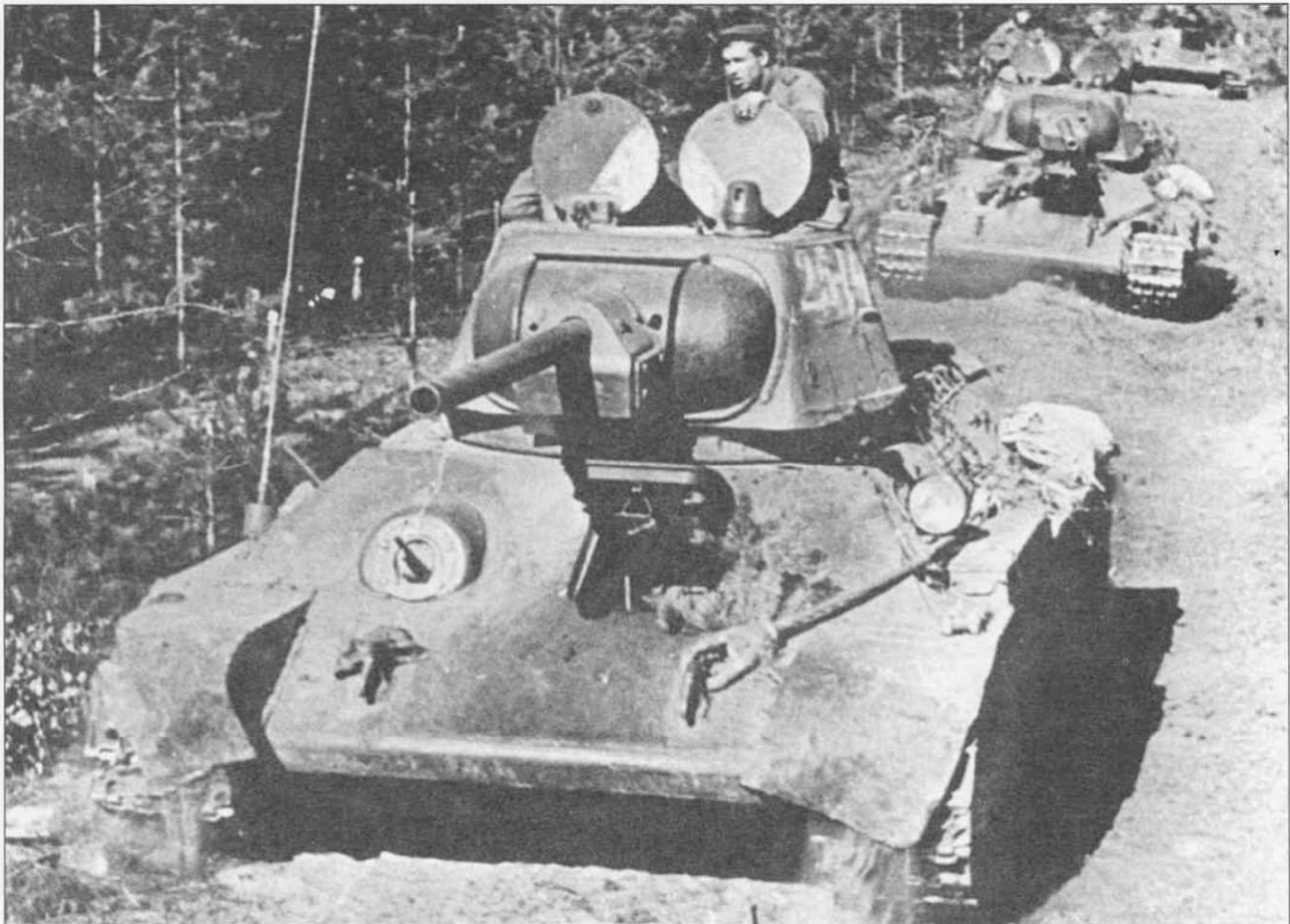
Колонна танков Т-34 образца 1943 г. на марше, лето 1943 г. На крышах башен нанесены треугольники белого цвета - знаки быстрого распознавания с воздуха. На борту головного танка от руки написан тактический номер «25-14», первые две цифры номера - код бригады.
