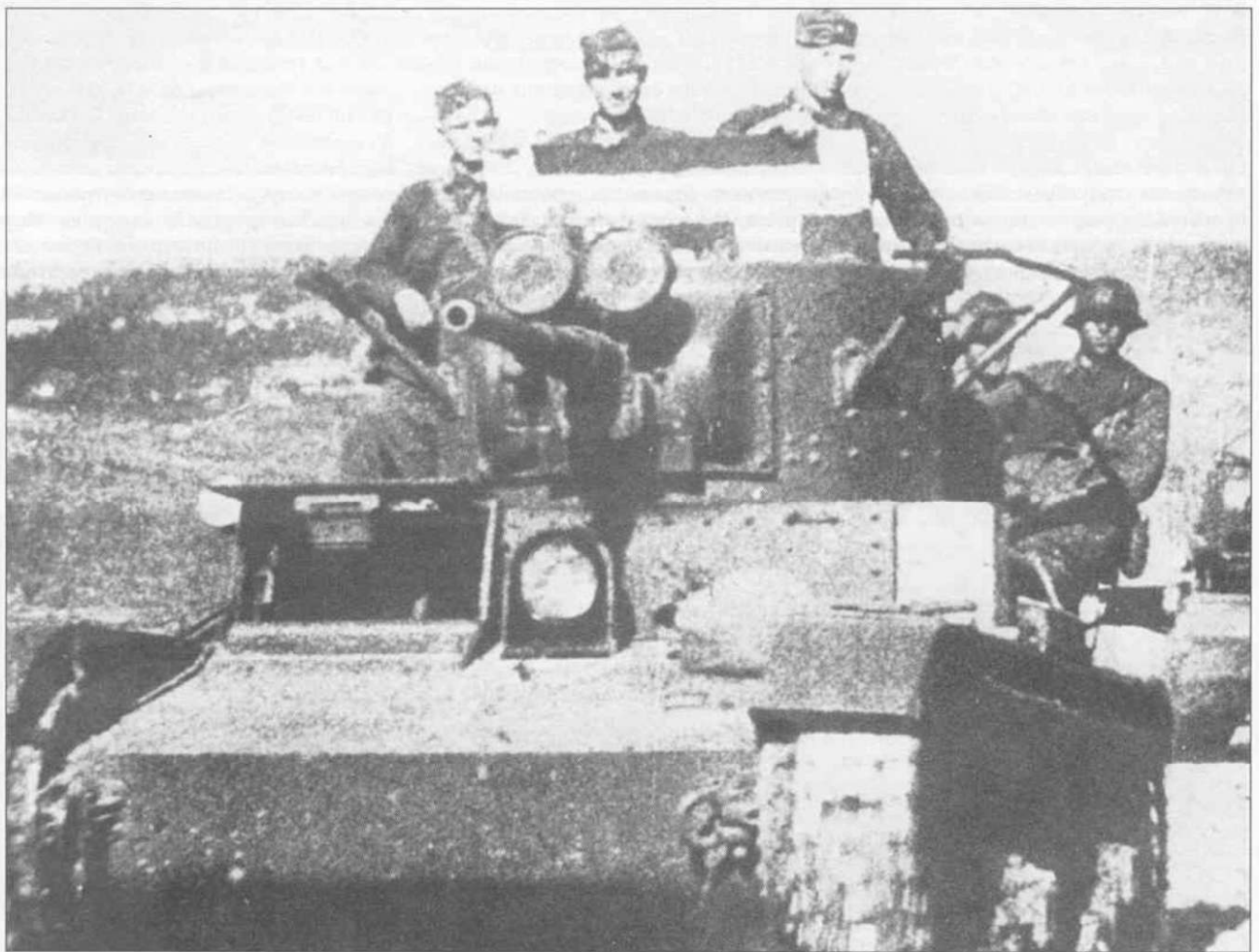
Одной из наиболее часто встречающихся форм маркировки танков Красной Армии являлись знаки быстрого опознавания с воздуха. На снимке - танк Т-26 образца 1933 г., на башне белой краской написана буква «Д», нижняя часть которой видна на открытом люке. На заднем плане едва различим танк ОТ-28.
