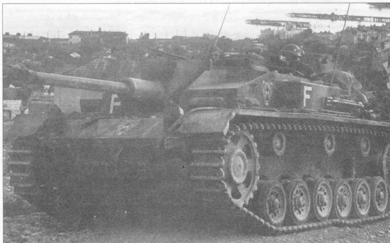
Штурмовое орудие StuG III Ausf. F из StuG Brigade 210, известной как «Tigerkopf Brigade» за характерные эмблемы в виде головы тигра. Эмблема бригады хорошо видна на борту рубки, запечатленной на фотографии самоходки. Бригада принимала участие в ожесточенных боях на Кавказе. С 1943 г. штурмовые орудия окрашивались по новой схеме, базовый цвет - темно-желтый, пятна камуфляжа - темные оливково-зеленые.
