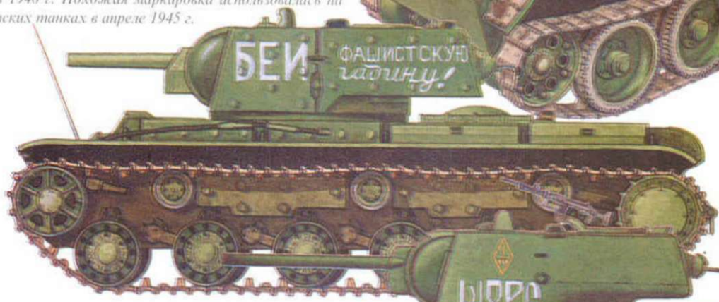
КВ-1 образца 1940 с накладной броней. На башне написан лозунг «Бей фашистскую гадину».
