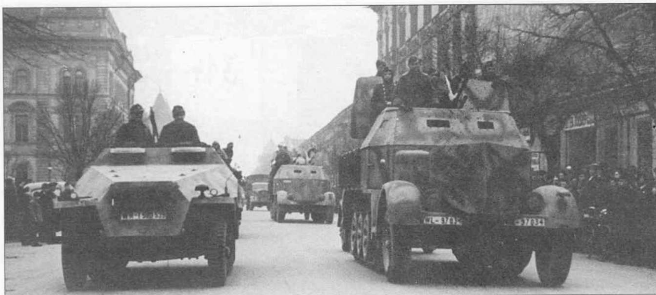
Зенитные установки подразделений люфтваффе, такие как 2cm Flak38 auf Fgst Zgkw 8t (на снимке справа), окрашивались аналогично бронетехнике вермахта и войск СС. На номерном знаке - префикс «WL», люфтваффе. Слева - Ганомаз Sd.Kfz. 251 Ausf. D из учебной танковой дивизии (префикс «WH» на номерном знаке обозначает вермахт). Снимок сделан поздней весной 1944 г. в центре Будапешта.
