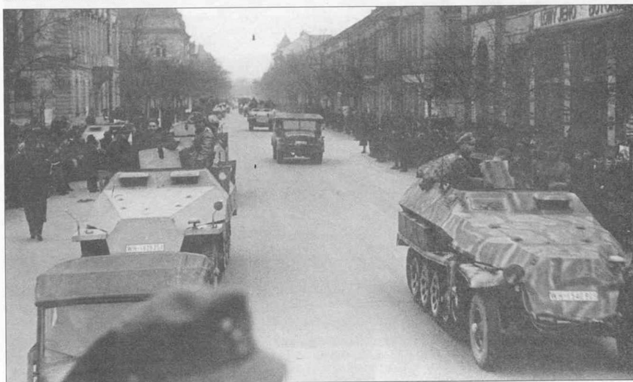
Схемы камуфляжа бронетехники не стандартизировались даже на уровне дивизии. На снимке - два полугусеничных бронетранспортера Ганомаг Sd.Kfz. 251 из учебной танковой дивизии, Будапешт, 1944 г. Справа - основательно камуфлированный бронеевтомобиль Sd.Kfz. 251 Ausf. C. По базовому темно-желтому фону нанесен причудливый узор из полос оливково-зеленого и красно-коричневого цветов. Слева - вообще не имеющий камуфляжа броневиk Sd.Kfz. 251 Ausf. D.
