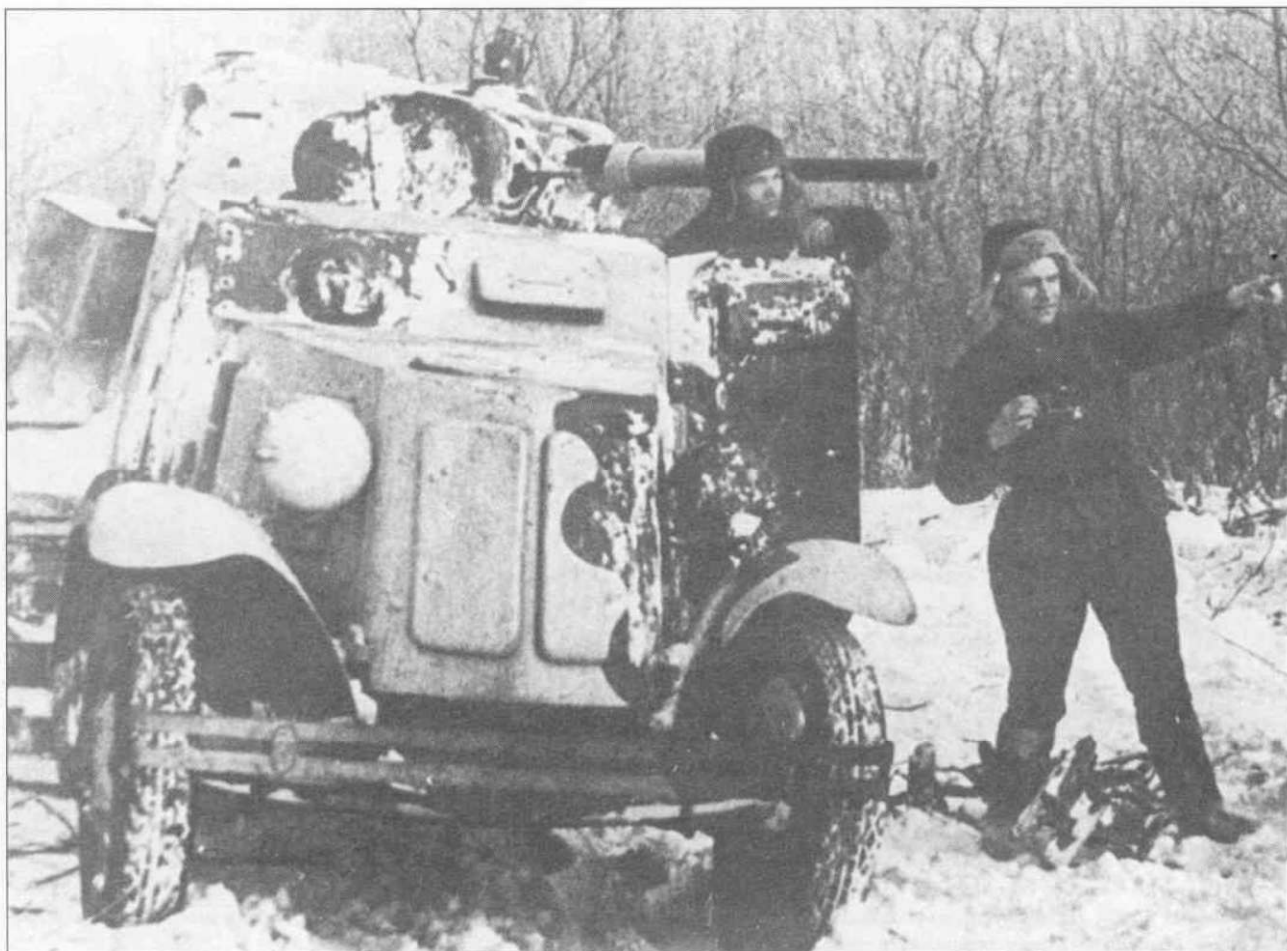
Зимой бронетехника Красной Армии в обязательном порядке перекрашивалась в белый цвет. Нестойкая краска на водяной основе быстро облезала. Обратите внимание на пятна камуфляжа, проступающие сквозь белую окраску. На снимке - бронеевтомобиль БА-10.
