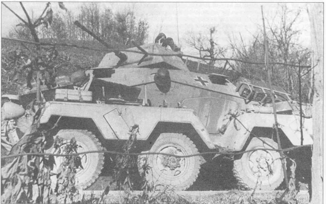
Бронеавтомобиль Sd.Kfz. 232 в типичной для немецких бронемашин Восточного фронта окраске. Машина просто покрашена в темно-желтый цвет, пятна камуфляжа отсутствуют. На борту корпуса (непосредственно под каской) видна железнодорожная маркировка. Верхняя строчка маркировки - марка бронеавтомобиля, средняя и третья - информация о массе машины. Обычно эти надписи заключались в прямоугольник.
