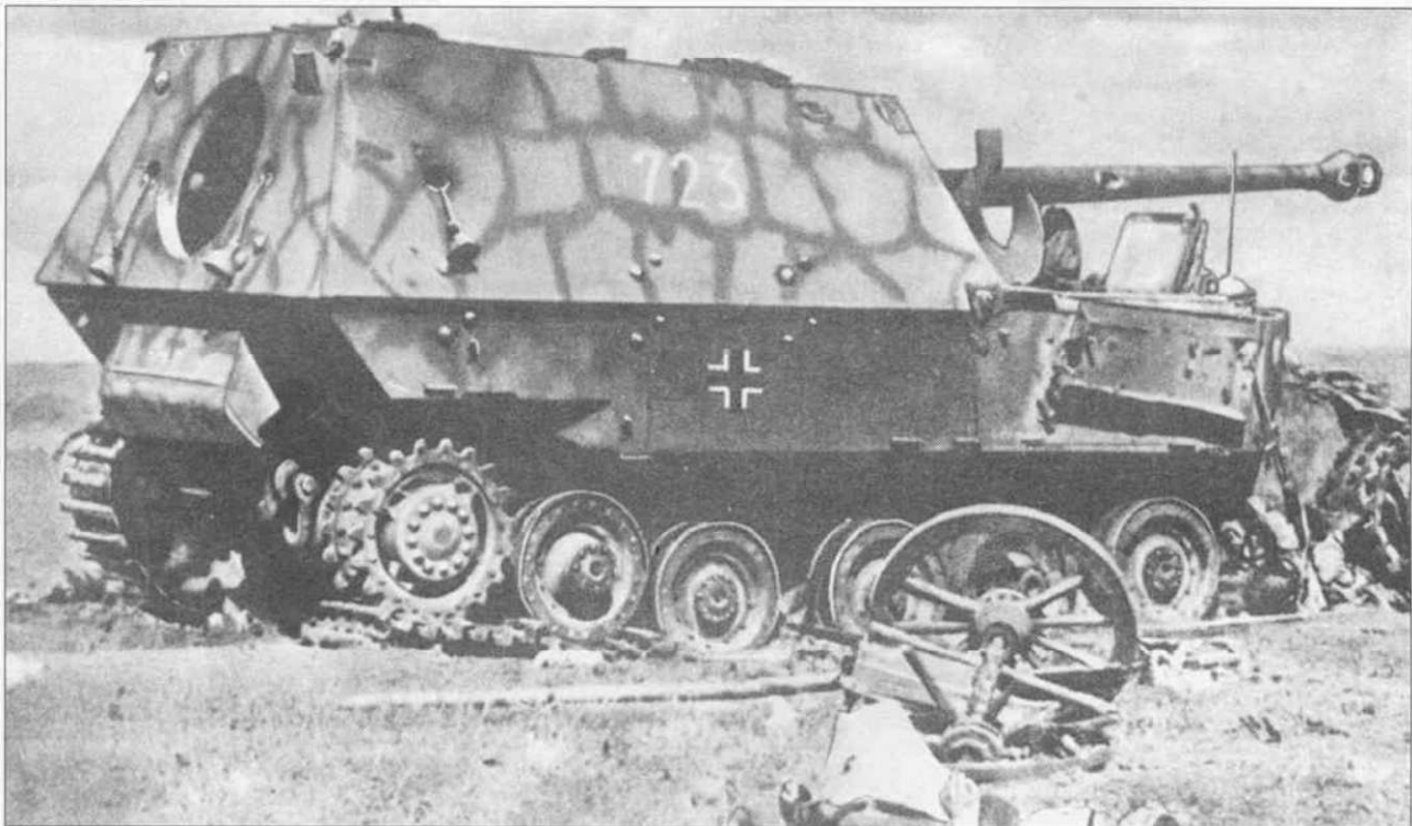
Символ поражения вермахта под Курском - подбитый «Фердинанд» (Sturmgeschütz mit 8,8 cm PaK 43/2, Sd.Kfz 184). Самоходка принадлежала Jagd-Regiment 656. «Фердинанд» целиком окрашен в темно-желтый цвет, по которому накрашены темные оливково-зеленые полосы разрушающего камуфляжа. Такая окраска была типична для действовавших на Курском выступе тяжелых истребителей танков Sd.Kfz 184. Из 89 «Фердинандов», имевшихся в войсках к моменту начала операции «Цитадель», немцы потеряли под Курском 39 самоходов.
