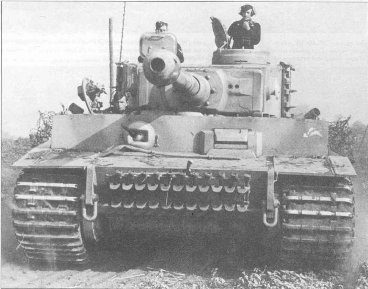
Введенная в 1943 г. схема окраски бронетехники не устанавливала стандарта расположения и формы камуфляжных полос или пятен, поэтому рисунок камуфляжа танков из различных подразделений сильно варьировался. Снимок этого «Тигра» сделан в 1943 г. Полосы темного оливого-зеленого цвета довольно правильной формы нанесены распылителем по базовому темно-желтому фону. «Разрушающий» эффект данной окраски минимален - два цвета почти сливаются в один, в то время как согласно идее разрушающего камуфляжа цвета должны быть контрастными. На лобовом бронелисте корпуса «Тигра» нанесена эмблема подразделения, к какому подразделению она относится установить не удалось. На борту башни написан тактический номер «214».
