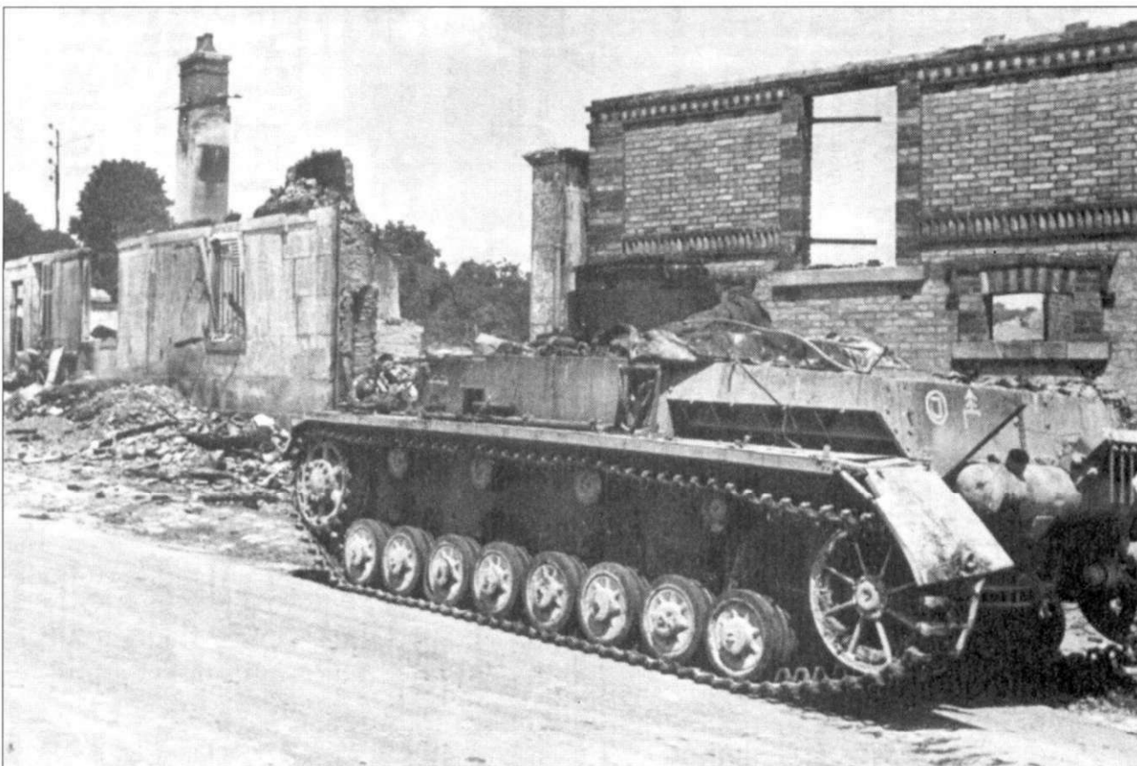
Необычного вида машина на фотографии - это PzKpfw IV Ausf D либо E- танковый мостовукладчик из саперного батальона (PzPi Abt), переданный ремонтно-технической роте танкового полка после того, как он уложил мостовую конструкцию. Задняя опора мостовой конструкции частично закрывает тактический знак саперов. Немецкая буква «I» в круге обозначает ремонтно-техническое подразделение.
