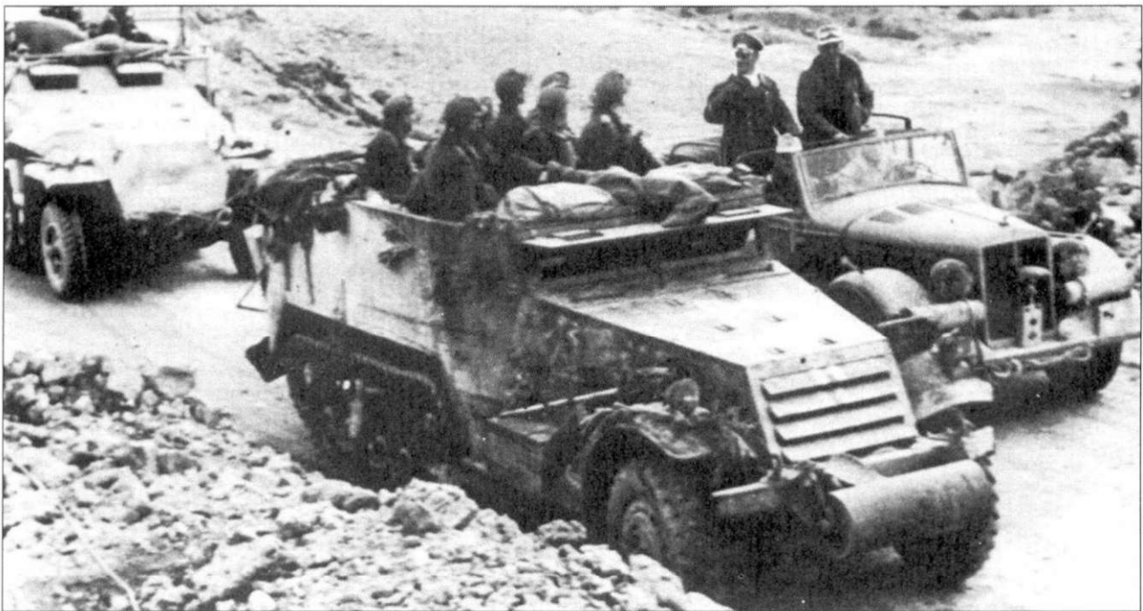
После битвы у Кассерейн Пасс немцы захватили большое количество американских машин и оборудования. Представленный на снимке полугусеничный бронетранспортер М3 остался в первоначальной грязно-оливковой окраске, на которой лежит толстый слой пыли. Кресты нарисованы на верхней части капота и жалюзи радиатора. Этот М3 - ранних выпусков.
