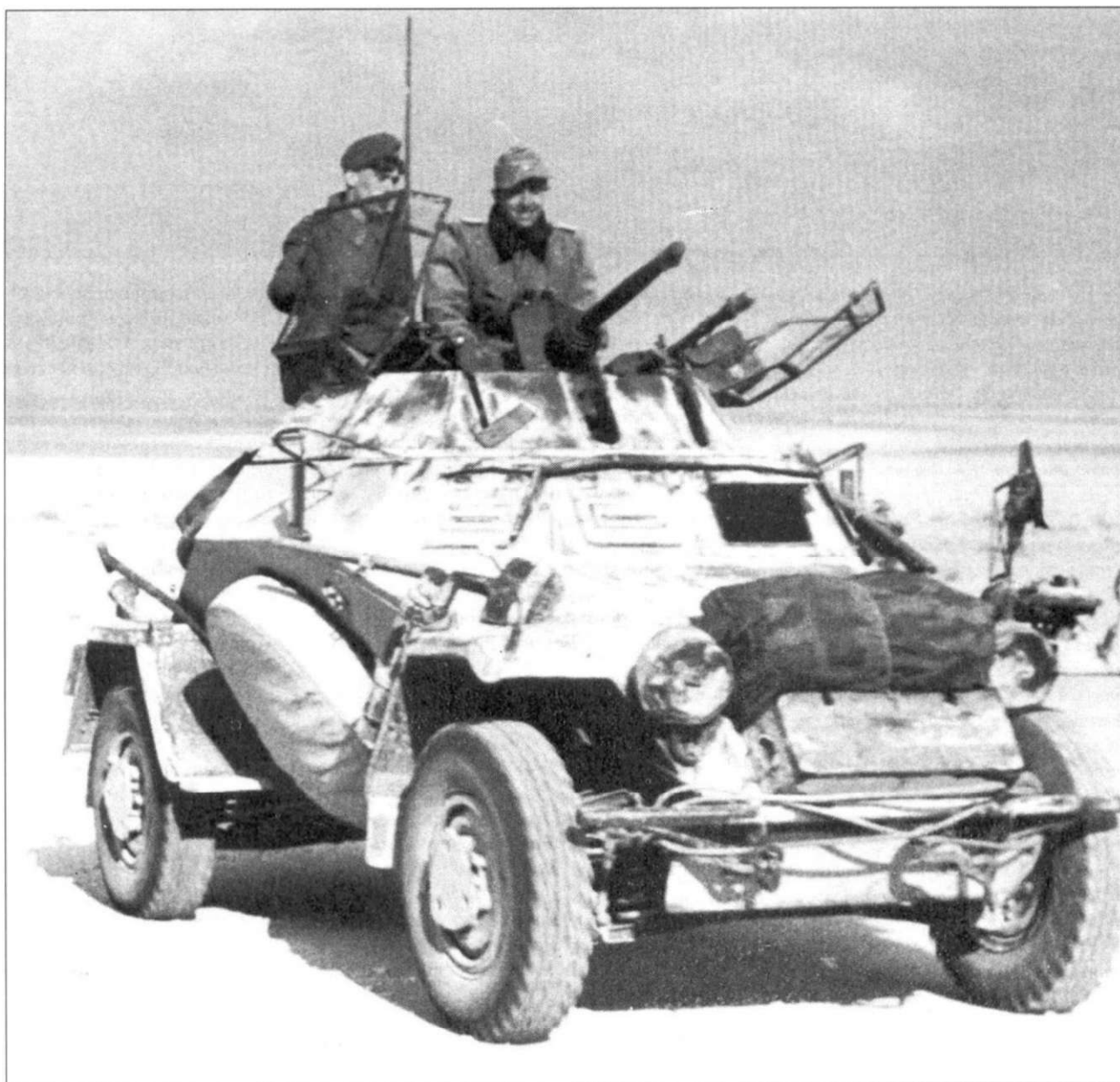
Легкая двухосная бронемашина SdKfz 222 раннего выпуска сфотографирована в Ливии в начале 1941 г. Оригинальная темно-серая окраска покрыта затвердевшим слоем грязи, которая после высыхания имела светло-желтый цвет. Обратите внимание, что темно-серая краска проглядывает на верхних участках башни - грязевое покрытие быстро стиралось. Для изменения цвета интерьера машины грязь не применялась.
