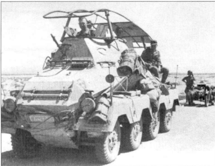
Тяжелая бронемашина связи SdKfz 263 полностью «окрашена» грязью. Эмблема - африканская пальма на левом наклонном броневом листе нарисована на темно-серой базовой окраске. Как и все машины в пустыне, этот экземпляр так же несет очень много дополнительного оборудования, уложенного на броне. На антенне натянут солнцезащитный тент.
