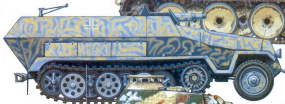
Самоходная установка с 75 мм короткоствольной пушкой SdKfz 251/9c, Россия, 1943 г. Окрашен базовым темно-серым цветом, поверх которого распылителем нанесены волнистые линии темно-желтой краски.
