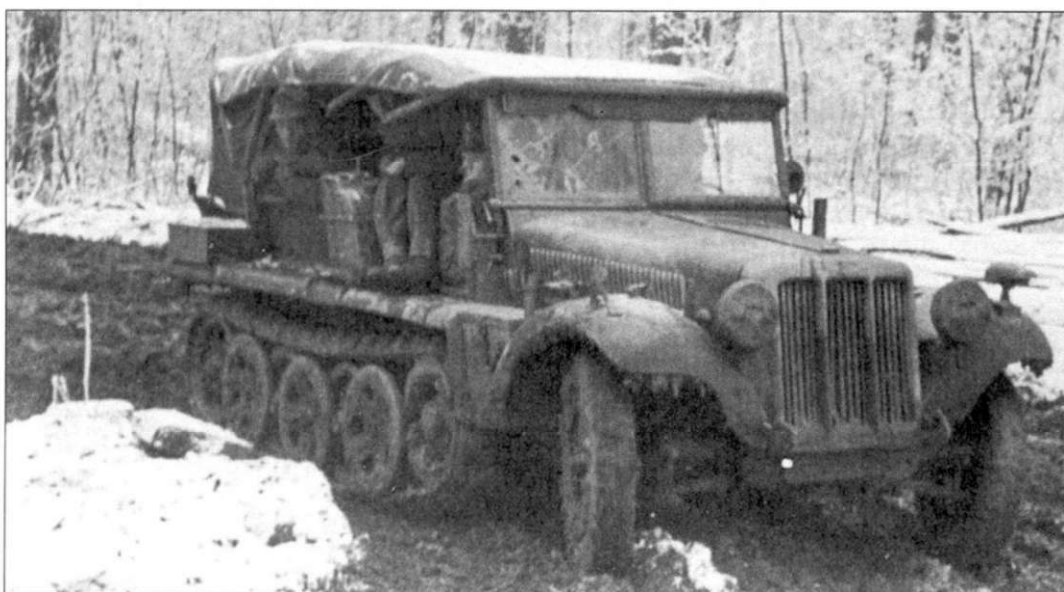
Легкий полугусеничный тягач SdKfz 10 продвигается по грязной проселочной дороге под Ленинградом в начале 1942 г. Его темно-серая окраска почти полностью закрыта разбрызганной жидкой грязью. После высыхания грязь станет более выразительного земляного оттенка.
