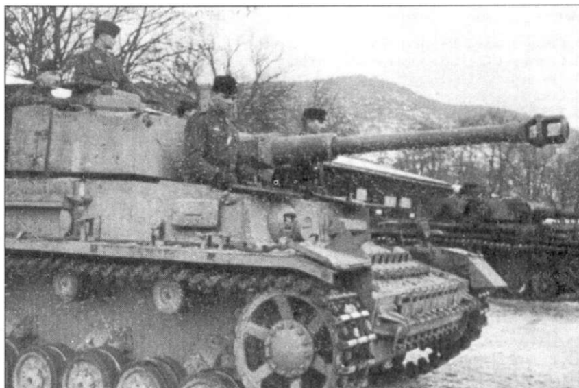
Танк PzKpfw IV Ausf G полностью перекрашен в темно-желтый цвет. Танк PzKpfw III Ausf N на заднем плане имеет широкие темно-желтые полосы, нанесенные распылителем поверх темно-серого цвета. Так же как и гораздо более поздний PzKpfw IV Ausf G, этот экземпляр имеет экраны на башне.
