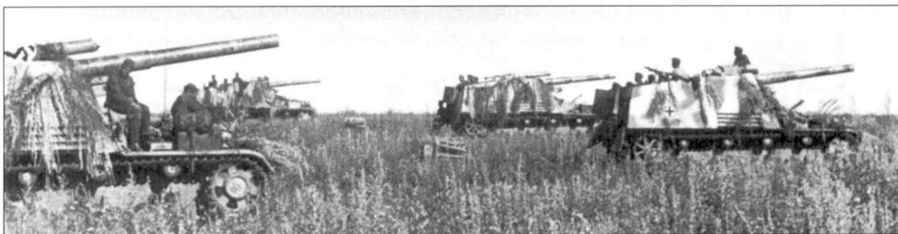
Самоходные орудия «Нитте» окрашены с использованием необычной схемы. На базовый темно-серый цвет сначала нанесена распылителем темно-зеленая краска. В то время когда был сделан этот снимок, поверх обоих этих цветов были накрашены большие новые пятна темно-желтого цвета. Некоторые машины дополнительно замаскированы листвой.
