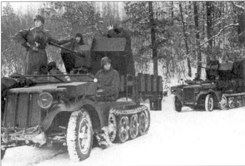
Два полугусеничных легких тягача SdKfz 10/4 с установленными на них зенитными пушками, Россия, 1941 г. Несоответствие темно-серой краски белому снегу очевидно. Кроме того что темно-серая краска сама по себе контрастировала со снегом, отсутствие зимой пыли и грязи еще усиливало этот эффект.
