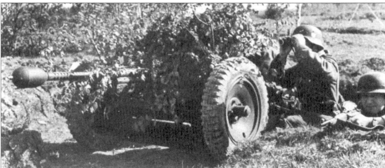
37-мм противотанковое орудие РАК 36 с установленной надкалиберной противотанковой гранатой «Stilgranate» окрашено в темно-серый цвет. Для лучшей маскировки от противника его ствол и щит укрыты ветками.
