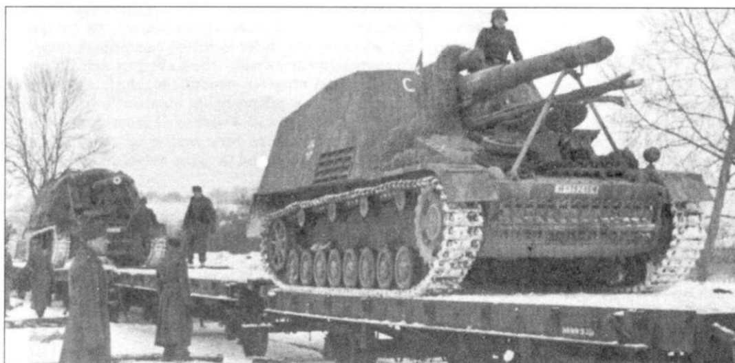
Самоходные орудия «Hummel» из бронетанкового подразделения СС окрашены по двухцветной камуфляжной схеме: темно-зеленые пятна нанесены из краскопульты на темно-серый базовый цвет. Буква «С» на лобовой броне возле ствола пушки - значок третьей батареи в подразделении.
