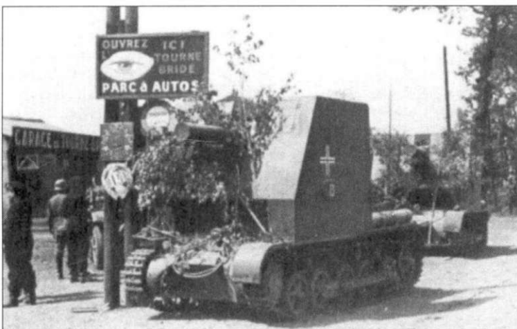
Тяжелая самоходная 150 мм гаубица SIG 33 на шасси легкого танка PzKpfw I Ausf B демонстрирует использование листьев для усиления эффективности камуфляжа. Французский плакат наверху - указатель места парковки автомобилей.
