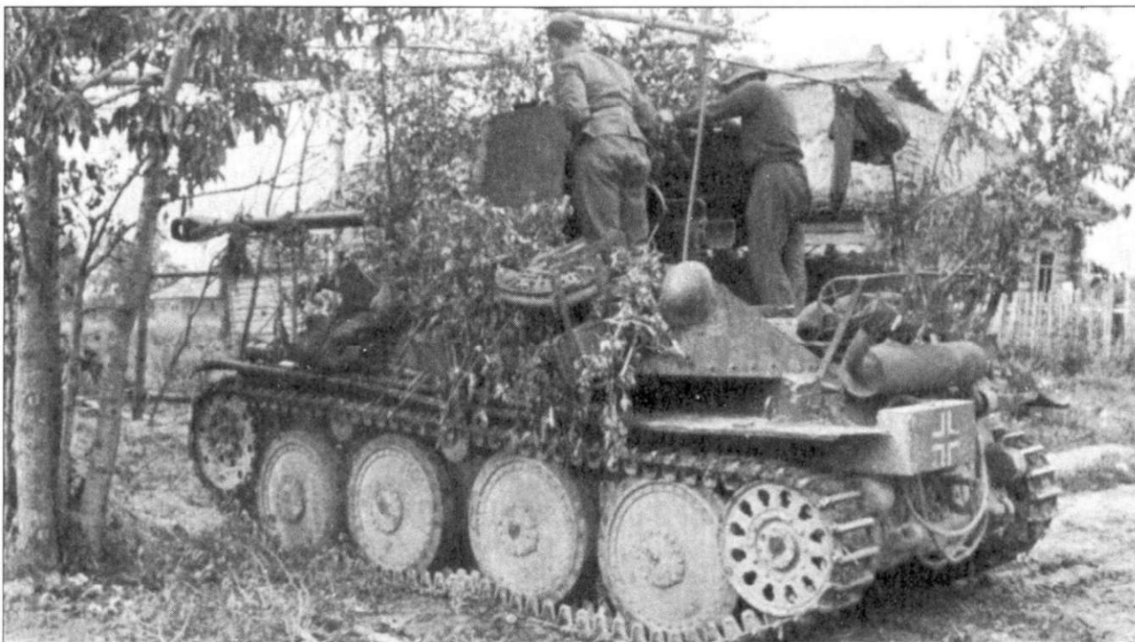
«Marder III» (советское 76,2 мм орудие РАК36r, в соответствии с немецкой классификацией, на шасси PzKfw38 (t)) окрашен в темно-серый цвет, на опорных катках высохшая грязь. Укрепленные на нем ветки скрывают высокую надстройку и помогают слиться с окружающими деревьями.
