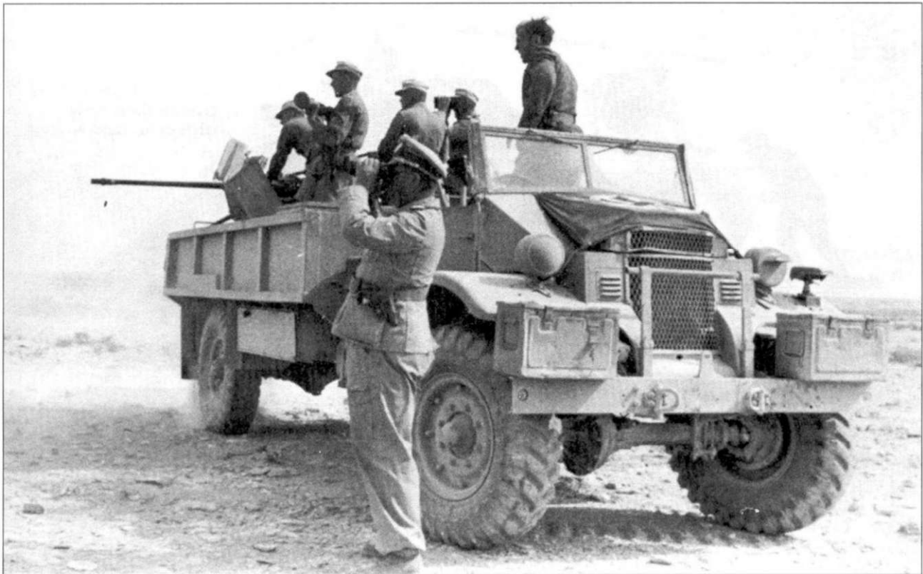
Захваченный британский грузовик Canadian CMP переделан в самоходную артиллерийскую установку с 20-мм пушкой Flak 38. Машина полностью перекрашена в желто-коричневый цвет. Флаг, укрепленный на капоте, служит для облегчения идентификации машины пилотам Люфтваффе.
