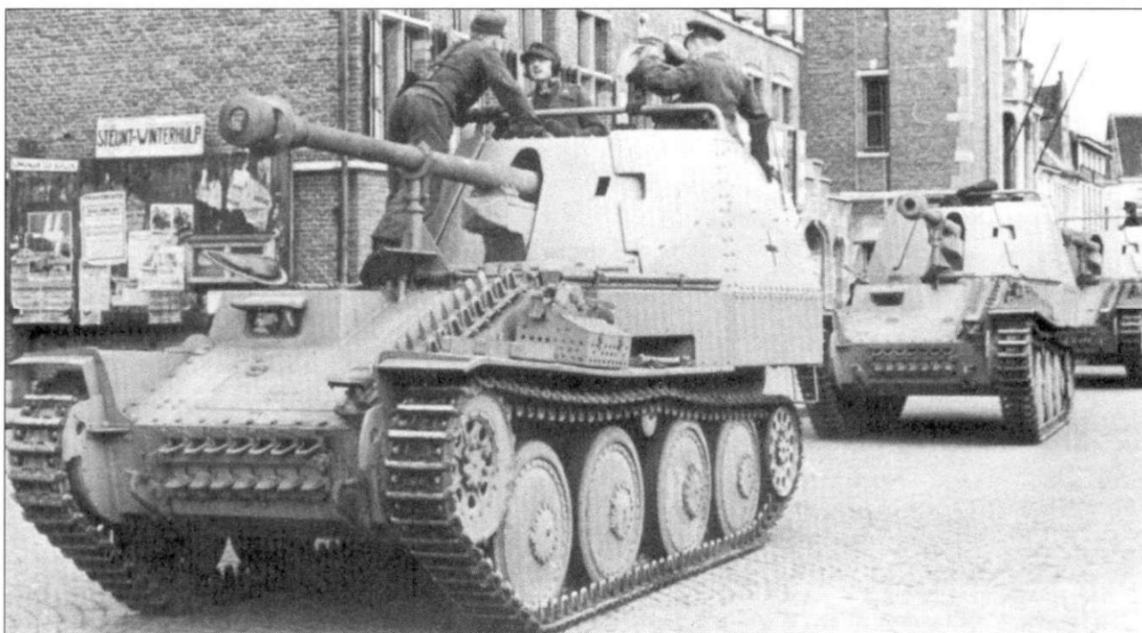
Marder III Ausf M, сфотографированные во Фландрии в 1944 г., демонстрируют эффект изменения оттенка красочного покрытия после длительного срока службы. Сравните переднюю часть пушки и верхние поверхности машины, которые укрывались маскировочными сетями.
