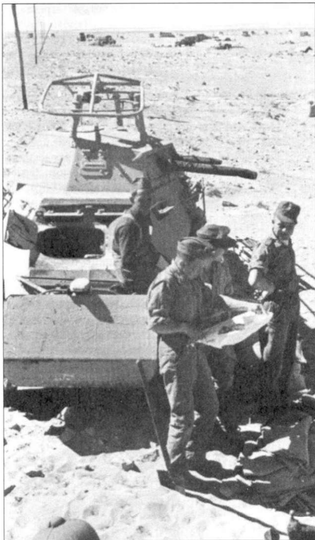
Восьмиколесная тяжёлая бронемашина связи SdKfz 232 демонстрирует текстурированный узор на переднем броневом листе, возникший в результате высыхания использовавшейся в качестве покрытия грязи. Это толстое покрытие обычно получалось гораздо грубее, чем окрашенная поверхность.
