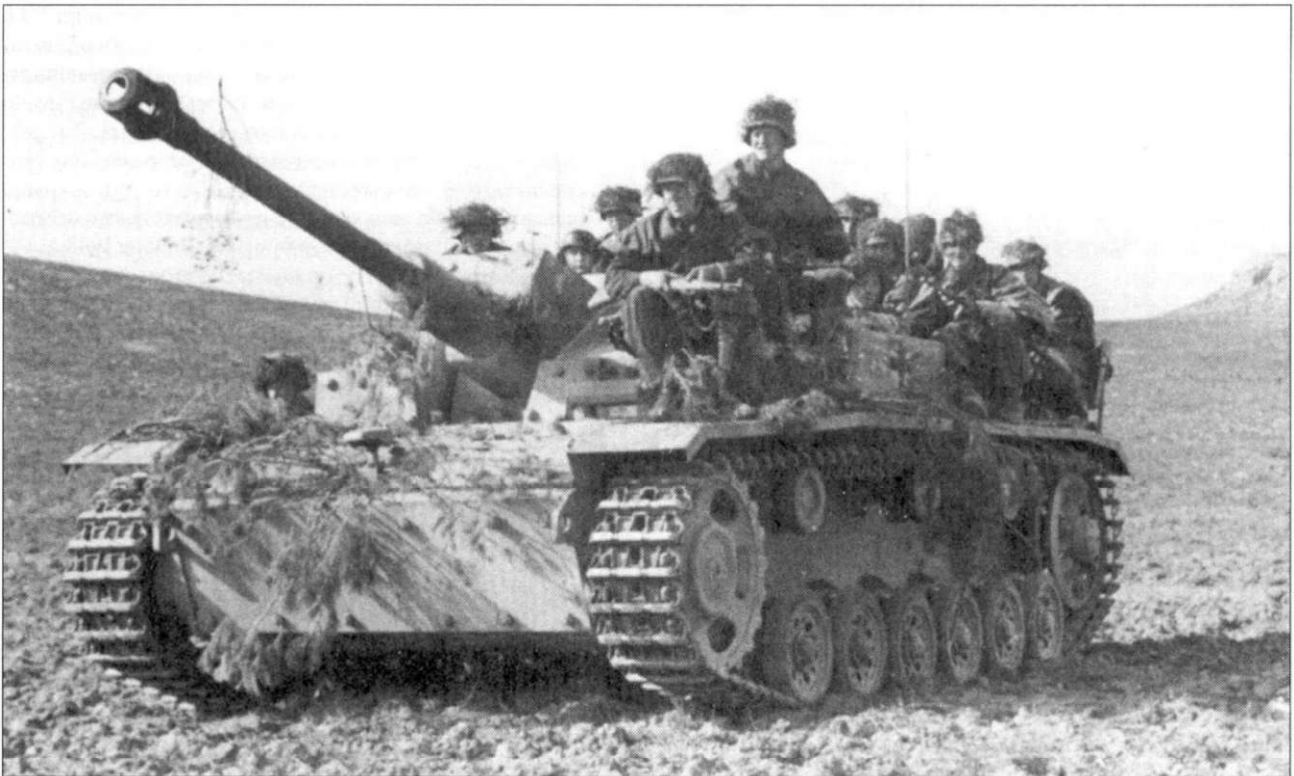
Штурмовое орудие StuG III Ausf F сфотографировано в Тунисе. Машина из состава одного из последних пополнений НАК, достигших Африки. Машина окрашена полностью в темно-желтый цвет. Ветки использовались для того, чтобы скрыть углы ее передней части. В Тунисе был гораздо более умеренный климат, чем в Ливийской пустыне, и многие солдаты, как те, что видны на снимке, носили стандартное европейское обмундирование.
