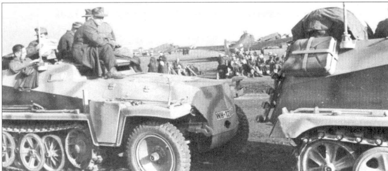
Два подгусеничных бронетранспортера SdKfz 250 в заводской окраске - на базовом желто-коричневом цвете нанесены распылителем серо-зеленые полосы. Это превосходный пример аккуратного камуфляжа, выполненного «по уставу» - в точном соответствии с принятыми в то время правилами.
