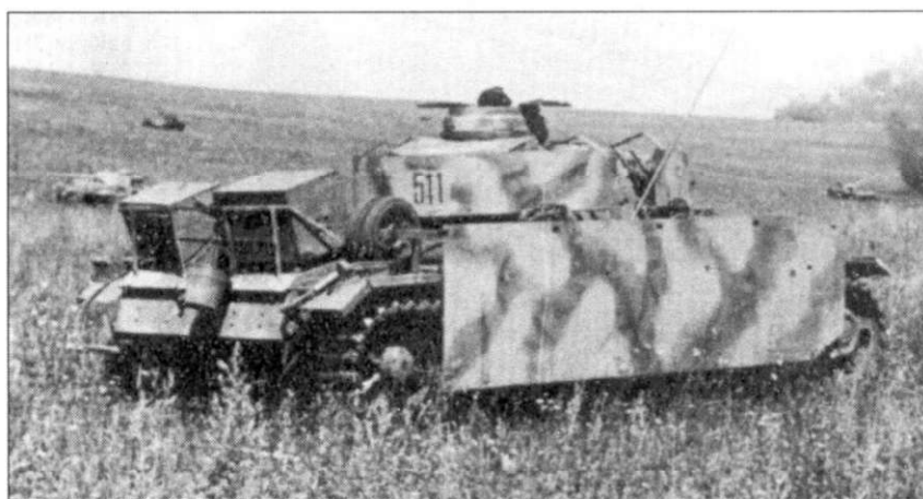
Танк PzKpfw III Ausf L, сфотографированный в России, имеет подобную предыдущей фотографии схему окраски. Поверх старой окраски состоящей из тонких темно-зеленых линий на темно-сером фоне, нанесена распылителем темно-желтая краска. Старые цвета служат вторым оттенком камуфляжной схемы. Tактический номер черный.
