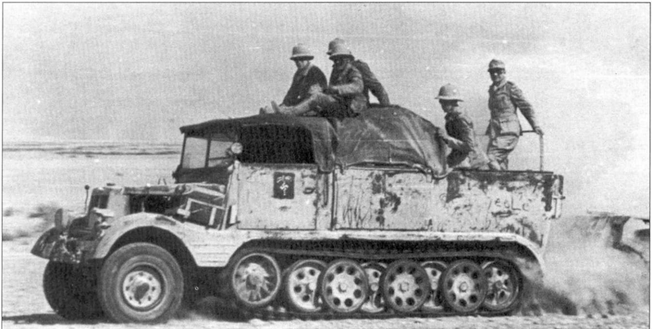
3-тонный тягач SdKfz 11 демонстрирует пример частично стертой, грязевой «окраски». Темные пятна и штрихи свидетельствуют о том, что машина была обмазана грязью, а не покрашена.
