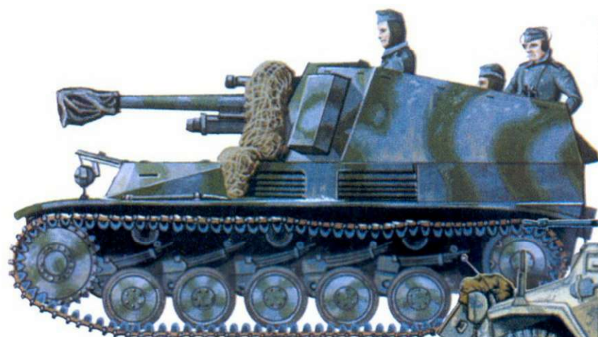
Самоходное орудие Wespe (105 mm le. F.H. 18), Россия, зима 1941-42 гг. Окрашено в темно-серый цвет, поверх которого нанесены темно-зеленые полосы.
