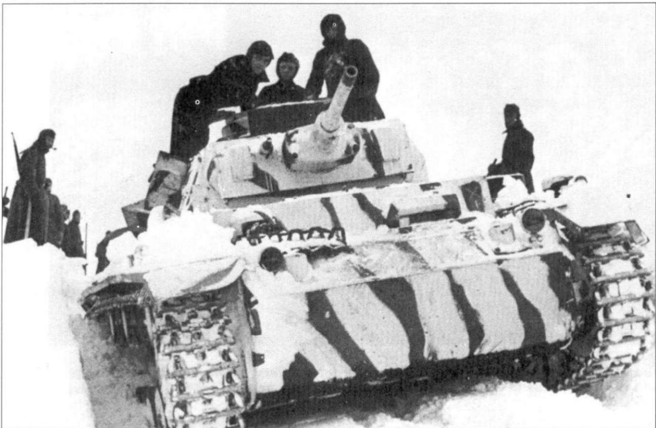
Средний танк PzKpfw III Ausf J из 5-й танковой дивизии имеет схему камуфляжной окраски состоящую из широких белых полос нанесенных побелкой на темно-серый базовый цвет. К тому же снег лежащий на левой надгусеничной полке является как бы дополнительным средством камуфляжа.
