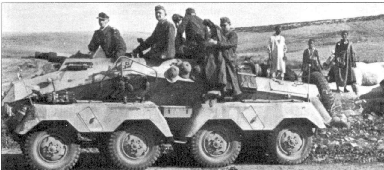
Самоходная 75 мм гаубица SdKfz 233 так же сфотографирована в Тунисе. Коричнево-пустынная краска местами содрана и износилась. Обратите внимание на пробковые шлемы старого образца, которые еще использовались в то время.
