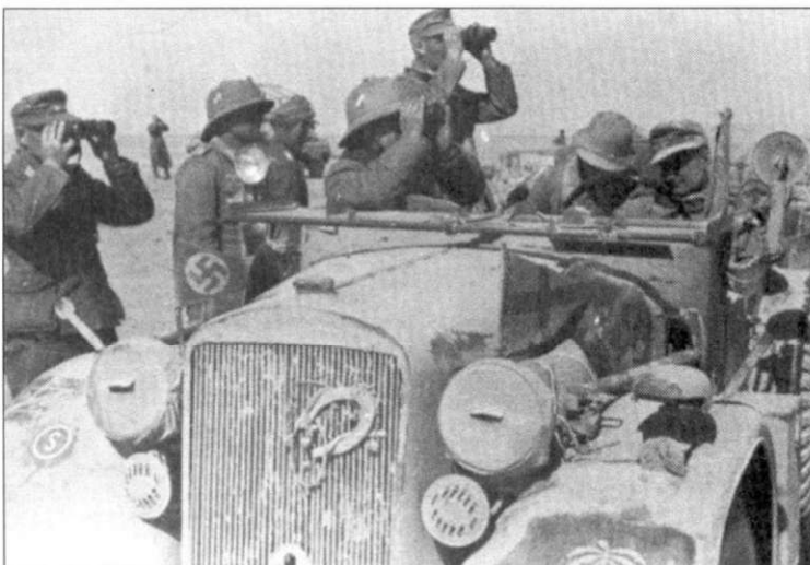
Тяжелая бронемашина связи SdKfz 263 полностью «окрашена» грязью. Эмблема - африканская пальма на левом наклонном броневом листе нарисована на темно-серой базовой окраске. Как и все машины в пустыне, этот экземпляр так же несет очень много дополнительного оборудования, уложенного на броне. На антенне натянут солнцезащитный тент.
