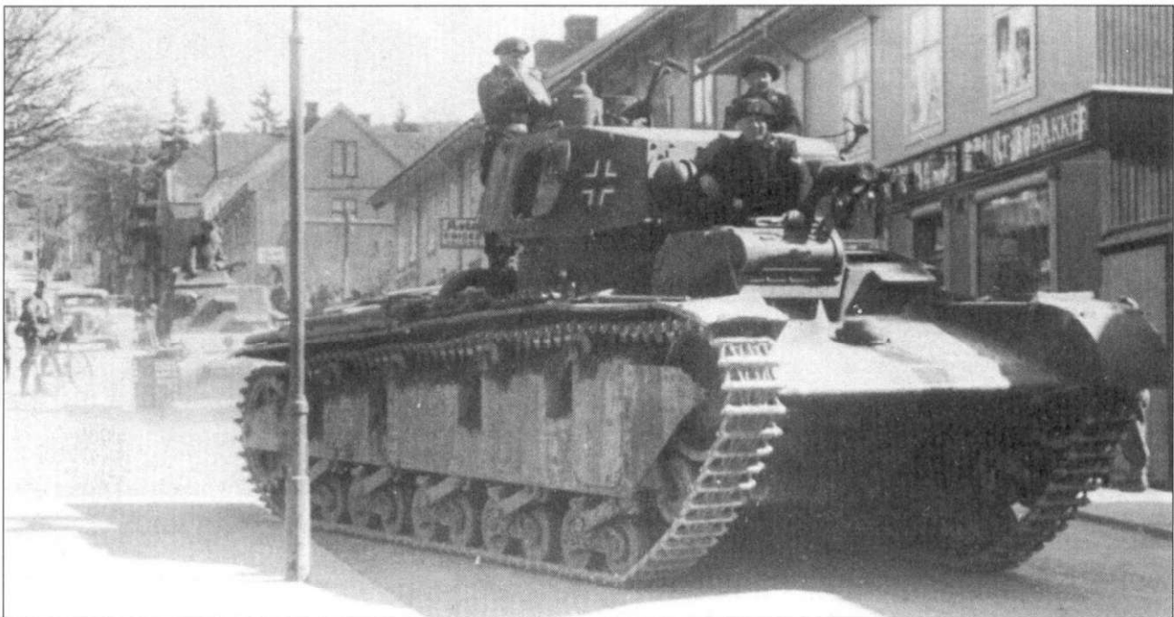
Один из трех прототипов тяжелого танка PzKpfw Nb.Fz «Neubaufahrzeuge», направленных в Осло во время вторжения в Норвегию, 1940 г. Танк окрашен полностью в темно-серый цвет, на его нижней части лежит слой пыли. Командирский танк на заднем плане покрыт таким толстым слоем пыли, что он существенно осветляет его цвет.
