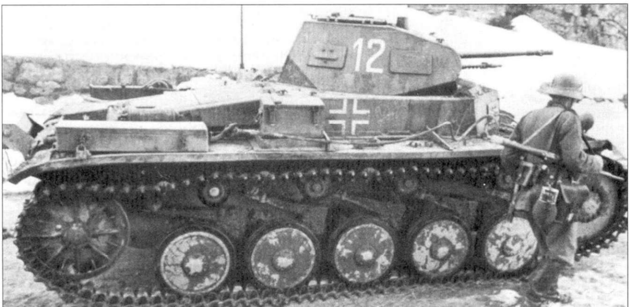
Легкий танк PzKpfw II Ausf C в Норвегии, окрашен полностью в темно-серый цвет. Номер и крест белые. Катки залепаны грязью, брызги воды со ступиц превратили ее в некоторых местах в темно-коричневые, влажные пятна.
