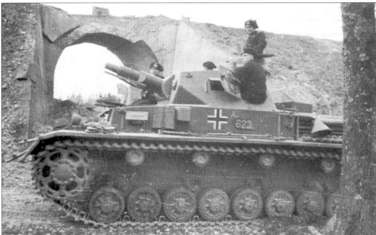
Средний танк PzKpfw IV Ausf D из 5-й танковой дивизии сфотографирован во Франции в 1940 г. Основной темно-серый цвет его окраски только слегка прикрыт пылью. Номер танка и дивизионный значок нанесены темно-желтой краской. Обратите внимание на новый стиль нанесения креста, который снижает его заметность для вражеских артиллеристов.
