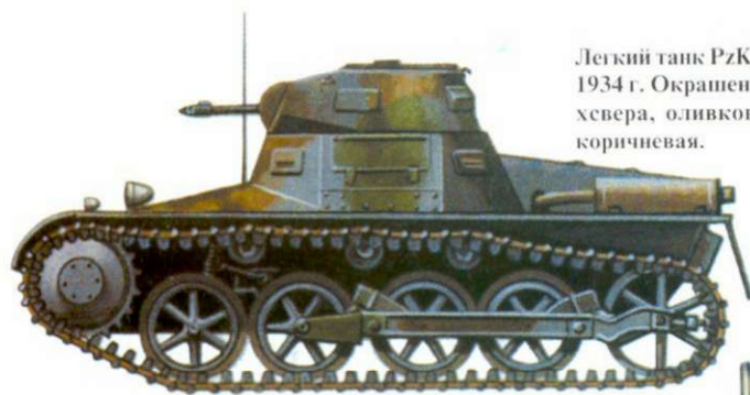
Легкий танк PzKpfw I Ausf A, Германия 1935 г. Окрашен красками: темно-серая и темно-коричневая.
