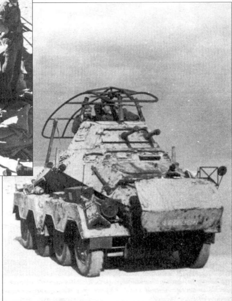
Восьмиколесная тяжёлая бронемашина связи SdKfz 232 демонстрирует текстурированный узор на переднем броневом листе, возникший в результате высыхания использовавшейся в качестве покрытия грязи. Это толстое покрытие обычно получалось гораздо грубее, чем окрашенная поверхность.
