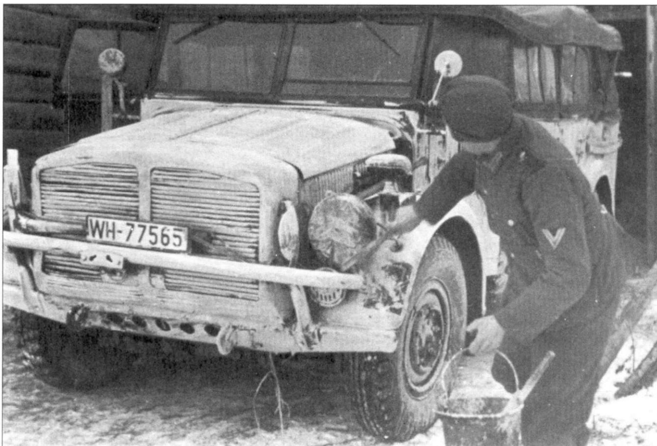
Автомобиль Horch Kfz 15 т.Е.Рkw в конце процесса нанесения покрытия из побелки. Корпус машины полностью покрыт ею, однако тент крыши остался неокрашенным.
