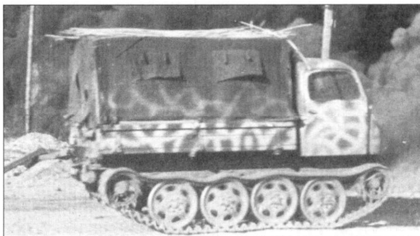
Легкий гусеничный грузовик-тягач RSO (Steyr) сфотографирован в России. Кабина и нижняя часть кузова покрыта нанесенными распылителем соединяющимися линиями темно-желтой краски. Длинные прутья, уложенные на крыше тента, вероятно служат для дополнительной воздушной маскировки.
