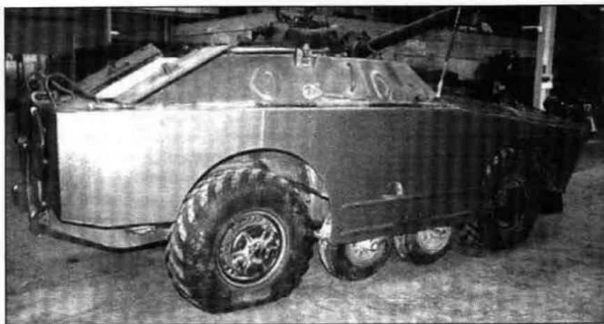
БРДМ-1. В нижней части корпуса видны дополнительные подъемные колеса с активным приводом.
