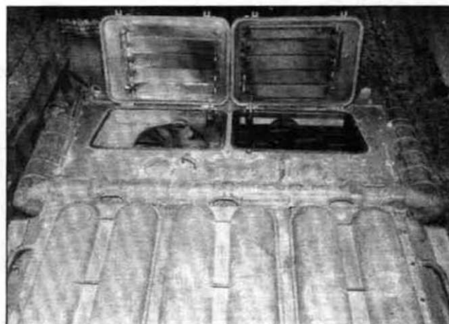
Откинутые крышки жалюзи над вентиляторами системы охлаждения двигателей. Вид с кормы (слева) и сверху-спереди (справа). На этих фото хорошо видны сами вентиляторы и кожухи воздухоотводов. Здесь же видна характерная форма крышек прикрывающих двигатели.
