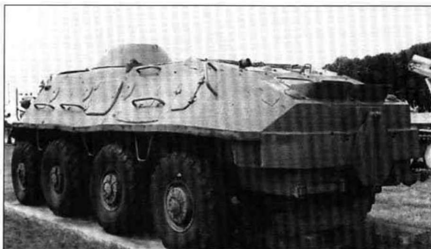
БТР-60ПБ вид сзади. Хорошо видны отверстие для выброса воды из обводного канала водомета, буксирное устройство, заслонка водомета
