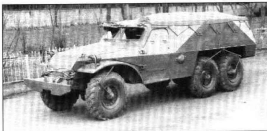
БТР-152В1 с штангами внешней подкачки колес.
