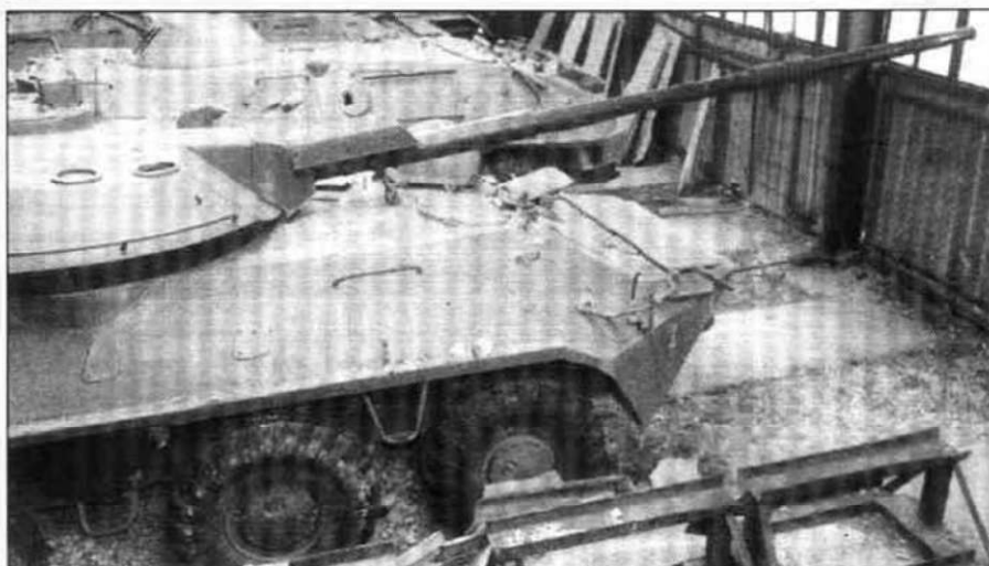
На фото хорошо виден характерный длинный ствол 85-мм пушки с эжектором и дульным тормозом оригинальной (перфорированной) конструкции.
