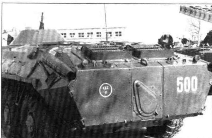
БТР-70 вид сзади. Хорошо видны задние габаритные фонари, кожух выхлопной трубы, крепление лопаты.
