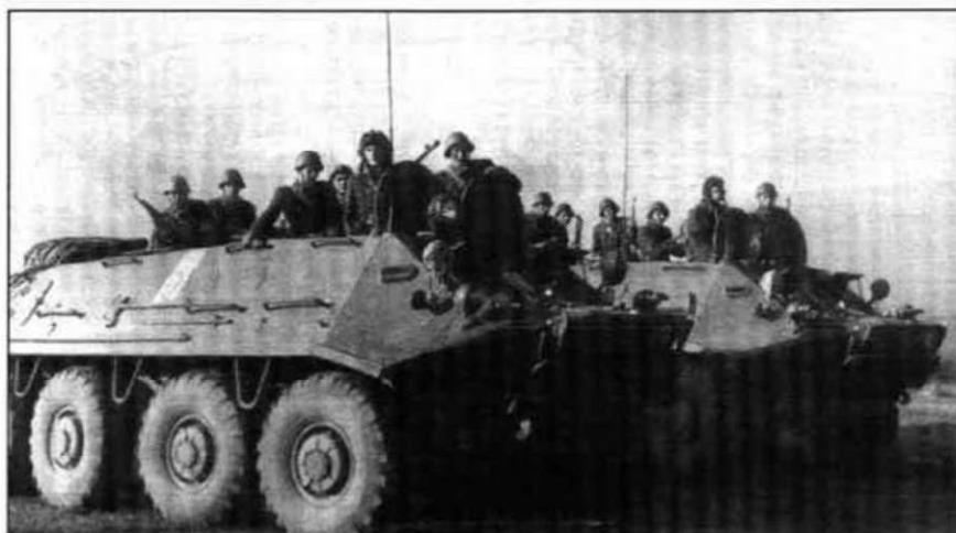
БТР-60ПА болгарской армии. Люки на крыше бронетранспортеров открыты и из них выглядывают экипаж и десантники. На кормовой части переднего бронетранспортера укреплено запасное колесо.
