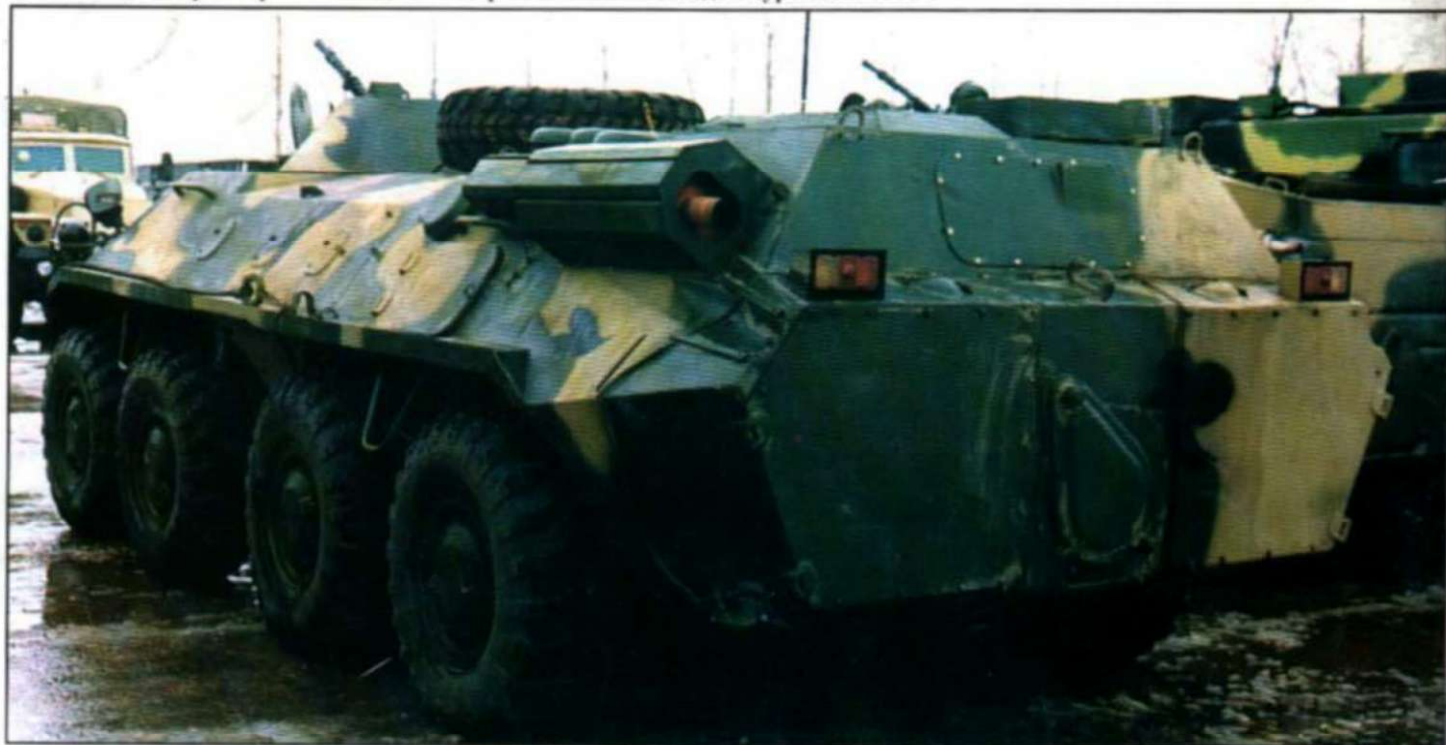
БТР-70, модернизированный до стандарта БТР-80 на заводе «Муромтепловоз».
