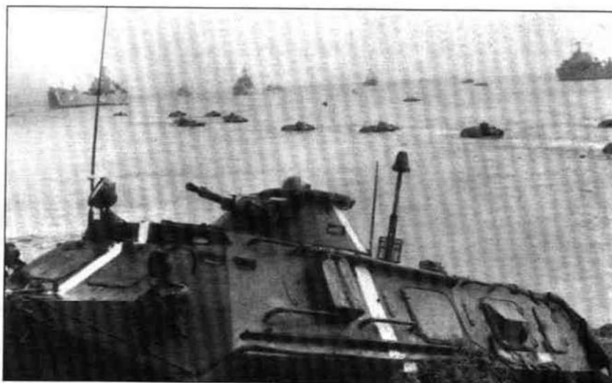
Командирский бронетранспортер на базе БТР-60ПБ морской пехоты во время учений. Хорошо видны дополнительные антенны и выступающая крышка прикрывающая генератор (в задней части корпуса).
