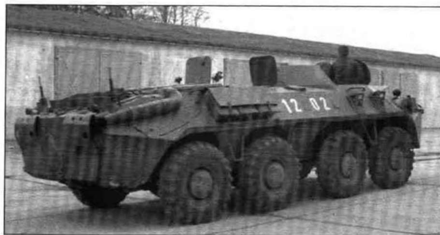
БТР-70 - крышки верхних десантных люков подняты. На борту закреплены три канистры и два тормозных башмака. На корме установлены не характерные для БТР-70 бамперы (использовавшиеся на БТР-80 раннего типа). Вероятно это было сделано во время одного из ремонтов.
