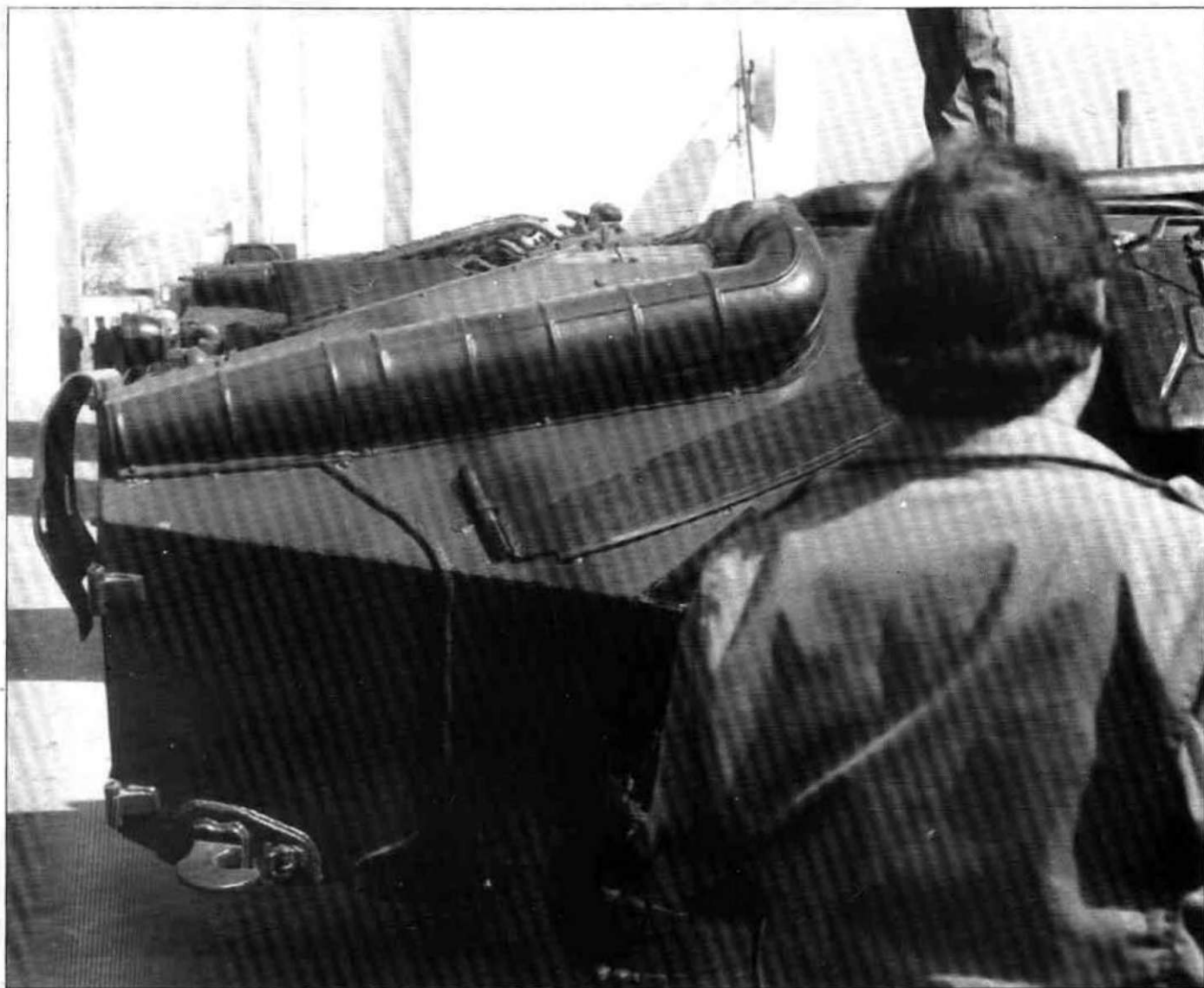
БТР-70: глушитель правого двигателя, под ним - крепление пилы.
