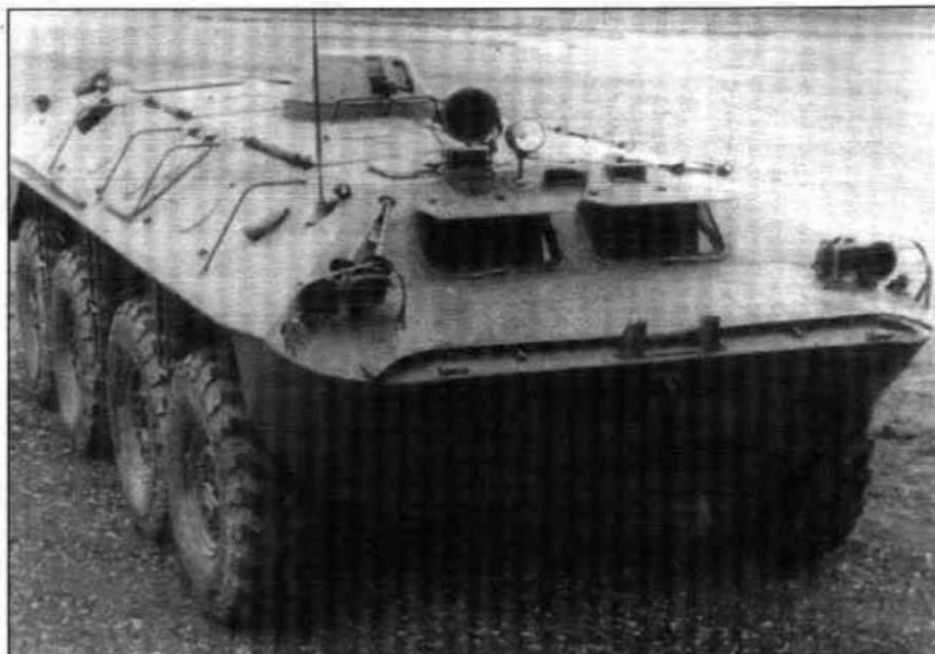
Опытный образец бронетранспортера «Объект 1015-Б». Видна крыша с десантным люком и башня, вооруженная 7,62-мм пулеметом ПКТ, заимствованная с МТЛБ.
