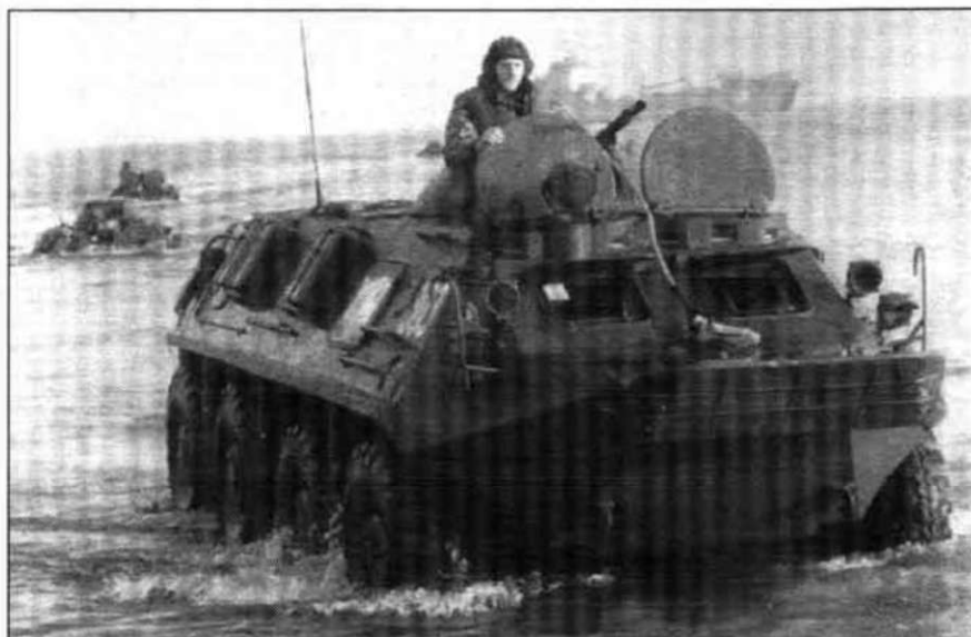
БТР-60ПБ выходят на берег. На борту хорошо видны закрепленные канистры для дополнительного топлива.
