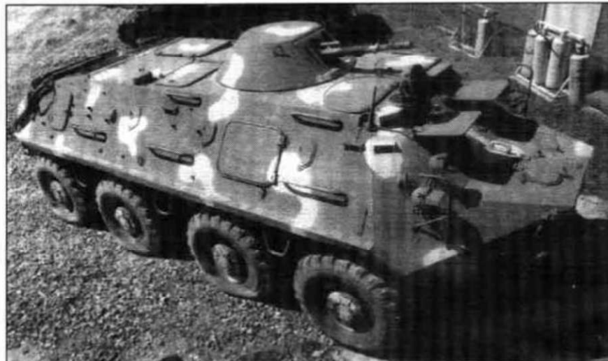
БТР-60ПБ ранних выпусков. Хорошо видны бортовой десантный люк, приборы наблюдения командира, глухие броневые крышки передних смотровых люков. Машина из экспозиции одного из зарубежных музеев, поэтому достоверность окраски вызывает сомнение.
