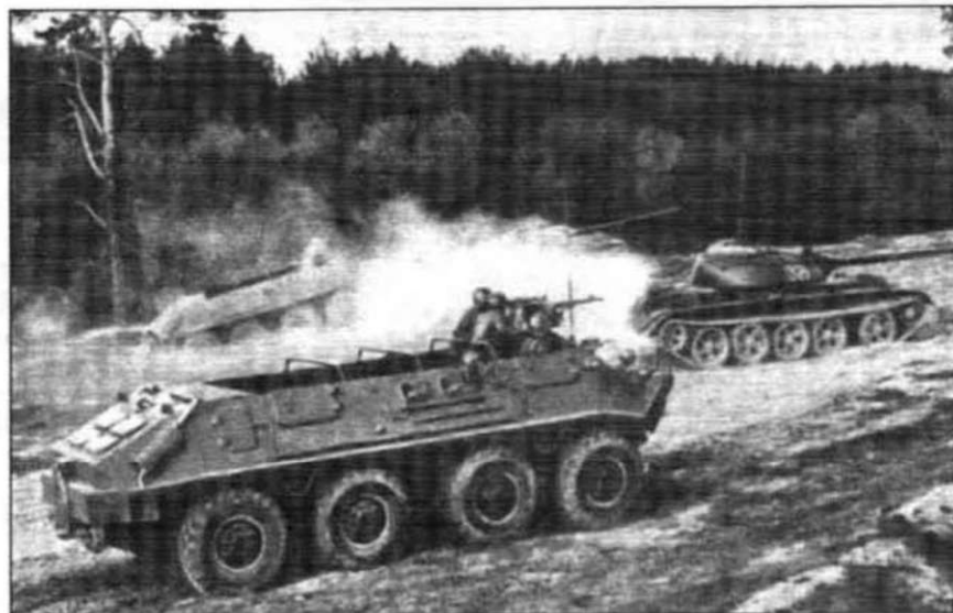
БТР-60П сфотографированный во время учений. Хорошо видна открытая верхняя часть корпуса с установленными дугами тента. Обратите внимание на бортовые амбразуры из которых торчат автоматы десантников
