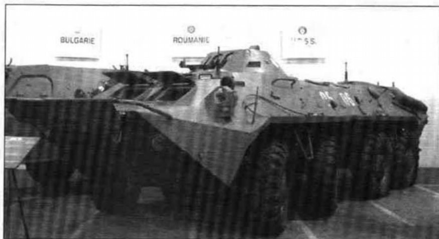
БТР-70 поздних выпусков. Пулемет КПВТ снят, волноотражательный щиток поднят. Хорошо видно, что две передние пары колес поворотные.
