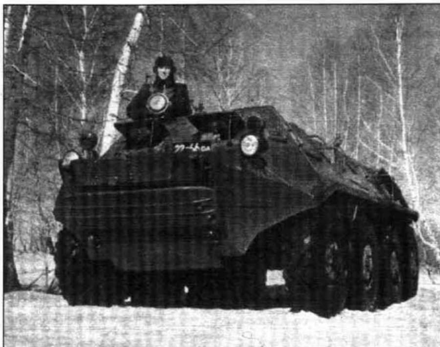
БТР-60П. Хорошо видна форма броневых листов передней части корпуса, расположенных со значительными углами наклона к вертикали и волноотражательный щиток.
