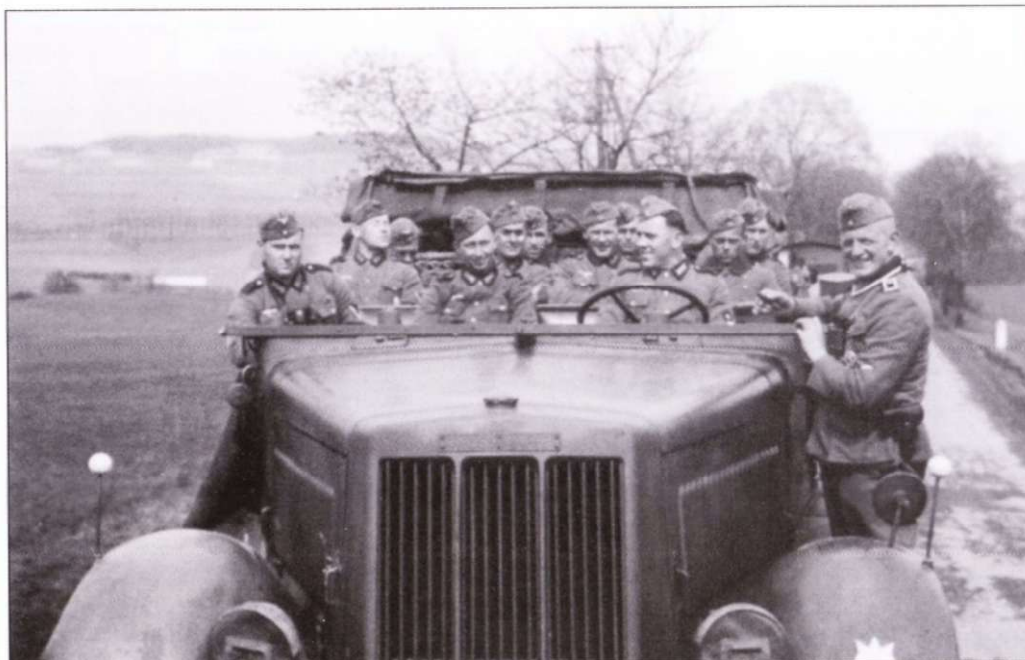
Sd.Kfz. 7 с экипажем. Эмблема фирмы Краусс-Маффей заметна над радиатором. Другие фирмы выпускавшие полугусеничные тягачи устанавливали свои эмблемы. Их машины могли отличаться незначительно конструкцией кузова и отдельных элементов.
