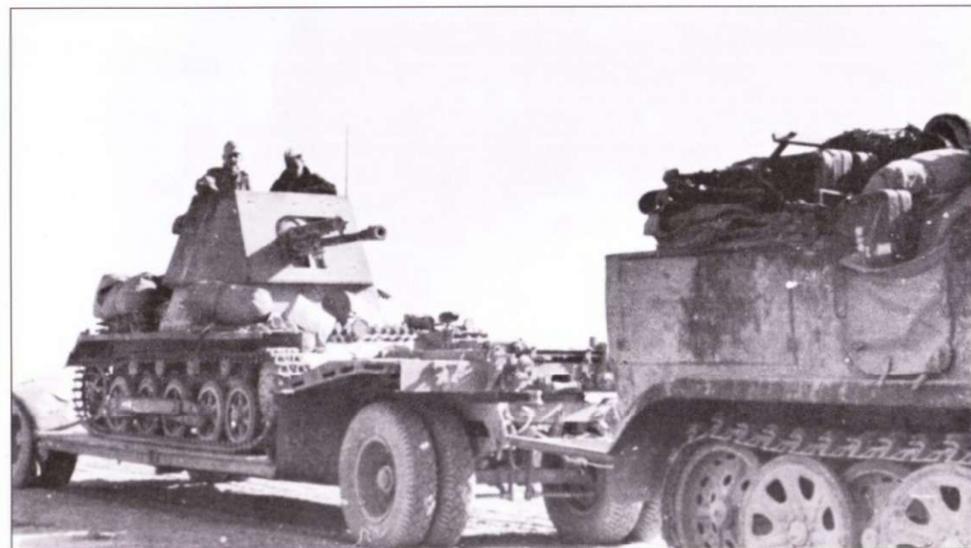
Использование трейлеров для ускоренной переброски бронетехники существенно сокращало ее преждевременный износ. Эвакуация подбитых машин или требующей ремонта техники также осуществлялась при помощи этих прицепов. На снимке легкий танк 4,7 см Pak (t) (Sfl) auf Pz.Kw.I ohne Turm на специальном прицепе типа 115.
