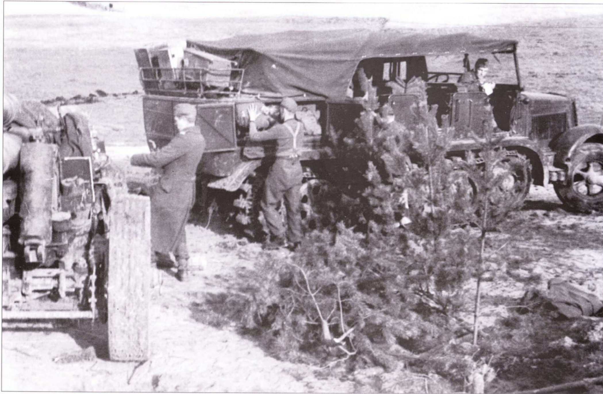
Восточный фронт. На Восточном фронте большинство тягачей уже оборудовали открытыми багажниками в корме. Передние колеса всех тягачей Sd.Kfz. 7 были спицованными, в то время как большинство других германских полугусеничных тягачей имели колеса с дисками.
