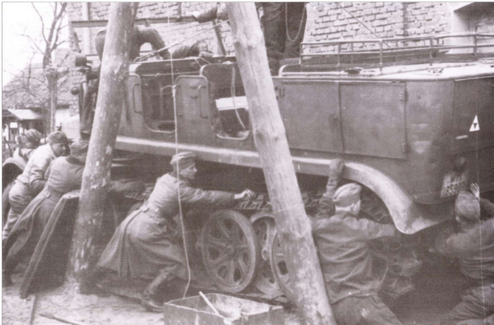
Ремонт Sdkfz 7 был трудным делом и требовал от ремонтной команды больших усилий. На снимке показана бригада за ремонтом подвески и кабестан (грузовая лебедка). Противопожарная перегородка удалена на время ремонта.
