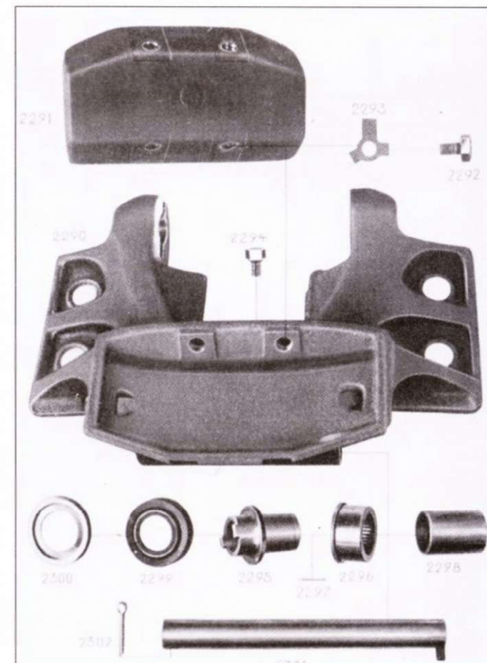
Конструкция траков гусеницы
