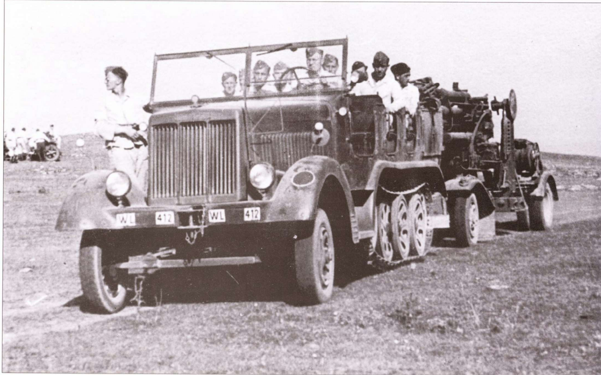
На этом снимке хорошо видны круглые крылья серийных тягачей КМ т 9 и КМ т 10. Такие крылья придумали на фирме Бюссинг-NAG, после чего их немедленно переняли на фирме Краусс-Маффей. Два крыла и передней бампер фактически образуют единый конструктивный узел. Тягачи КМ т 9 и КМ т 10 обладали не только возможностью буксировки сверхмощных 88-мм зенитных орудий, но и были способны транспортировать расчеты этих орудий. На фото, сделанное во время предвоенных учений, попала машина ранней постройки из подразделения люфтваффе. Буксирные узлы, интегрированные в передние бамперы типичны для артиллерийских тягачей всех наций.
