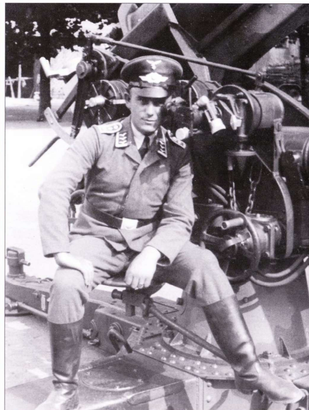
Сержант артиллерийского подразделения люфтваффе позирует у прицела Flakzielfernrohr-20 (или -20E). Прицел был стереоскопическим, но левый окуляр обычно закрывали заглушкой, используя только правый. Выше колена унтера – маховик механизма горизонтального наведения.
