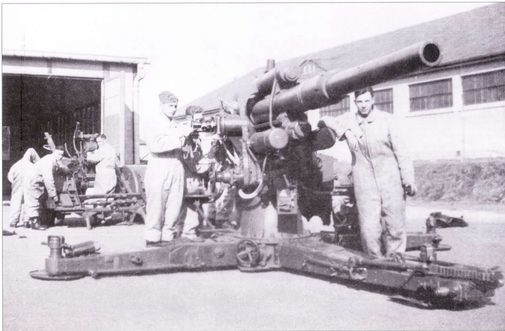
На конце каждой лапы смонтированы массивные домкраты с «подушками», препятствующему зарыванию орудия в грунт при выстреле. Маховик в основании тумбы предназначен для точной выставки лафета в горизонт.
