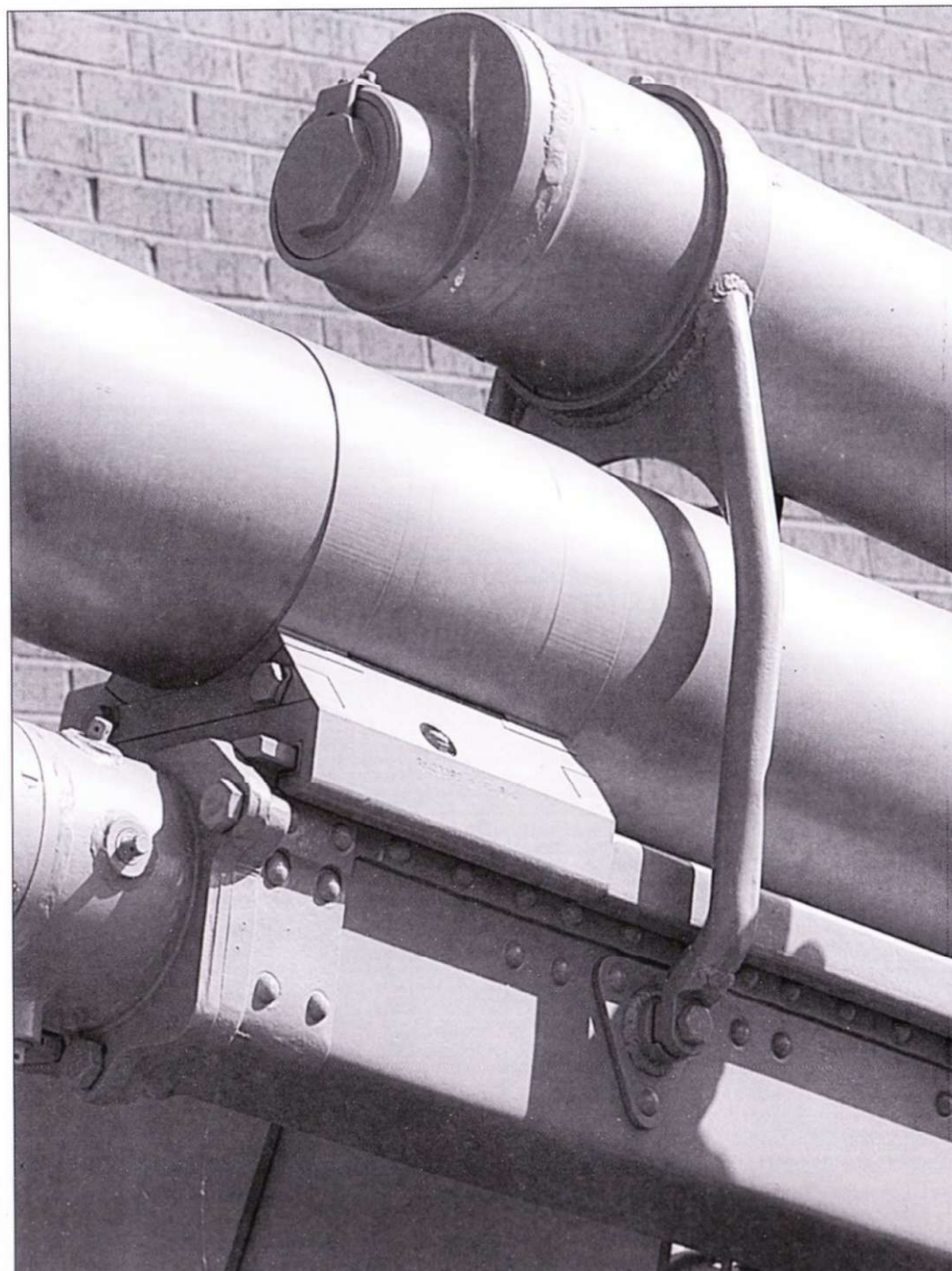
Крепление рекуператора к люльке.
