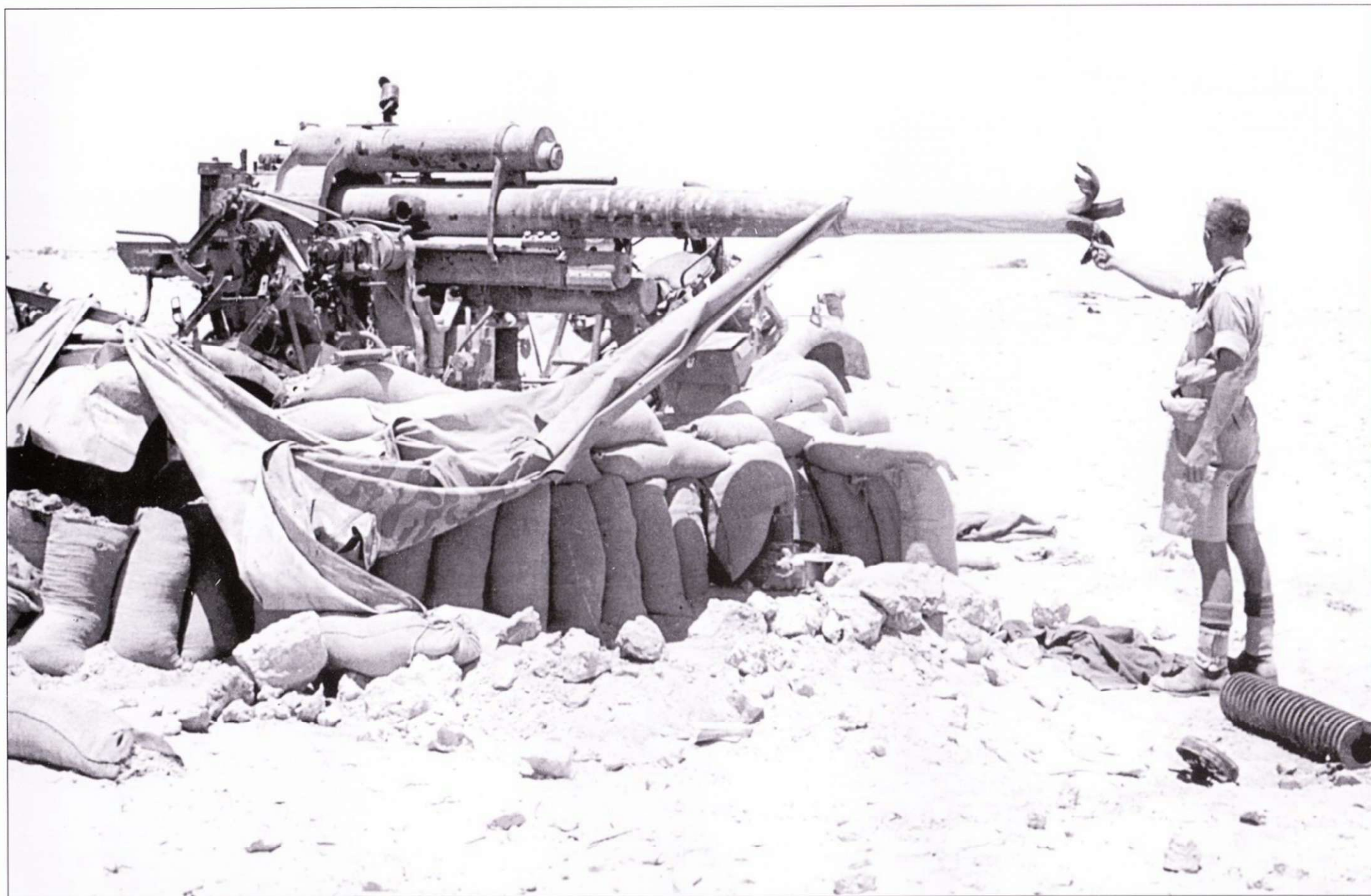
Когда немцы не имели возможности при отступлении забрать технику с собой, они выводили ее из строя. У 88-мм пушек обычно подрывали ствол. Это орудие принадлежало германскому корпусу «Африка».
