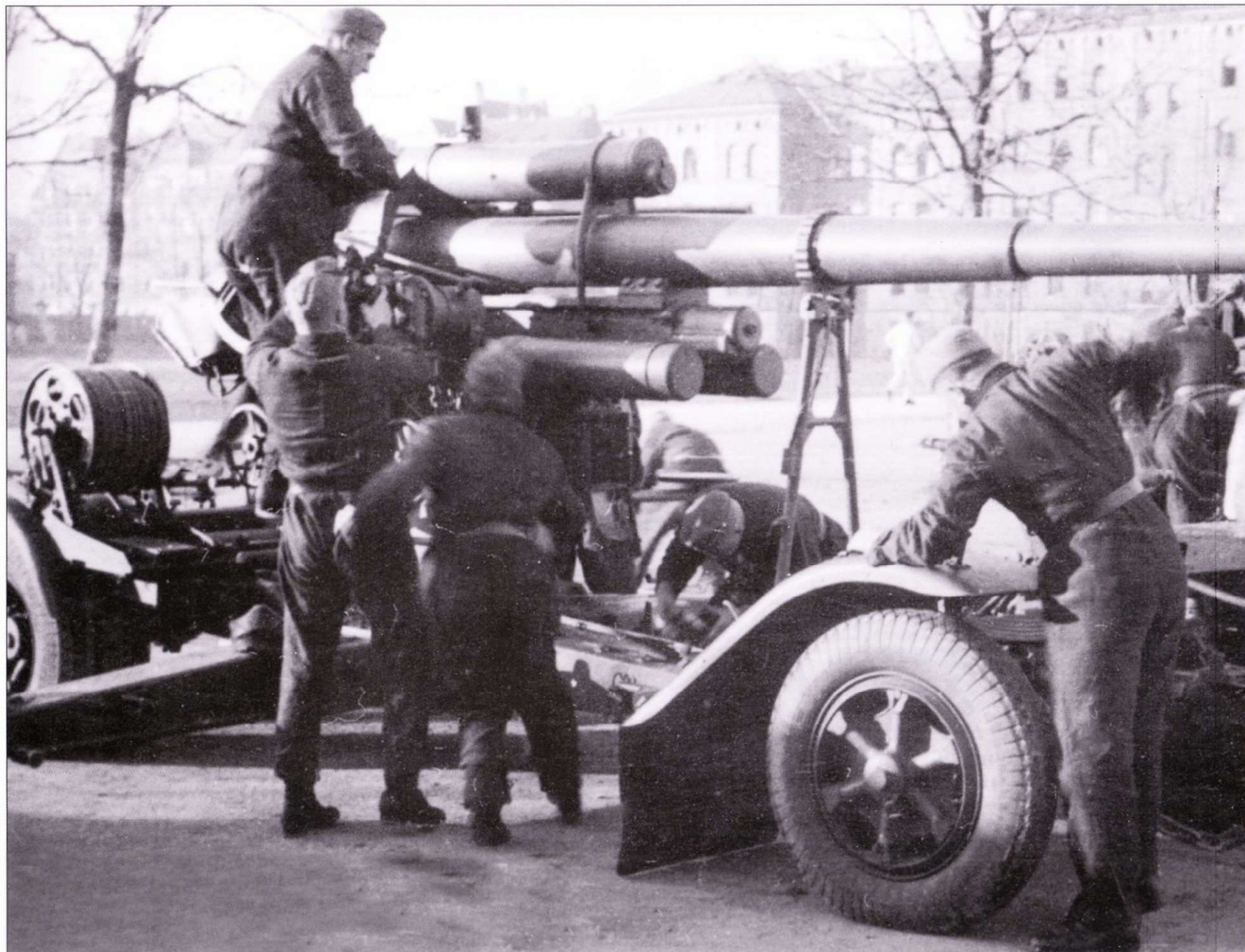
Расчет зенитного орудия Flak-18 на учениях. Расчет пушки состоял из 11 молодых здоровых мужчин. Обязанности членов расчета перераспределялись в зависимости от целей, которые обстреливала пушка. Орудие Flak-18 снабжалось стволом 8.8 см Flak-Rohr 18, ствол легко отличить от стволов орудий иных модификаций по отсутствию уступа.
