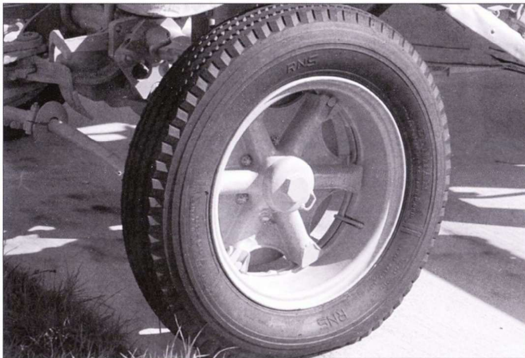
На переднем передке транспорта стояли одинарные колеса, на заднем – двойные.
