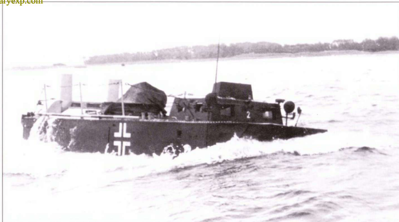
2-й прототип амфибии LWS II на воде. На больших скоростях хода амфибия сильно зарывалась в воду носом. На крыше рубки установлен водотбойной щиток, защищавший верхние рубочные люки от заливания. На палубе установлены леерные стойки с цепным ограждением.
