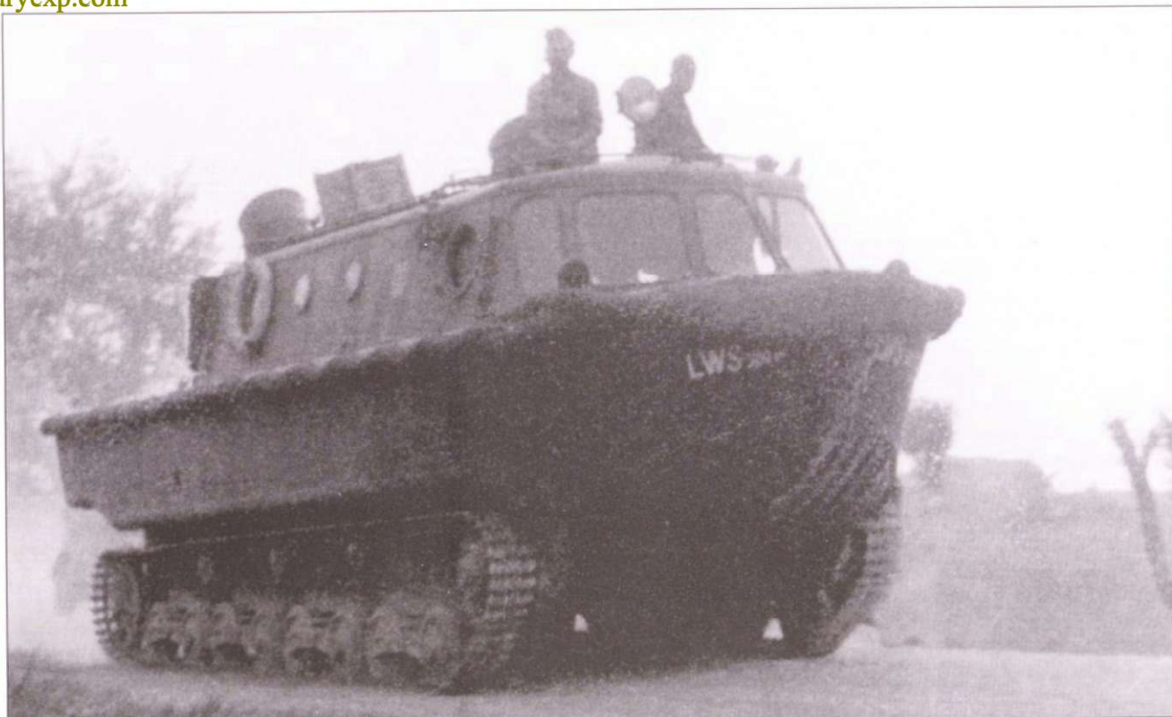
Предсерийная машина LWS 300 с большими окнами в передней части машины и тремя трубами на крыше рубки.
