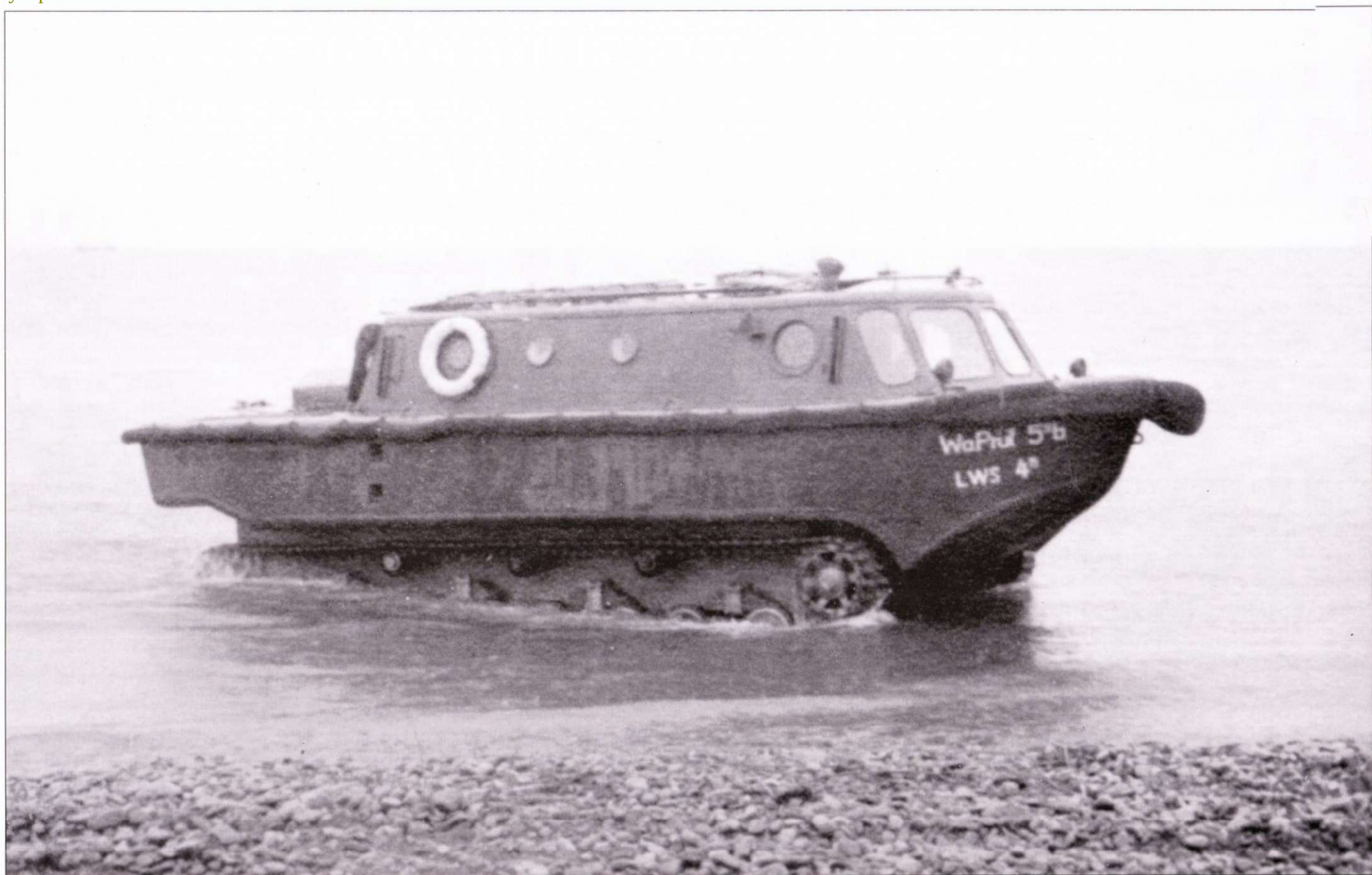
LWS-4 15 на испытаниях, проводимых Wa Prüf 5 VIb. После модернизации на машине установлены ведущие колеса нового типа. Стиль написания «LWS» не встречался ни на одной другой такой машине.
