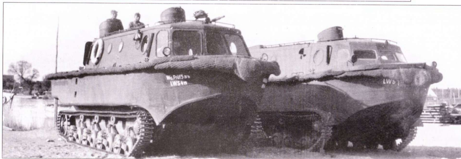
Амфибии LWS-4 15 и LWS-1 98 (справа) имели различное остекление лобовых частей рубок. Фотографии сделаны в Дивенуве на балтийском острове Волен. На оборотах снимков написано «1942», но скорее всего снимки сделаны в 1941 г.
