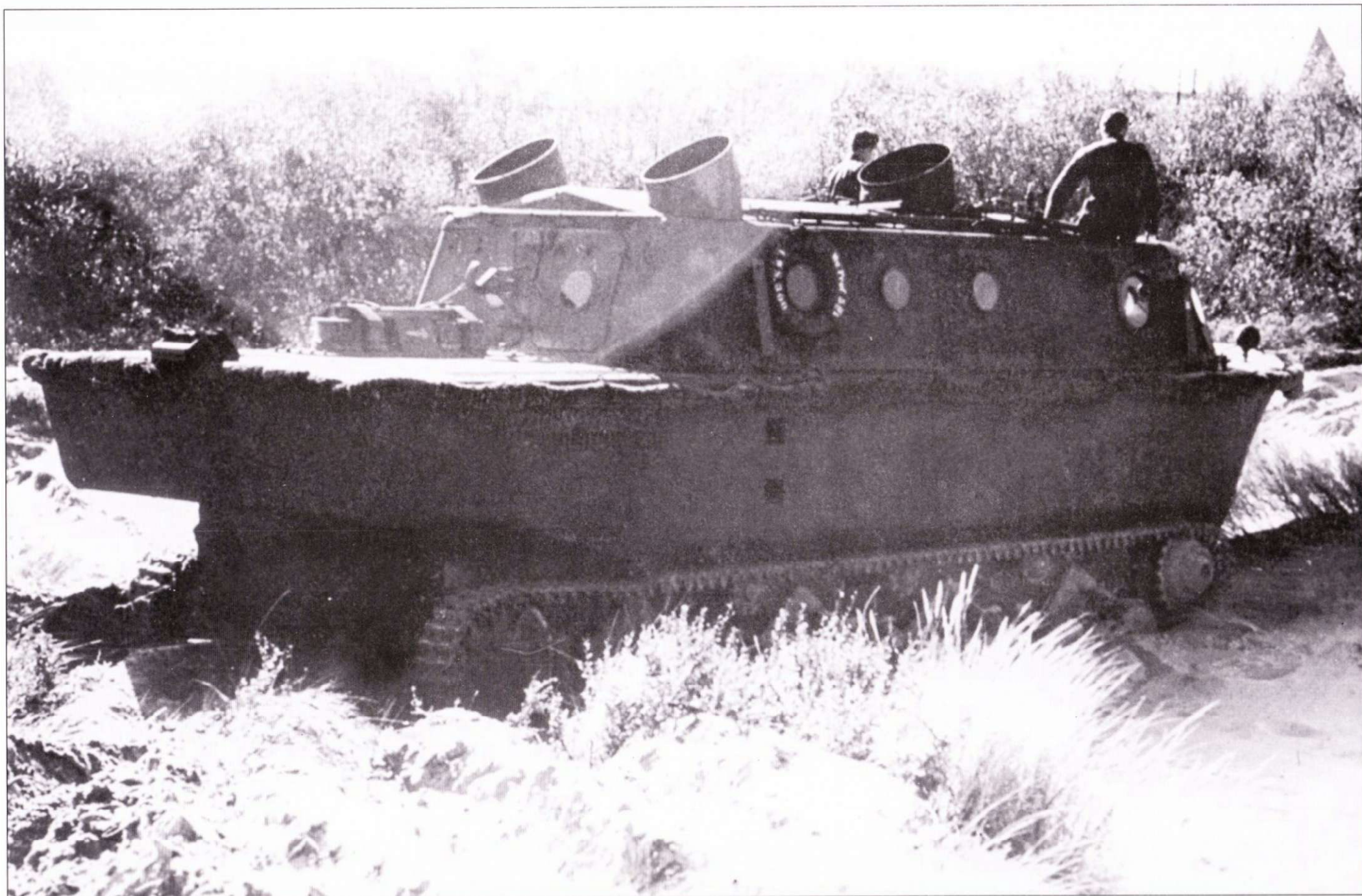
На борту рубки подвешен спасательный круг с обозначением амфибии - LWS-3 00. В задней стенке рубки сделано два больших люка, створки которых откидываются к бортам.
