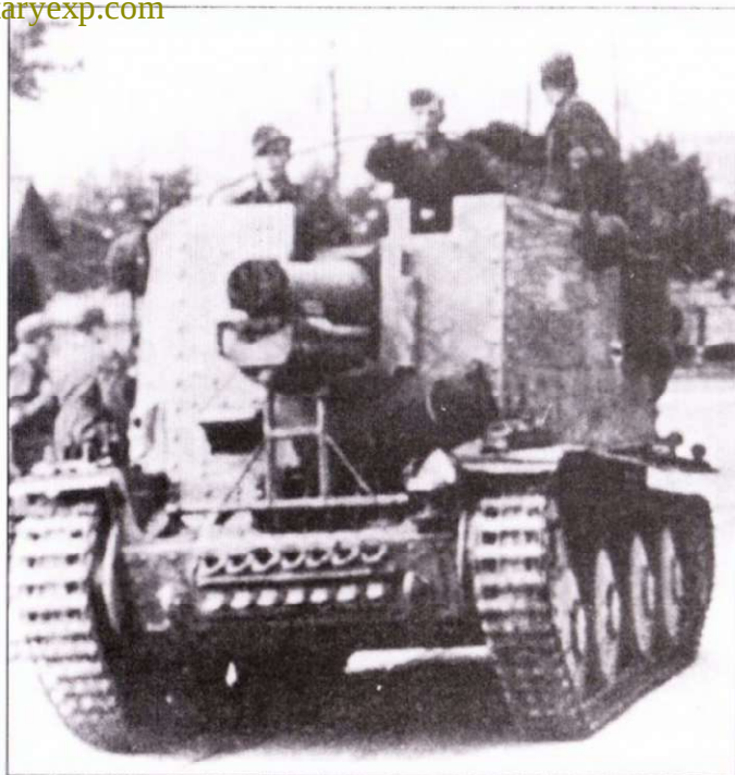
Самоходное орудие 15 см sIG 33/1 auf Fgst PzKpfw 38(t) Ausf. H SdKfz 138/1 "Grille", 14-й гренадерский полк 5-й танковой дивизии, Восточный фронт, 1944 год.
