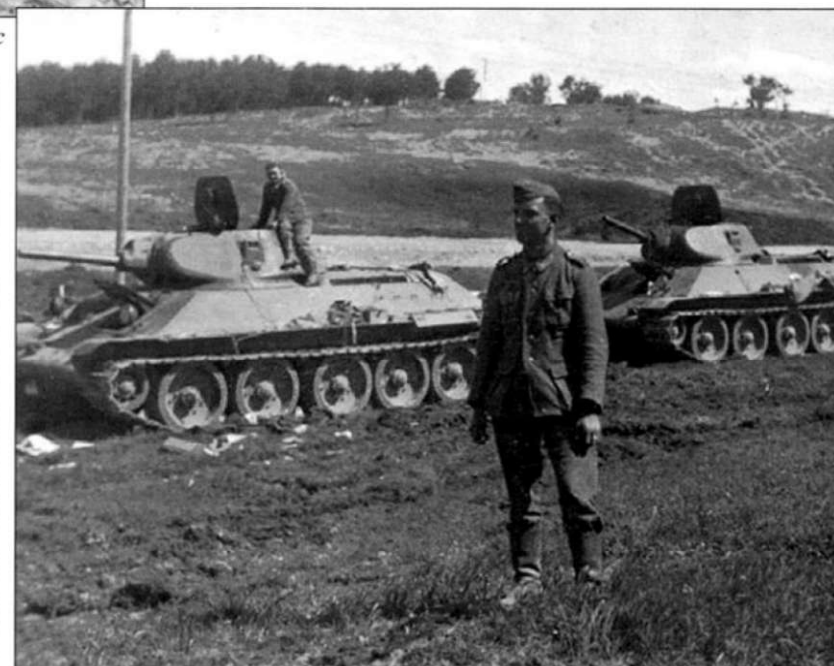
Брошенные Т-34 образца 1940 года с литой башней. На фото хорошо видны белые отметки быстрого опознавания с воздуха на башенных люках танков.
