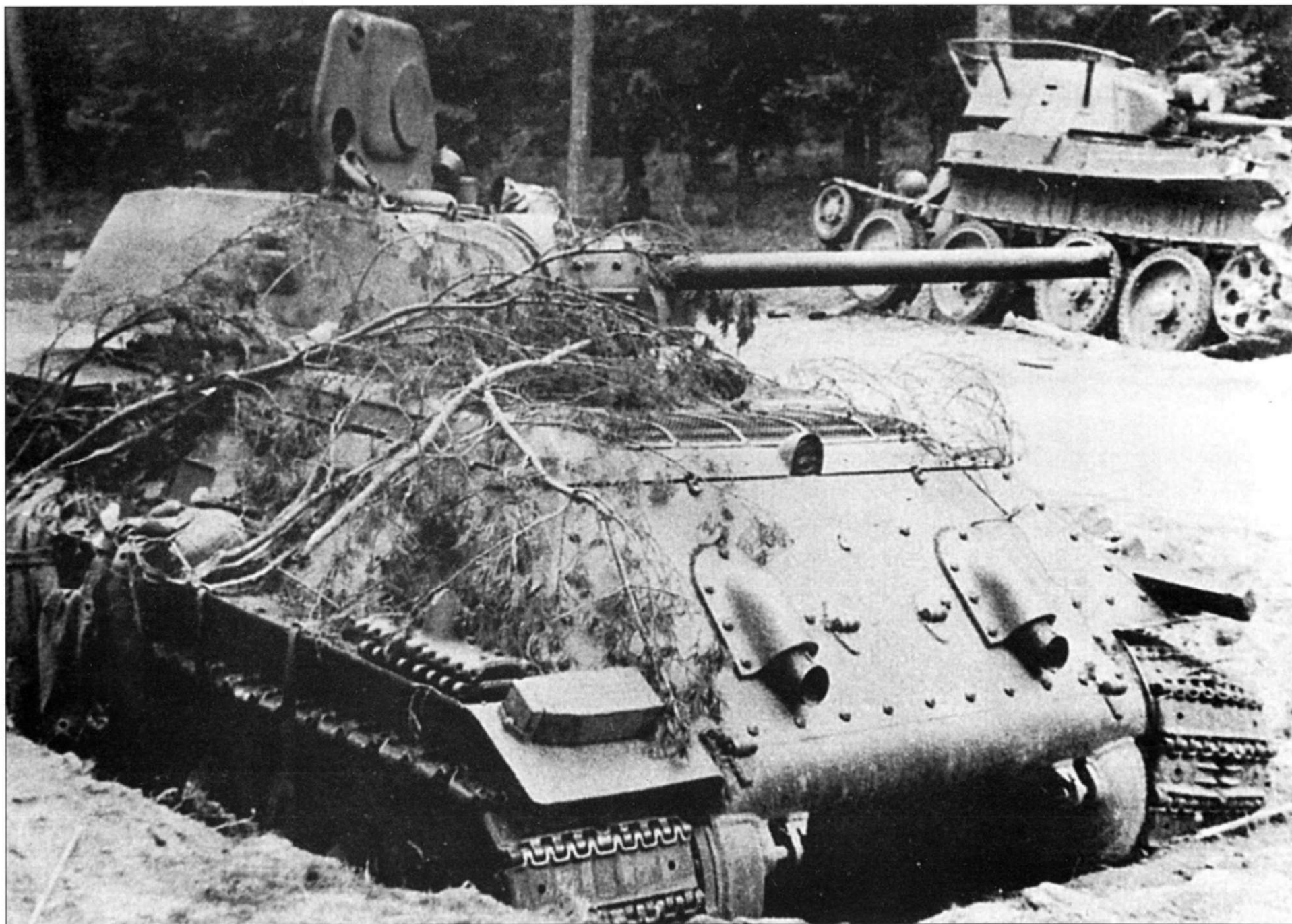
Т-34 образца 1941 года и БТ-7М брошенные на Украине, июнь-июль 1941 года. Этот Т-34 лишь недавно поступил с завода, о чем свидетельствуют почти полный инструментальный ящик и деревянные бруски, закрепленные на крыльях танка.
