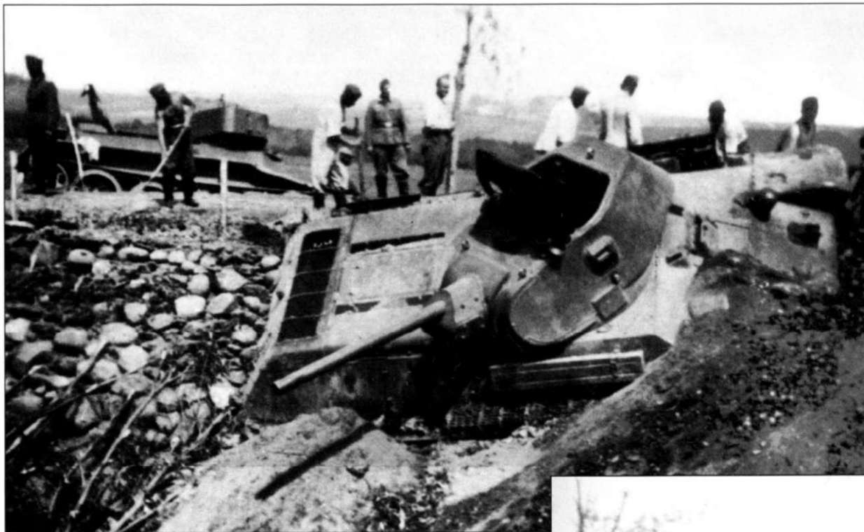
Танк Т-34 выпуска 1941 года со сварной башней, сорвавшийся в овражек из-за ошибки механика-водителя. Танк оснащен только одним наружным баком. Обычно танк нес четыре или восемь таких баков.
