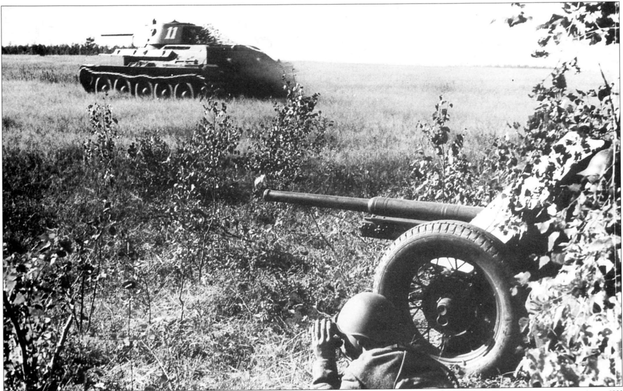
Редкая фотография, запечатлевшая Т-34 образца 1941 года в боевой обстановке, Западный фронт, лето 1941 года. На переднем плане видна противотанковая 45-мм пушка образца 1932 года - основная противотанковая пушка Красной Армии в то время. Т-34 образца 1941 года отличался от танков предыдущих выпусков вооружением: вместо короткой пушки Л-11, на танк устанавливали улучшенную пушку Ф-34, обладавшую хорошей баллистикой.
