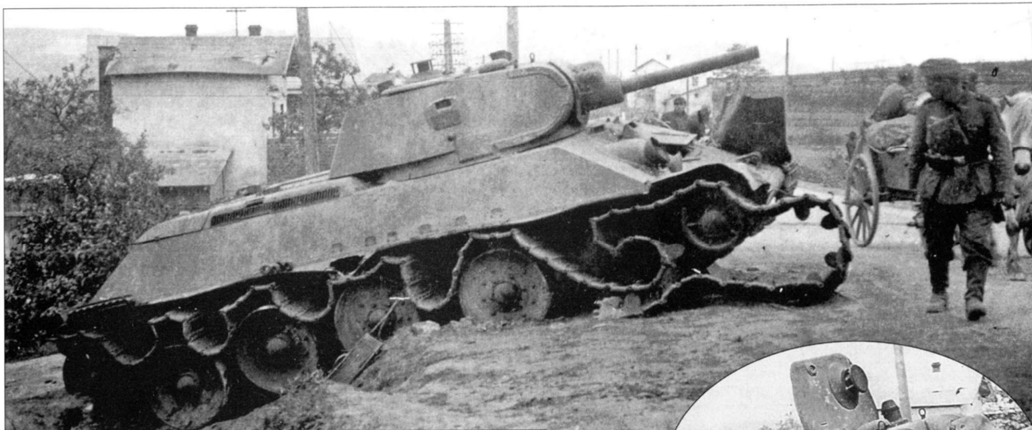
Брошенный Т-34 образца 1940 года раннего выпуска. Башня уже «большая», но на ее крыше сохранился антенный ввод.
