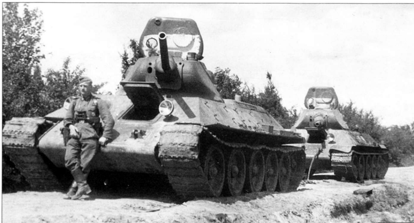
Брошенные Т-34 образца 1940 года с литой башней. На фото хорошо видны белые отметки быстрого опознавания с воздуха на башенных люках танков.
