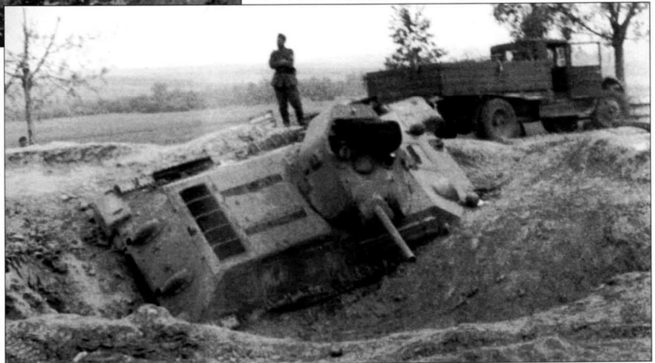
Танк Т-34 выпуска 1941 года со сварной башней, сорвавшийся в овражек из-за ошибки механика-водителя. Танк оснащен только одним наружным баком. Обычно танк нес четыре или восемь таких баков.
