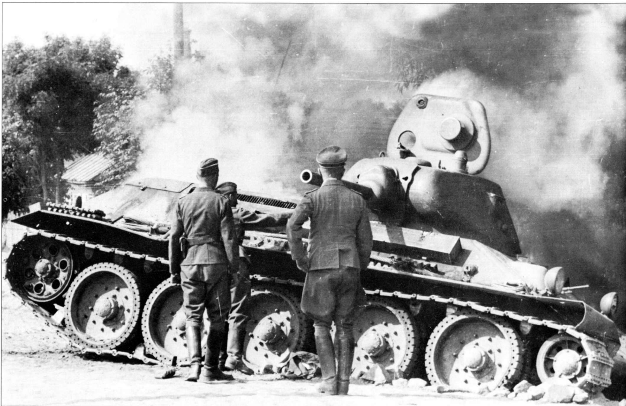
Два фото брошенных Т-34 с литой башней, выпущенных до марта 1941 года. Видны все детали, характерные для ранних Т-34, часто называемых «образца 1940 года»: гусеницы, люк механика-водителя, пушка, панорама на люке.
