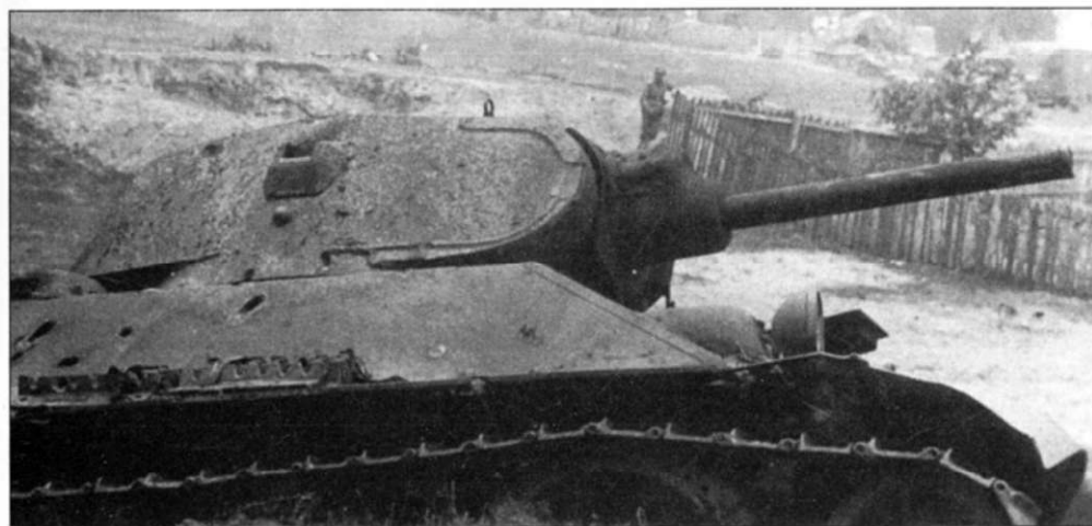
Три снимка Т-34 образца 1940 года раннего выпуска. Танки оснащены «узкой» башней с большими углами наклона бортовых деталей.
