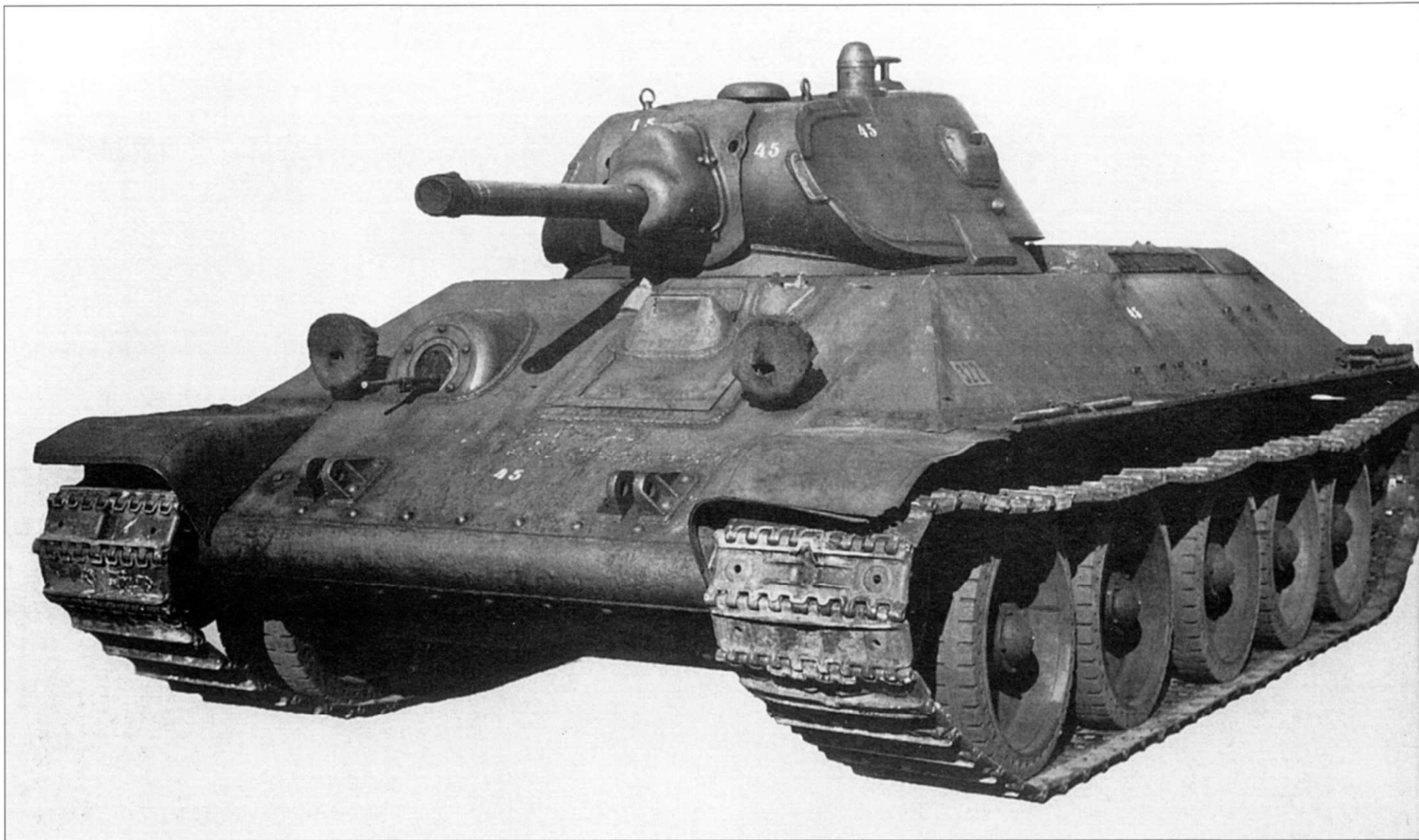
Два фото Т-34 образца 1940 года со сварной башней. Машина была захвачена и испытывалась немцами. Белыми цифрами отмечена толщина брони.
