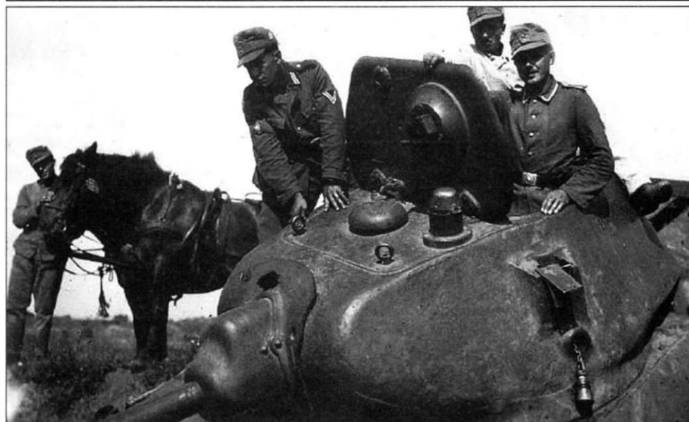
Крупный план крыши литой башни Т-34 выпуска 1940 г. Обратите внимание, что pistolетная амбразура открыта и ее пробка свисает на цепочке.
