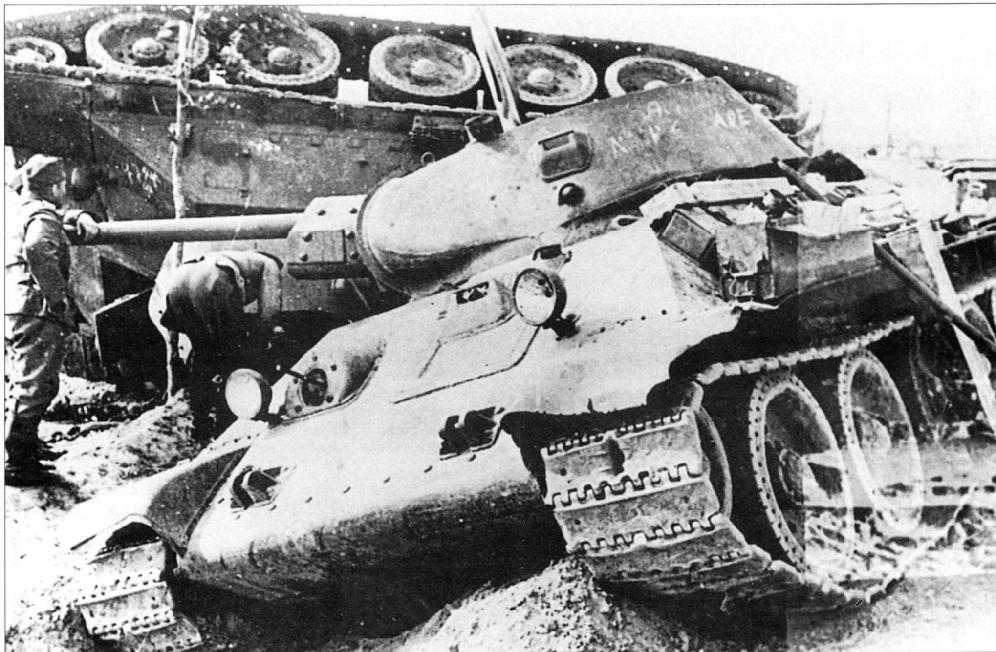
Т-34 выпуска 1941 года, литая башня. По-видимому танки попадали под удар авиации, взрыв крупной авиабомбы вполне мог перевернуть 28-тонный танк.
