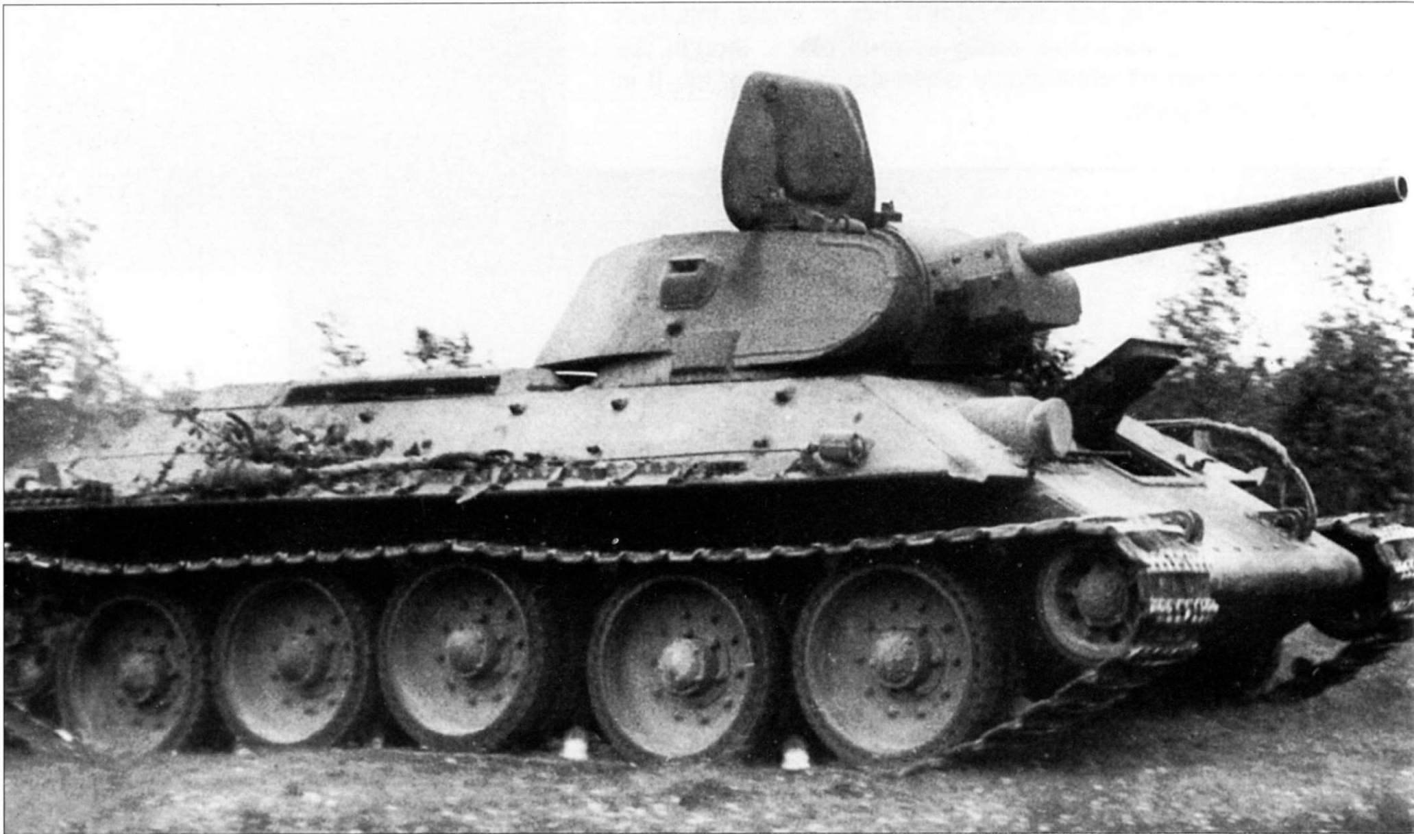
Т-34 образца 1941 года появился на фронте в конце лета 1941 года. Запечатленный на снимке танк вероятно только что получен с завода, поскольку буксировочные тросы еще покрыты промасленной бумагой. Это танк командира взвода или роты поскольку вдоль правого борта протянута антенна. Обратите внимание на то, что в крышке люка отсутствует заглушенный круглый лючок для панорамы.
