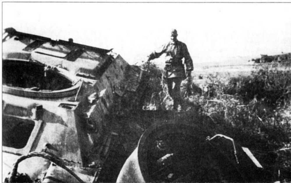
Т-34 первой серии с пушкой Л-11, лето 1941 года. Хорошо видны детали корпуса. Башня сорвана с погона.
