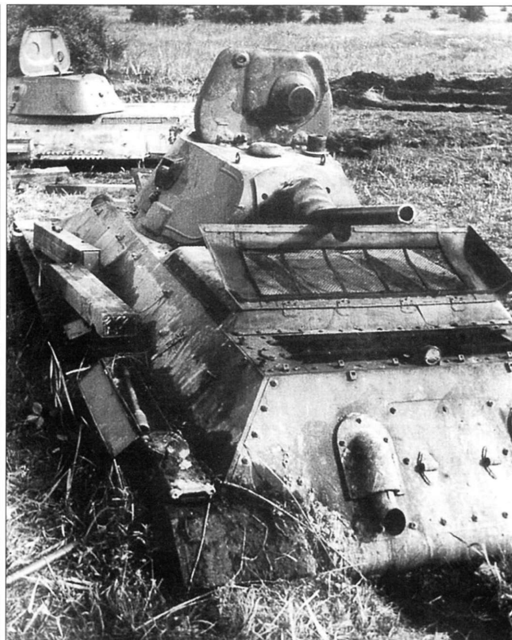
Вид с кормы на брошенный Т-34 образца 1940 года со сварной башней. Хорошо видно, что танк камуфлирован - скорее всего коричневыми и темно-зелеными пятнами по светло-зеленому фону. Границы пятен - четкие, без размытия.
