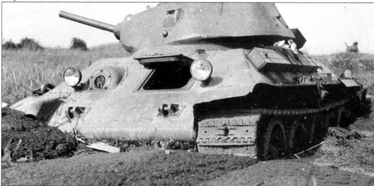
Брошенные Т-34 образца 1940 года с литой башней. На фото хорошо видны белые отметки быстрого опознавания с воздуха на башенных люках танков.
