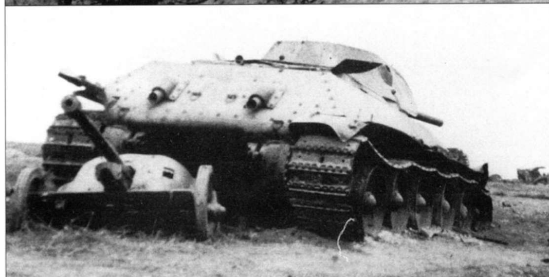
Брошенный Т-34 образца 1940 года раннего выпуска. Башня уже «большая», но на ее крыше сохранился антенный ввод.
