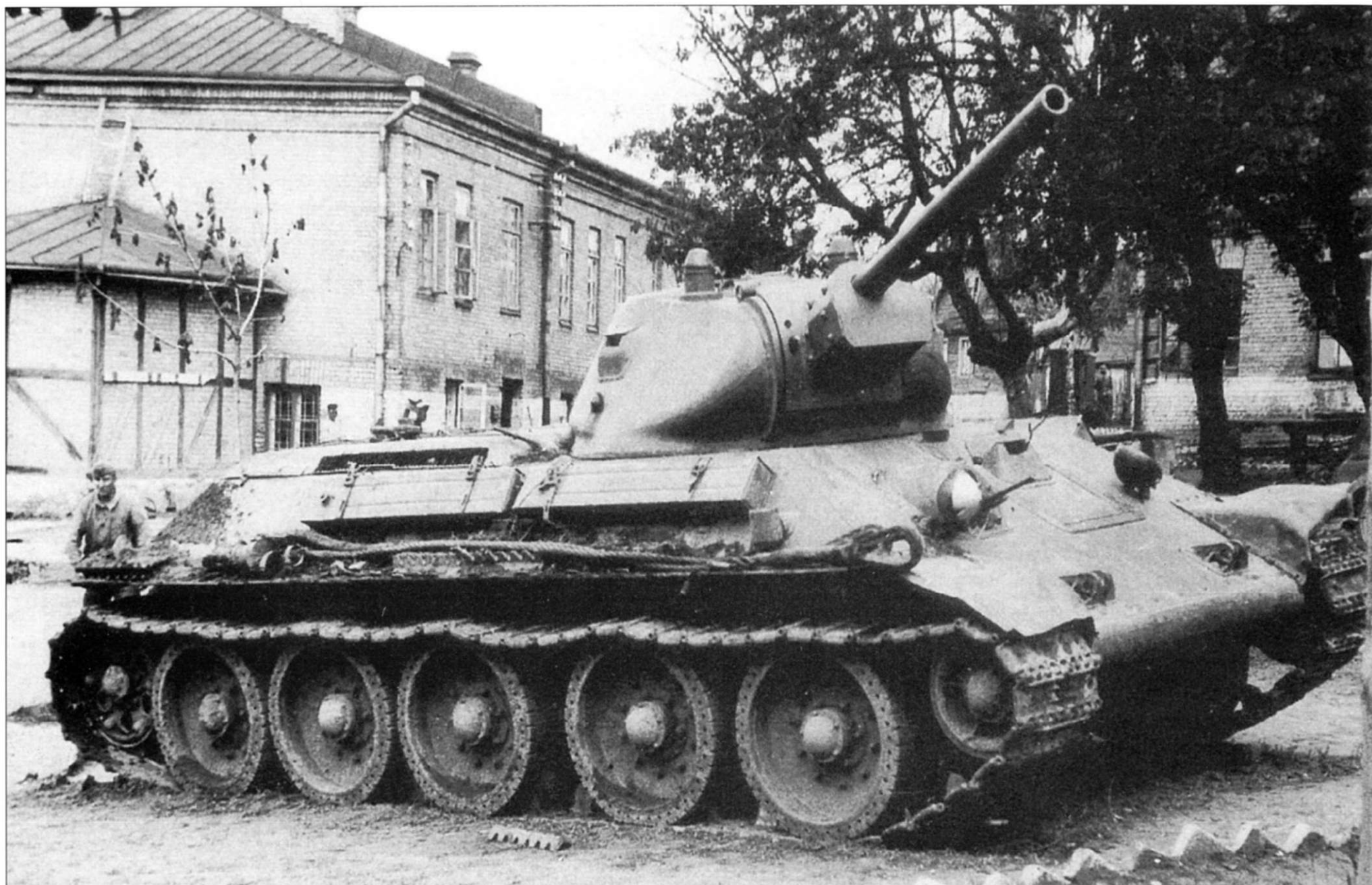
Отличный снимок танка Т-34 выпуска 1941 года с литой башней. Танк был брошен в июне-июле 1941 года на площади одного из городов Белоруссии. Танк полностью оснащен и имеет два башенных перископа. Позже все эти «излишества» были убраны из конструкции танка, чтобы снизить стоимость производства.
