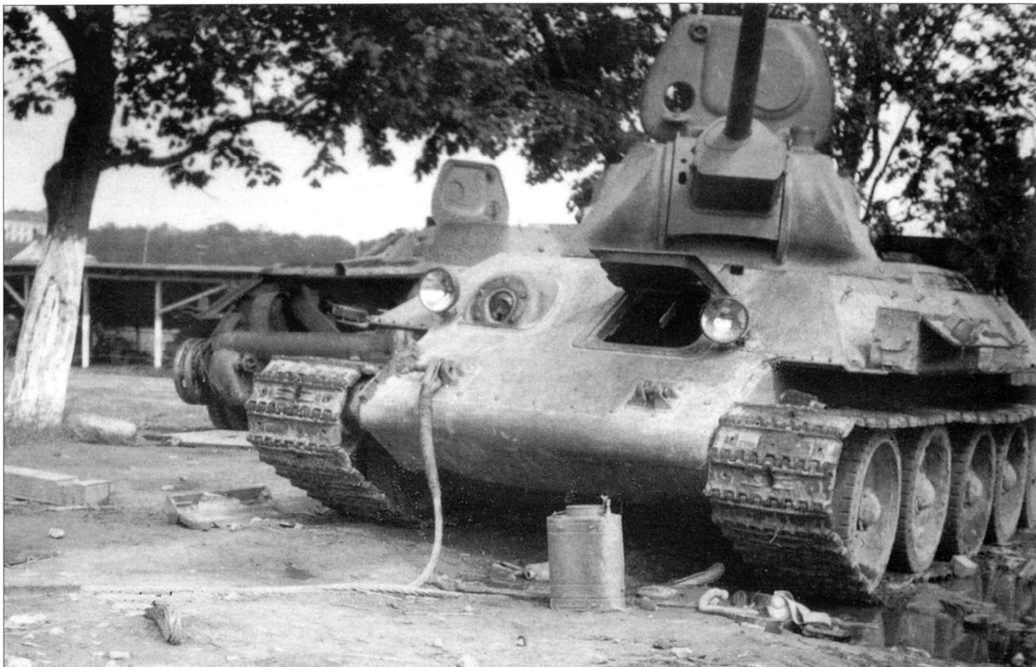
Пара «тридцатьчетверок», брошенных во время ремонта, лето 1941 года. Хорошо видна конструкция башни. На башенном люке виден заваренное отверстие для панорамы. Люк механика-водителя старого типа, танк оснащен двумя фарами и старыми буксировочными креплениями. На крыле виден большой инструментальный ящик. Танк выпущен весной 1941 года.
