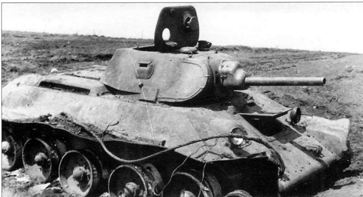
Серия фотографий подбитых Т-34 образца 1940 года со сварной башней.
