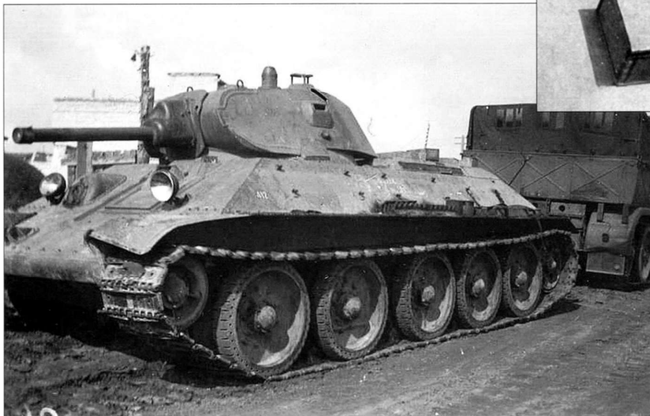
Немецкий тягач пытается эвакуировать Т-34 выпуска 1940 года со сварной башней. Танк не имеет никаких видимых повреждений.
