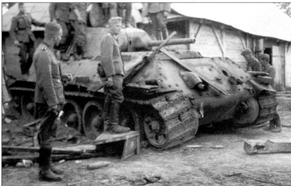
Здесь и на фото слева: Т-34 образца 1940 года со сварной башней, подбитый во время летних боев 1941 года. Это танк позднего выпуска, о чем свидетельствует отсутствие панорамы на крышке люка. Броня Т-34 была достаточно толстой, чтобы выдерживать попадания снарядов разных калибров. Этот танк немцам удалось подбить лишь со стороны кормы, где броня более тонкая.
