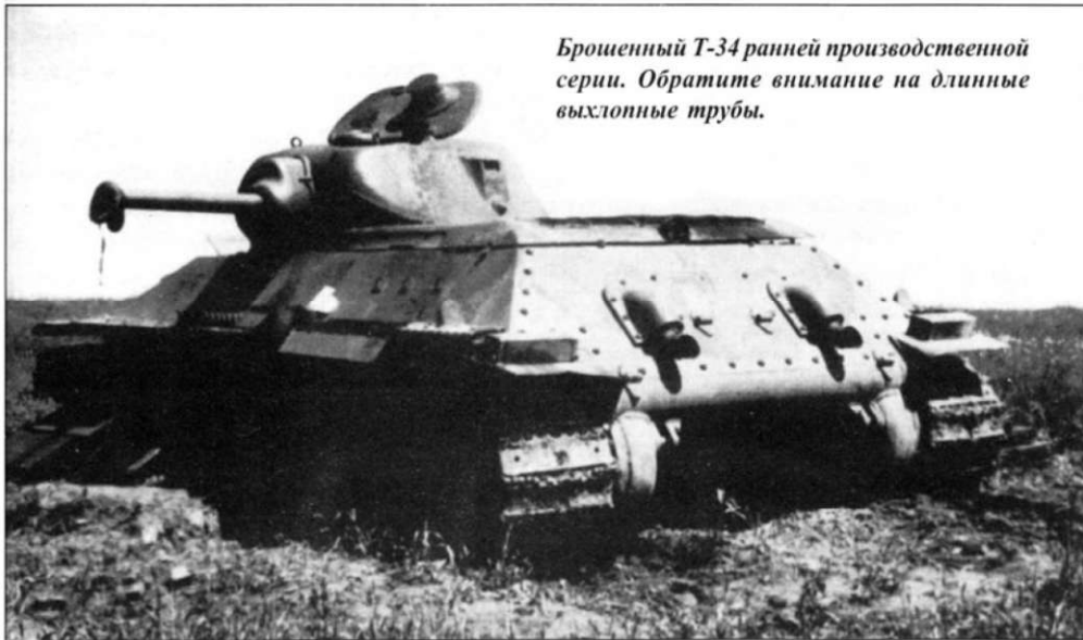
Здесь и на фото слева: Т-34 образца 1940 года со сварной башней, подбитый во время летних боев 1941 года. Это танк позднего выпуска, о чем свидетельствует отсутствие панорамы на крышке люка. Броня Т-34 была достаточно толстой, чтобы выдерживать попадания снарядов разных калибров. Этот танк немцам удалось подбить лишь со стороны кормы, где броня более тонкая.
