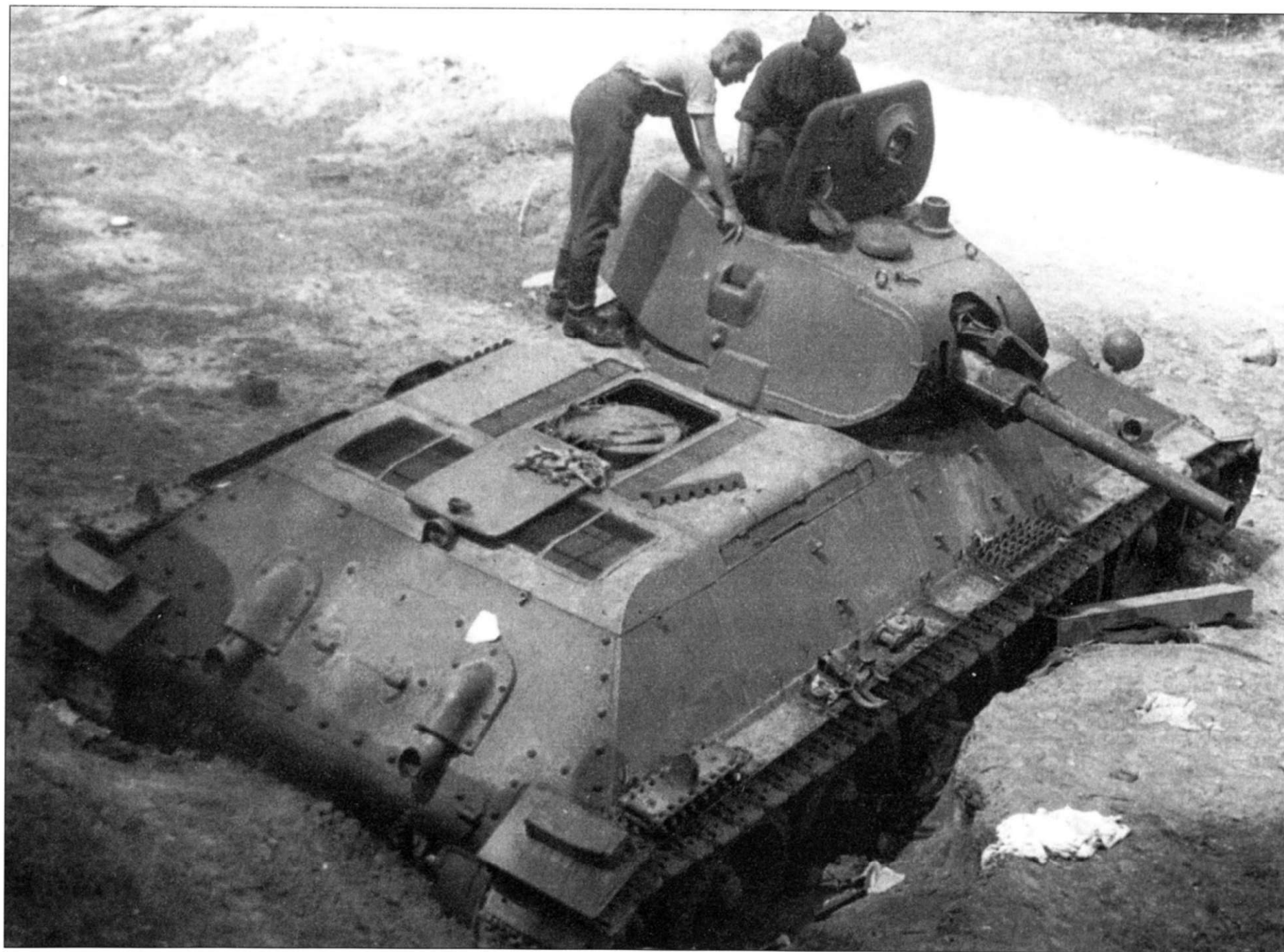
Два фото одного и того же танка, сделанные в разное время. Т-34 выпуска 1940 года, сварная башня. В задней части крыши башни видна заглушка на месте антенного ввода.
