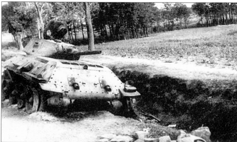
Серия снимков подбитых Т-34 выпуска 1940 года с литой башней. Танки горели - на ободах колес нет резинового бандажа. Экипажи не успели освоить новые танки, поэтому часто их бросали из-за механических поломок, вызванных неопытностью механиков-водителей.
