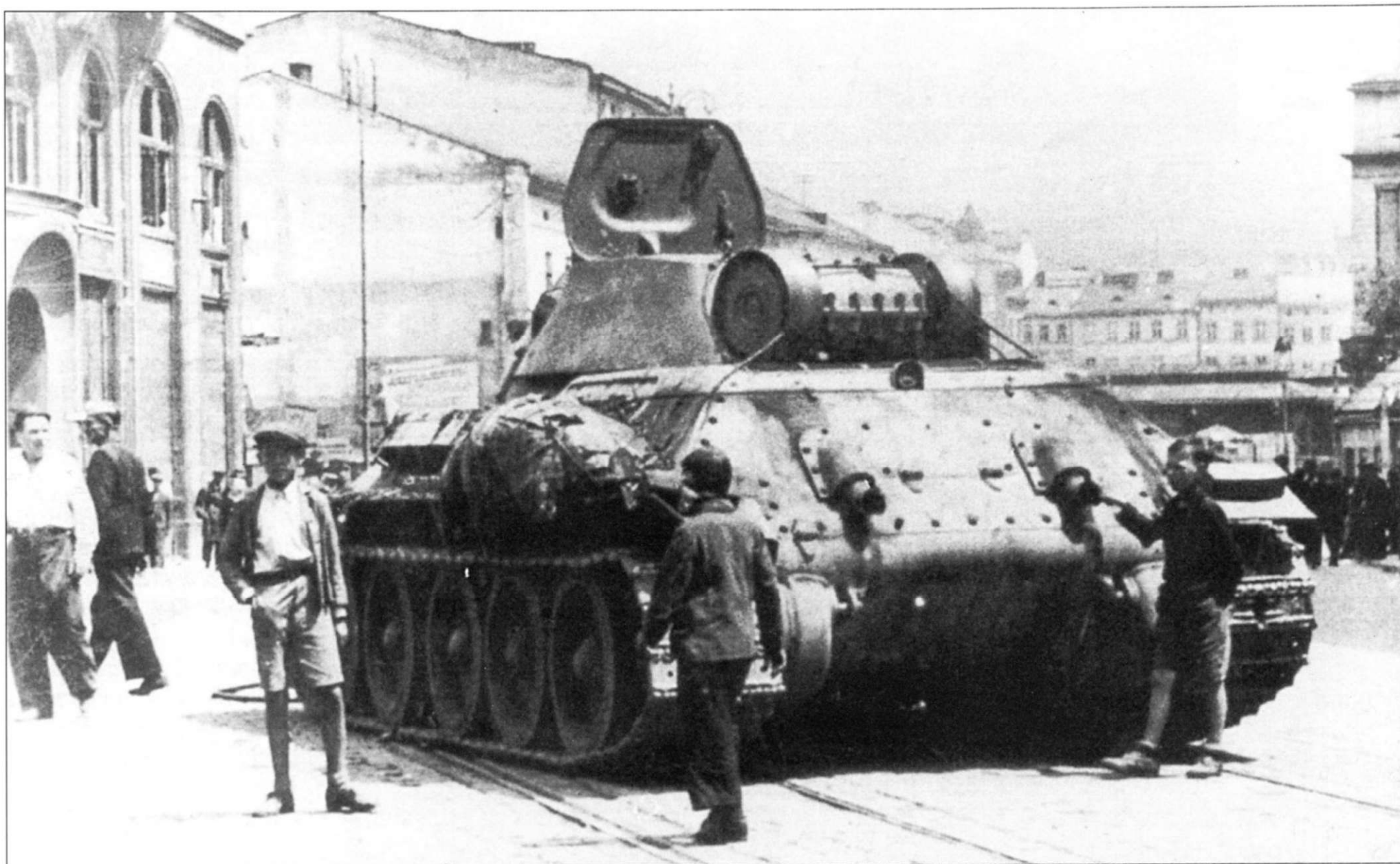
Дети играют вокруг Т-34 образца 1940 года из 4-го механизированного корпуса генерала Власова, брошенного на улицах Львова. Этот снимок взят из хорошо известной серии фотографий. На надмоторной бронеплите тросом прикручена коробка передач. Первые Т-34 страдали от серьезных механических недостатков, которые в значительной степени обусловили высокие потери летом 1941 года. Корпус Власова располагал 313 танками Т-34 и был одним из самых мощных корпусов, действовавших на Украине. Однако из-за плохого командования, корпус практически не оказал влияния на ход боев.
