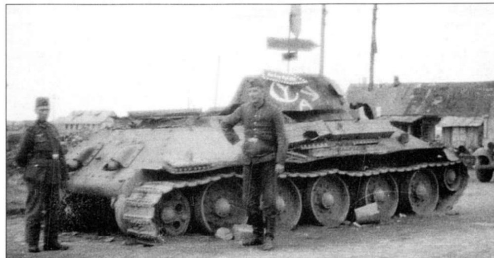
Т-34 с пушкой Л-11, сгоревший у какой-то деревни. На башне танка немцы изобразили тактический знак 12-й танковой дивизии. На бортовом баке виднеется большая пробоина. Немного непонятно почему резиновый бандаж полностью выгорел, тогда как на самом танке не видно следов копоти.
