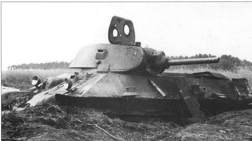
Серия фотографий подбитых Т-34 образца 1940 года со сварной башней.
