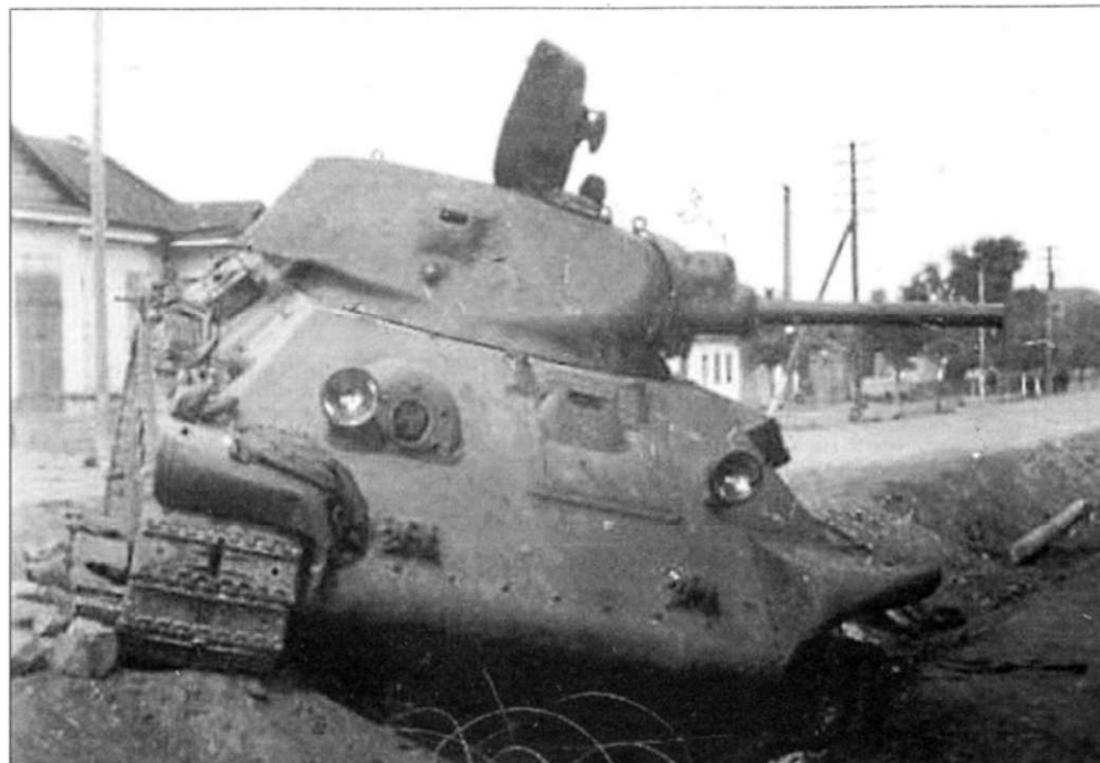
Два снимка Т-34 выпуска 1940 года с литой башней, лето 1941 г. Машины раннего выпуска - панорама на башенном люке присутствует.
