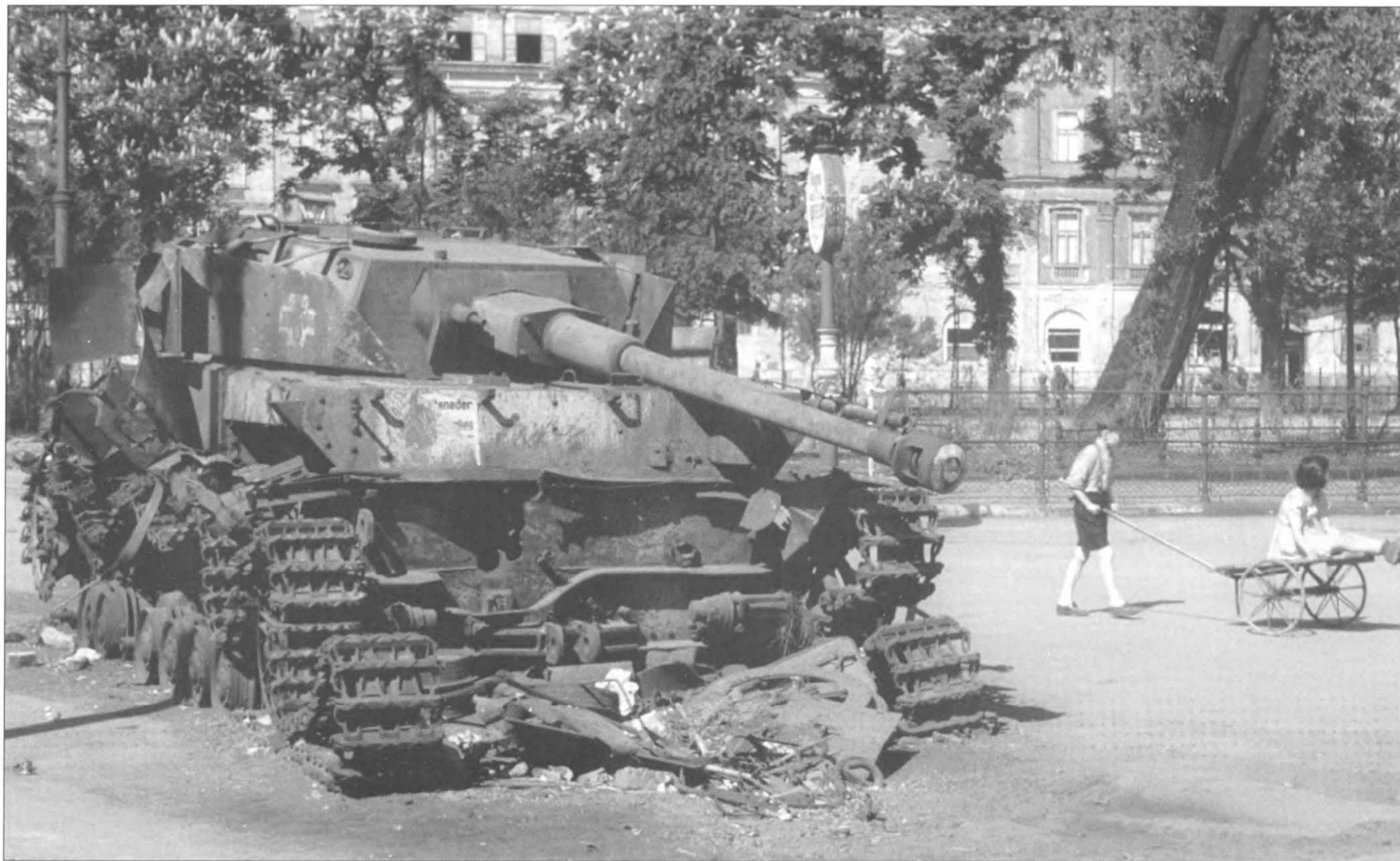
Panzerbeobachtungswagen IV Ausf. J, машина получила несколько прямых попаданий снарядов в корму корпуса. Снимок сделан в Пратере, Вена, апреля 1945 г. Взрывом с башни сброшена командирская башенка; командирская башенка аналогична командирской башенке штурмового орудия. Командирский танк - позднего выпуска - буксирные узлы являются продолжением бронелистов корпуса, нет смотрового прибора наводчика, бортовые экраны сделаны из проволоки. Ствол спаренного с пушкой пулемета MG34 на самом деле является макетом. Вместо пулемета на командирские танки ставили вторую радиостанцию. На крыше корпуса, под стволом орудия, заметен бронированный антенный ввод командирской радиостанции.
