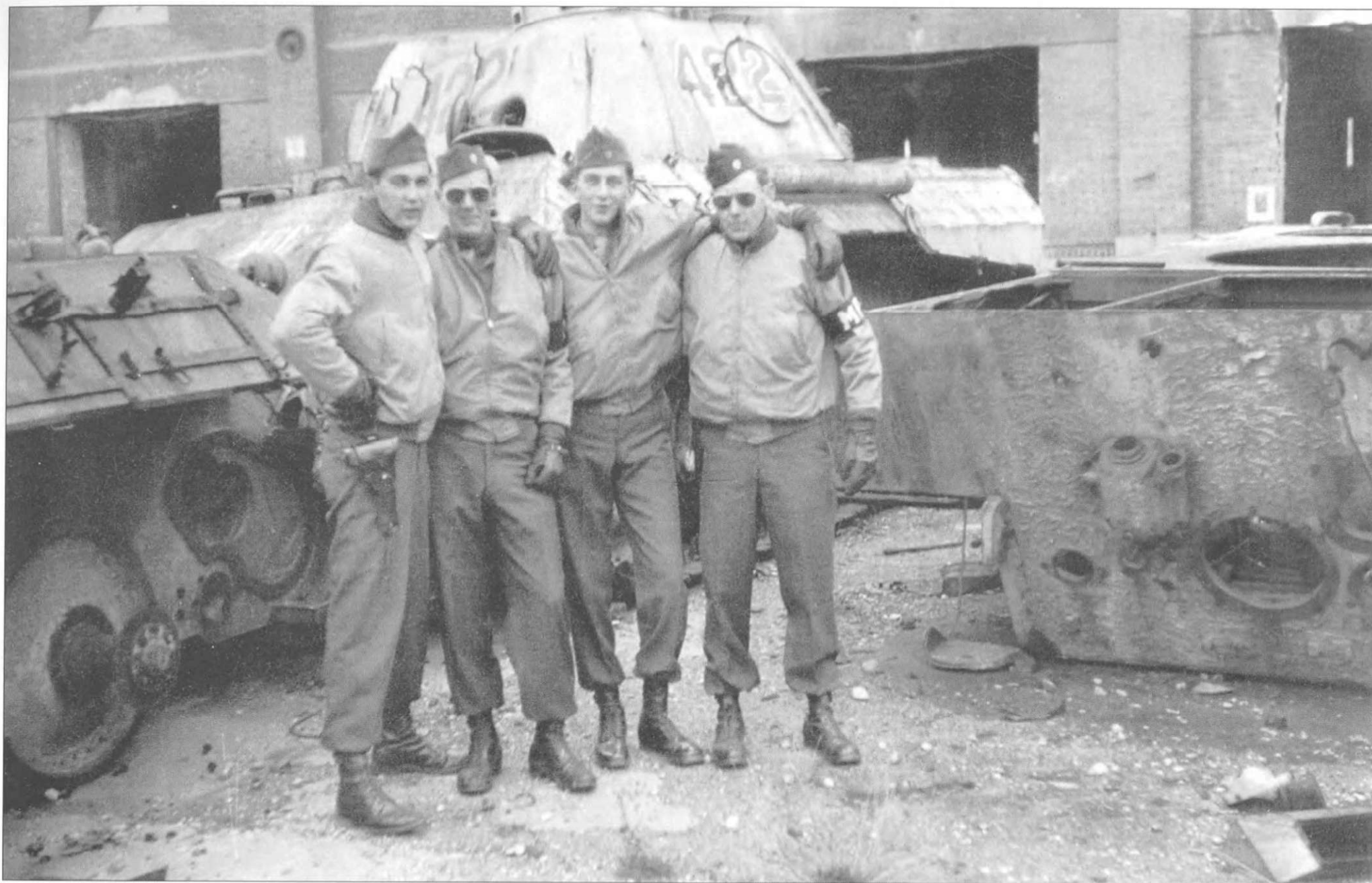
Данные танки «Пантера» - машины модификаций Ausf. D и Ausf. A. Корпус слева и танк на заднем плане - «Пантера» Ausf. D, справа - Ausf. A. На левом корпусе видна фара Бош, что позволяет датировать время изготовления танка самое позднее июнем 1943 г.
