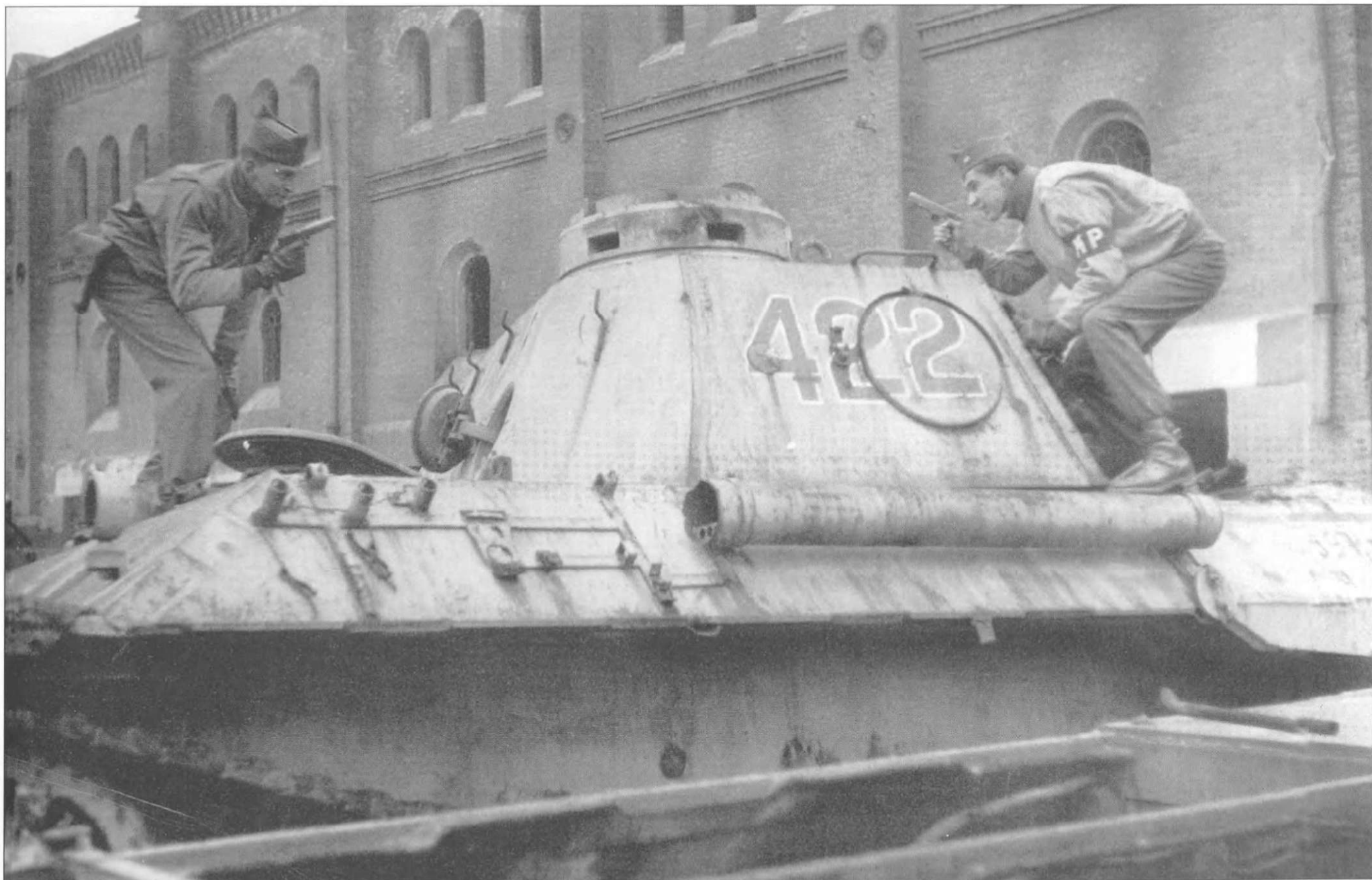
«Пантера» с бортовым номером «422» была изготовлена не позднее апреля 1943 г., так как над люком в стенке башни отсутствует ограждение от дождевой воды. Танк побывал в боях - на командирской башенке видны отметины от снарядов и пуль. На стенке башни приварены крюки, предназначенные для крепления запасных гусеничных трактов.
