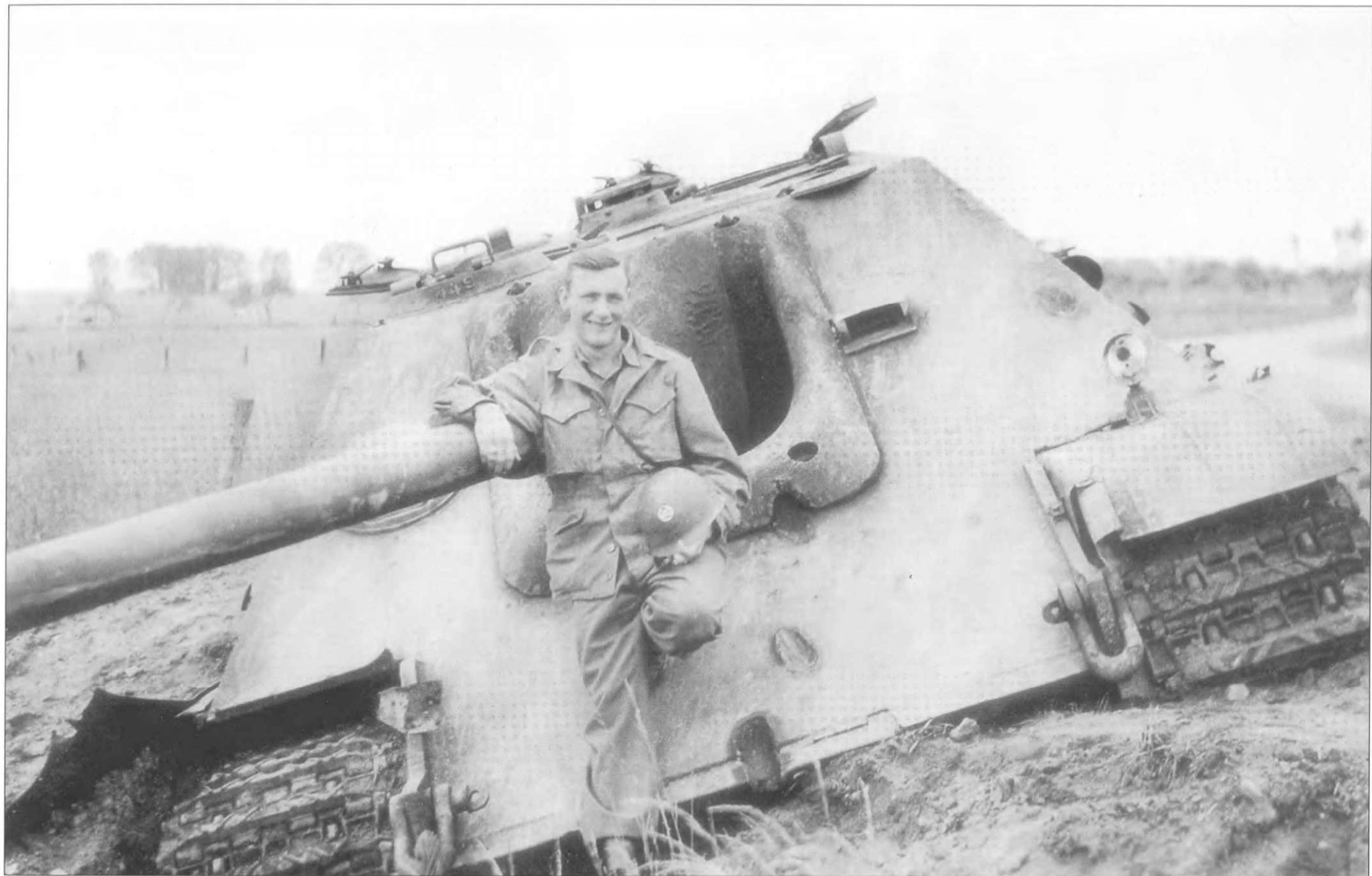
80-мм лобовой бронелист «Ягдпантеры» выдержал несколько прямых попаданий снарядов, выпущенных американским танком, однако снаряд, который попал в стык бронелистов, очевидно вызвал смещение элементов трансмиссии, хотя броню и не пробил. «Ягдпантера» потеряла ход, после чего стала обреченной.
