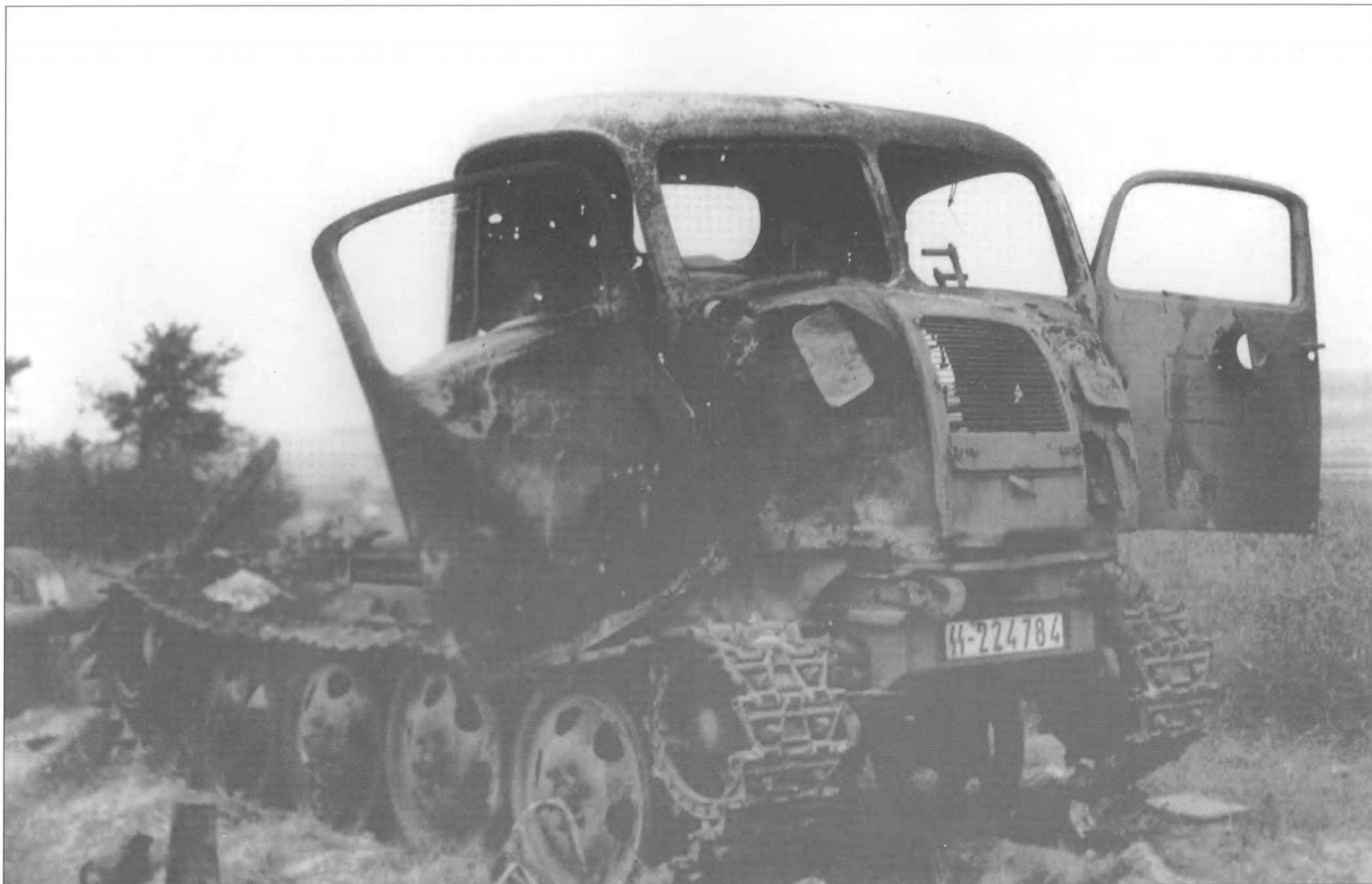
Тягач RSO/01 из подразделения войск СС. Тягач, прежде чем быть уничтоженным, буксировал 75-мм противотанковую пушку Pak-40. Ствол орудия виден в левой части снимка. Заднюю стенку кабины тягача изрешетили пули. В двери водителя - дыра от осколка снаряда. Дата и место снимка не установлены, вероятнее всего - фотография сделана где-то во Франции.
