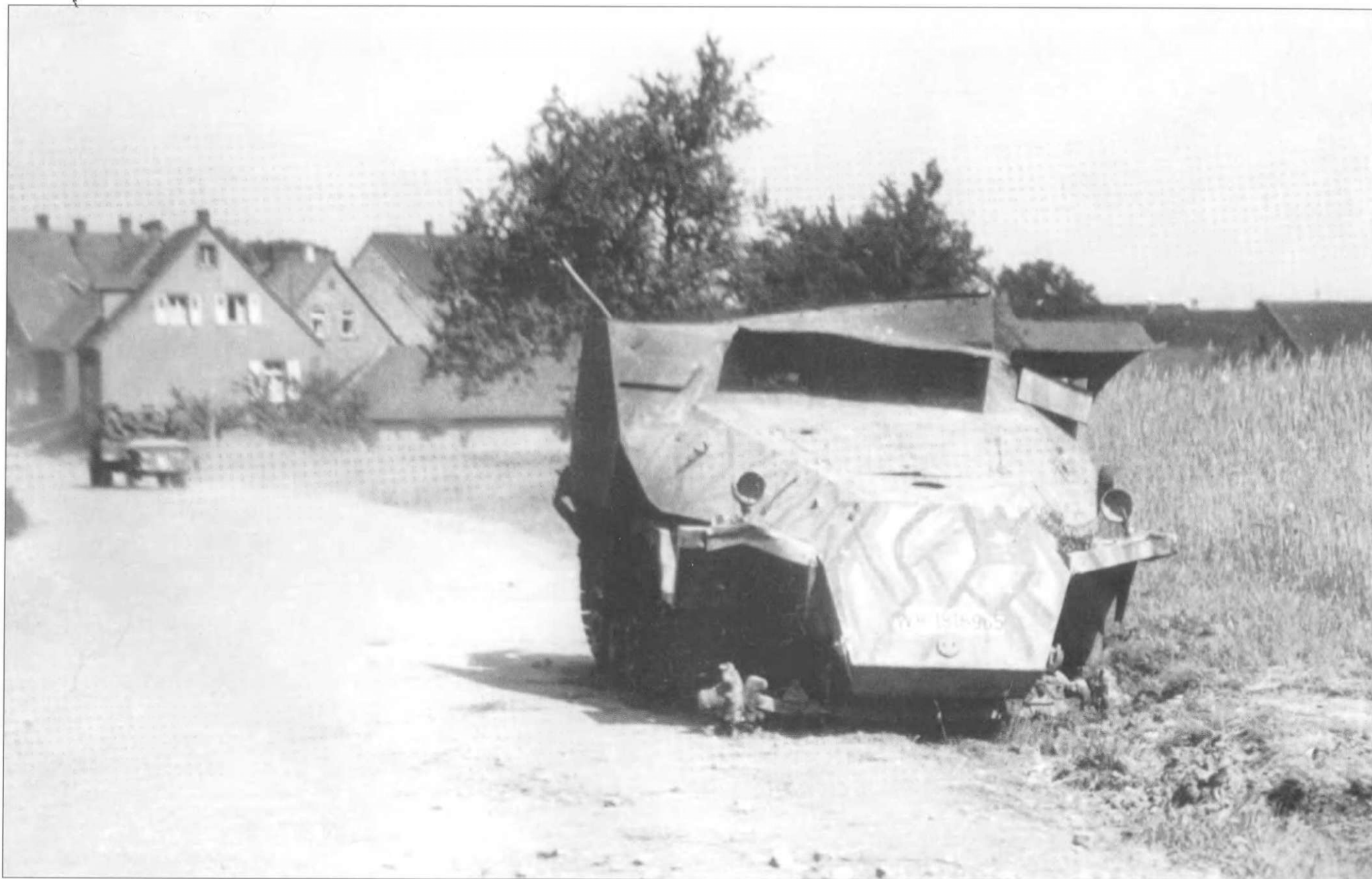
Камуфляж на 2 см Flak 38 auf Sf.Zkgw.3t нанесен вручную. Самоходка разбита прямым попаданием снаряда в борт непосредственно за сиденьем водителя. Определенный интерес вызывает эмблема части в виде орла, изображенная на лобовой стенке капота. Передние колеса уже сняли.
