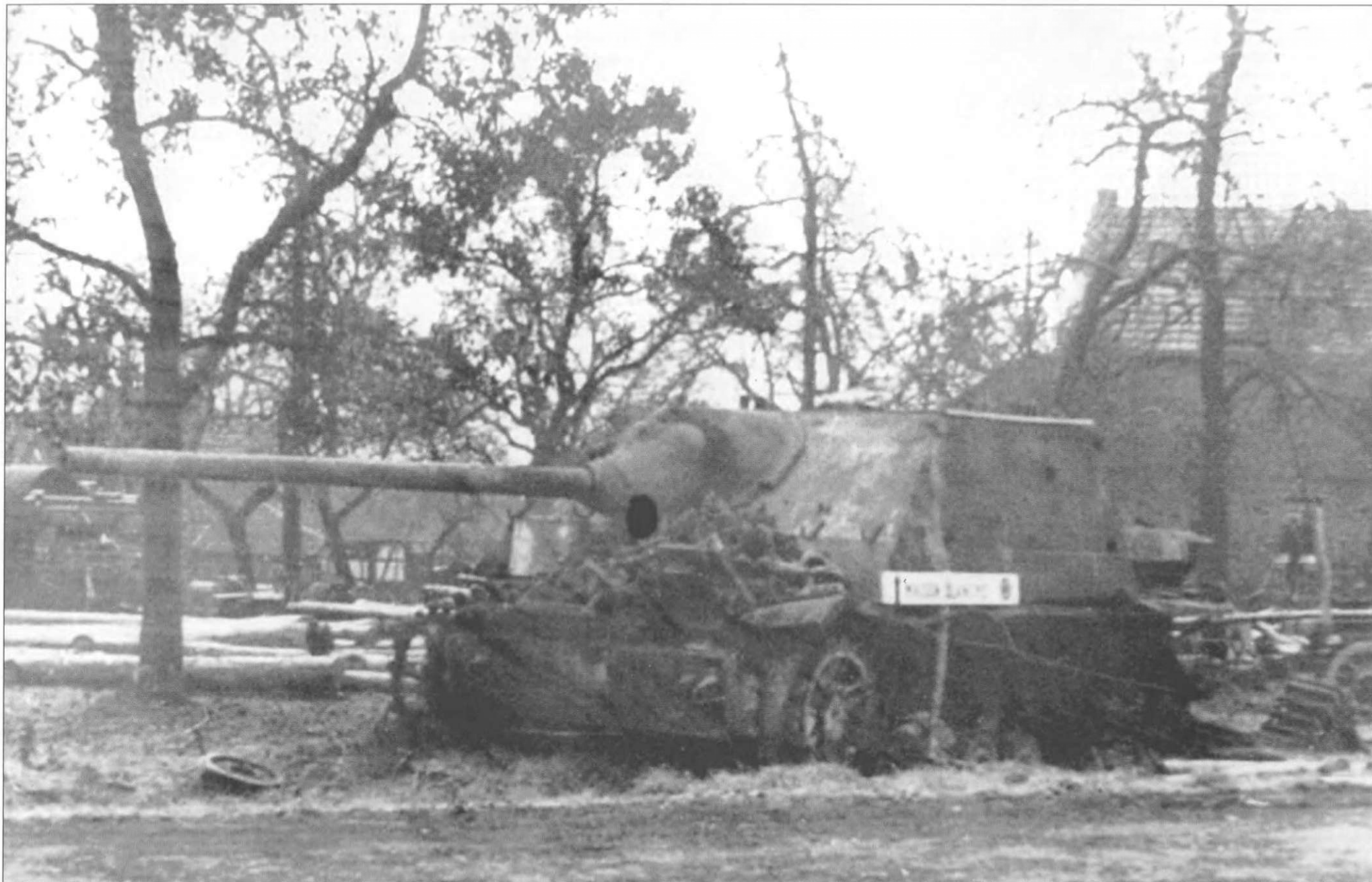
Разбитый истребитель танков Panzer IV/70(A) из 7-й роты 2-го танкового полка 103-й панцербригады, окрестности Мюльхаузена, декабрь 1944 г., Эльзас. В тот период 7-я рота 2-го танкового полка была придана 106-й панцербригаде. На лобовой стенке рубки машины видны крюки, предназначенные для навески запасных гусеничных траков.
