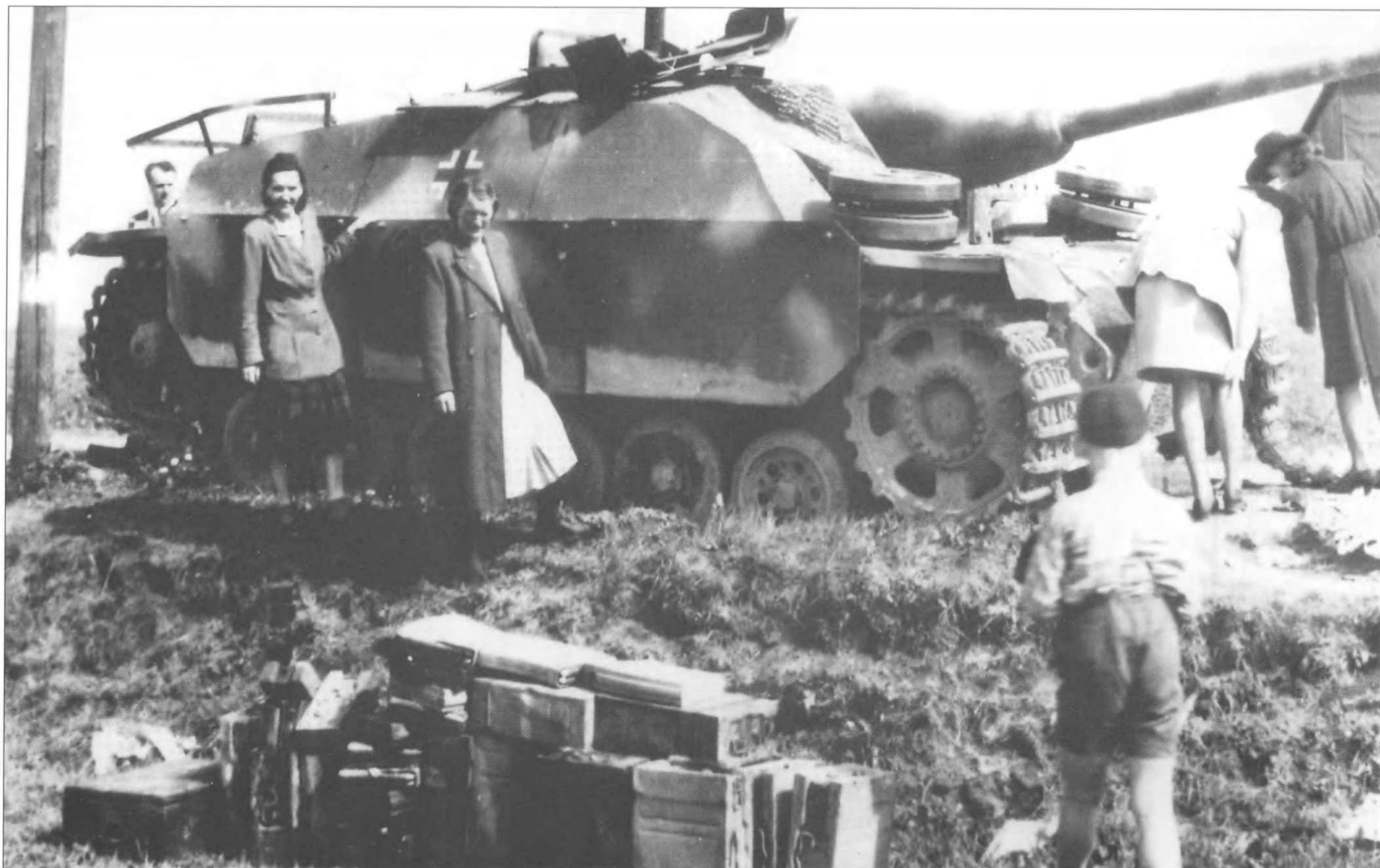
Очень необычная самоходка StuG III Ausf. G из 10-й панцергренадерской дивизии; снимок сделан после капитуляции дивизии в Хавикув Броде, Моравия, примерно 10 мая 1945 г. Бортовой экран - полевая доработка. За счет такого экрана самоходка стала похожей на Jagdpanzer IV. Щиток пулемета на крыше рубки состоит, минимум, из трех элементов, броня щитка - разнесенная. Люк заряжающего открыт.
