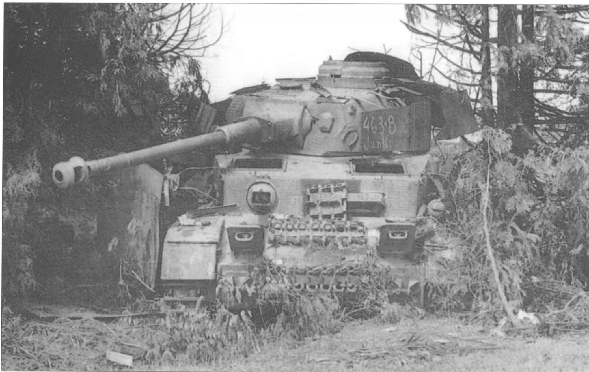
Краса панцерваффе превратилась в металлолом. Американцы поместили металлолом словом «junk» - старье, хлам. Танк Pz.Kpfw. IV Ausf. H из 2-го батальона 16-го танкового полка 116-й панцер-дивизии был подбит недалеко от замка Бурж Сент-Леонард во Франции в августе 1944 г. Внутренним взрывом сорвало люки механика-водителя и стрелка-радиста. Закрепленная на удачу на башне подкова экипажу танка не помогла.
