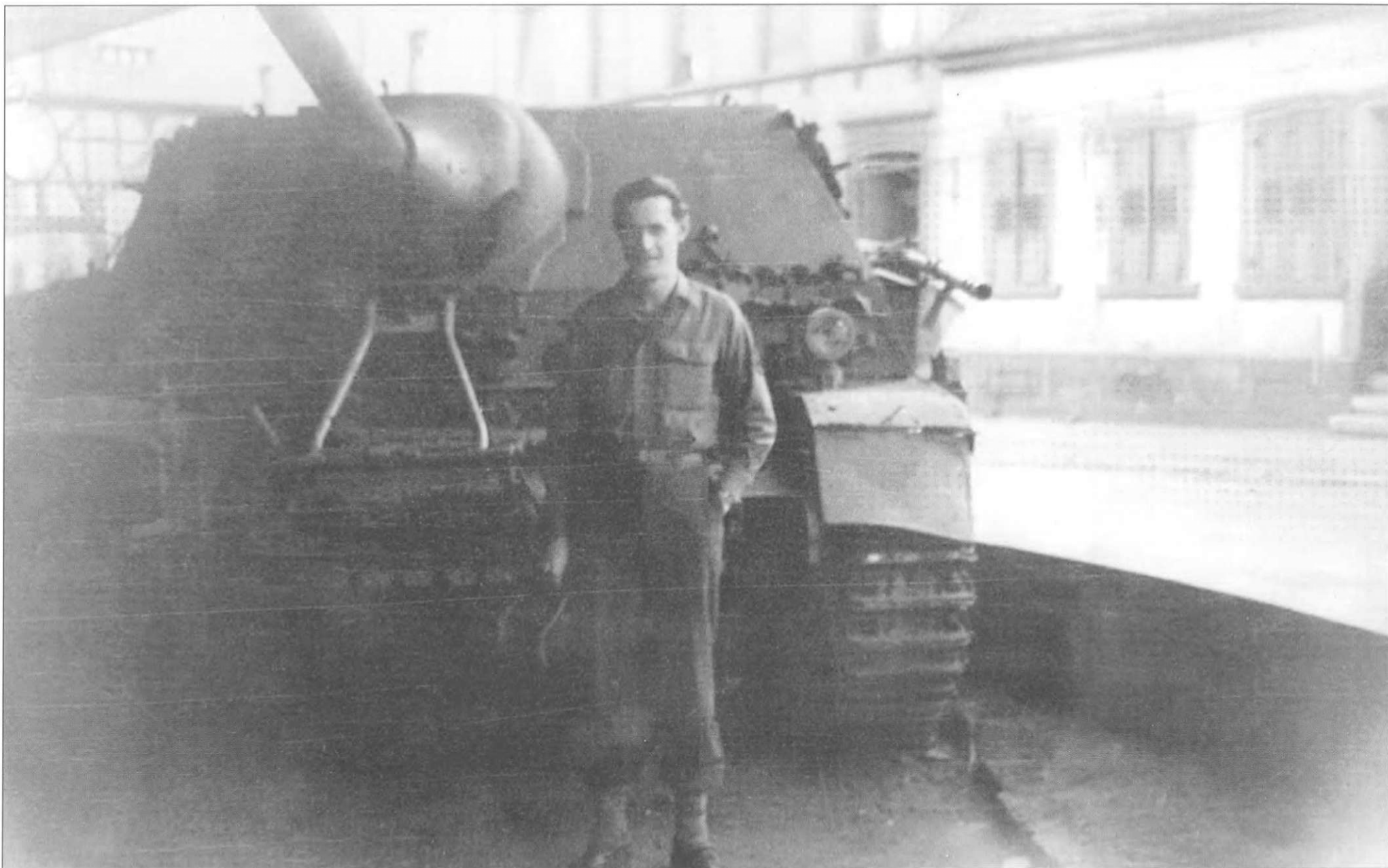
Сержант Лютер У. Джонсон из 36-й пехотной дивизии армии США позирует у истребителя танков Panzer IV/70(A) из 7-й роты 2-го танкового полка. На лобовую стенку рубки навешены запасные гусеничные траки. Запасные траки есть также на лобовой части корпуса и на борту рубки выше проволочных бортовых экранов. Машина - поздней постройки, с интегрированными в борта корпуса буксирными узлами.
