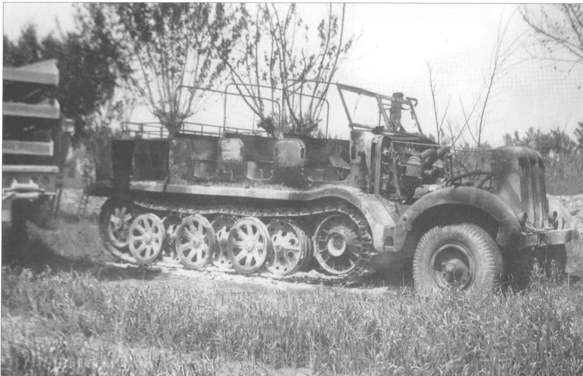
Пламя пожрало данный экземпляр тягача Sd.Kfz. 8 DB10, снимок сделан американским фотолобителем в районе Болоньи, Италия, в 1945 г. Шины колес и опорные катки засыпаны золой. DB-10 являлся финальным вариантом 12-тонного тягача и выпускался фирмами Даймлер-Бенц, Краусс-Маффей, ELMAG и Шкода.
