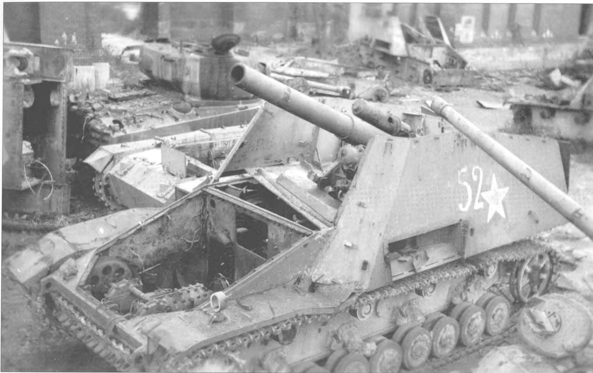
На этом «Хуммеле» славно потоптались кирзовые сапоги Красной Армии. На заднем плане - Pz.Kpfw. I Ausf. B, M4A2, Pz.Kpfw. III, слева - шасси М4. Разбитый «Хуммель» является самоходкой поздней постройки, так как на борту присутствует короб вокруг отверстия воздухозаборника, кроме того - приварены петли, предназначенные для крепления маскировки и тента. Самоходка полностью перекрашена в советский защитный цвет.
