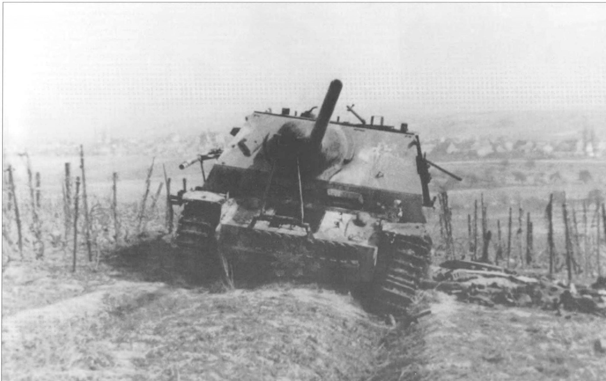
Та же машина. Есть возможность разглядеть Vorsatz-P спереди. В отличие от большинства истребителей танков Panzer IV/70(A), у этой машины отсутствуют крюки для крепления запасных траков на лобовой стенке рубки. Траки навешены только на лобовую часть корпуса. Сдвижной колпак рядом с маской пушки закрывает амбразуру пулемета MG42, стрельбу из которого вел заряжающий. На земле рядом с самоходкой валяются выбитые внутренним взрывом панели крыши рубки.
