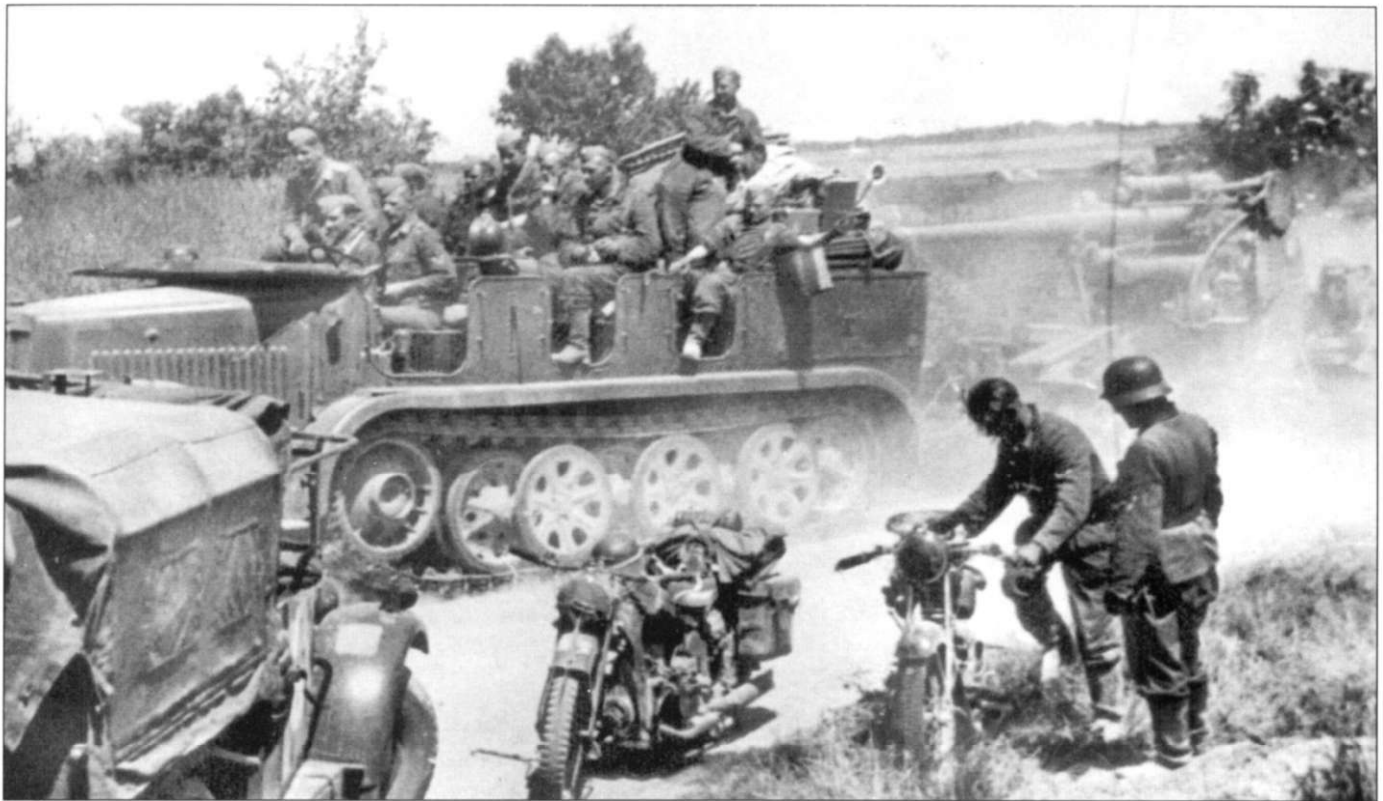
Пара мотоциклистов и легкий автомобиль пропускают тягач Sd.Kfz. 7 с пушкой FlaK-18 и трейлером Sd.Ah. 201 на прицепе. Тягач движется на высокой скорости, поднимая клубы пыли. Опять тягач полностью забит людьми и грузом. На бортах кузова смонтированы вертикальные поручни.
