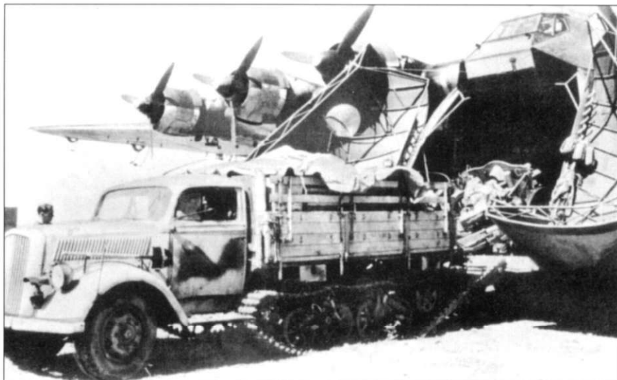
Опель «Маультиер» вытаскивает 105-мм гаубицу из чрева транспортного самолета Me-323 «Гигант». Маультиер изготовлен на основе грузовика Опель-Блиц 3-6-3S с использованием гусеничного движителя Карден-Ллойд. Полуусеничный грузовик был способен буксировать прицеп массой до 3 т, в частности 105-мм гаубицу. На машине Опель «Маультиер» стоял шестцилиндровый мотор Опель мощностью 68 л.с. при 3000 оборотах. Машина развивала максимальную скорость в 24 мили в час, запас хода составлял 100 миль.
