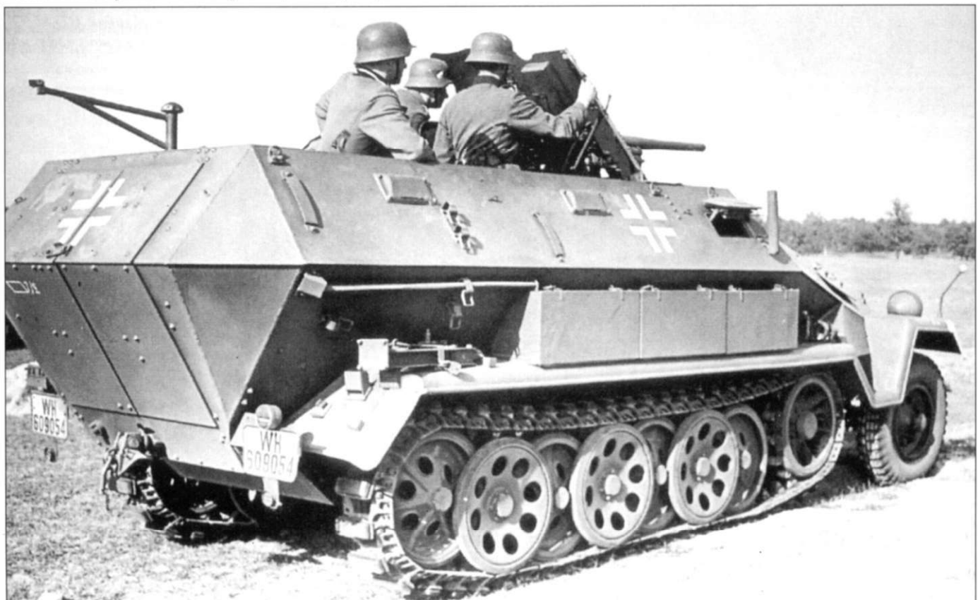
Бронетранспортер Sd.Kfz. 251/10 Ausf. A (определен по полноценному орудиному щиту пушки 3.7 см PaK-36) на учениях. Домкрат размещен на правой надгусеничной полке. Лопата с борта исчезла, но ее крепления сохранились. Маркировка машины состоит из креста и ромбовидного тактического символа панцерваффе. Номерной знак - вермахта.
