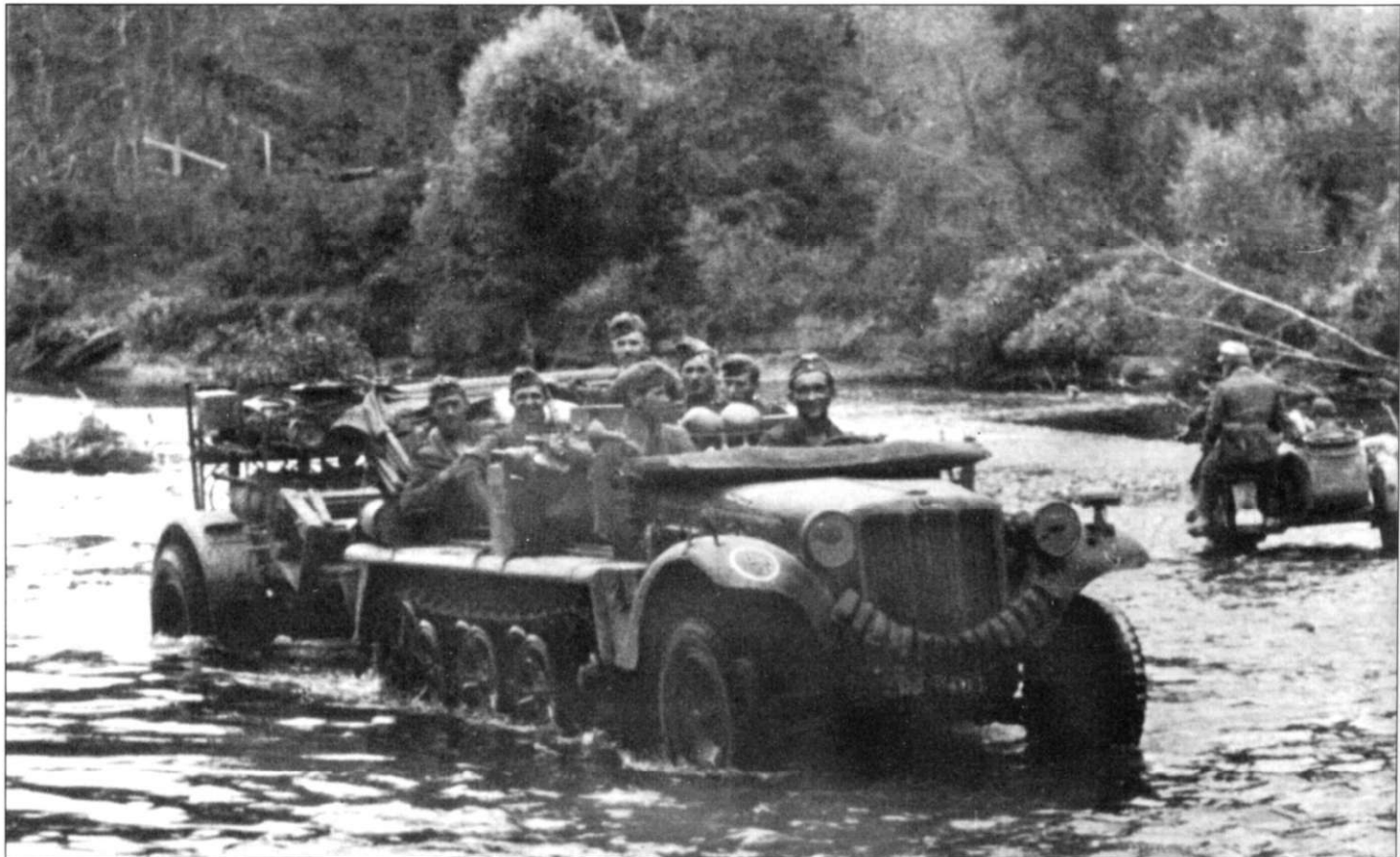
Тягач Sd.Kfz. 10 ракетной установкой Wurfrahmen калибра 280 мм или 320 мм на прицепе. Автопоезд форсирует водную преграду. На крыле тягача нанесена эмблема в виде окружности белого цвета. Между фарами подвешена проволока, с нанизанными на нее запасными резиновыми башмаками для гусениц.
