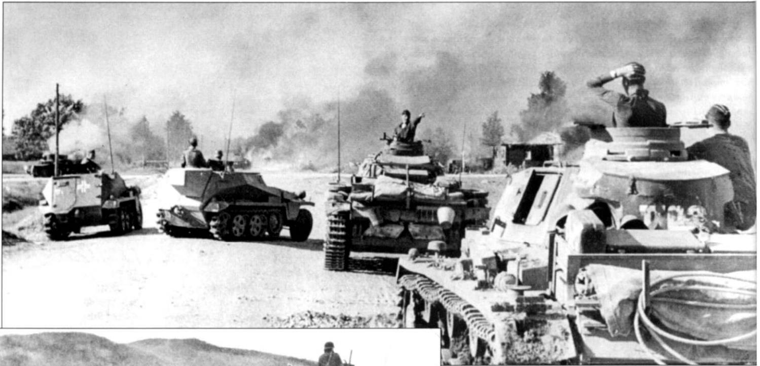
Скромно поименованные «Leichte Gepanzerte Beobachtungskraftwagen» две машины Sd.Kfz. 253 заняли середину дороги. Рядом - два танка Pz.Kpfw. III. На «центральной» бронемашине в корме закреплен обычный ящик. Тип машины, 253, удалось установить по круглому люку в крыше корпуса.
