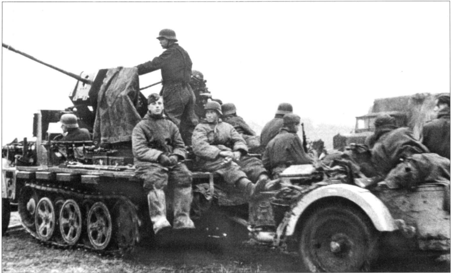
Частично бронированная зенитная самоходная установка Sd.Kfz. 10/4 вооружена пушкой 2 см Flak-30. На прицепе - трейлер Sd.Ah. 51. Магазины со снарядами разложены в кузове машины вокруг пушки. Скорострельность зенитки 2 см Flak-30 составляла 120 выстрелов в минуту. Дальность горизонтальной стрельбы - 4800 м. Эффективная высота поражения воздушных целей из пушки 2 см Flak-30 не превышала 2000 м.
