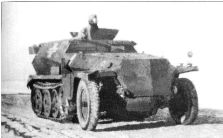
Сильно потертый броневик Sd.Kfz. 250/1 Ausf. B, за ним - броневик Sd.Kfz. 243/3, вооруженный пушкой 7.5 см KwK-37. Корпус бронетранспортера Ausf. B был проще в изготовлении, чем корпус бронетранспортера варианта Ausf. A. Внешние багажники вписаны в общий контур кузова изменена конфигурация лобовой части капота двигателя. Внутренний объем кузова увеличился при оставшихся неизменными габаритами.
