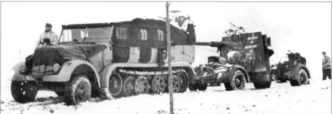
Сравнительно новый тягач Sd.Kfz. 7 буксирует орудие-ветеран FlaK-36/37 на трейлере Sd.Ah. 203. На орудийном щите нарисованы многочисленные отметки об уничтоженных целях. Орудие снабжено составным стволом R.A. 9. Тягач окрашен краской цвета Dunkelgelb RAL 7028. Между первым и вторым рядами сидений нанесены погрузочная маркировка. На крыле смонтирована фара Нотек.
