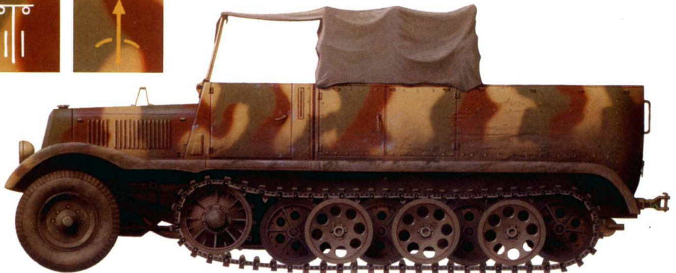
3-тонный полугусеничный тягач SdKfz 11 из 92-го артполка 20-й танковой дивизии, Восточный Фронт, ноябрь 1944 г. Базовый цвет тягача - темно-желтый, поверх которого нанесены оливково-зеленые и красно-коричневые пятна. Дивизионный знак - желтого цвета, тактический знак батареи буксируемой артиллерии - белого цвета.
