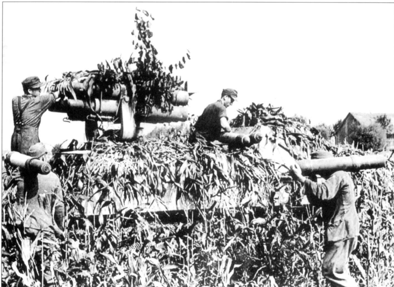
Расчет готовит реактивную систему залпового огня «Панцерверфер» к бою. Боевая машина обозначалась Sd.Kfz. 4 и представляла собой бронированный корпус «Маультияера» с установленной на нем 10-зарядной пусковой установкой неуправляемых снарядов 15 см Nebelwerfer-Zehning-42 . Пусковая установка вращалась на 360 градусов. В боекомплект входили фугасные и дымовые ракеты, дальность стрельбы составляла 6900 метров. Десять ракет «второго выстрела» хранилось внутри корпуса боевой машины.
