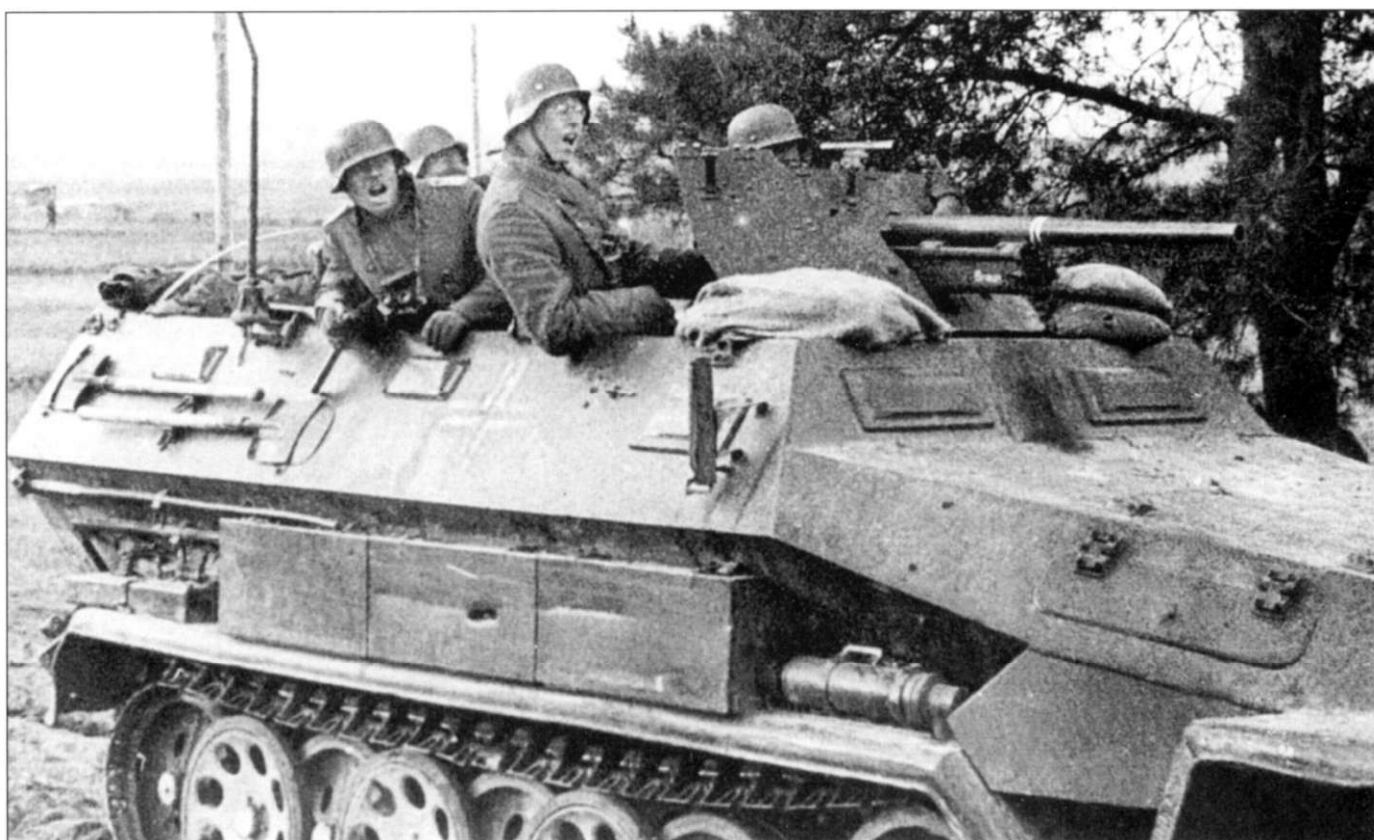
Экипаж бронемашины Sd.Kfz. 251/10 Ausf. А раздирают эмоции. Весь шанцевый инструмент закреплен на отведенных ему местах, однако застёжки лопат не закрыты. Для дополнительной защиты уложены мешки с песком. Антенна убрана. Верхняя часть орудийного щита срезана для лучшего обзора.
