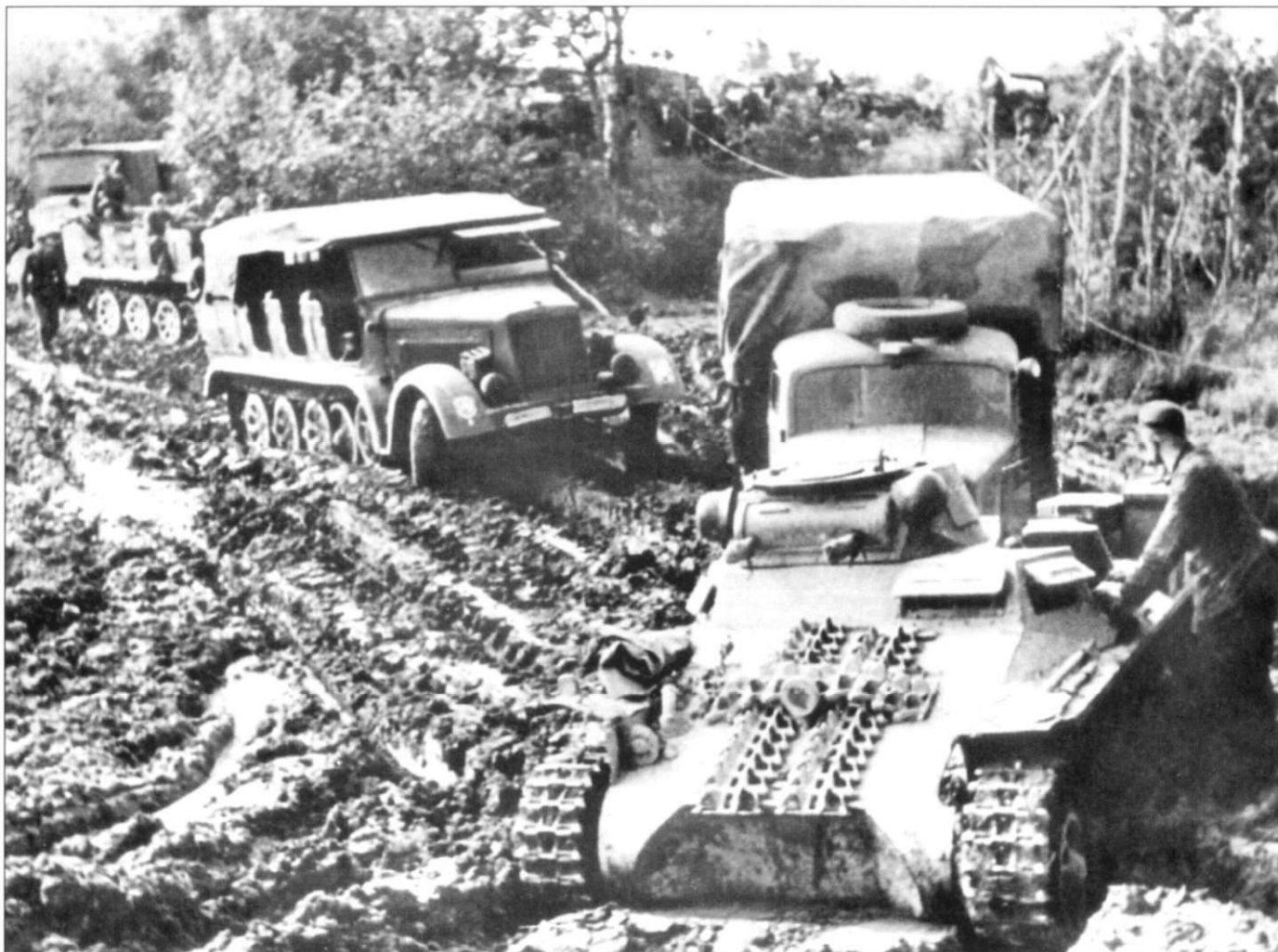
Тягач Sd.Kfz. 7 в грязи. На переднем плане - танк Pz.Kpfw. I, за ним - грузовик. Вариант тягача KMT-11 (на снимке) оснащался 6-цилиндровым двигателем Майбах HL-62 TUK (или HL-64 TR) мощностью 140 л.с. По шоссе тягач развивал максимальную скорость 31 миль в час, запас хода составлял 156 миль.
