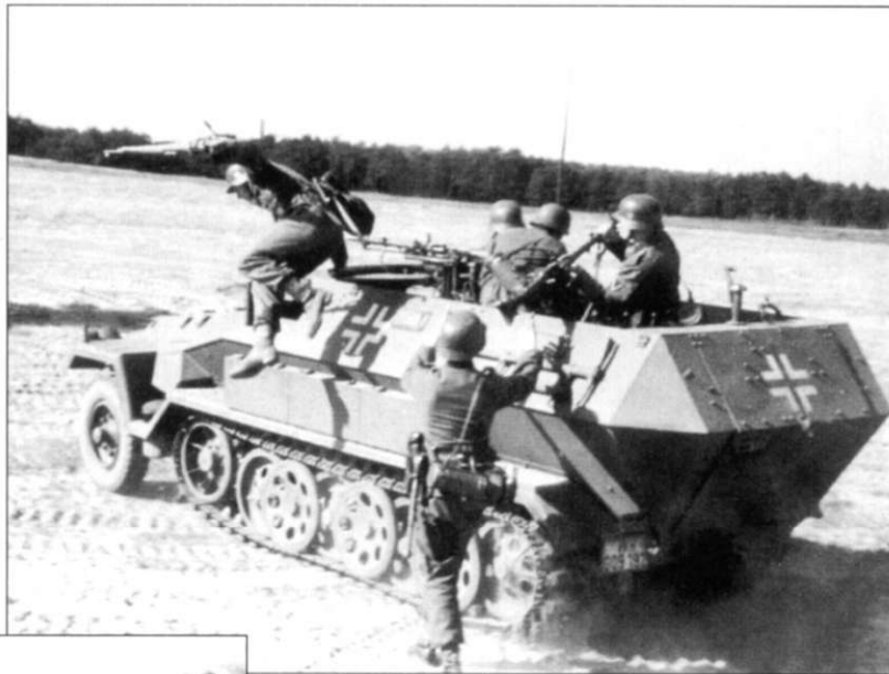
Бронетранспортер Sd.Kfz. 251/1 на учениях. Вариант Ausf. A идентифицируется по трем смотровым блокам в верхней части корпуса. Передний пулемет установлен на турели, задний - снят. Радиоантенна установлена штатно. Номерной знак указывает на принадлежность машины вермахту.
