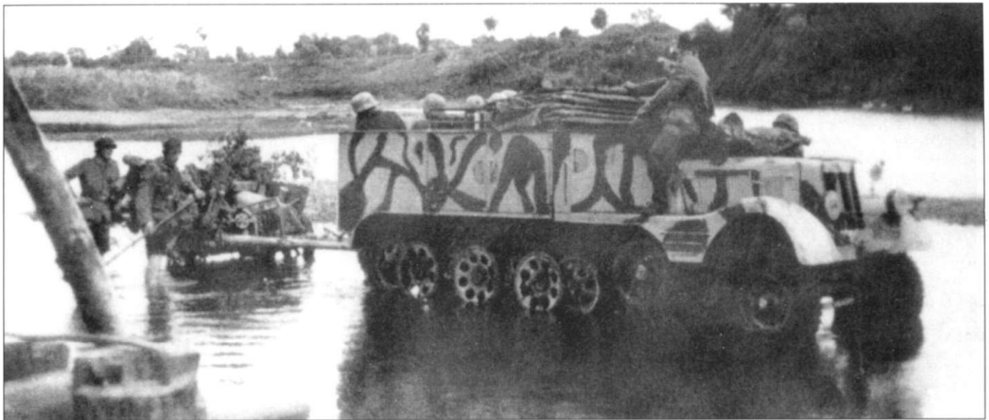
Тягач Sd.Kfz. 11 с противотанковой пушкой 7,5 см PaK-97/38 на прицепе форсирует вброд реку. Машина окрашена в «разрушающий» камуфляж темными пятнами по светлому фону. По полукруглому переходу между крылом и надгусеничной полке тягач идентифицируется как Sd.Kfz. 11/4 Nebelkraftwagen.
