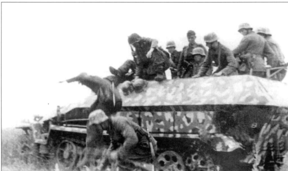
Бронетранспортер Sd.Kfz. 251/10 Ausf. B сфотографирована в момент выстрела из пушки 3,7 см PaK-36. Орудие частично закрыто щитом. Щит закрывает левую сторону, где установлен прицел. Антенна установлена более-менее стандартно.
