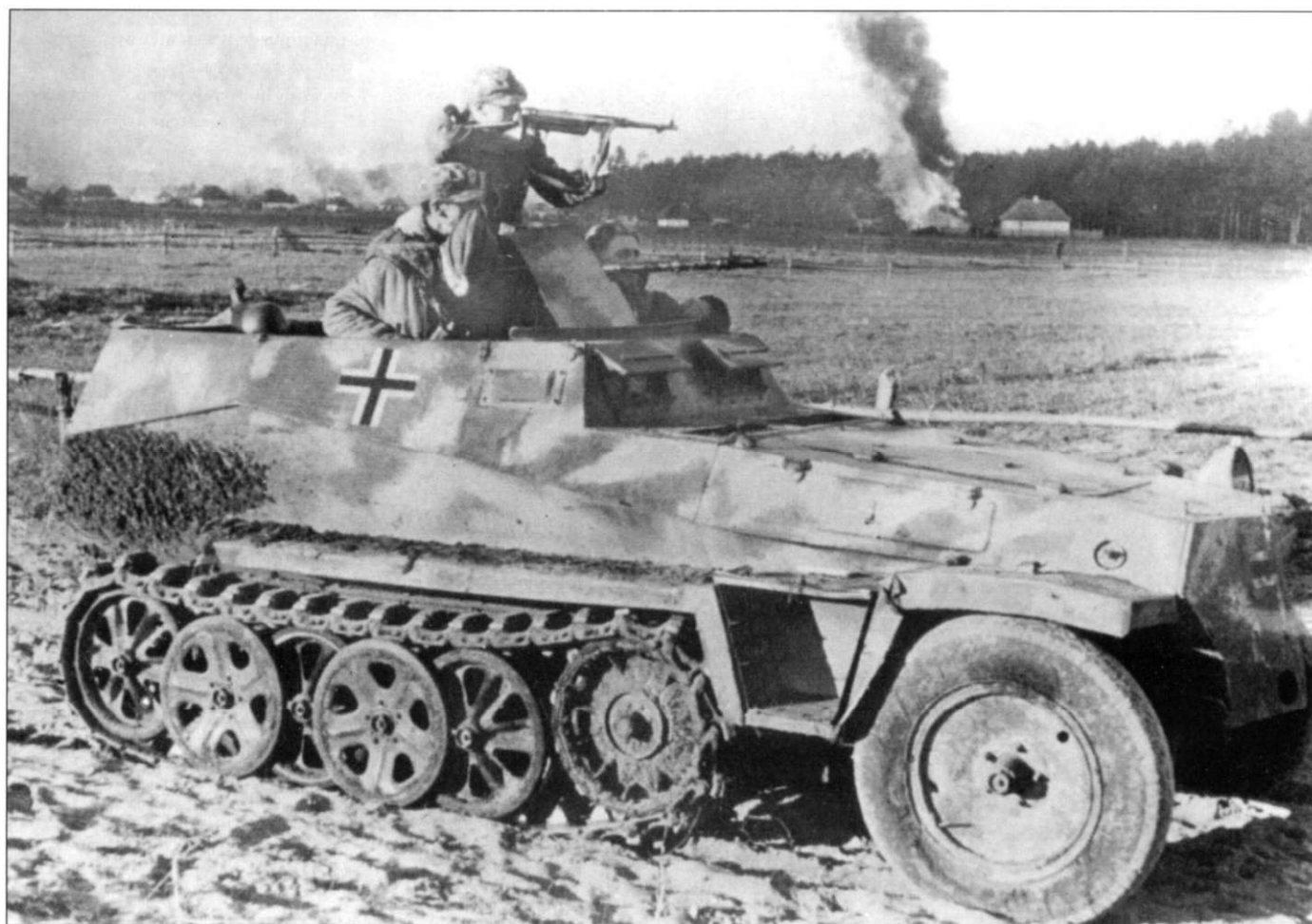
Экипаж бронетранспортера Sd.Kfz. 250/1 перестреливается с противником, используя пистолет-пулемет MP-40 и пулемет MG34. Бронетранспортер утратил ряд элементов: часть крыла, весь инструмент, дверцу инструментального ящика, фары. Радиоантенна не установлена. Бронетранспортеры Sd.Kfz. 250/1 оснащались 6-цилиндровыми двигателями Майбах HL-42 TRKM мощностью 100 л.с. Максимальная скорость машины по шоссе составляла 40 миль в час. Боевая масса машины - 6,4 тонны, длина - 15 футов, ширина - 6,3 фута, высота 5,2 фута.
