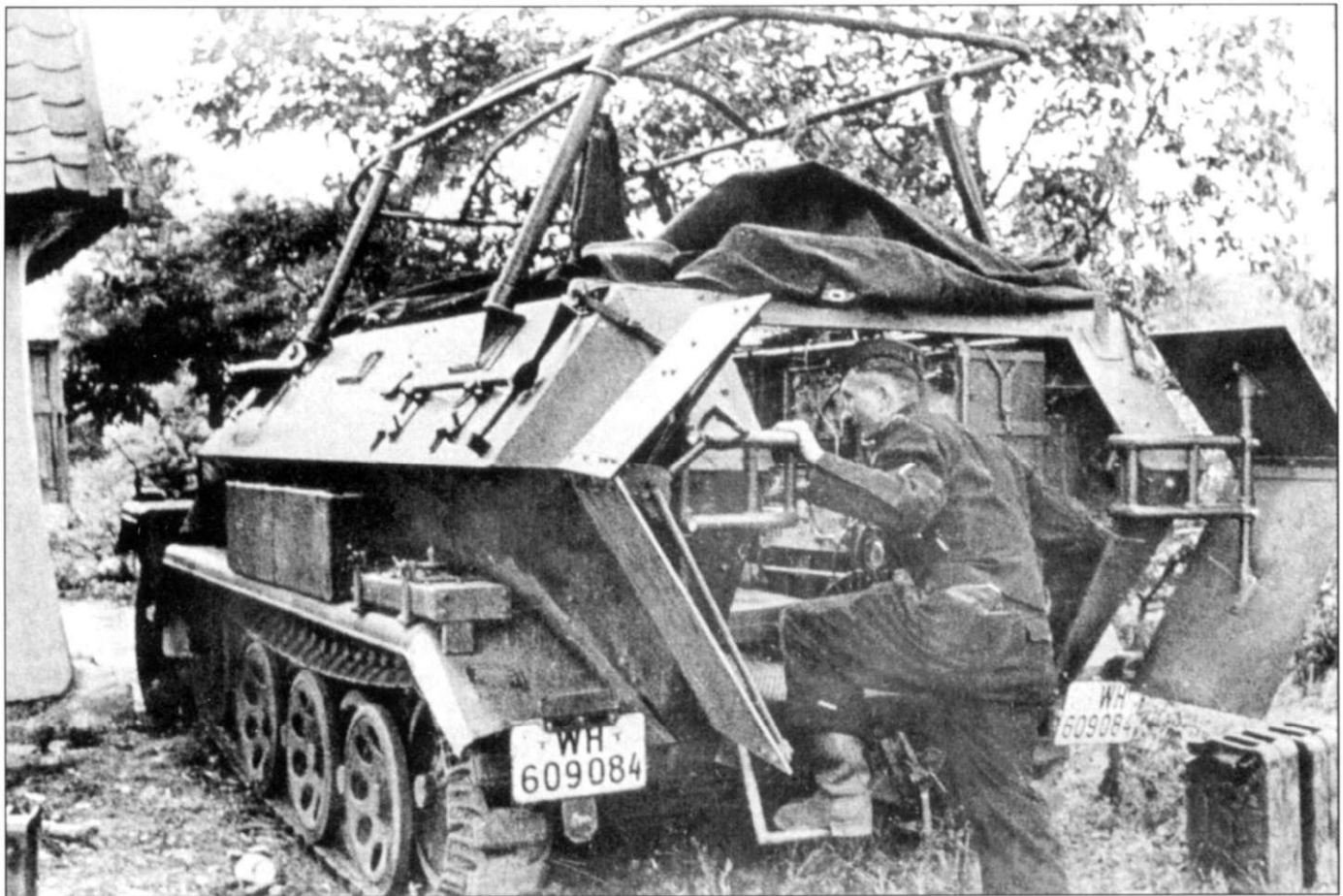
На снимке просматривается интерьер боевого отделения машины Sd.Kfz. 251/6 Ausf. A. Машина оснащена радиоантенной Rahmanantenna и телескопической антенной Kurbelmast высотой в поднятом положении 8 м. На борту кузова закреплены фиксаторы для двух шанцевых инструментов, вместо нормальных трех. Хорошо видны петли створок двери в кормовом бронелисте корпуса. Часть заднего подкрылка окрашена в белый цвет. Номерной знак вермахта. Солдат одет в черную униформу панцерваффе. На заднем подкрылке машины размещен домкрат раннего типа.
