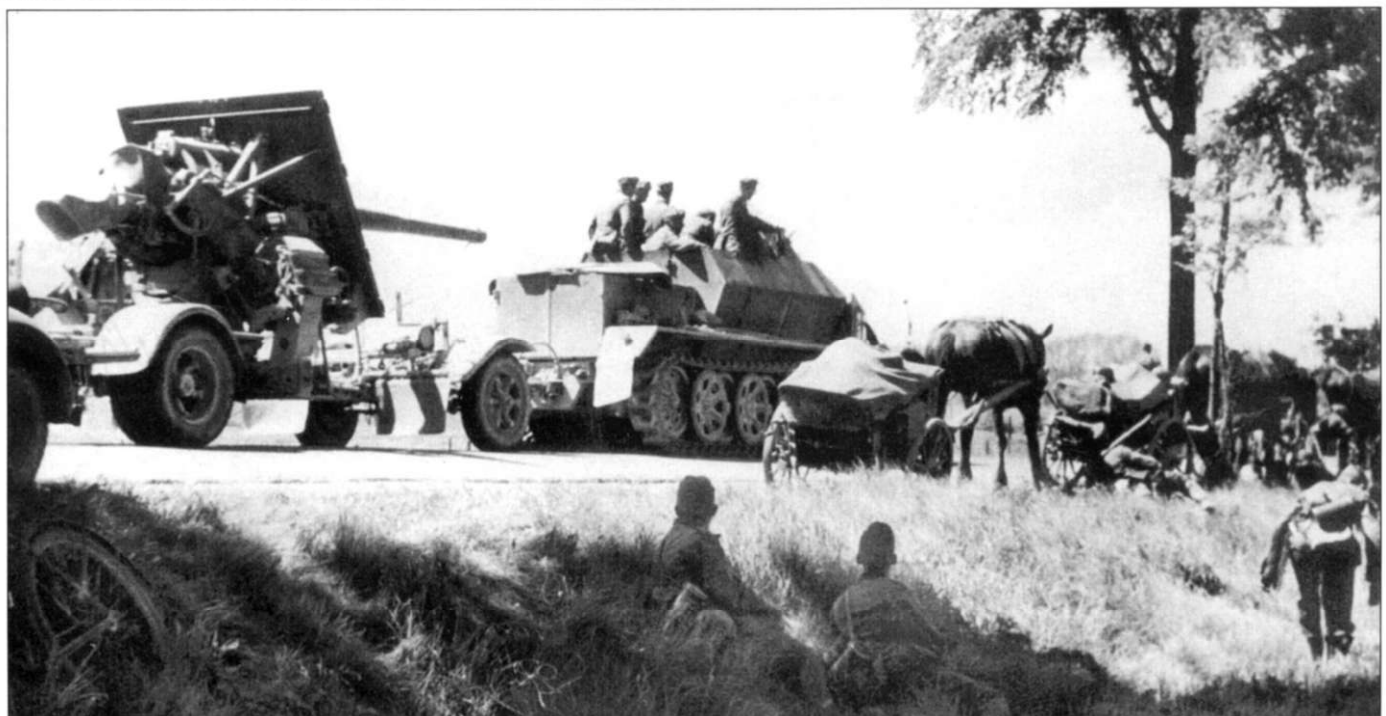
Тягач Sd.Kfz. 7 с бронекорпусом («Geranzerte 8 ton Zugkraftwagen») тянет 88-мм зенитку, поставленную на трейлер Sd.Ah. 201. Пушка снабжена щитом очень необычной формы. Подобные комбинации тягачей и зениток во время кампании во Франции имелись на вооружении 525-го, 560-го и 605-го противотанковых батальонов.
