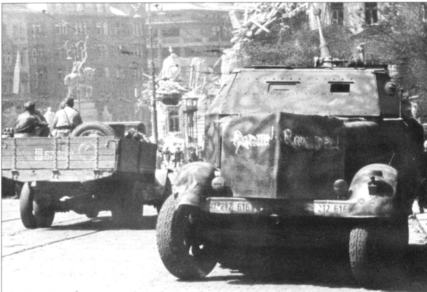
Еще один вариант зенитной самоходной установки на базе тягача Sd.Kfz. 7 - Sd.Kfz. 7/2. Машины Sd.Kfz. 7/2 вооружались зенитками 3.7 см FlaK-37 или 3.7 см FlaK-43. Это - броненная самоходка, может даже трофей. Мимо нее только что проследовал грузовик Красной Армии с красноармейцами в кузове. Тягач окрашен пятнистым камуфляжем. На щитке перед радиатором выполнена какая-то надпись готическим шрифтом. Очень необычны фары небольшого диаметра, снабженные светомаскировочными колпачками.
