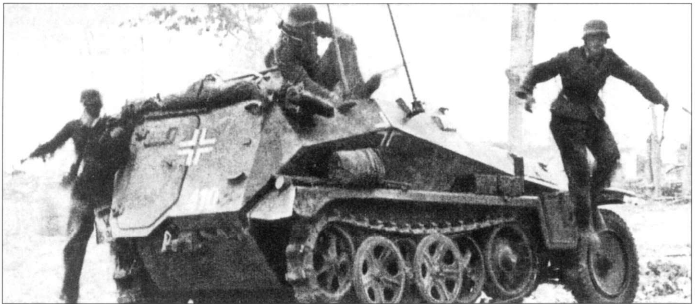
Экипаж быстро покидает радиомашину Sd.Kfz. 250/3 через борта кузова, не тратя времени на открывания двери. На машине установлено две радиоантенны. Небольшие полукруглые фитинги на заднем листе корпуса служат для фиксации буксирного троса. Интересным образом нарисован крест на борту корпуса. Ребра корпуса проходят меж «половинок» креста.
