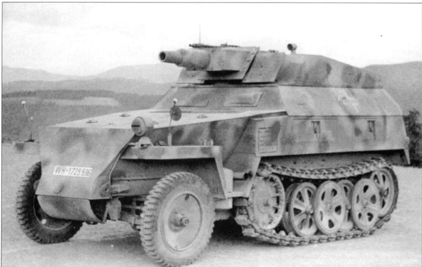
Почти новенький бронетранспортер Sd.Kfz. 250/8 Ausf. B. Качественный снимок, на котором видны все детали окраски. По базовой окраске цвета Dunkelgelb RAL-7028 нанесены пятна цвета Olivgrün RAL-6003 и Rotbraun RAL-8017. На корпусе над ведущим колесом нанесены данные, необходимые для погрузочно-разгрузочных работ с данным образцом техники. Номерной знак - вермахта (WH-1725596). Крест на борту кузова изображен «скобками» белого цвета. Пушка 7.5 см KwK-37 L/24 смонтирована в универсальной установке K51, с орудием спарен пулемет MG42. Пушка снабжена прицелом SflZF1b/Rblf36. Смотровой блок в левом борту корпуса закрыт заглушкой - обычная практика на пушечных модификациях бронетранспортера. Обратите внимание на фару со светомаскировочным чехлом, зеркало заднего вида и пустой крепеж инструмента на крыле переднего колеса.
