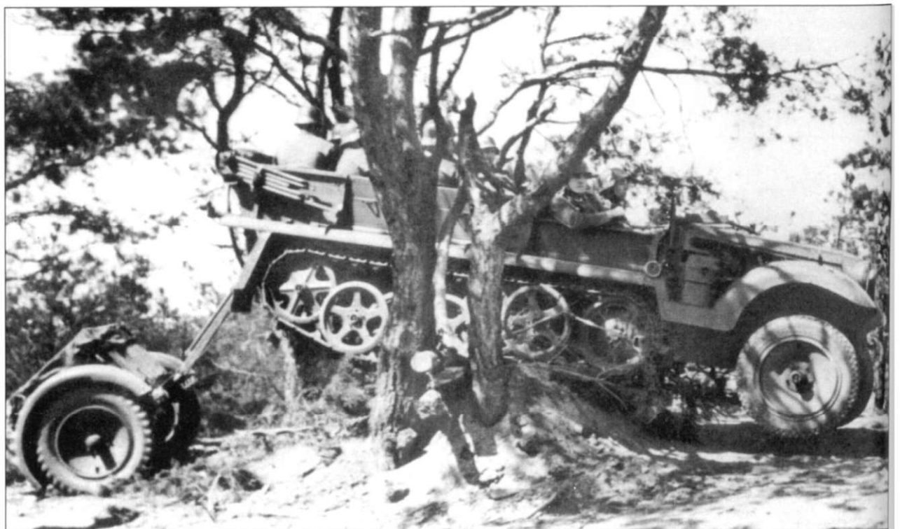
Тягач Sd.Kfz. 10 с передними колесами «первого» типа демонстрирует способность к преодолению препятствий. На прицепе - трейлер Sd.Ah. 32. Между передним крылом и надгусеничной полкой тягача установлено некое устройство цилиндрической формы. В кадр фотографа попала машина D6 с 6-цилиндровым двигателем Майбах NL38 TRKM мощностью 83 л.с.
