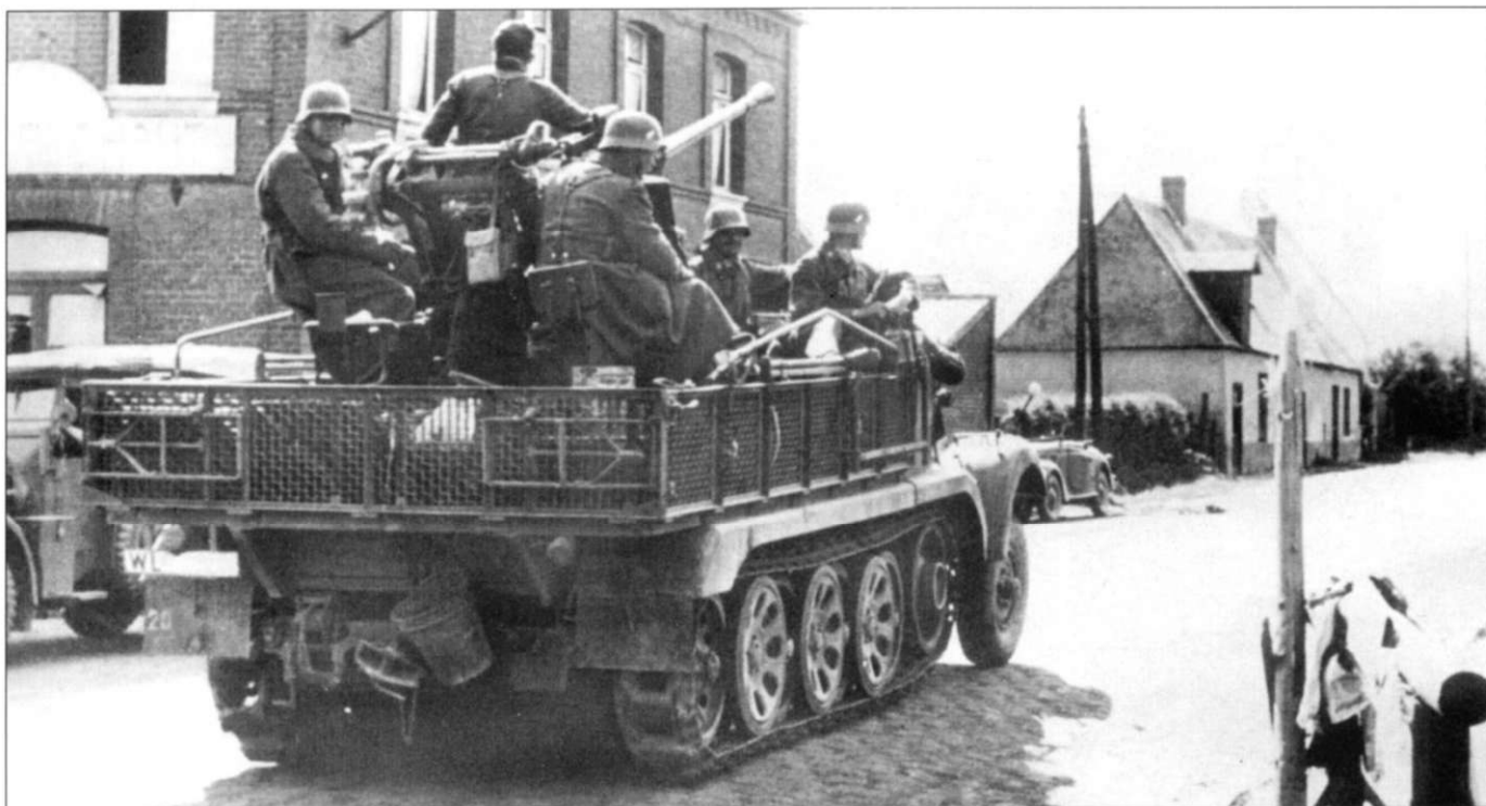
Самоходка Sd.Kfz. 6/2 с 37-мм зениткой FlaK-36 выдвигается на передовую. Машина принадлежит подразделению люфтваффе - на номерном знаке буквы WL. Не менее 200 зенитных самоходок на базе тягача Sd.Kfz. 6 поступило на вооружение частей ПВО люфтваффе. На вооружении одной зенитной батареи состояло девять самоходок. Пушка 3.7 cm FlaK-37 представляла собой зенитку FlaK-36, оснащенную щитом. Орудие снабжалось запасными стволами.
