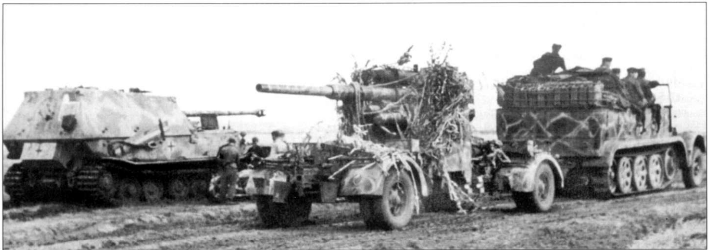
Тягач Sd.Kfz. 7 с зениткой 8,8 см Flak-36 или Flak-37 на буксире, на заднем плане - тяжелый истребитель танков «Фердинанд». Зенитка установлена на трейлере Sd.Ah. 203. Тягач и пушка окрашены в очень изобретательный камуфляж, причем краска светлого цвета распылена из краскопульта по краске темного цвета.
