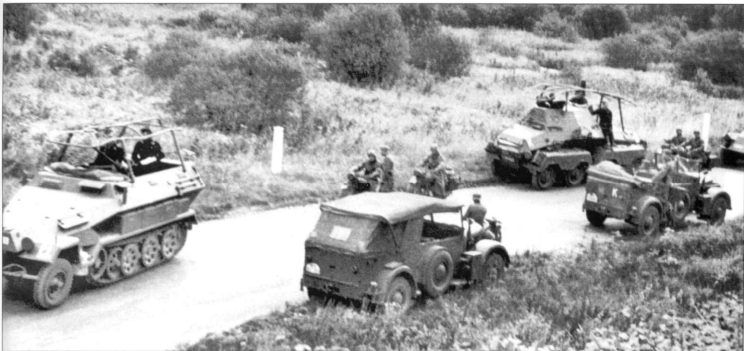
Колонна бронетехники и мотоциклов движется навстречу автоколонне из двух автомобилей повышенной проходимости Kfz. 15. Следом за полугусеничным бронетранспортером Sd.Kfz. 251/3 Ausf. A движется тяжелый бронеавтомобиль Sd.Kfz. 263 (8 Rad). Буква «K» обозначает принадлежность техники танковой группе фон Клейста. Фары Нотек на бронетранспортере нет, значит, скорее всего, снимок сделан в период марша по Франции в 1940 г.
