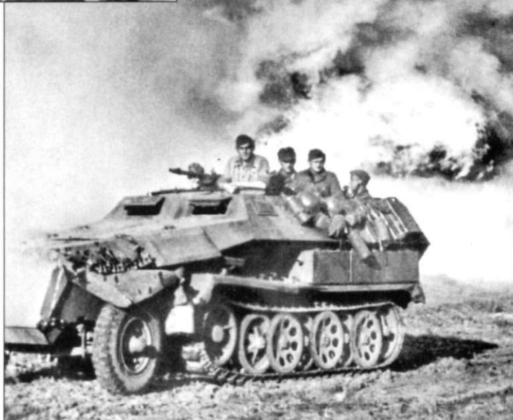
Бронетранспортер Sd.Kfz. 251/1 Ausf. C. Передний пулемет установлен на нештатной турели. Машины варианта Ausf. C отличались капотом новой формы, такие же капоты имели поздние Ausf. D. Крыло переднего колеса сильно помято. На борту кузова экипаж развесил свое имущество - боевое отделение бронетранспортера было очень тесным.
