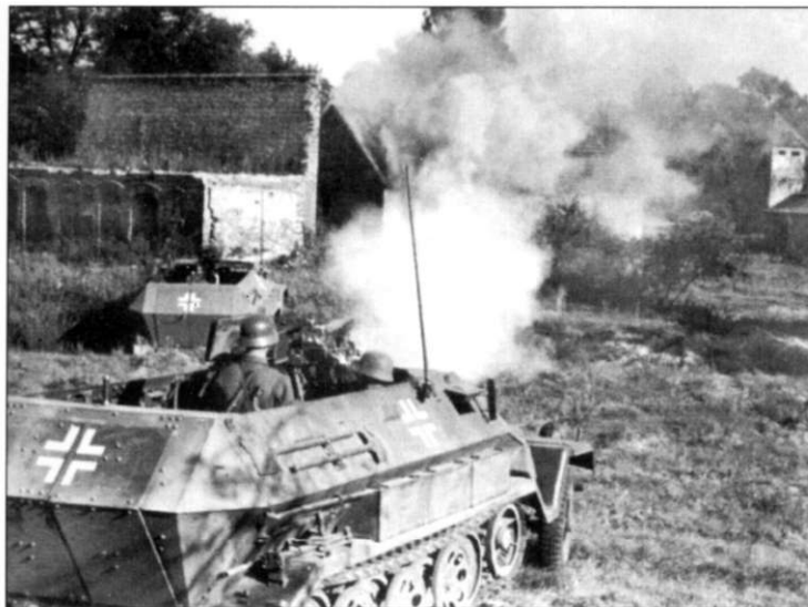
Бронетранспортер Sd.Kfz. 251/10 Ausf. B сфотографирована в момент выстрела из пушки 3,7 см PaK-36. Орудие частично закрыто щитом. Щит закрывает левую сторону, где установлен прицел. Антенна установлена более-менее стандартно.
