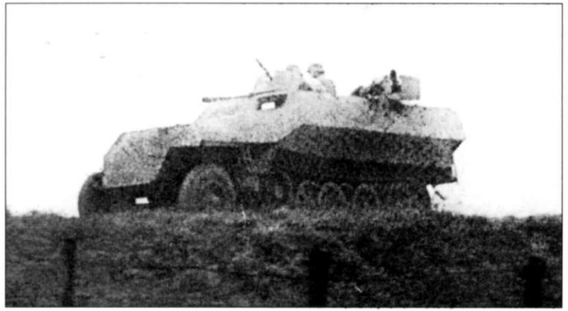
Редкий снимок - огнеметная машина Flammpanzerwagen Sd.Kfz. 251/16 Ausf. D . Машина вооружена двумя 140-мм огнеметами. Бак огнесмеси емкостью 700 литров позволяет произвести 80 выстрелов продолжительностью 1 секунда каждый. Дальность метания огнесмеси составляла 50 м. Экипаж огнеметного бронетранспортера состоял из четырех человек - командир/радист, механик-водитель, два огнеметчика.
