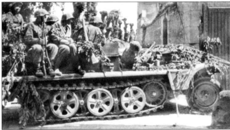
Замаскированный ветками тягач Sd.Kfz. 10 с передними колесами «второго» типа. На тягаче разместилось отделение пехоты. Все солдаты одеты в камуфляж.
