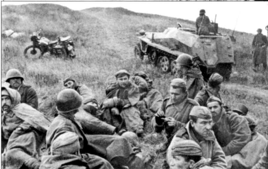
Пленные красноармейцы под охраной бронемашин Sd.Kfz. 253. Просматривается крыша бронемашин с вращающимся круглым люком, в которой установлен перископ S.F. Германский военный стоит в заднем люке прямоугольной формы.
