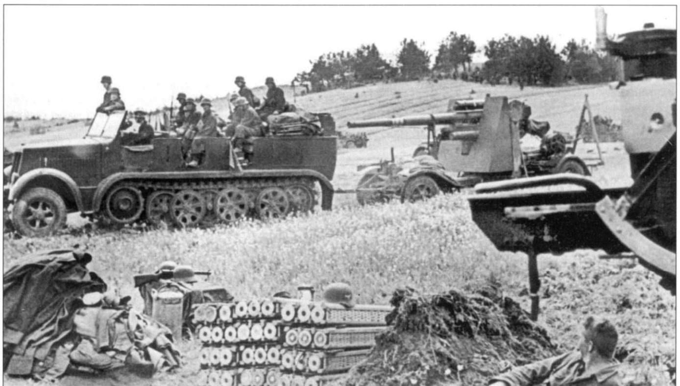
Пока один расчет зенитного орудия отдыхает, второй передвигается мимо на тягаче Sd.Kfz. 7 с пушкой FlaK-18 и трейлером Sd.Ah. 201 на прицепе. На переднем плане хорошо видны контейнеры с 88-мм снарядами. На снарядах лежит каска, на боку которой нарисован орел люфтваффе. Промеж двух других касок положен раритетный пистолет-пулемет Бергмана. Фары Нотек на тягаче нет.
