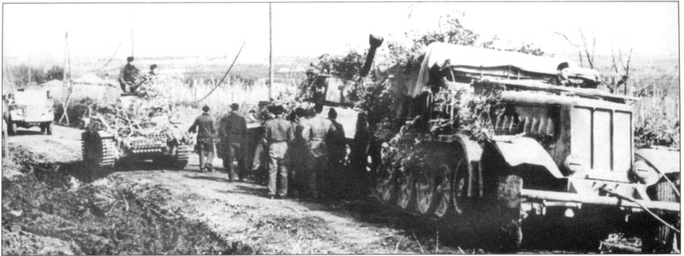
Тягач FAMO из 508-го тяжелого танкового батальона пытается стронуть с места застрявший «Тигр». В кадр попал только один тягач, на самом деле несколько машин связаны цугом - видны буксирные тросы. Один «Тигр» обычно буксировали три тягача Sd.Kfz. 9 сразу. Снимок сделан в Италии. Кузов тягача - позднего выпуска с крыльями прямоугольной формы и передним бампером в виде трубы. За драмой танка «Тигр» и тягачей Sd.Kfz. 9 с интересом наблюдает экипаж танка Pz.Kpfw. II Ausf. F.
