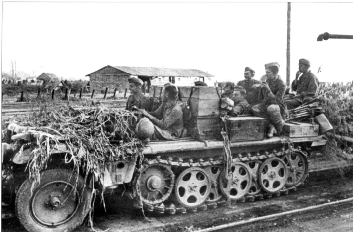
Тягач Sd.Kfz. 10 загружен снарядными ящиками и военными. Полугусеничный автомобиль уверенно передвигается по железнодорожному полотну. За местами водителя и пассажира на тягаче собрана необычная деревянная конструкция. Из-за веток невозможно установить какого типа орудие прицеплено к тягачу. Обычно тягачи Sd.Kfz. 10 буксировали противотанковые орудия 5 см PaK-38 и 7.5 см PaK-40.
