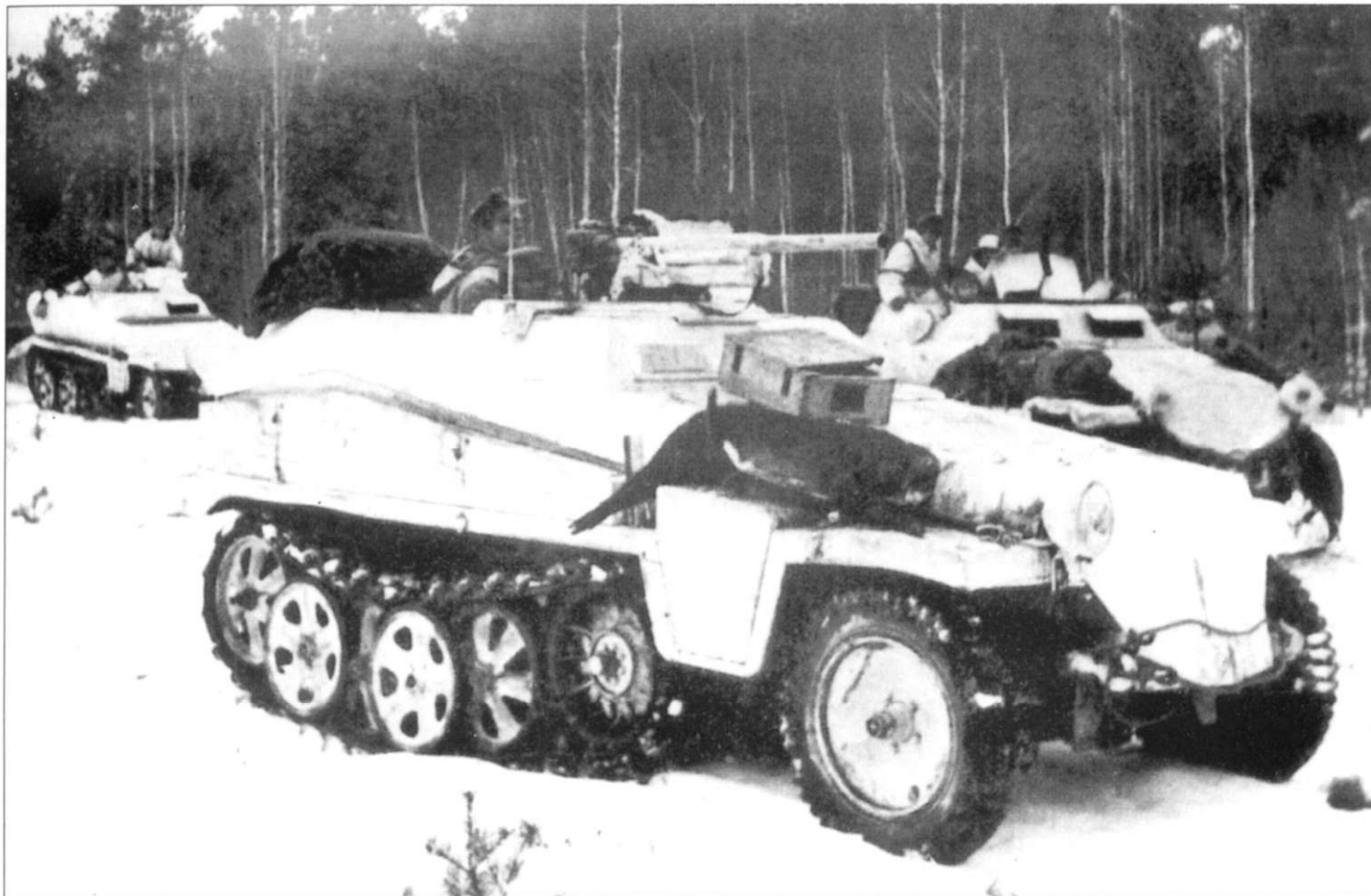
Машина командира взвода Sd.Kfz. 250/10 вооружалась легкой противотанковой пушкой 3.7 см PaK-36. В данном случае щит орудия выполнен в виде сэндвича. Машина окрашена в белый цвет.
