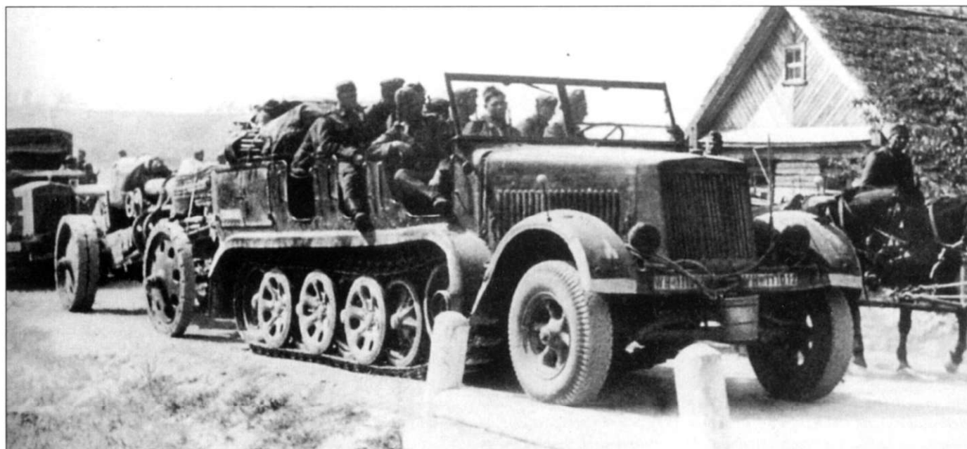
Тягач Sd.Kfz. 7 с орудием 10 см s.K-18 на прицепе. При перевозке стволы орудий обычно ставили в крайнее заднее положение отката для сокращения длины автопоезда. Обратите внимание насколько завален тягач разнообразным имуществом и скарбом. На левом крыле установлена фара Нотек. На правом крыле нанесена эмблема 23-й танковой дивизии. Оба крыла по низу обведены каймой белого цвета для облегчения вождения машины в колонны ночью.
