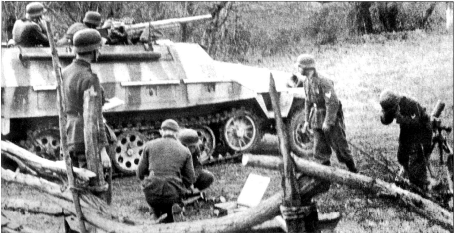
Расчет 80-мм миномета Gr.W-34 ведет огонь под прикрытием бронетранспортера Sd.Kfz. 251/10 Ausf. D , вооруженного 37-мм противотанковой пушкой. Это орудие к моменту начала серийного производства машин модификации Ausf. D устарело абсолютно, но других пушек не было. Машина камуфлирована широкими вертикальными полосами. Над крышками багажных отсеков установлены козырьки от дождевой воды. Обратите внимание на местоположение антенного ввода.
