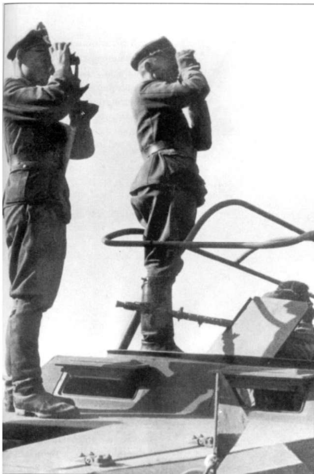
Пара германских офицеров обзоревают местность в бинокли. Военные заняли наблюдательную позицию на бронетранспортере Sd.Kfz. 251/3 Ausf. C. Одна створка доступа к двигателю открыта. Корпуса бронетранспортеров варианта Ausf. C были сварными. Пулемет MG34 снабжен щитком. Флажок на переднем плане обозначает принадлежность машины штабу танковой дивизии.
