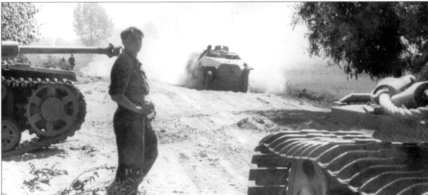
Бронетранспортер мчится по пыльной дороге. Снимок интересен отнюдь не машиной Sd.Kfz. 251, а крупным планом танковых траков Ostketten на штурмовом орудии StuG III Ausf. G. Траки Ostketten представляли собой уменьшенный в размерах вариант траков танка «Тигр», не следует путать их с траками Winterketten. Последние были шире и имели более развитые грунтозацепы.
