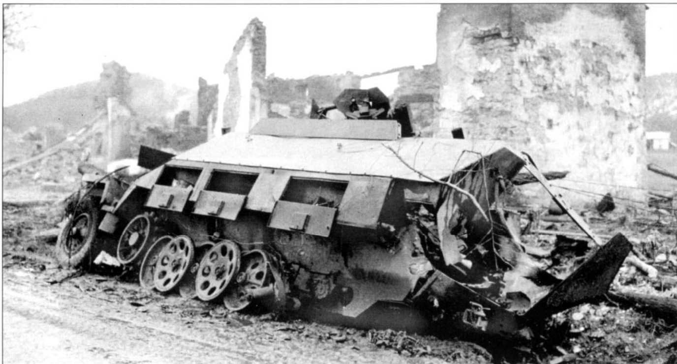
Fliegerabwehr Schützenpanzerwagen (2 cm MG151 Drilling) Sd.Kfz. 251/21 Ausf. D подбит на городской улице. Машина, скорее всего, взорвана экипажем. Гусениц нет вообще. Резиновые бандажки опорных катков сгорели. Крышки багажных отсеков откинута.
