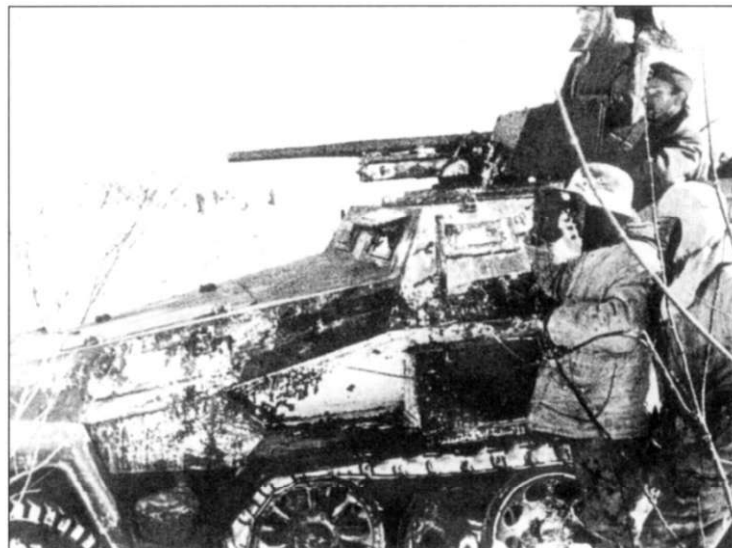
Зимняя окраска белого цвета почти слезла с поверхностей бронетранспортера Sd.Kfz. 251/10 Ausf. B. Орудийный щит - типа сэндвич.
