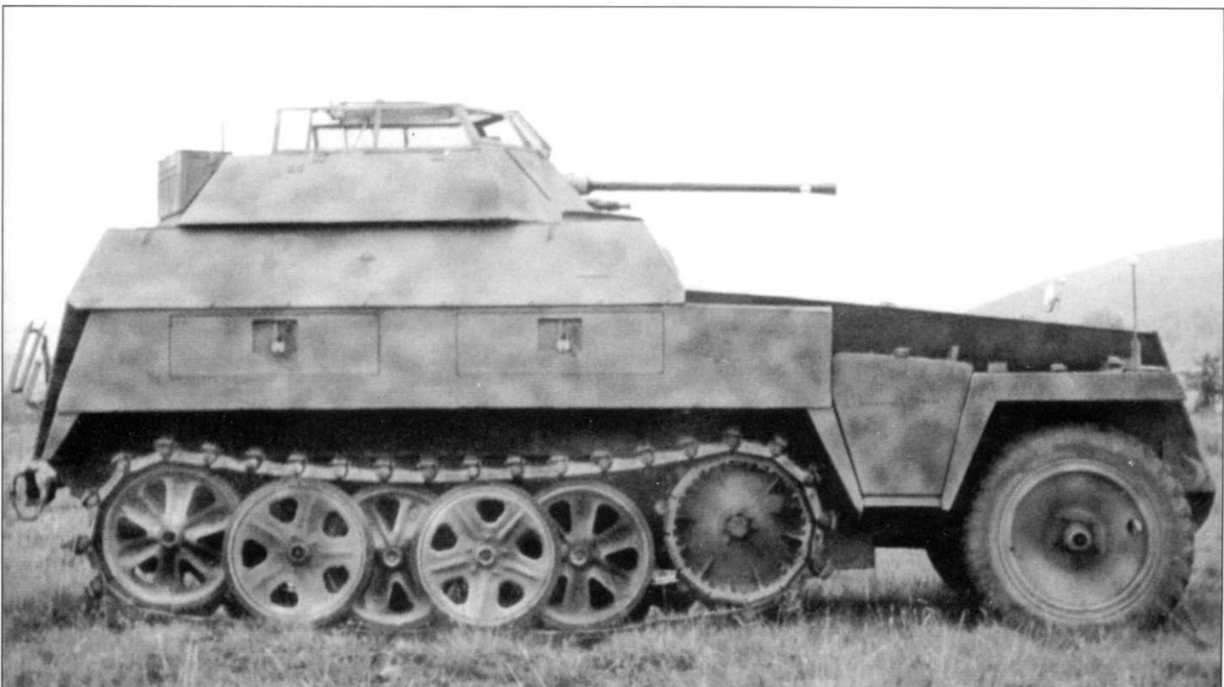
Вид сбоку бронемашины Leichtes Schützenpanzerwagen (2 cm) Sd.Kfz. 250/9 Ausf. B. Налицо все отличия разведывательной машины - Aufklärungspanzerwagen. На крыше боевого отделения смонтирована вращающаяся башня с 20-мм пушкой и спаренной с ней 7,92-мм пулеметом. Просматривается штыревая антенна радиостанции Fu.Spr.Ger.f в задней части башни. Открытую сверху башню прикрывают от гранат откидные сетки-экраны. Машина окрашена в цвет Dunkelgelb RAL-7028, поверх которого нанесены пятна цвета Olivgrün RAL-6003 и Rotbraun RAL-8017.
