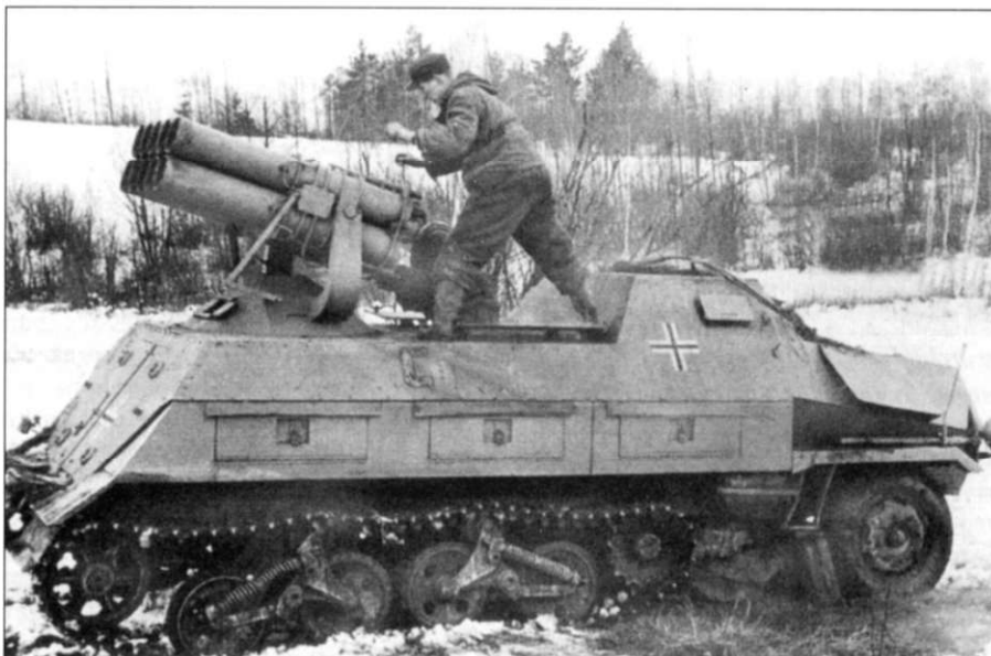
Боевая машина «Панцерверфер», промаркированная буквой «С». Расчет готовит установку к стрельбе. Люк в крыше открыт, из него извлекают ракеты. Обратите внимание на форму ведущего колеса, отличную от ведущего колеса машины «Gustav». На борту видны следы от газов твердотопливных ракетных двигателей. Над крышками бортовых ящиков сделаны дождевые козырьки. Между гусеницей и передним колесом устроен багажник для канистры.
