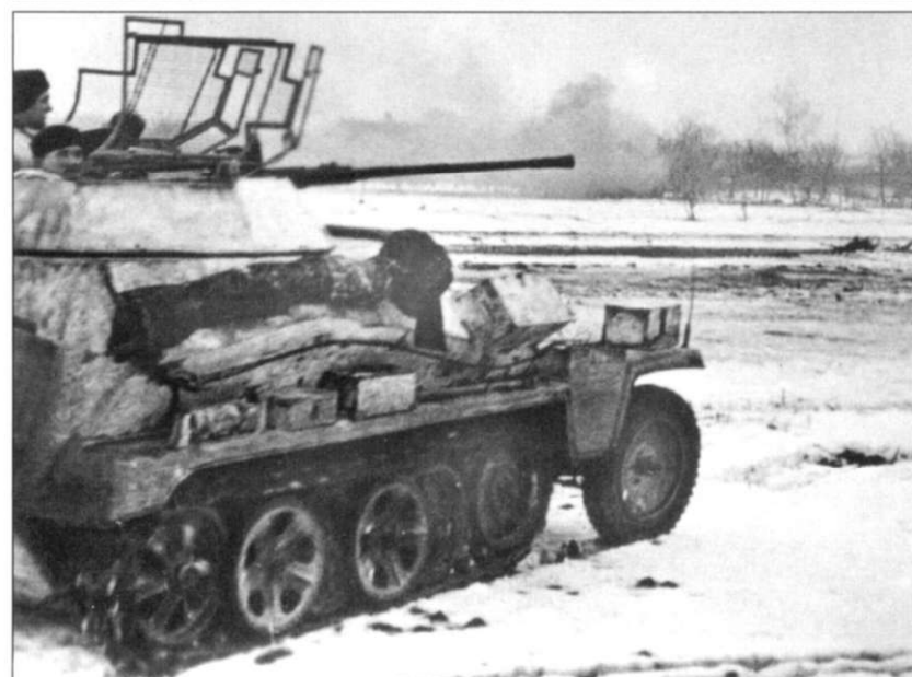
На бронетранспортере Sd.Kfz. 250/9 была установлена башня от броневедомости Sd.Kfz. 222. Официально полугусеничный броневедомость именовался «le.SPW (2 ст)» (Sd.Kfz. 250/9 Ausf. A). Башня закрыта самодельным тентом. Рядом с капотом пристроен длинный ящик, который, вероятно, служит для хранения запасных стволов к 20-мм пушке. Данная машина вооружена башенной установкой из 20-мм автоматической пушки KwK-38 и спаренного с ней 7,92-мм пулемета MG34. На заднем плане - Sd.Kfz. 250/9 Ausf. C.
