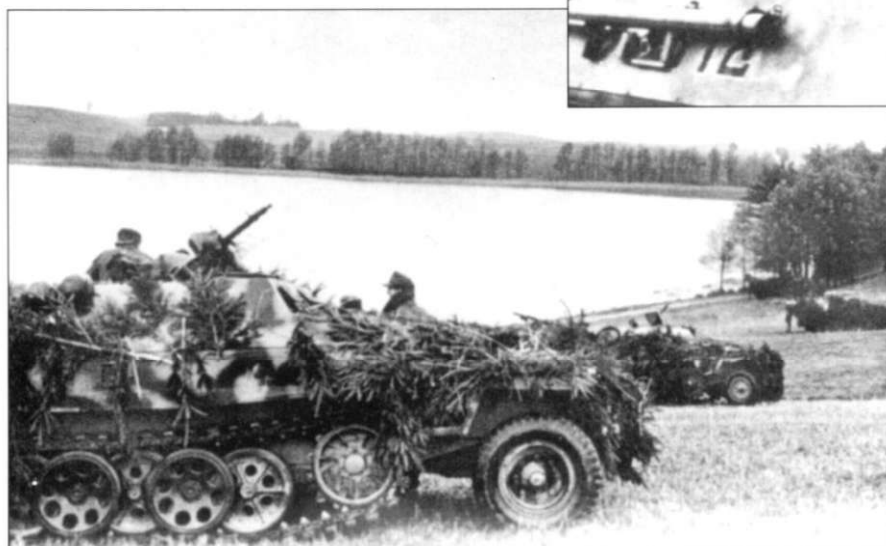
Несколько бронетранспортеров Sd.Kfz. 251 Ausf. D разворачиваются в боевой порядок. На ближайшей машине нанесен трехзначный бортовой номер, который скрыт противотанковым ружьем 8.8 см Raketenpanzerbuchse (RP43), более известное как Panzerschreck.
