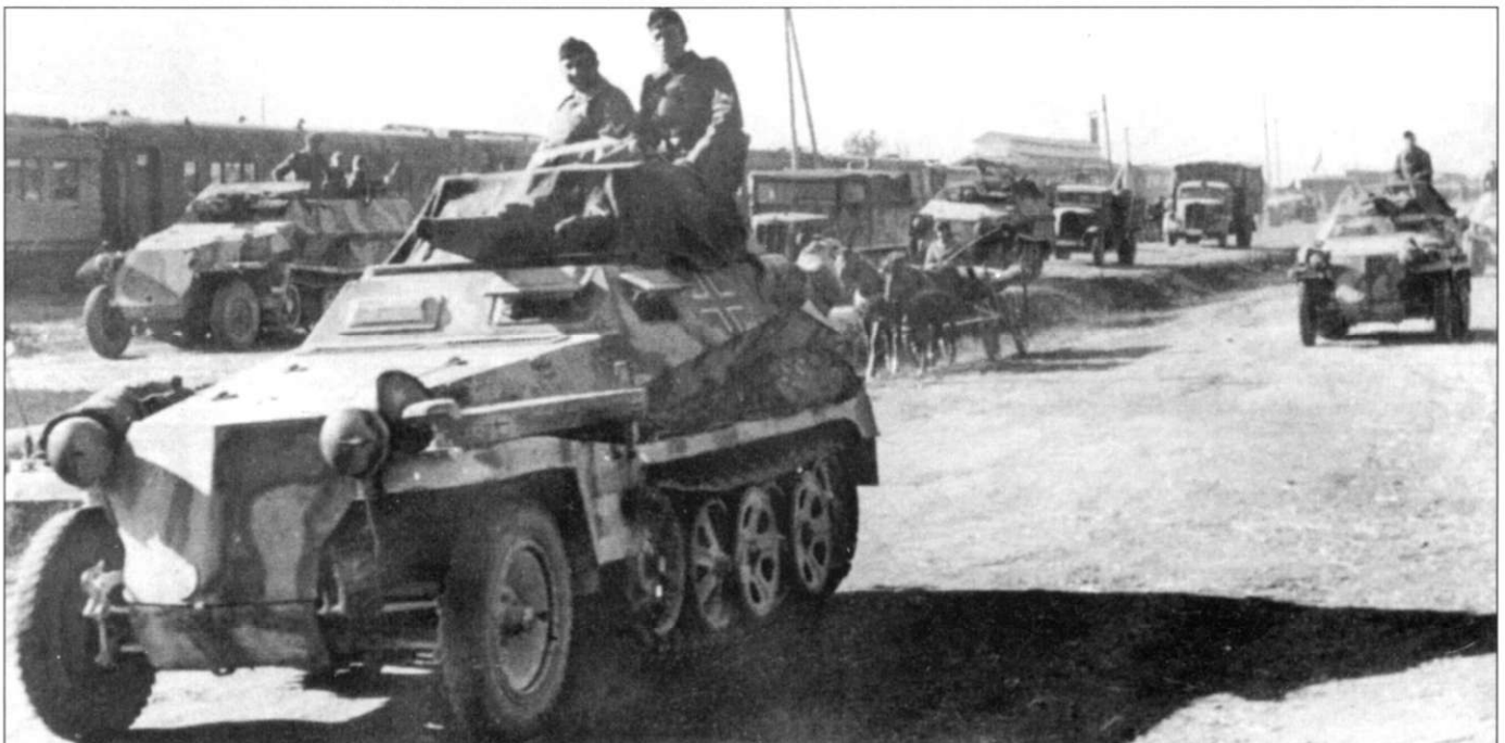
На бронетранспортере Sd.Kfz. 250/9 была установлена башня от броневедомости Sd.Kfz. 222. Официально полугусеничный броневедомость именовался «le.SPW (2 ст)» (Sd.Kfz. 250/9 Ausf. A). Башня закрыта самодельным тентом. Рядом с капотом пристроен длинный ящик, который, вероятно, служит для хранения запасных стволов к 20-мм пушке. Данная машина вооружена башенной установкой из 20-мм автоматической пушки KwK-38 и спаренного с ней 7,92-мм пулемета MG34. На заднем плане - Sd.Kfz. 250/9 Ausf. C.
