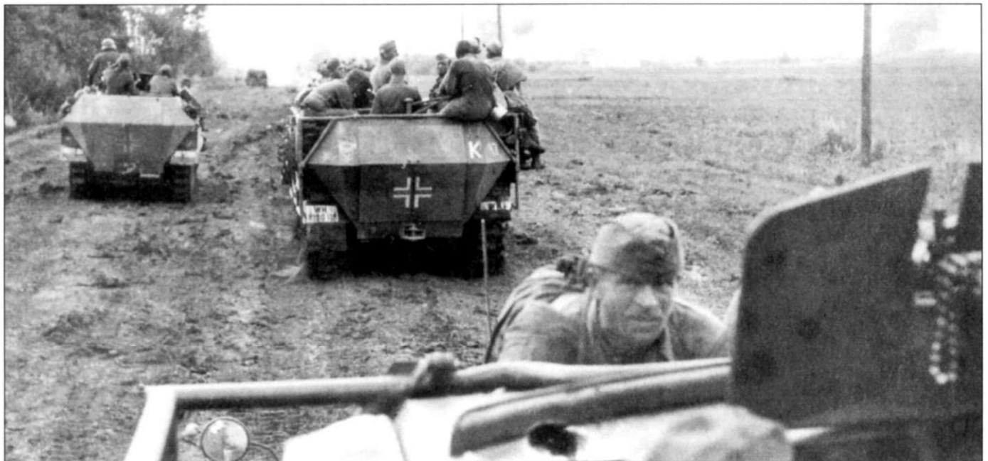
Колонна бронетранспортеров Sd.Kfz. 251 из 1-й танковой группы фон Клейста, Восточный фронт. Две машины снабжены рамами для монтажа пусковых установок 280- или 300-мм неуправляемых ракет класса поверхность - поверхность. На переднем плане - пленный красноармеец. Один бронетранспортер промаркирован буквой «К» - Клейст. В начальный период операции «Барбаросса» в 1-ю Танковую группу Клейста входили 9-я, 11-я, 13-я и 14-я панцердивизии.
