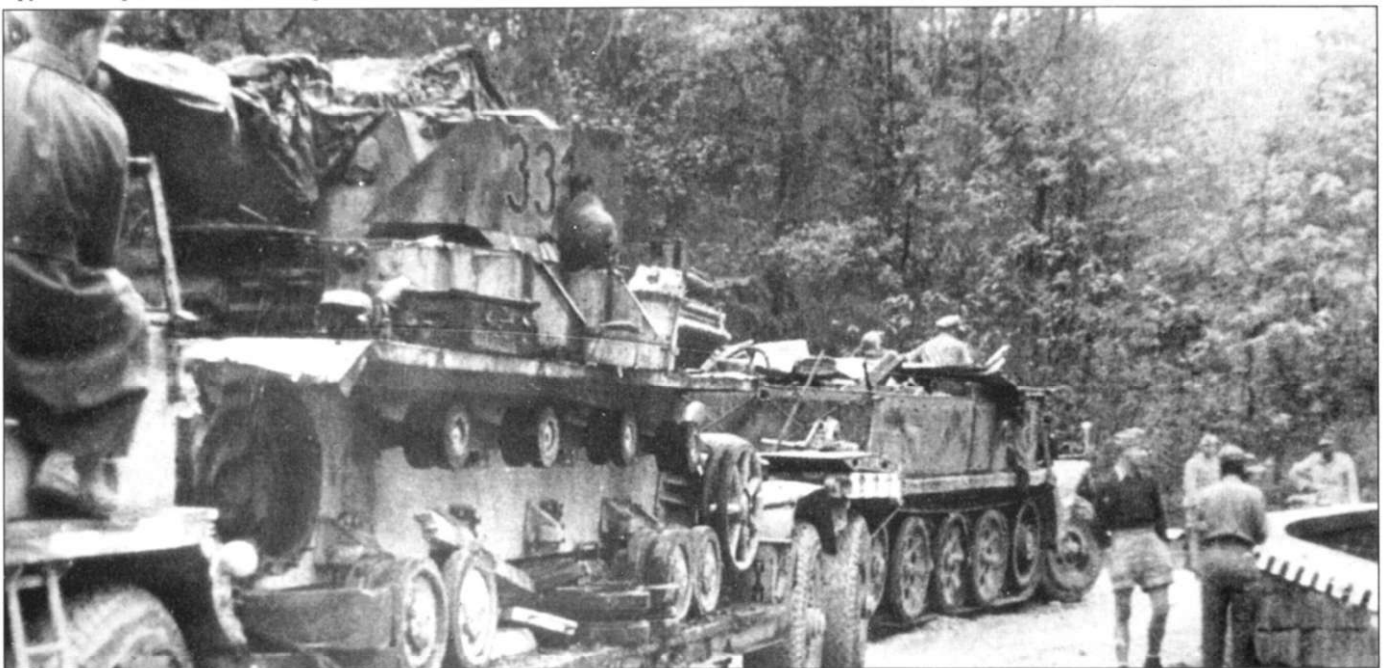
Тягач FAMO буксирует трейлер Sd.Ah. 116 с установленным на нем поврежденным танком Pz.Kpfw. IV (вероятно модификации Ausf. G) из 3-й роты I батальона танкового полка. Интересна униформа одного военного, что на снимке справа: свитер и шорты. Зато водителя трейлера одет в шинель.
