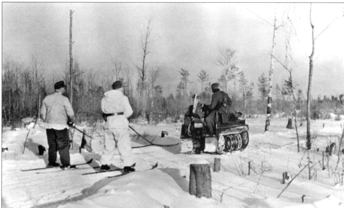
Интересное фото. Kettenkrad используется для буксировки лыжников. Судя по отсутствию вооружения, снимок сделан где-то в тылу на каком-то показе с целью демонстрации возможностей полугусеничного мотоцикла.
