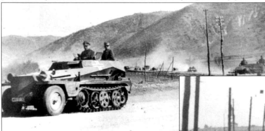
Этот Sd.Kfz. 253 используется в качестве командирской машины батареи штурмовой артиллерии. Машина снабжена фарой Нотек, установленной на крыше. Радиоантенна опущена.
