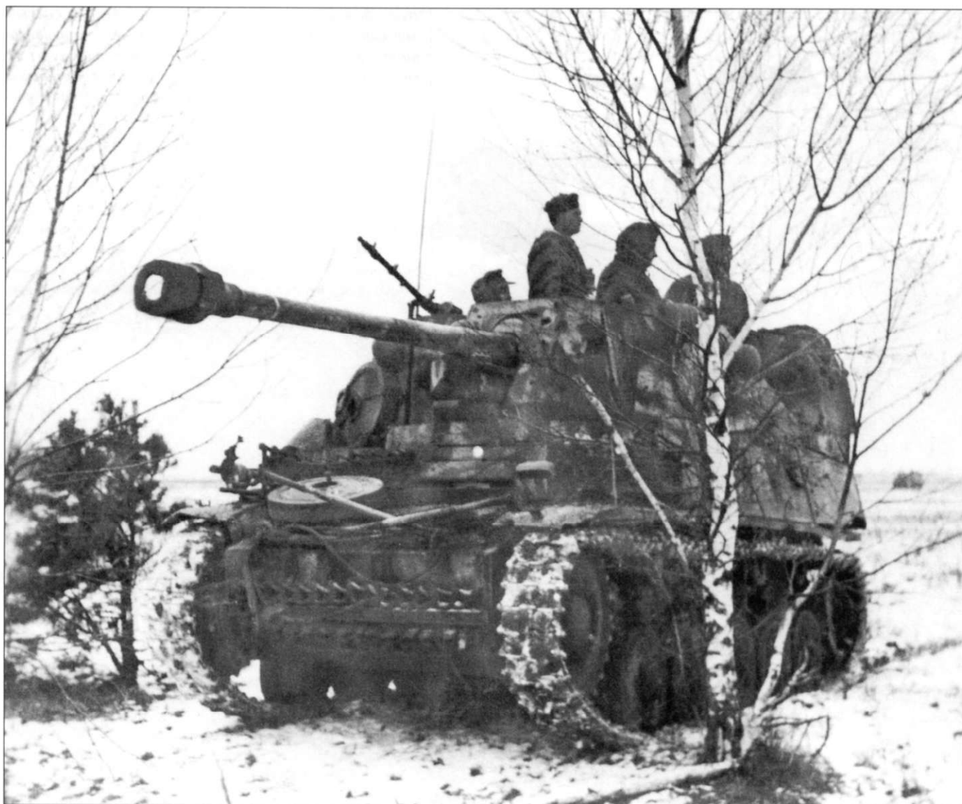
Несколько снимков самоходок Marder II (Sd.Kfz. 131), сделанных зимой. Обычное дело - в лобовой части корпуса закреплены запасные опорный каток и гусеничные траки. На всех машинах пулеметы MG-34 приведены в боевое положение. Фотографии сделаны в самом начале зимы - самоходки еще не успели перекрасить в белый цвет. Истребители танков камуфлированы красно-коричневыми и оливково-зелеными пятнами-полосами по темно-желтому фону. Номера машин - «113», «122», цифры тактических номеров - белые.
