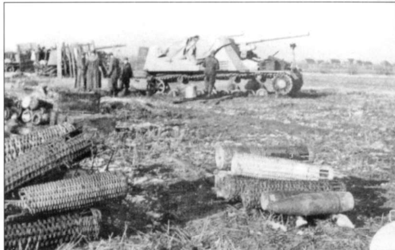
Батарея «Хуммелей» на огневой позиции. Ближайшая к камере самоходка драпирована тканью, искажающей силуэт боевой машины. К борту другой самоходки в этих же целях прислонены бревна и доски. На переднем плане лежат плетеные контейнеры для снарядов (масса снаряда 42,9 кг). Артиллеристы называли такие контейнеры Koffer (чемодан).
