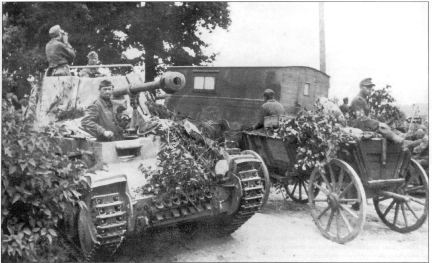
Старое и новое, Латвия, сентябрь 1944 г. Слева - замаскированная ветками самоходка 7,5 см PaK-40/3 Pz.Kpfw. 38 (t) Ausf. H Marder III Sd.Kfz. 138, справа - конная повозка Hf.1 длиной 3,86 м.
