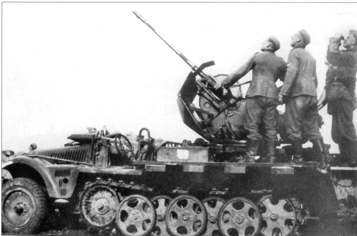
Расчет 20-мм пушки FlaK-38 3CY Sd.Kfz. 10/5 осматривает воздушное пространство в поисках самолетов противника. Бойцы расчета имели счастливую возможность перевозить личное имущество или непосредственно в самоходке, или в трейлере для боеприпасов.
