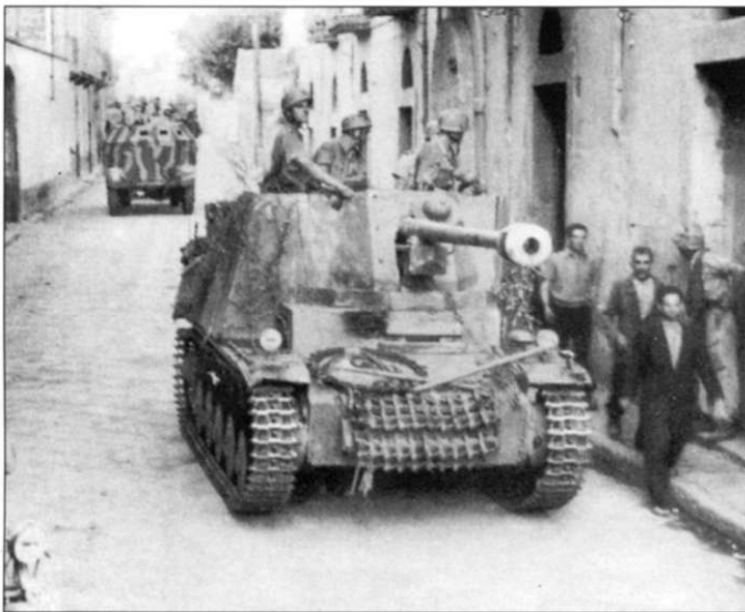
Истребитель танков Marder II (Sd.Kfz. 131) из противотанкового батальона «Герман Геринг» на улице итальянского городка. Машина камуфлирована мелкими пятнами оливково-зеленого цвета по темно-желтому фону. На лобовой стенке рубки подвешен пробковый тропический шлем. На дальнем плане - зенитная самоходная установка 2 см Flakvierling-38 auf schwerer Geländegangiger Lastkraftwagen 4,5 tonne - счетверенная 20-мм зенитная пушка FlaK-38 на шасси грузовика Мерседес-Бенц L4500, у которого бронированы капот и кабина. Зенитная самоходка расписана темно-зелеными полосами по темно-желтому фону.
