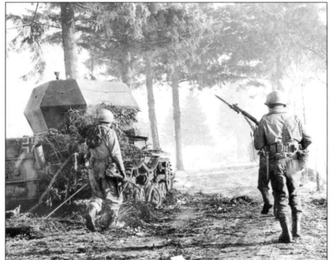
Зенитный танк «Wirbelwind» поздней постройки, подбитый в лесу севернее Бастони в январе 1945 г. Самоходка изготовлена на шасси танка Pz.Kpfw. IV Ausf. J, выхлопные патрубки которого оснащены пламегасителями. Прямым попаданием снаряда сорван один ролик и повреждены два опорных катка зенитного танка.
