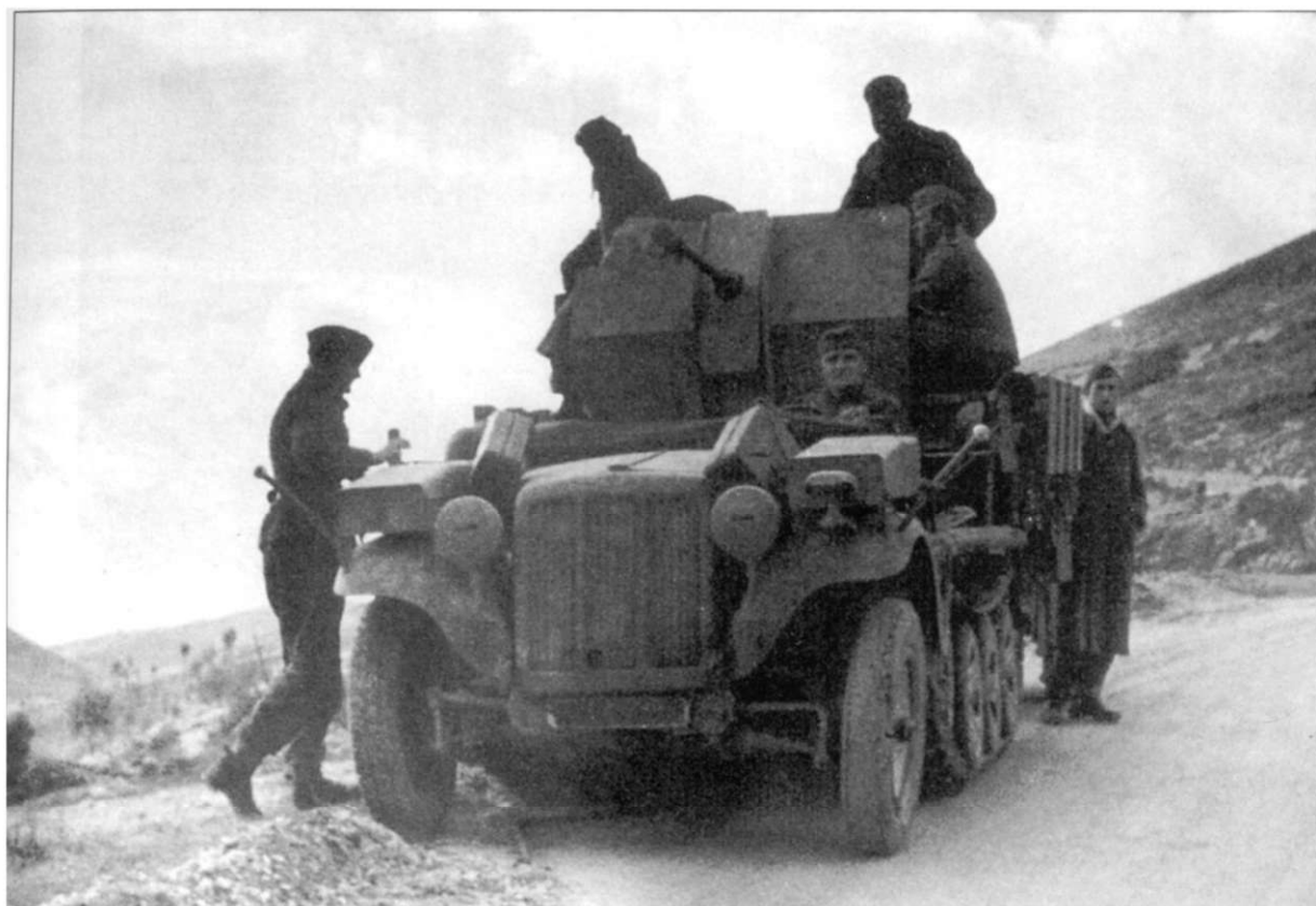
Полугусеничный тягач, вооруженный 20-мм пушкой FlaK-38 остановился на обочине горной дороги. На крыльях закреплено по одной 20-литровой канистре. Фары закрыты светомаскировочными чехлами.
