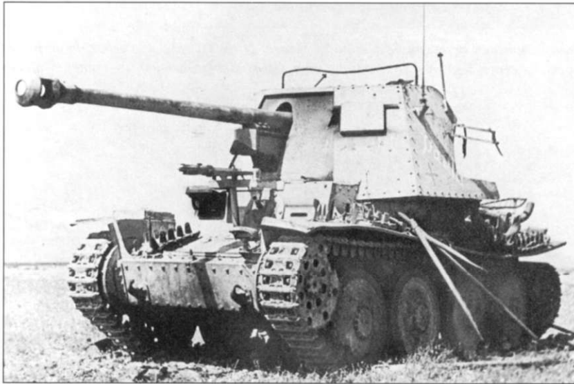
Вид справа истребителя танков 7,5 см PaK-40/3 Pz.Kpfw. 38 (t) Ausf. H Marder III Sd.Kfz. 138. Фиксатор ствола орудия в походном положении откинут. Ниже фиксатора виден ствол курсового пулемета MG-37 (t) (чешский пулемет vz.37) калибра 7,92 мм. Пулемет установлен в лобовой части корпуса по центру. Наличие пулемета MG-34 в боевом отделении на самоходках Marder III Ausf. H Sd.Kfz. 138 не предусматривалось.
