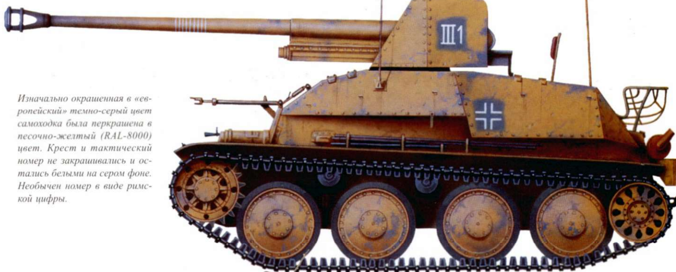
Panzerjäger mit 7.5 cm PaK-40/3 auf Pz.Kpfw. 38 (t) Ausf. H (Sd.Kfz. 138) или «Мардер III», 2-я рота 39-го батальона истребителей танков 21-й панцердивизии, Тунис, март 1943 г.
