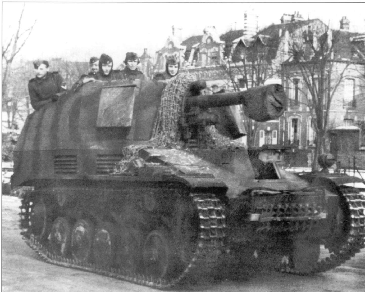
«Веспе» на улице города во Франции. Самоходка камуфлирована полосами темно-зеленого цвета по темно-серому фону. Поверх ствола орудия переброшена маскировочная сеть, ствол орудия закрыт матерчатым чехлом. Жалюзи вентиляции указывают на расположение мотора в центральной части корпуса.
