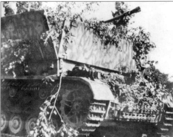
Два снимка ЗСУ «Мобельваген», вооруженной 37-мм пушкой FlaK-43. Самоходки «Мобельваген» строились на шасси танков Pz.Kpfw. IV. Полное название ЗСУ - 3.7 cm FlaK auf Fahrgestell Panzerkampfwagen IV (Sf.) (Sd.Kfz. 161/3). Первые 20 рубок были изготовлены из двойных бронелистов толщиной 12 мм каждый, следующие 25 - из двойных бронелистов толщиной по 10 мм, остальные сделали из одинарных бронелистов толщиной 25 мм. Стенки рубки выполнялись откидными, но работать с пушкой можно было и при поднятых стенках. Самоходка камуфлирована полосами оливково-зеленого и красно-коричневого цвета по темно-желтому фону.
