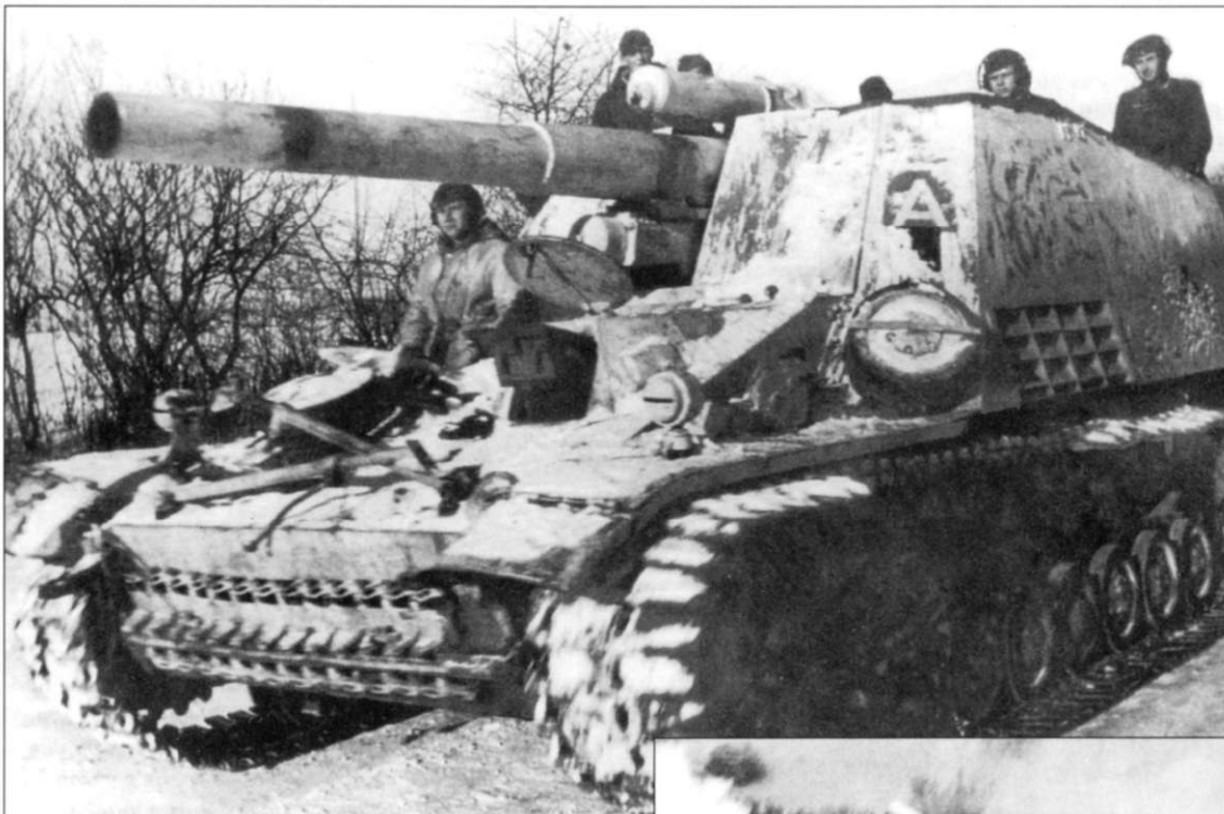
«Хуммель», гаубица «А», Восточный фронт, январь 1944 г. Самоходка перекрашена в белый цвет. Из своего люка высунулся радист. Экипаж «Хуммеля» состоял из шести человек. Машина на марше, но видно самоходка просто меняет огневую позицию - фиксаторы ствола орудия сложены в походном положении. На траки установлены расширители Ostketten.
