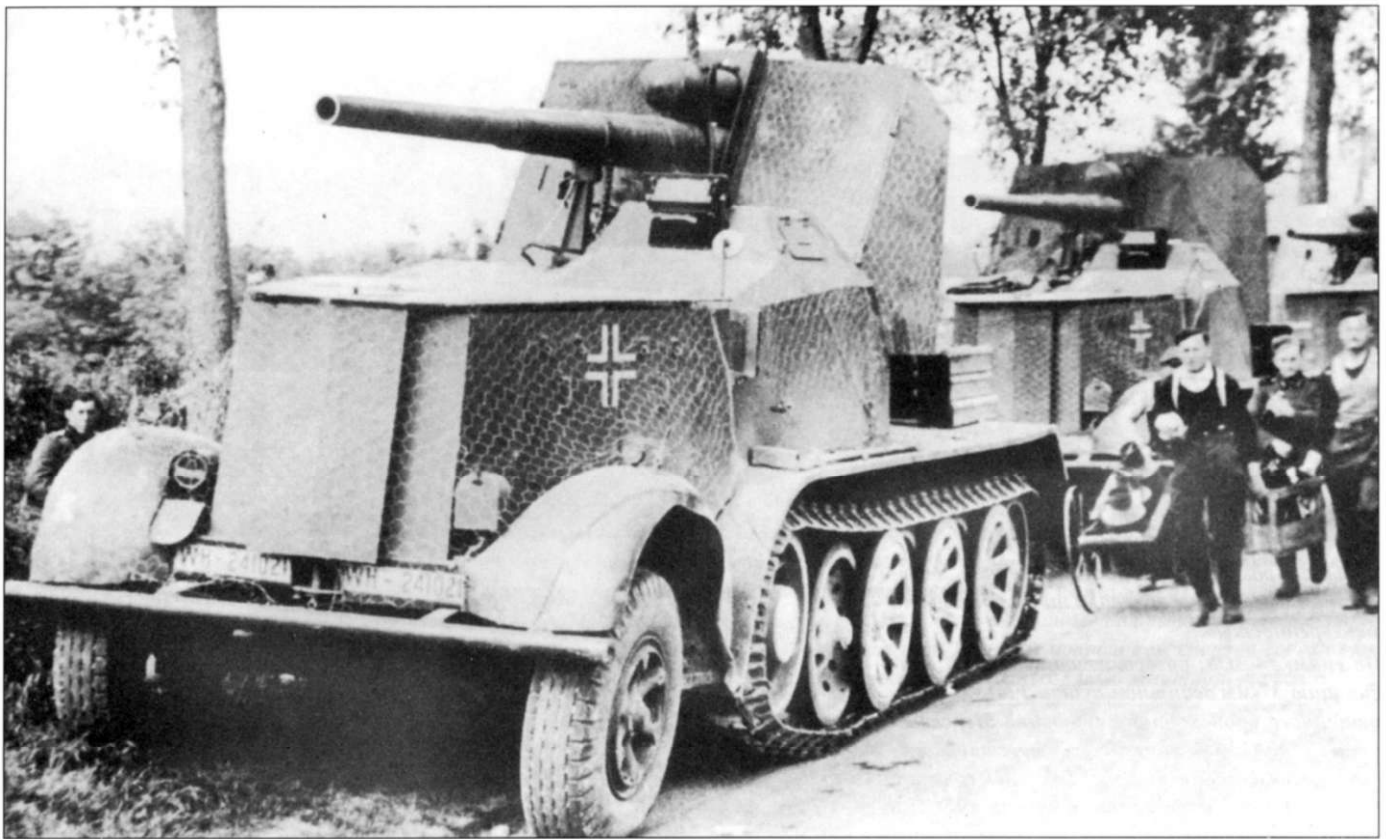
Батарея 3СУ 8.8 cm FlaK-18(Sf.) auf schwerer Zugkraftwagen 12t (Sd.Kfz. 8) из 8-го тяжелого батальона истребителей танков. Окрашенные в серый цвет 12-тонные полугусеничные тягачи снабжены проволочными сетками, к которым при необходимости крепится маскировка. В передней части головной самоходки закреплено два номерных знака, что для начального периода войны выглядит нормальным. Обратите внимание на светомаскировочные колпаки фар - колпаки раннего типа, откидные. На крыле над гусеницей размещен ящик с дополнительными снарядами к пушке. На левом переднем крыле нарисована белой краской буква «К» - танковая группа фон Клейста. Экипаж покинул самоходку по нужде.
