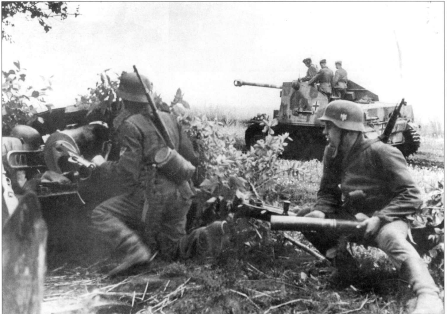
Истребитель танков Marder II (Sd.Kfz. 131) следует мимо огневой позиции трофейной французской 75-мм полевой пушки образца 1897 г. Французское орудие установлено на лафете германского противотанкового орудия PaK-38 калибра 50 мм. В боекомплект орудия входили бронебойные снаряды польского и французского образца, а также германские кумулятивные снаряды. В крайнем случае такие орудия использовались для борьбы с советскими танками. Самоходка Marder II камуфлирована крупными пятнами темно-зеленого цвета по темно-желтому фону. Снимок отлично демонстрирует уязвимость расчета самоходного орудия от обстрела сзади сбоку.
