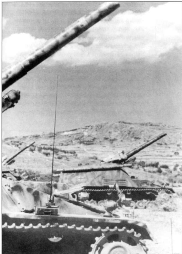
Самоходки «Хуммель» талантливо камуфлированы из краскопульты пятнами и полосами оливково-зеленого цвета по темно-желтому фону. На снимке хорошо виден антенный вивод и сама штыревая радиоантенна. Самоходки «Хуммель» оснащались радиостанциями Fu.Spr.Ger.f.; такие же радиостанции стояли на САУ «Веспе».
