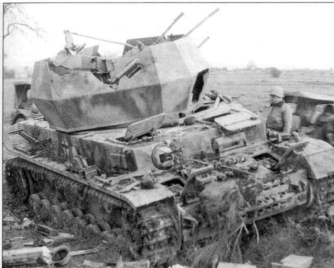
ЗСУ Flakpanzer IV «Wirbelwind» была уничтожена прямым попаданием 5-дюймовой неуправляемой авиационной ракеты, выпущенной с истребителя-бомбардировщика союзников. Корпус танка покрыт циммеритом.
