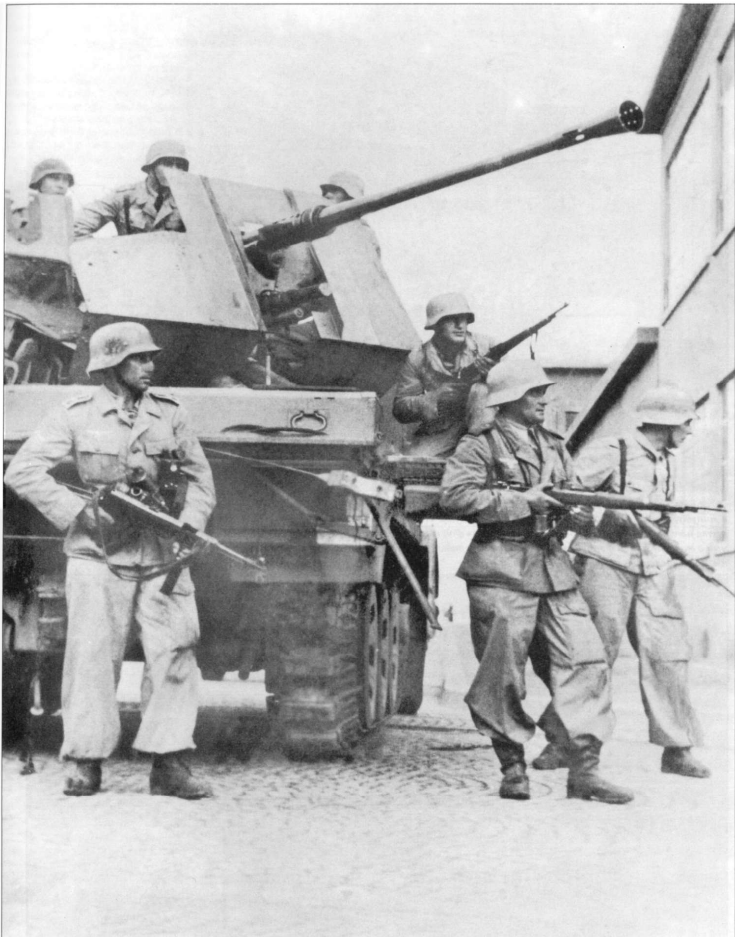
Солдаты люфтваффе из танковой дивизии «Герман Геринг» спешили со своей ЗСУ Sd.Kfz. 7/2. На самом деле воины просто позировали фотографу, Италия, 1944 г. 8-тонный полугусеничный тягач Sd.Kfz. 7 был предназначен для буксировки артиллерии. В варианте ЗСУ у тягача бронировались капот мотора и кабина. Вооружение состояло из 370-мм пушки FlaK-36. Всего в 1943 - 1945 гг. было изготовлено 123 таких самоходки. Небольшой отдельный бронециток слева от казенной части пушки предназначен для защиты наводчика. Фельдфебель вооружен пистолетом-пулеметом MP-40.
