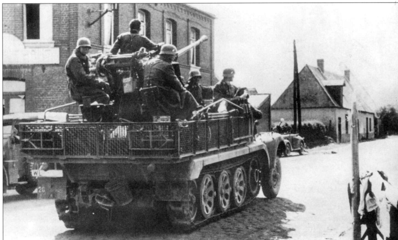
ЗСУ Sd.Kfz. 7/2 одного из подразделений люфтваффе на улице французского населенного пункта. Бронирование капота отсутствует, нет и бронекابины.
