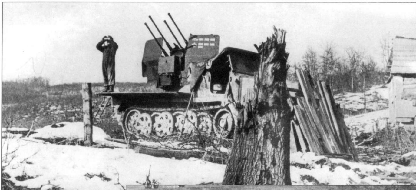
ЗСУ Sd.Kfz. 7/1 на огневой позиции, Восточный фронт. Двигатель прикрыт досками - какая-никакая дополнительная защита от пуль и осколков. На орудийном щите нанесены символические изображения уничтоженных этой установкой целей - 15 танков и 20 самолетов и по мелочи - грузовики, пулеметы, пушки без счета. Командир одет в комбинезон.
