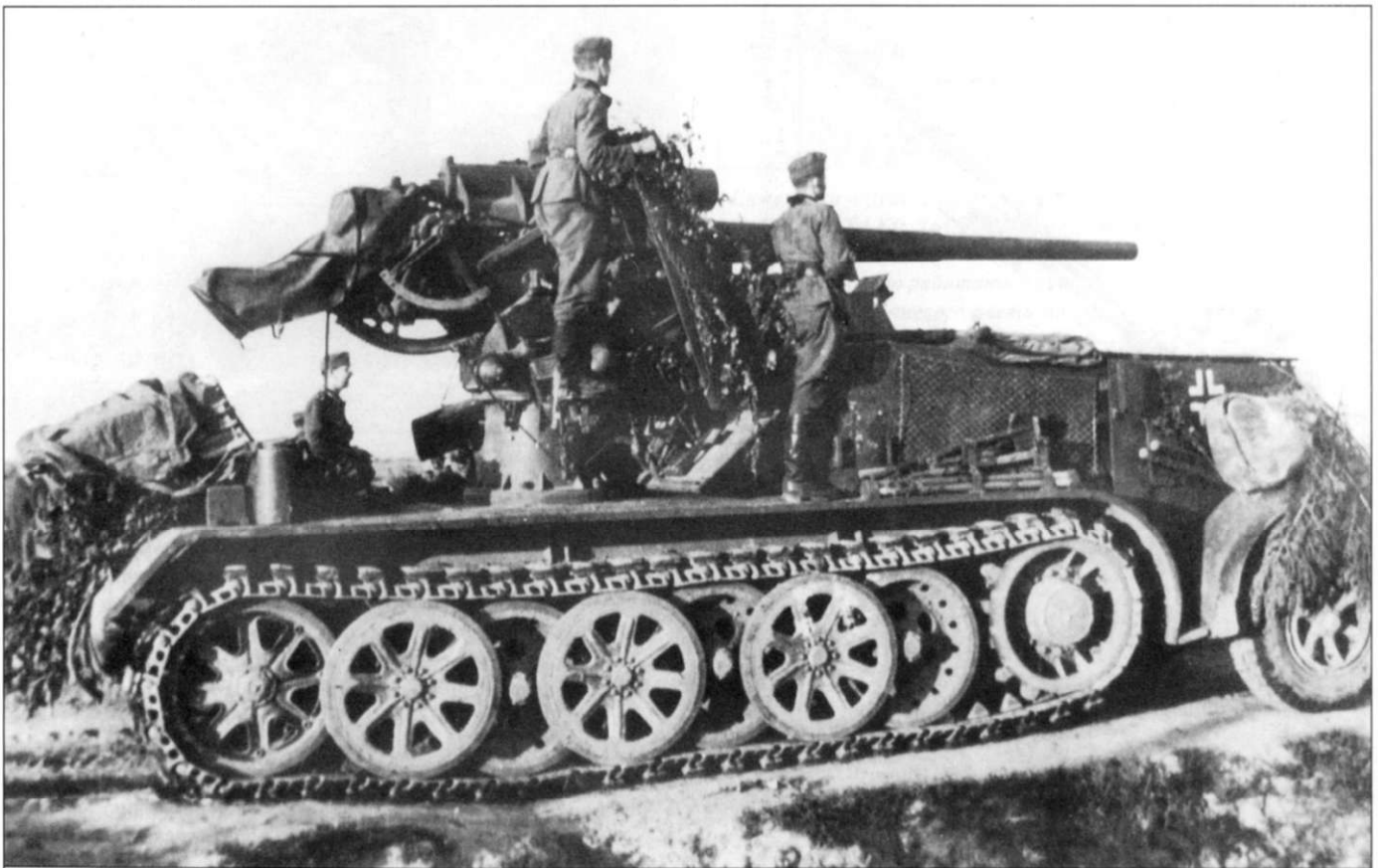
В 1939 г. пушки 8.8 cm FlaK-18 (Sf.) установили на десять 12-тонных полугусеничных тягачей Sd.Kfz. 8 в надежде придать тяжелым пушкам повышенную подвижность. Орудия предназначались как для поражения воздушных целей, так и для стрельбы по танкам. Кабины и двигатели тягачей прикрыты 14-мм броней. По бортам машины были смонтированы по два домкрата, призванные обеспечить стабильность тягача при стрельбе из мощной пушки. У машины, что на снимке, домкраты сняты и уложены на крыле.
