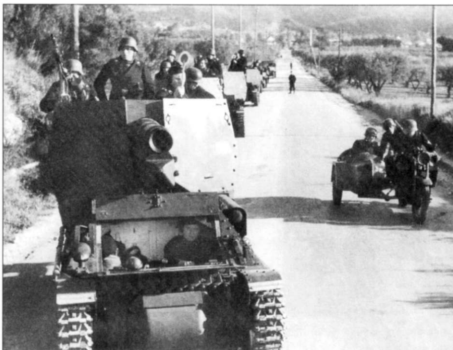
Крыша отделения управления самоходки Sd.Kfz. 135/1 была сделана полностью раскладной. На бронешите рубки установлен предназначенный для самообороны от самолетов пулемет MG-34. При виде спереди самоходку Sd.Kfz. 135/1 несложно спутать с САУ «Бизон» Sd.Kfz. 101.
