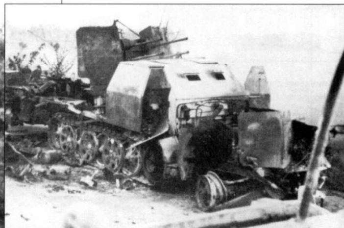
Уничтоженная 3CU Sd.Kfz. 7/1 с бронированными кабиной и капотом двигателя. Снимок сделан в долине реки По, Италия, апрель 1945 г. Скорее всего сначала машину подбила авиация, а потом сдвинул боекомплект к счетверенной зенитной пушке.
