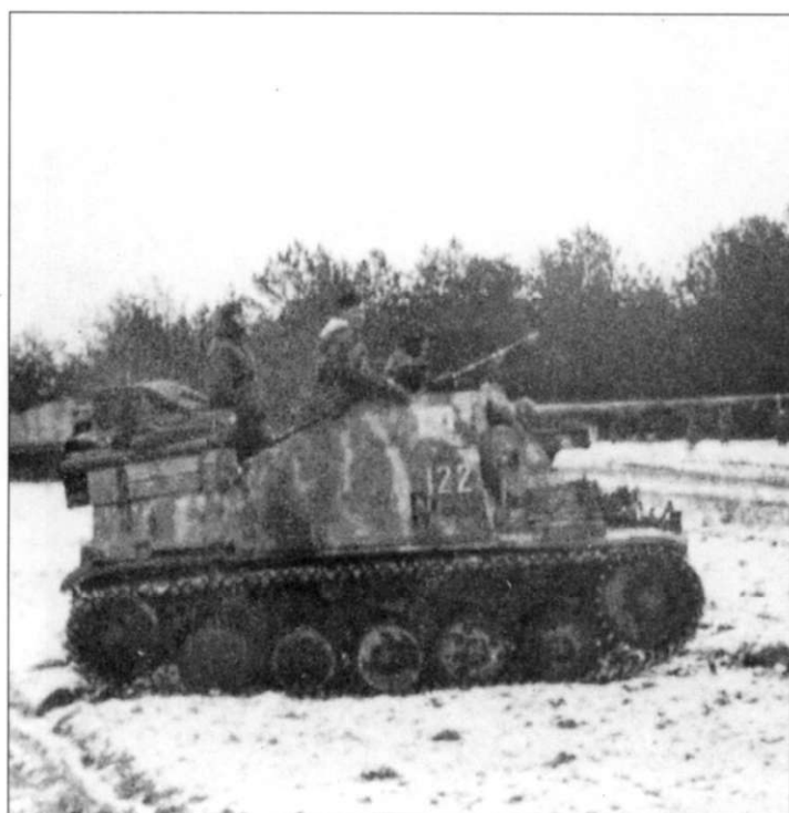
Несколько снимков самоходок Marder II (Sd.Kfz. 131), сделанных зимой. Обычное дело - в лобовой части корпуса закреплены запасные опорный каток и гусеничные траки. На всех машинах пулеметы MG-34 приведены в боевое положение. Фотографии сделаны в самом начале зимы - самоходки еще не успели перекрасить в белый цвет. Истребители танков камуфлированы красно-коричневыми и оливково-зелеными пятнами-полосами по темно-желтому фону. Номера машин - «113», «122», цифры тактических номеров - белые.
