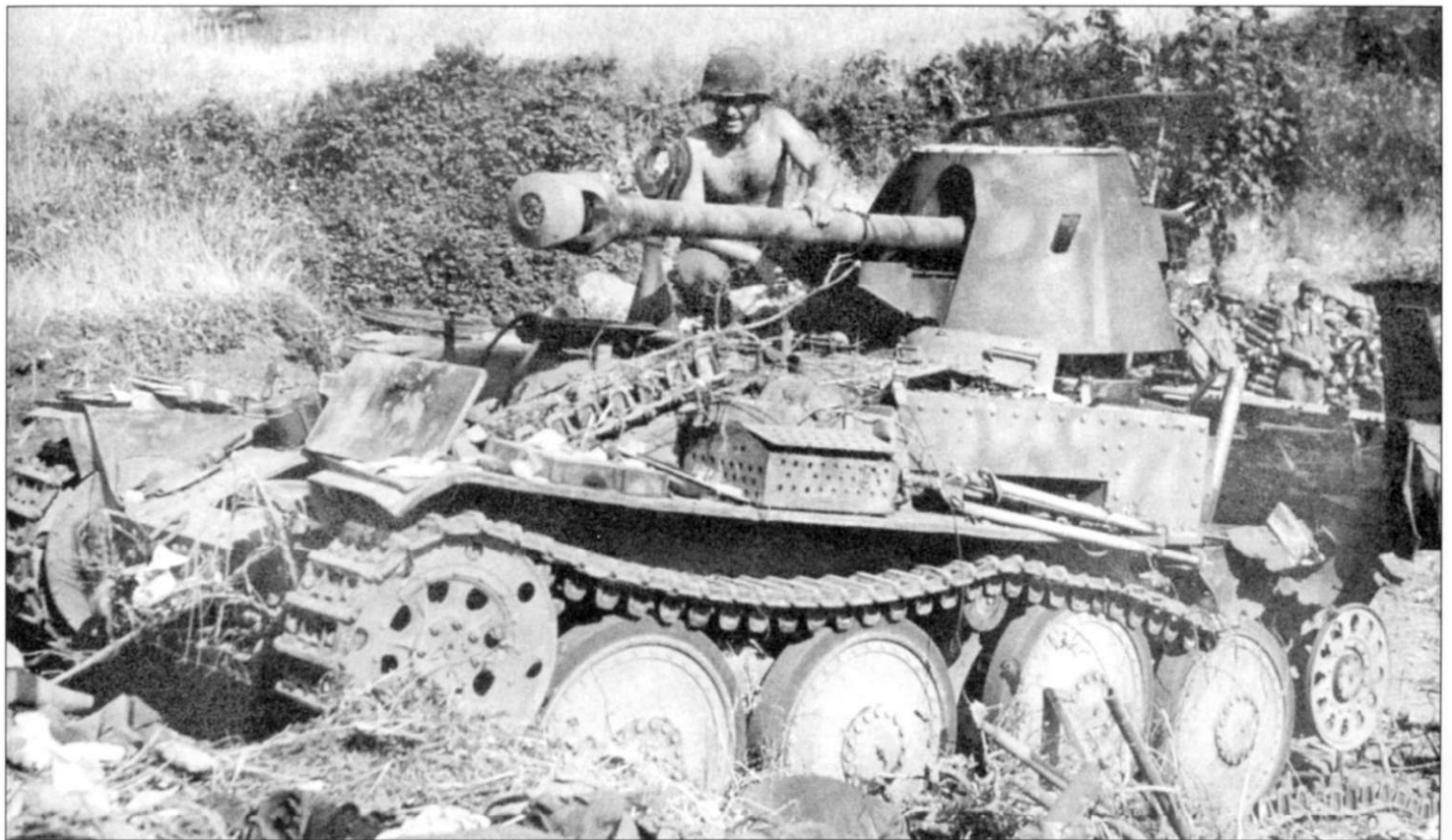
Американец осматривает истребитель танков Marder III Ausf. M, Италия. На самоходке случилась детонация боекомплекта, из-за чего боевое отделение полностью разрушилось. Зато на снимке отлично виден оружейный щит, который на фотографиях исправных машин обычно частично закрывает рубка.
