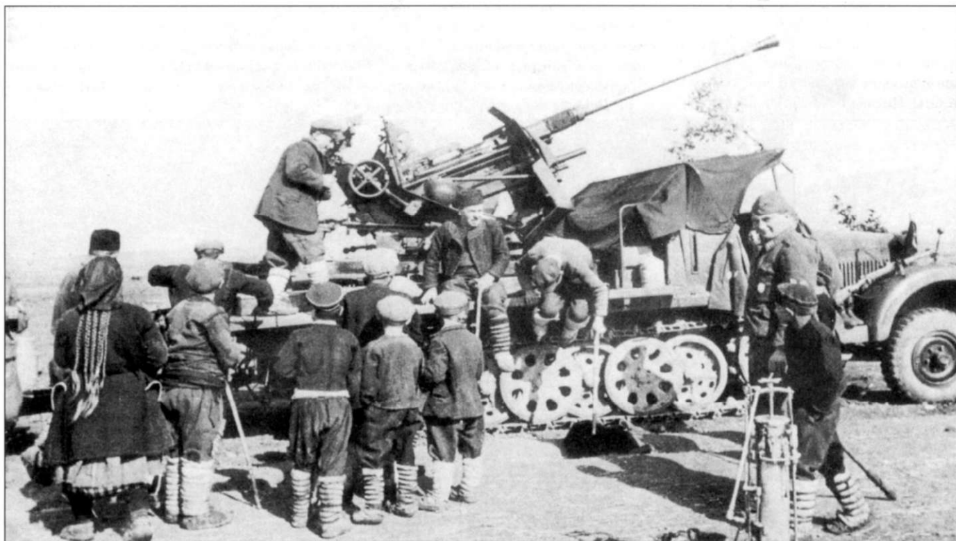
Болгарские детишки нашли себе интересную игрушку - действующую модель в масштабе 1:1 ЗСУ Sd.Kfz. 6/2. Расчет самоходки детям не мешает. Самоходка вооружена 37-мм автоматической пушкой. Обычно такие самоходки прикрывали батареи 88-мм зенитных орудий.
