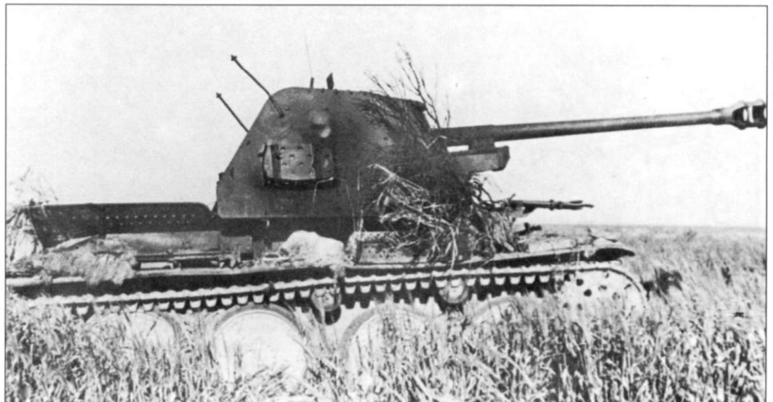
Истребитель танков 7,5 см PaK-40/3 Pz.Kpfw. 38 (t) Ausf. H - вариант самоходки Marder III Sd.Kfz. 138 на шасси чешского танка Pz.Kpfw. 38 (t). Существовали серьезные отличия между самоходками модификаций Ausf. H и Ausf. M. Рубки самоходок обоих вариантов выполнялись открытыми сверху, но рубка истребителя танков варианта Ausf. H открытой была еще и с кормы. Возимый боекомплект истребителя танков Marder III Ausf. H составлял 38 снарядов. Сектор обстрела орудия в горизонтальной плоскости - +/- 30 градусов. Бронирование стенок рубки - 8-50 мм. С конца 1942 г. по середину 1943 г. было построено 418 истребителей танков Marder III Ausf. H. Первые такие машины поступили на вооружение противотанковых батальонов в мае 1943 г. Данную самоходку экипаж назвал «Paula», имя написано белой краской на стенке рубки. Истребитель танков выведен из строя прямым попаданием снаряда.
