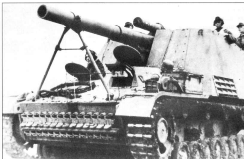
САУ «Хуммель». В передней части корпуса смонтирована сварная решетка, вертикальные штыри которой помогают механику-водителю выдерживать направление движения. Место радиста - в правой части отделения управления. В составе панцердивизии имелась всего одна батарея тяжелых САУ «Хуммель». - шесть орудий. Танкисты всегда считали, что одна батарея самоходных «Хуммелей» лучше, чем две батареи буксируемых 150-мм гаубиц.
