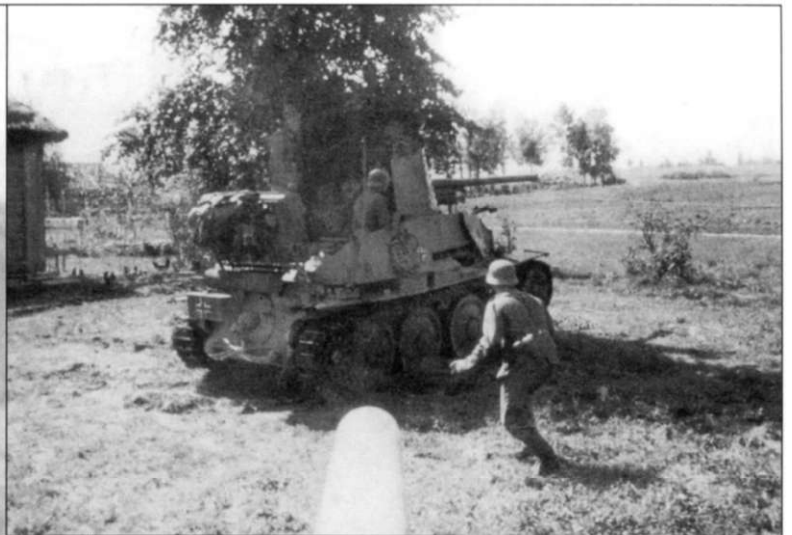
Еще один подвид истребителя танков «Мардер» - Sd.Kfz. 139, Panzerjager 38 (t) für 7.62 cm PaK-36 (r). Компоновка данного варианта схожа с компоновкой истребителя танков «Мардер II» Sd.Kfz. 132. Снимок сделан на Восточном фронте в августе 1942 г. В кормовой части корпуса закреплен багажный ящик. Самоходками Sd.Kfz. 139 вооружались батальоны истребителей танков, как отдельные, так и в составе панцердивизий.
