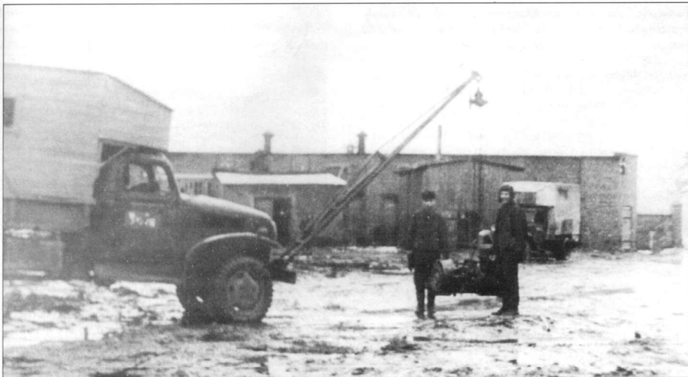
Канадская полевая передвижная мастерская на базе грузового автомобиля «Шевроле G7101», Восточная Пруссия, весна 1945 года.
