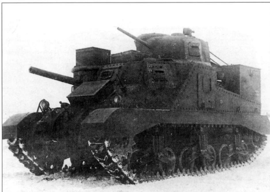
БРЭМ М31 (Т2) оснащена лебедкой и стрелой подъемного крана.
