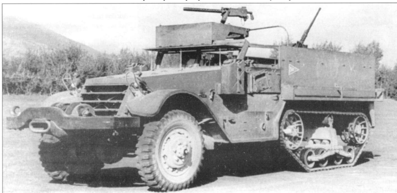
Бронетранспортер М2А1, видны пулеметы «Браунинг» калибра 12,7 и 7,62 мм.
