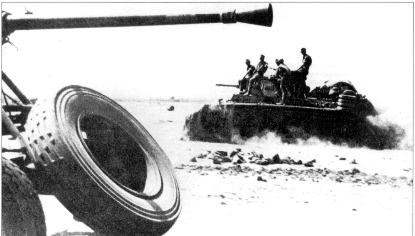
Еще один танк Pz-Kpfw. II Ausf. A-C, на этот раз без накладной брони на маске пушки. Ствол 20-мм пушки KwK-30 закрыт чехлом для предупреждения попадания песка в ствол.
