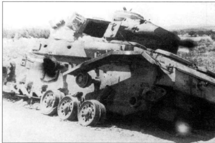
Танк Pz.Kpfw. III Ausf. N, вероятно из 501-го тяжелого танкового батальона. Танк подбит в Тунисе в 1943 г. В борту корпуса хорошо видны сквозные пробоины от снарядов. Вместе с батальоном «Тигров» в Северную Африку прибыло 25 танков Pz.Kpfw. III Ausf. N.
