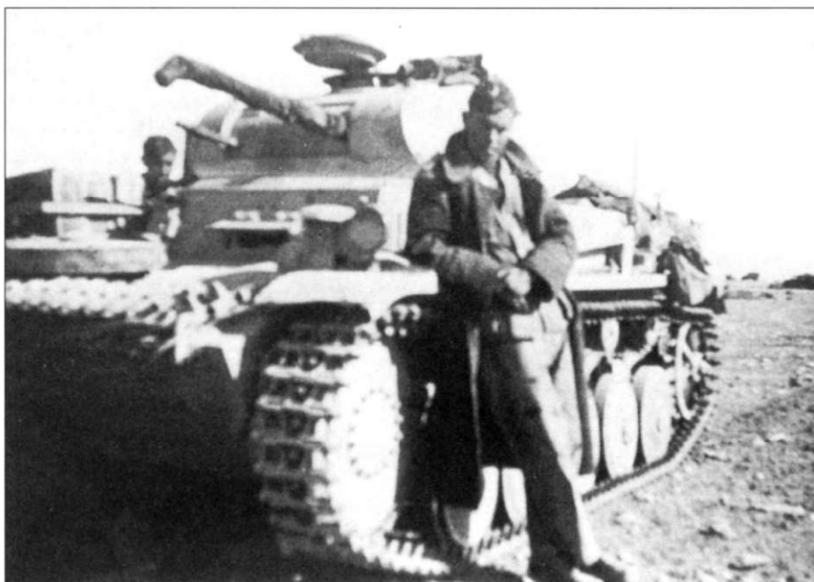
Еще один танк Pz-Kpfw. II Ausf. A-C, на этот раз без накладной брони на маске пушки. Ствол 20-мм пушки KwK-30 закрыт чехлом для предупреждения попадания песка в ствол.
