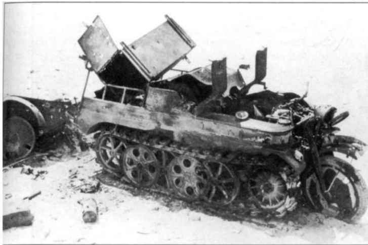
Еще один полугусеничный мотоцикл NSU HK-100 Kettenkrad Kfz.2, уничтоженный огнем стрелкового оружия. Пули подожгли топливо в бензобаке. Мотоцикл сгорел. Сзади - стандартный прицеп мотоцикла, разработанный специально для «Кеттенкрафтрада». На борту заметна тактическая маркировка - прямоугольник с косым крестом внутри.
