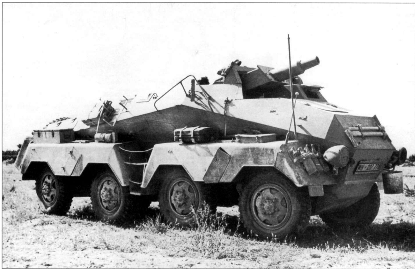
Тяжелый броневедомитель schwere Panzerspahwagen (7.5cm) Sd.Kfz. 233, захваченный союзниками в Тунисе. Броневик перекрашен в песочно-желтый цвет, изначальная окраска - серая. В передней части машины закреплен номерной знак «WH-237 778». Цифры номера черные, фон - белый.
