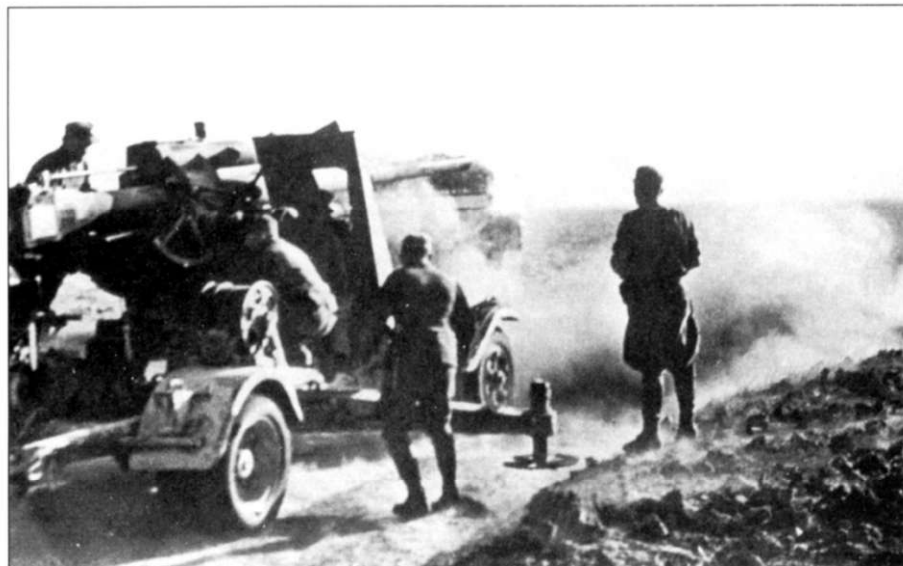
Ствол пушки 8.8 см Flak в крайней точке отката после выстрела. В крайнем случае из орудия разрешалось вести огонь прямо с транспортной платформы, как на снимке, но точность стрельбы в этом случае сильно падала, да и опасность для расчета возрастала. Орудия «восемь-восемь» показали себя в Северной Африке, как и на других театрах военных действий, великолепным средством борьбы с танками.
