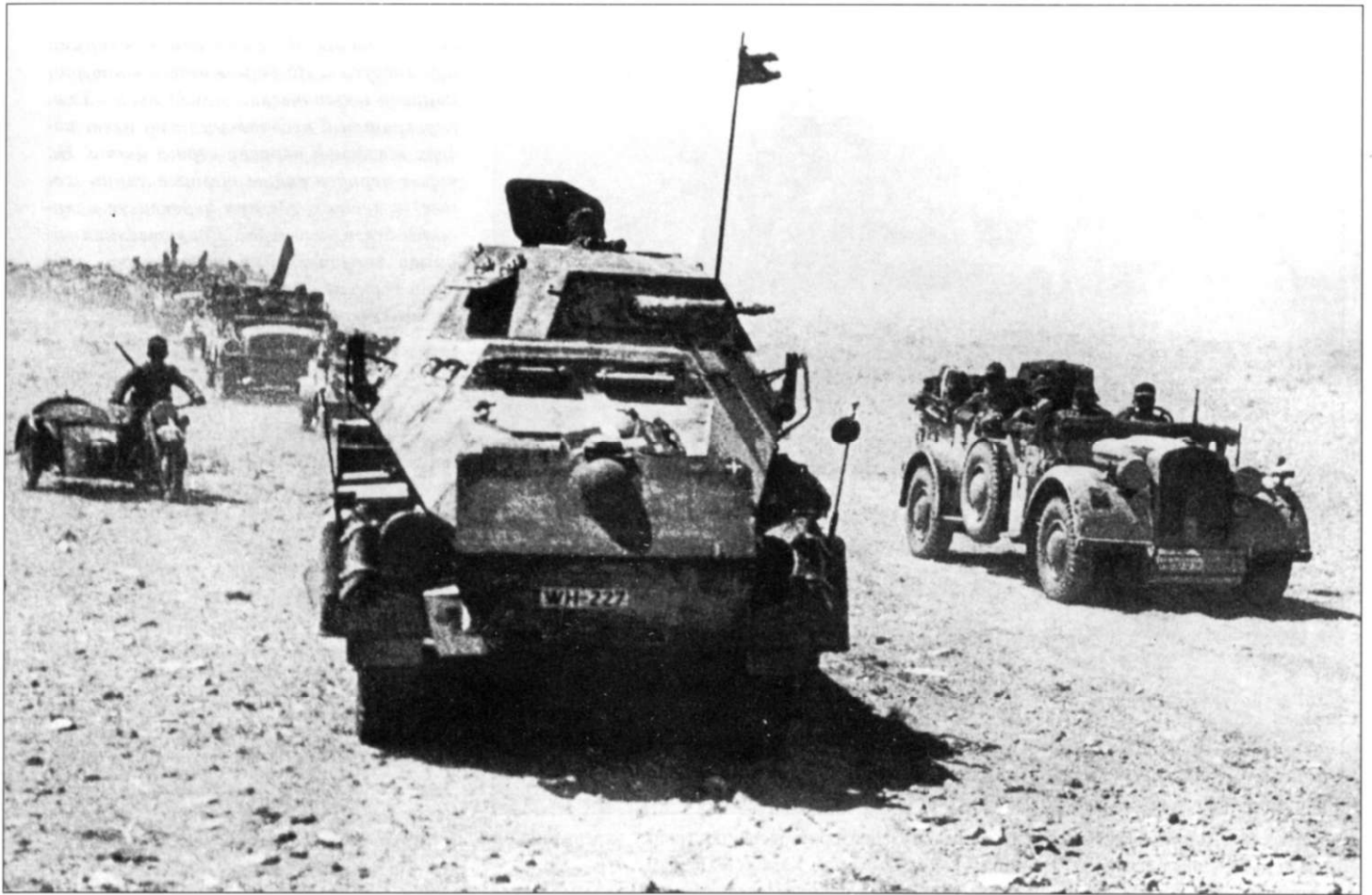
Колонна техники во главе с бронев автомобилем schwere Panzerspahwagen Sd.Kfz. 231 с дополнительной накладной броней толщиной 8 мм, такая броня стала монтироваться в лобовой части броневиков в начале 1940 г. Правее бронев автомобиля - автомобиль Хорх Kfz. 15, на крыле которого нанесена эмблема корпуса «Африка» - пальма со свастикой. Эмблема нанесена на фоне неперекрашенного квадрата серого цвета.
