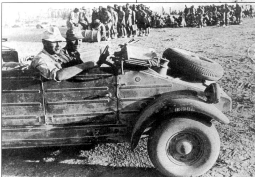
Британские военнопленные наполняют водой флаги из бочки, июнь 1942 г. На переднем плане - кюбельваген, оснащенный колесами с крупными пустынными шинами. Желтая краска с автомобиля сильно пообтерлась. На крыле видна надпись - 690-200-0.6ати, размер шины в мм и давление в пневматиках колес в атмосферах.
