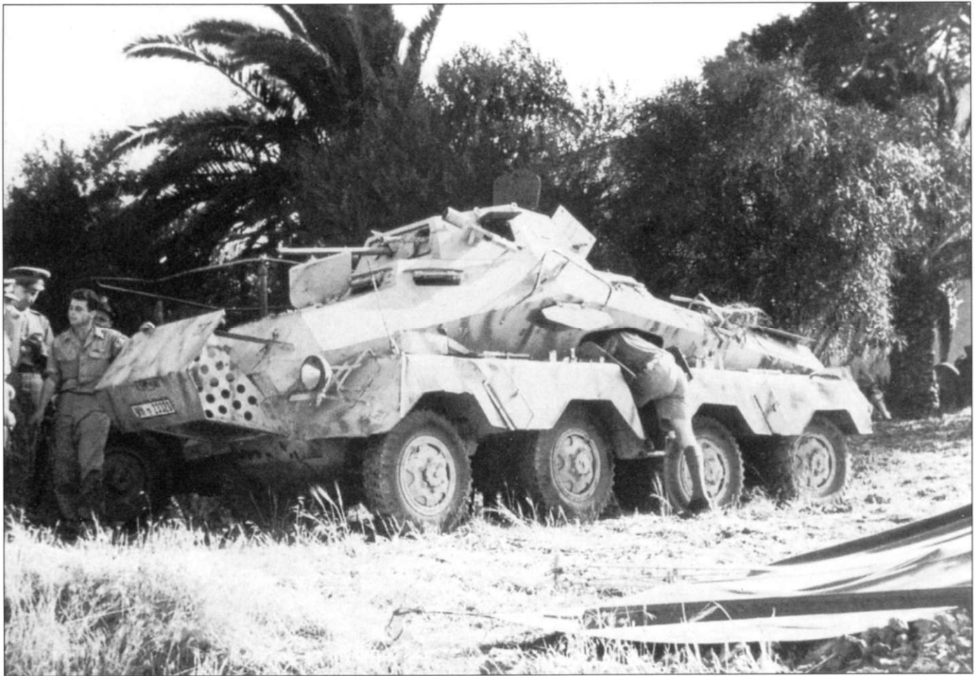
Трофейный тяжелый броневедомитель schwere Panzerspahwagen (7.5cm) Sd.Jfz. 233 осматривают британские военные корреспонденты. На борту башни закреплён дымовой гранатомет. Машина камуфлирована желтыми пятнами по серому фону. В верхнем правом углу накладной брони написан бортовой номер - цифра «8».
