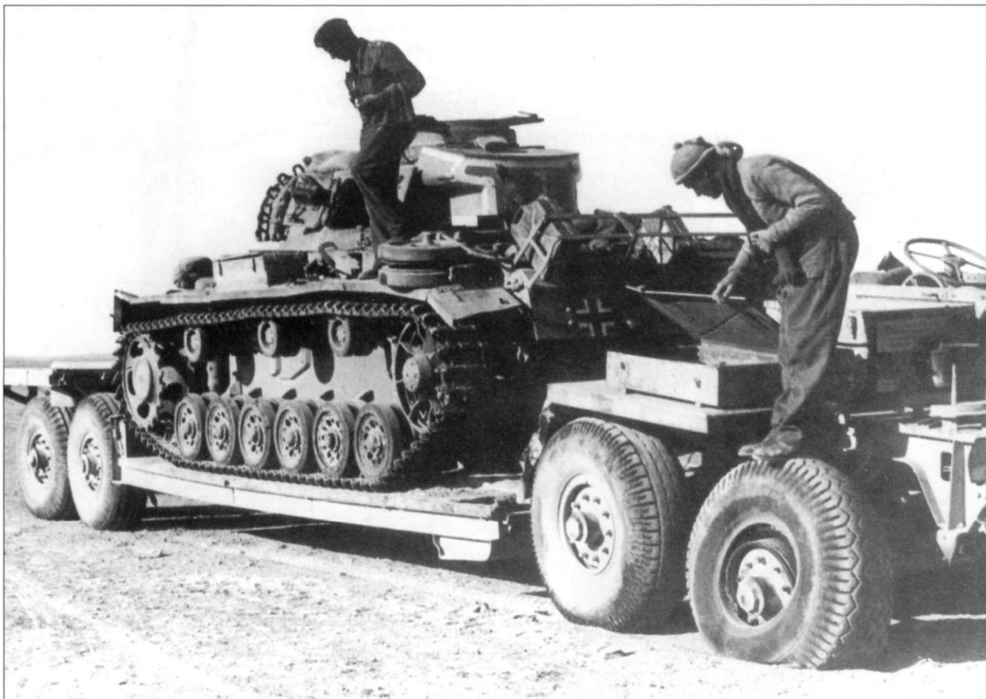
Танк Pz.Kpfw. III Ausf. J погружен на танковый транспортер Sd.Kfz. 116. Танк и танковый транспортер англичане захватили под Сиди-Барани. Тактический номер «1» белого цвета указывает на штабную машину 1-го батальона. Забашенный контейнер по кромкам обведен линиями белого цвета, вероятно для лучшей идентификации командирской машины на больших дистанциях.
