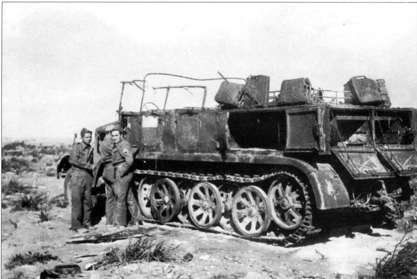
Три американских солдата осматривают брошенный 12-тонный тягач Sd.Kfz. 8. Машина сильно пострадала от пожара. Обгорела краска, сгорели резиновые бандажки опорных катков.
