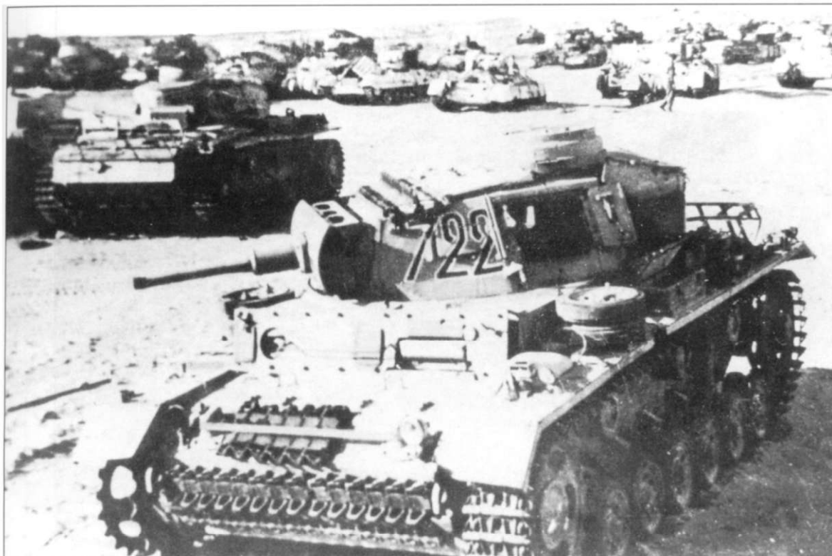
Танк Pz.Kpfw. III Ausf. J, вооруженный пушкой 5 см KwK L/42 - трофеем англичан под Эль-Аламейном. Машина оснащена накладной броней толщиной 20 мм, обычной для танков модели Ausf. L. Тактический номер «722» указывает на принадлежность танка 7-й роте 5-го панцерполка. Контраст между цветом цифр и окраской танка очень значительный - вероятно цифры написаны краской черного цвета.
