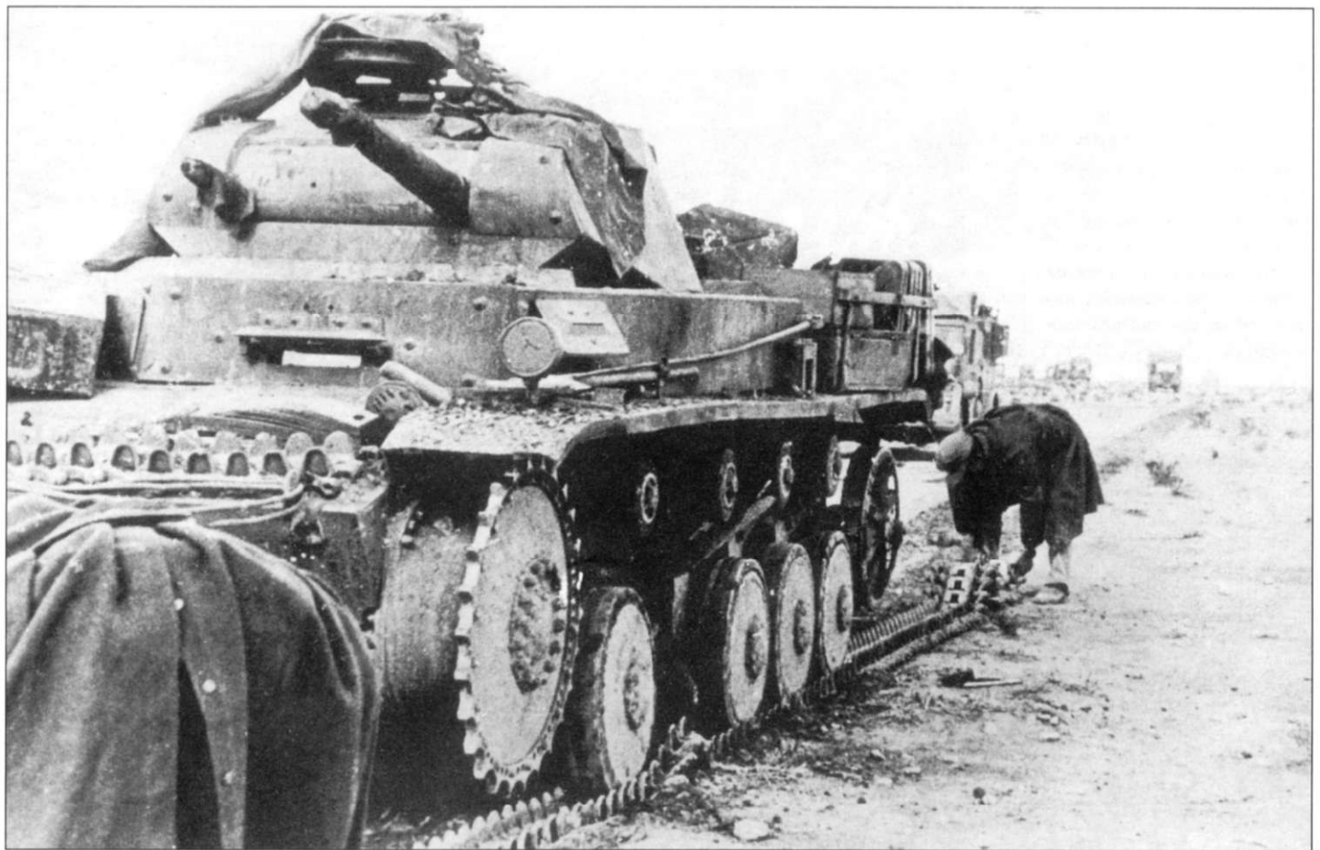
Танк Pz.Kpfw. II Ausf. A-C подорвался на mine, повредив гусеницу и ходовую часть. Танк оснащен командирской башенкой позднего типа, но не имеет накладной 15-мм брони на маске пушки. Желтая краска сильно слезла от песка и ветра.
