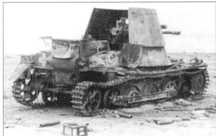
Два снимка самоходки 4,7 см PaK (t) auf. Pz.Kpfw. I Ausf. B, подбитой англичанами в Северной Африке. 27 семь таких самоходно-артиллерийских установок прибыло в Триполи в марте 1941 г. в составе 605-го батальона истребителей танков. Часть машин прошла всю африканскую кампанию вермахта вплоть до капитуляции в мае 1943 г. Самоходки были вооружены чешскими пушками Шкода 47 мм KPV.vz.38 Model A5, самыми мощными противотанковыми орудиями германской армии по состоянию на 1940 г. Все самоходки, отправленные в Африку были перекрашены в пустынно-желтый цвет поверх заводской серой окраски.
