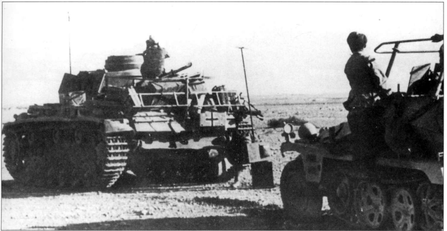
Командир танка Pz.Bef.Wg III Ausf. H осматривает местность в бинокль. На переднем плане - полугусеничный бронетранспортер Sd.Kfz. 250/5, личная машина Роммеля на раннем этапе кампании. Машина названа «GREIF», имя написано на левой стороне бронетранспортера контурно красной краской, на правой - белой краской, тоже контуром. За танком виден радист за работой с полевой радиостанцией. Башня командирского танка Pz.Bef.Wg III зафиксирована неподвижно, благодаря чему крышу моторного отделения можно без опасения использовать как багажник. Снимок сделан 16 июля 1942 г.
