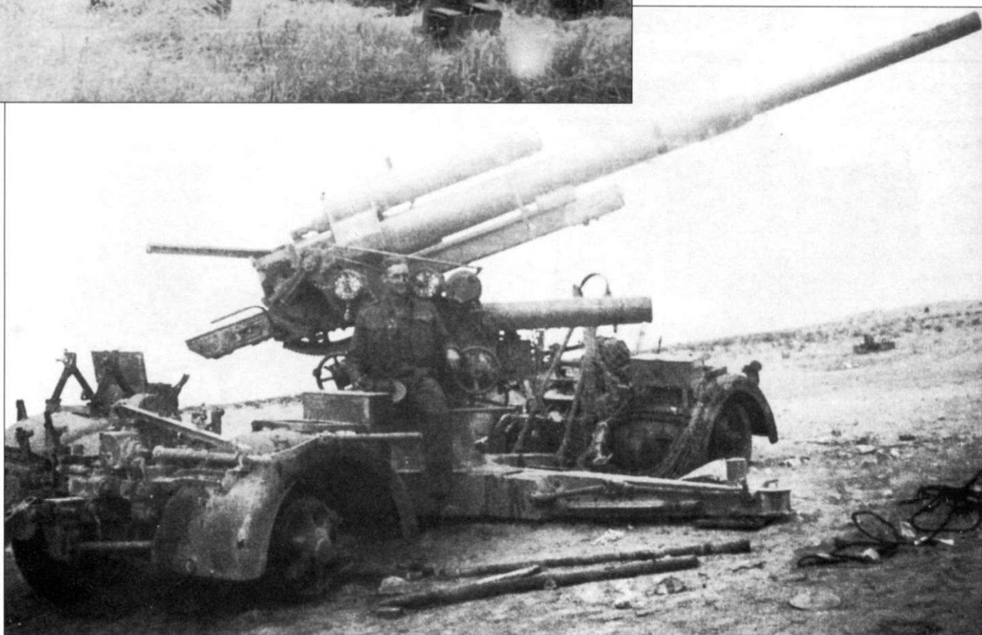
Зенитное орудие 8.8 см Flak-36/37, уничтоженное англичанами в Тунисе. Внешне пушка Flak-36/37 идентична орудью Flak-18, исключая ствол и транспортер, хотя часто встречалась комбинация ствола пушки Flak-18 с лафетом орудия Flak-36/37.
