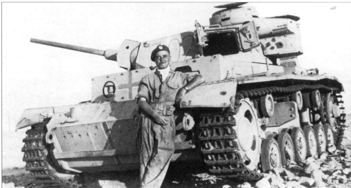
Один из 76 танков Pz.Kpfw. III Ausf. L, вооруженных 50-мм пушками KwK L/60, доставленных в Северную Африку с июля - августа 1942 г. Англичане называли эти танки «Mark III Special» за их длинноствольные пушки. На этом танке, как и на ряде других, нет 20-мм броневой накладки на маске пушки. На танках модификации Ausf. L также ставилась накладная броня толщиной 20 мм в лобовой части корпуса, устранены смотровой лючок заряжающего в маске пушки и наблюдательные амбразуры в бортах башни. Танк полностью перекрашен в песочно-желтый цвет поверх серой заводской окраски. На лобовом бронелисте надстройки корпуса нарисован очень крупный крест. Цифры бортового номера - красные с белой обводкой. Номера нанесены на борта башни и забашенный контейнер. По номеру установлена принадлежность машины - 7-я рота 5-го танкового полка.
