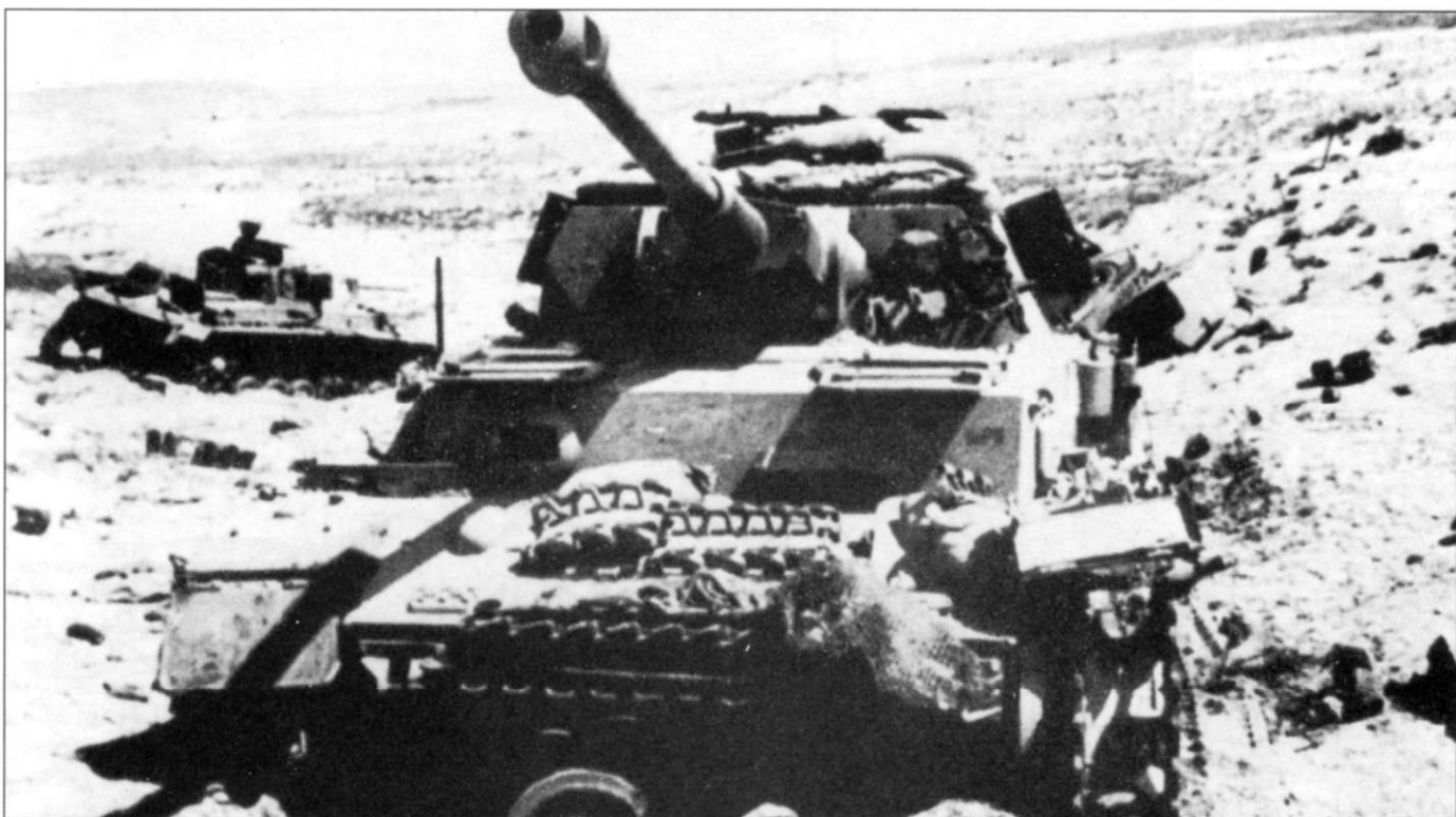
Танки Pz.Kpfw. IV Ausf. G и Pz.Kpfw. III Ausf. L, Тунис. Правее смотрового блока механика-водителя видна эмблема «Wolfsangel» 8-го танкового полка. Лобовая часть корпуса дополнительно защищена гусеничными траками и мешками с песком.
