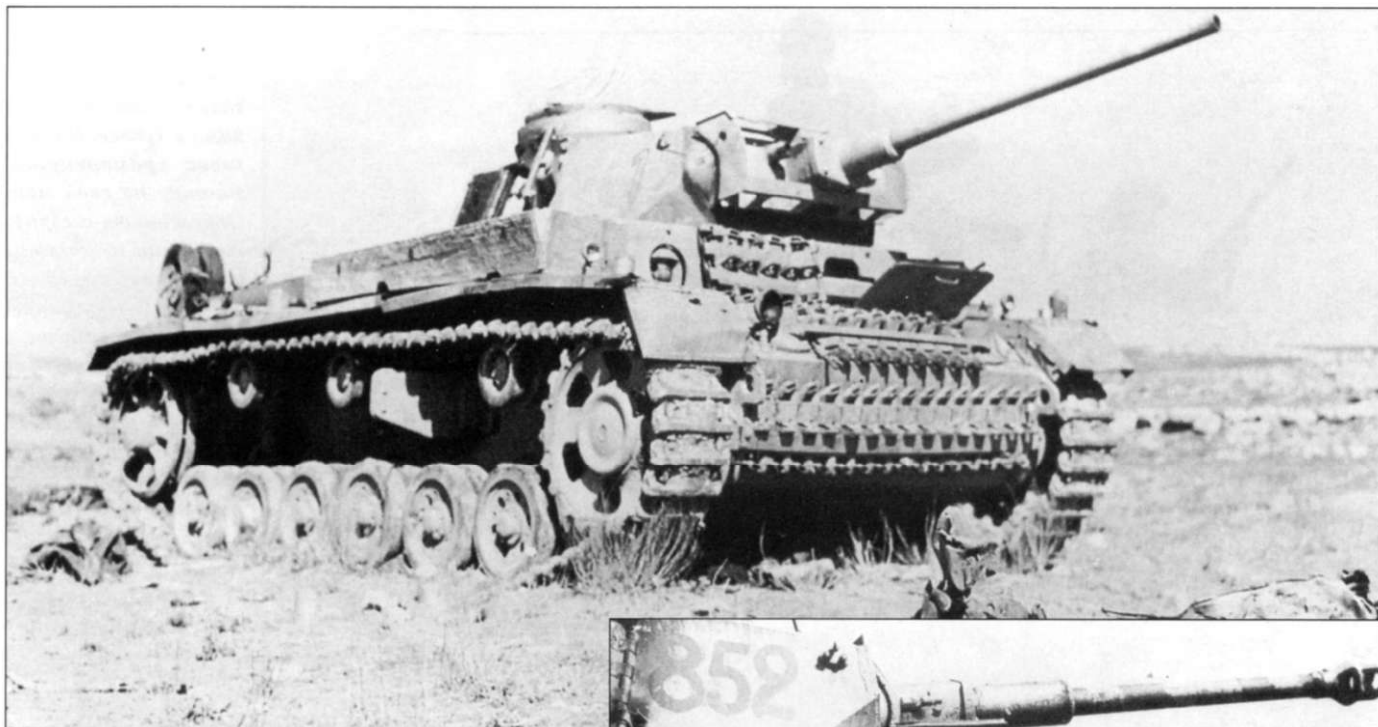
Танк Pz.Kpfw. III Ausf. L из 7-го танкового полка 10-й панцердивизии, подбитый англичанами в районе Кассерин в феврале 1943 г. Tактический номер «1» нарисован черной краской контуром, есть еще два номера меньшего размера («15»), не видимых на этой фотографии. 20-мм броневая накладка на маску пушки не установлена.
