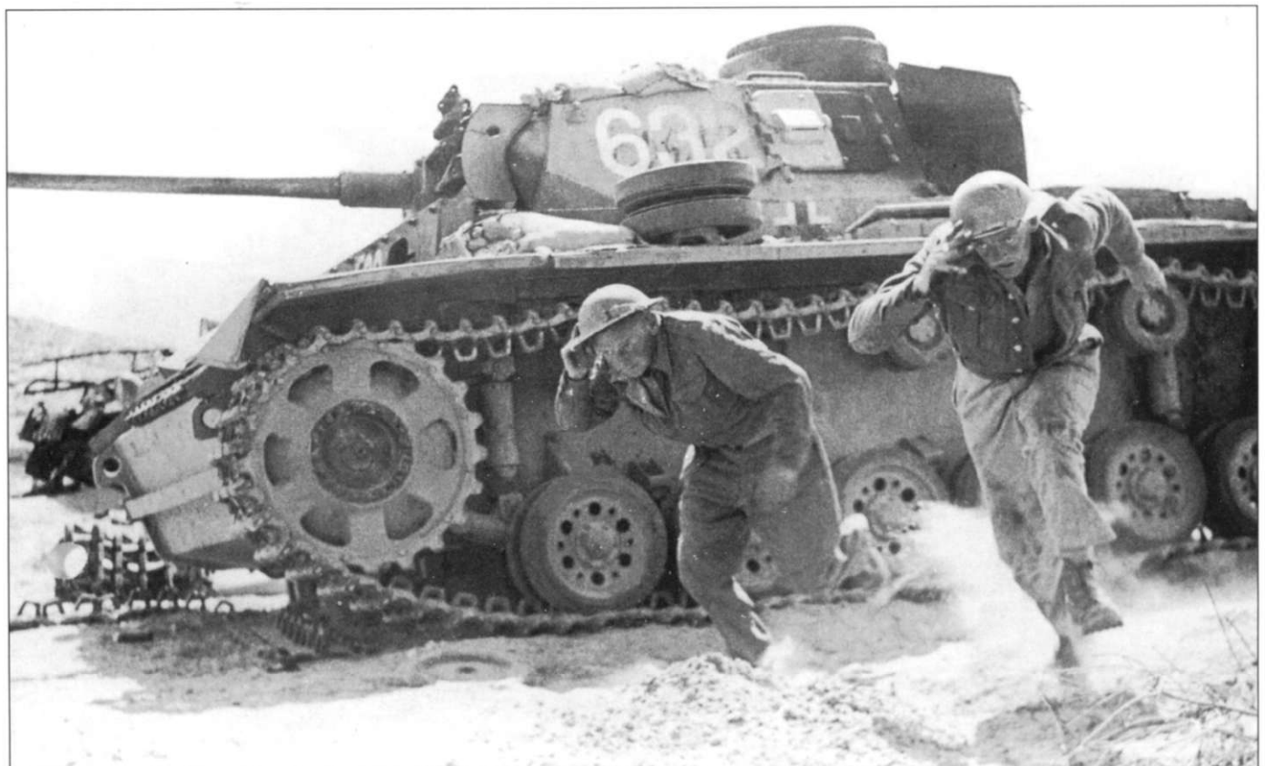
Два британских сапера заложили взрывчатку в танк Pz.Kpfw. III Ausf. L , район Медины, март 1943 г. На борту башни танка крупно белой краской написан тактический номер «632», вероятно это танк из 5-го панцерполка. Подобно большинству танков Pz.Kpfw. III Ausf. L , действовавших в Северной Африке, у этой машины нет 20-мм накладной брони на башне.
