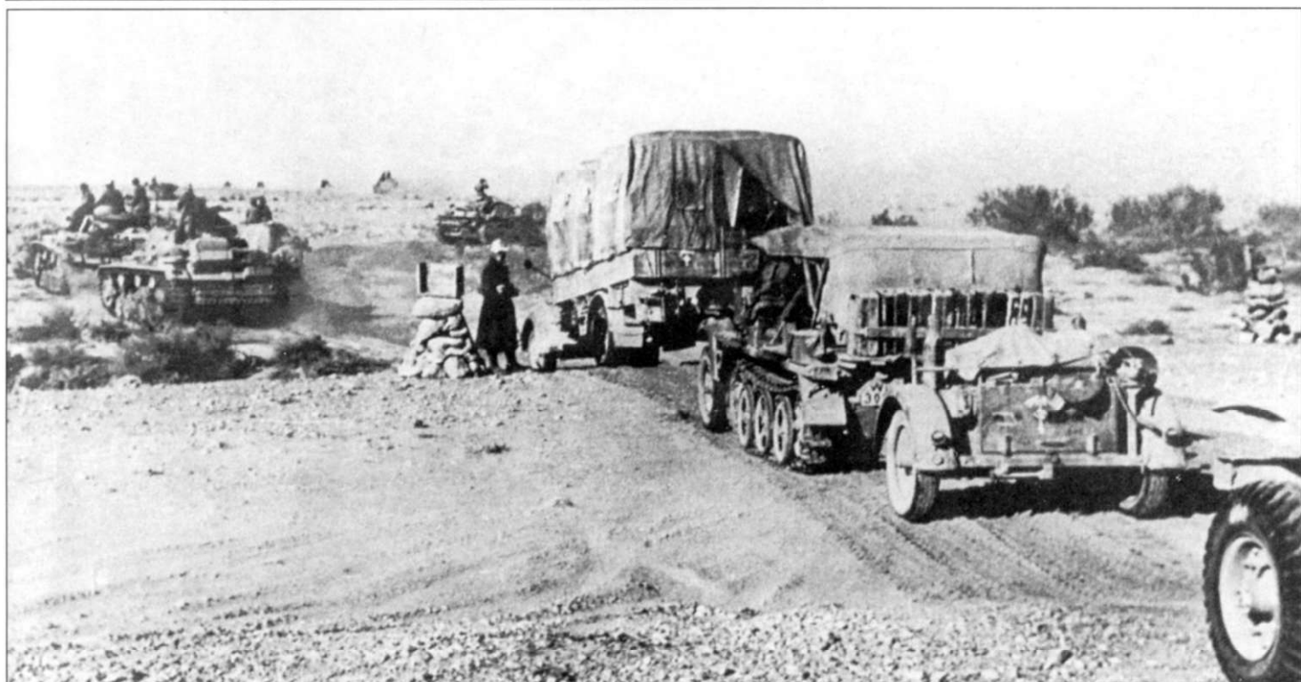
Колонна техники из 15-й панцердивизии по дороге на Восток, февраль 1942 г. Впереди следует танк Pz.Kpfw. III из 8-го панцерполка, за ним - грузовик снабжения и полугусеничный тягач Sdf.Kfz. 10 с трейлером для перевозки боеприпасов на прицепе. На корме тягача виден белый тактический знак панцердивизии. Аналогичный знак нанесен на задней стенке трейлера. Также видна белая пальма со свастикой корпуса «Африка» и красная эмблема «Wolfsangel» 8-го танкового полка. Дорога обозначена сложенными на обочине двумя пирамидками из камней.
