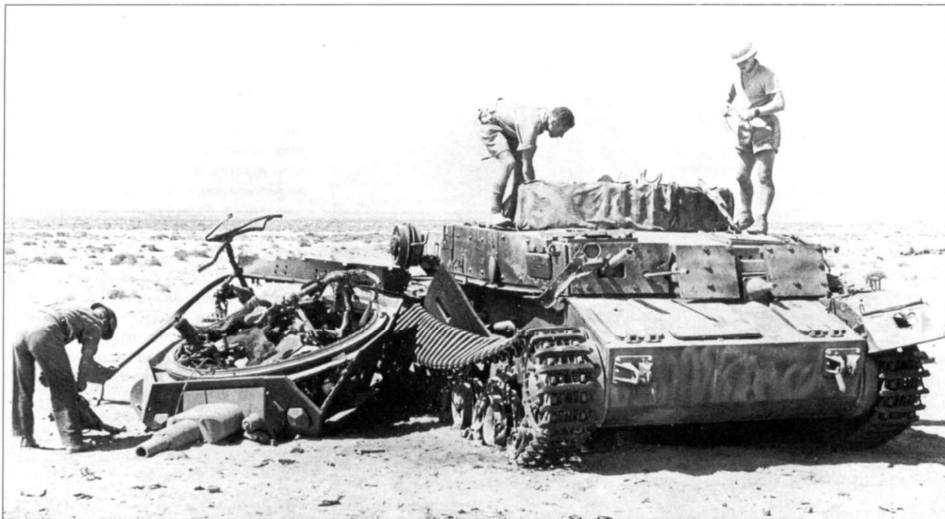
Танк Pz.Kpfw. IV Ausf. E из 5-го танкового полка, уничтоженный детонацией боекомплекта. Башня сорвана внутренним взрывом. На снимке видна накладная броня корпуса толщиной 20 мм и 30 мм. При атаке Тобрука 8-я рота потеряла пять танков Pz.Kpfw. IV. Танк камуфлирован извилистыми полосами желтого цвета по исходному серому фону. Танк оснащен гусеницами, набранными из ранних траков шириной 36 см.
