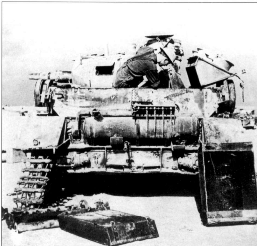
Танк Pz.Kpfw. IV Ausf. D из 5-го танкового полка подбит британскими пушками под Тобруком. На башне белым контуром написан тактический номер «811». Танк перекрашен в песочно-желтый цвет поверх заводской окраски серого цвета. На корме корпуса видны темные линии (серые) в местах, где при перекраске находился буксирный трос. Единственная видимая маркировка, помимо номера - эмблема корпуса «Африка» и крест, обозначенный белыми скобками.
