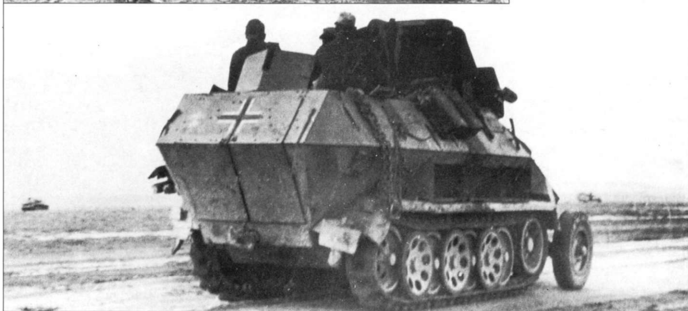
Полугусеничный бронетранспортер Sd.Kfz. 251/1 Ausf. C, вооруженный 50-мм противотанковой пушкой PaK-38, орудие установлено в полевых ремонтных мастерских. На корме бронетранспортера поставлен щиток от пулемета MG-34, видимо перенесен спереди. На задней дверце кузова нарисованы крест и пальма корпуса «Африка». Броневик имеет потрепанный вид - нет крышек багажных отсеков в борту кузова.
