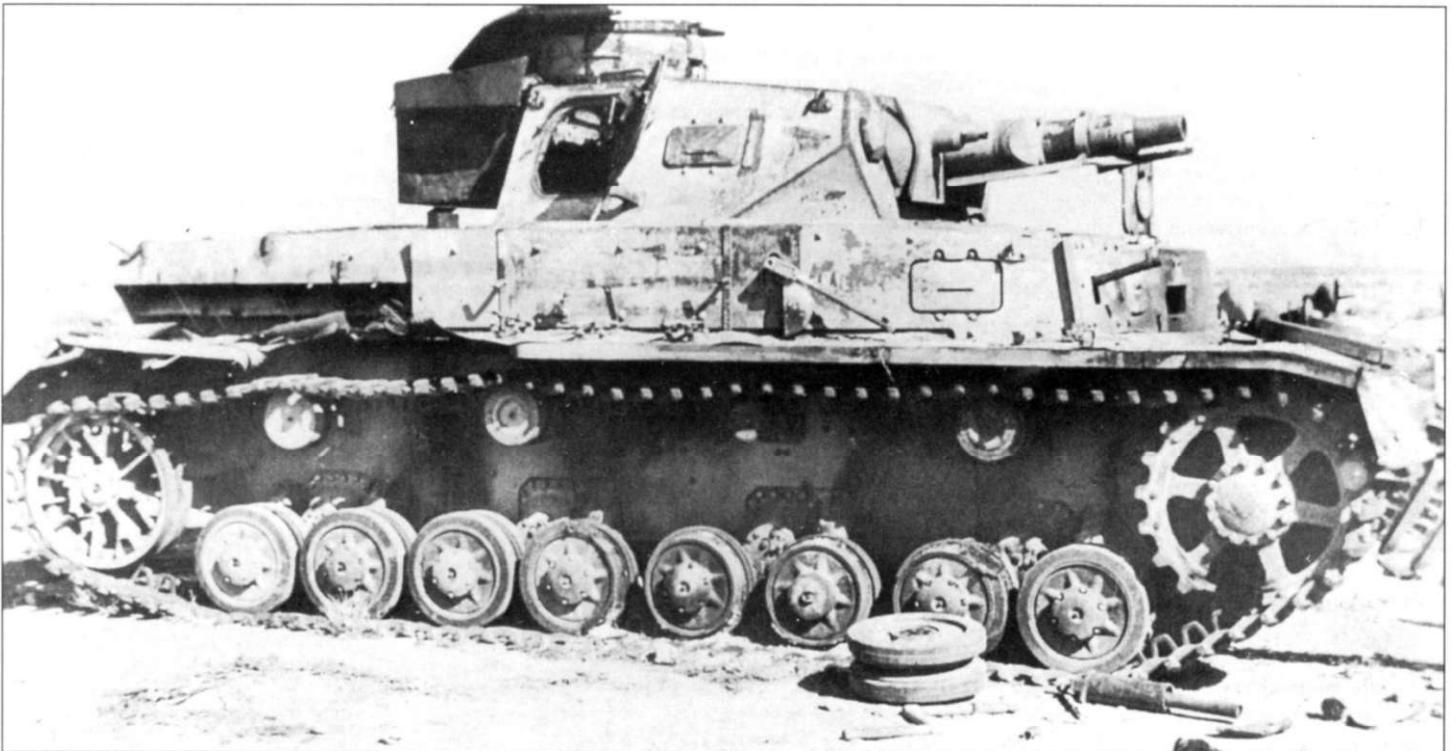
14 апреля 1941 г. 5-й танковый полк предпринял первую неудачную атаку Тобрука, потеряв несколько танков от огня британских 25-фунтовых противотанковых пушек. На башне подбитого танка Pz.Kpfw. IV Ausf. E с трудом различим номер «821». Танк оснащен накладной 20-мм бортовой и 30-мм лобовой броней - комплект «Zusatzpanzer». Внутренним взрывом сорваны лобовой смотровой лючок механика-водителя и накладная броня. Резина на опорных катках частично обгорела.
