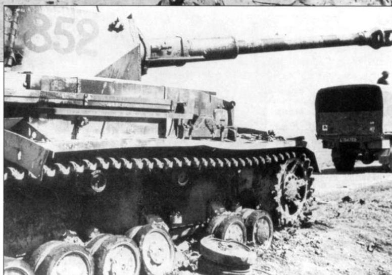
Танк Pz.Kpfw. III Ausf. L из 7-го танкового полка 10-й панцердивизии, подбитый англичанами в районе Кассерин в феврале 1943 г. Tактический номер «1» нарисован черной краской контуром, есть еще два номера меньшего размера («15»), не видимых на этой фотографии. 20-мм броневая накладка на маску пушки не установлена.
