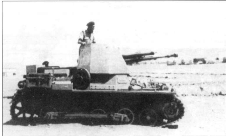
Два снимка самоходки 4,7 см PaK (t) auf. Pz.Kpfw. I Ausf. B, подбитой англичанами в Северной Африке. 27 семь таких самоходно-артиллерийских установок прибыло в Триполи в марте 1941 г. в составе 605-го батальона истребителей танков. Часть машин прошла всю африканскую кампанию вермахта вплоть до капитуляции в мае 1943 г. Самоходки были вооружены чешскими пушками Шкода 47 мм KPV.vz.38 Model A5, самыми мощными противотанковыми орудиями германской армии по состоянию на 1940 г. Все самоходки, отправленные в Африку были перекрашены в пустынно-желтый цвет поверх заводской серой окраски.
