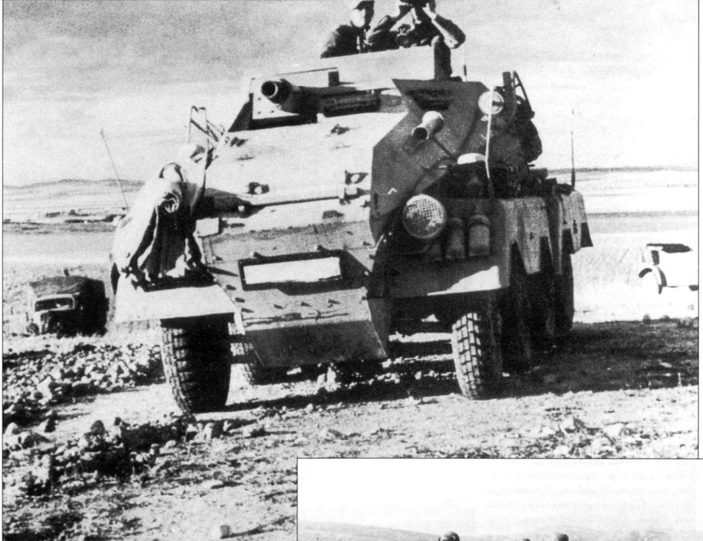
Еще один тяжелый броневедомитель schwere Panzerspahwagen (7,5 см) Sd.Kfz. 233, Тунис, январь 1943 г. С декабря 1942 г. по октябрь 1943 г. было изготовлено 109 таких броневедомителей, вооруженных устаревшими пушками 7,5 см StuK-37 L/24 от танков Pz.Kpfw. IV ранних модификаций.
