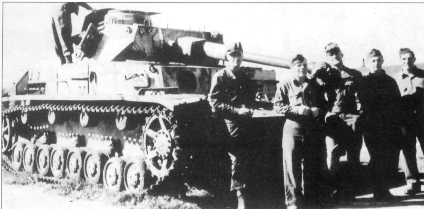
Солдаты армии США позируют на фоне танка Pz.Kpfw. IV Ausf. G раннего выпуска. Наблюдательные амбразуры в борту башни и в маске пушки отсутствуют. Ствол снабжен дульным тормозом, характерным для пушек танков модификации Ausf. F2. К башне приварены крепления для гусеничных траков и опорных катков.
