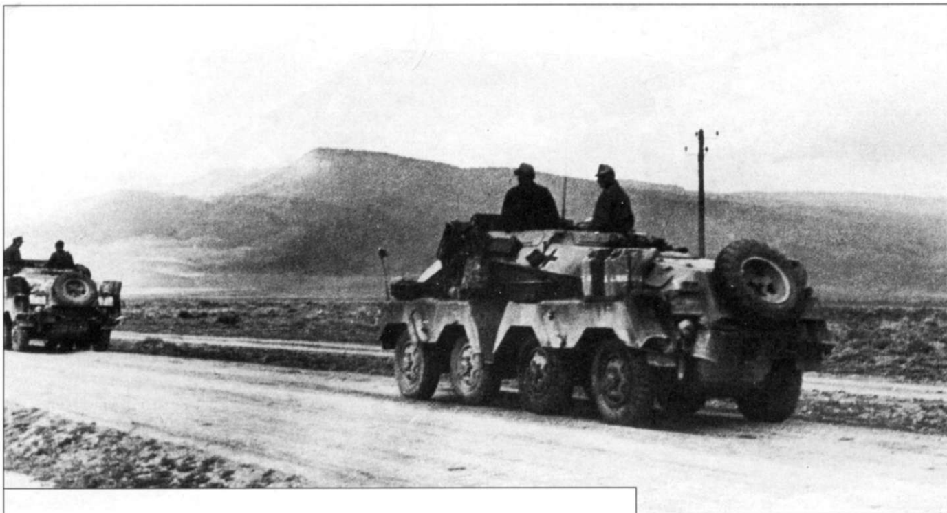
Два тяжелых бронеавтомобиля schwere Panzerspahwagen (7.5cm) Sd.Kfz. 233, Тунис, март 1943 г. Обе машины снабжены запасными колесами и канистрами для воды. Ближайшая машина промаркирована только крестами и номерными знаками вермахта.
