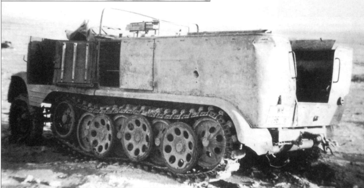
Брошенный в пустыне полугусеничный тягач Sd.Kfz. 11. Такие тягачи обычно использовались для буксировки 105-мм гаубиц leFH-18, хотя тягачи применялись также для буксировки и других типов артиллерийских систем. Видимая маркировка ограничена номерным знаком вермахта.
