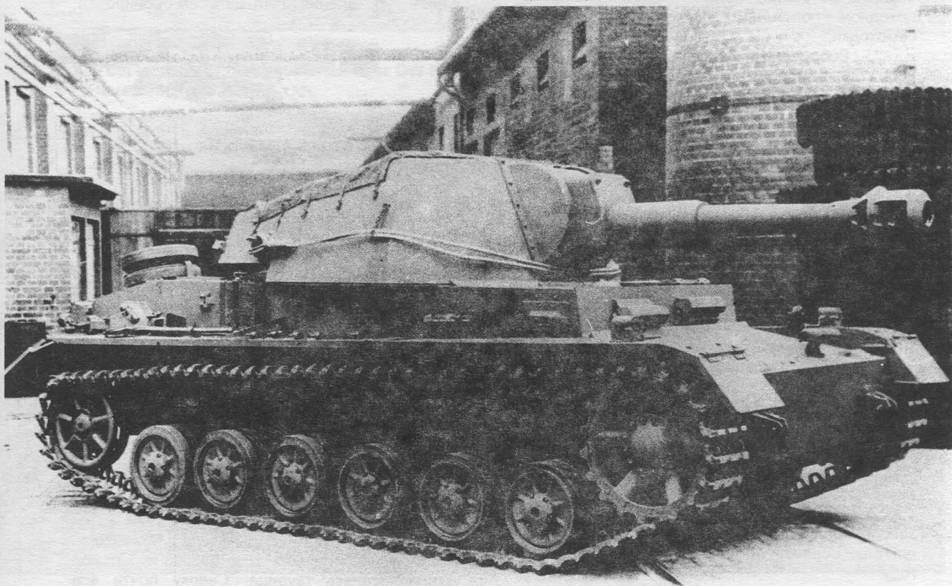
Прототип 10.5 cm leFH 18/1 Geschützwagen IV Sd Kfz 165/1 на заводе фирмы Крупп, 1942 г.
